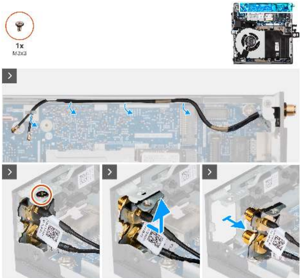
Abbildung 36. Entfernen der SMA-Antenne
