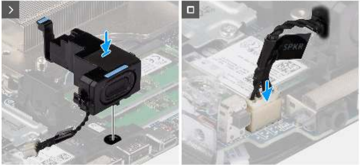
Abbildung 15. Einbauen des Lautsprechers
