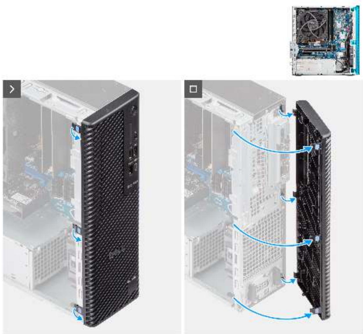
Abbildung 15. Entfernen der vorderen Abdeckung
