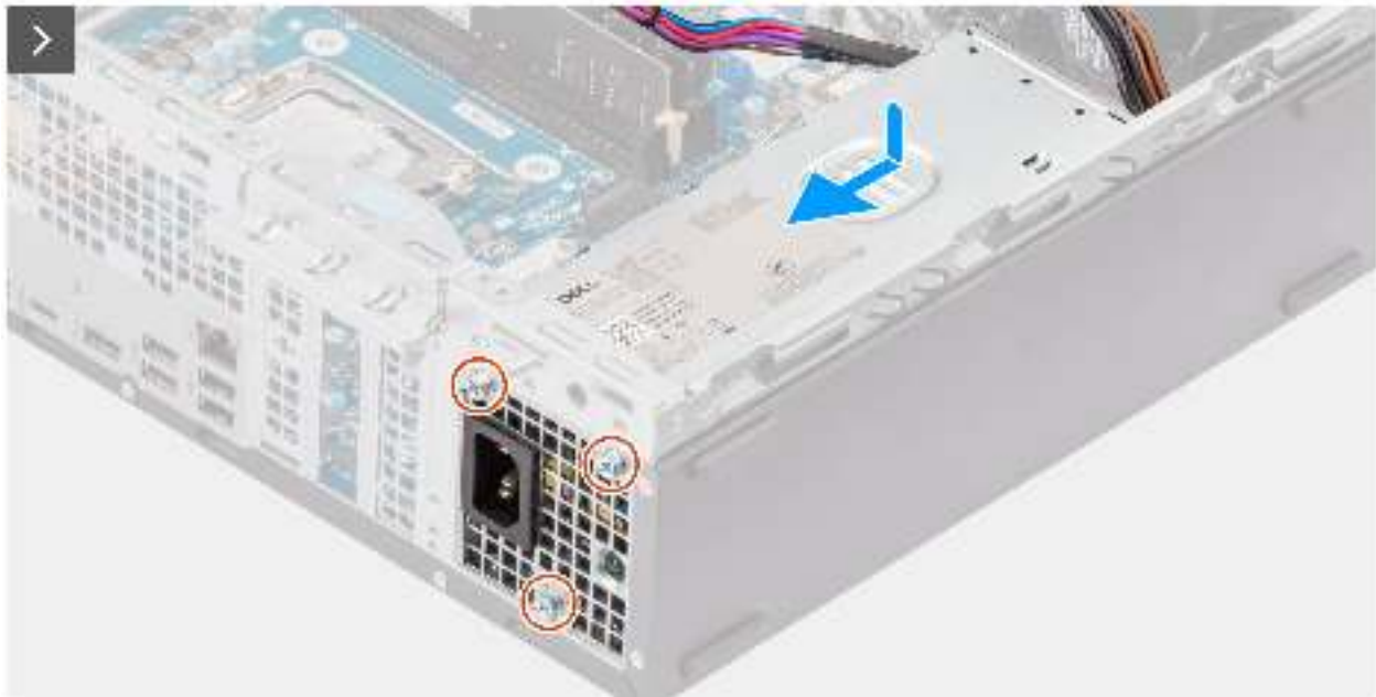
Abbildung 59. Installieren der Stromversorgungseinheit
