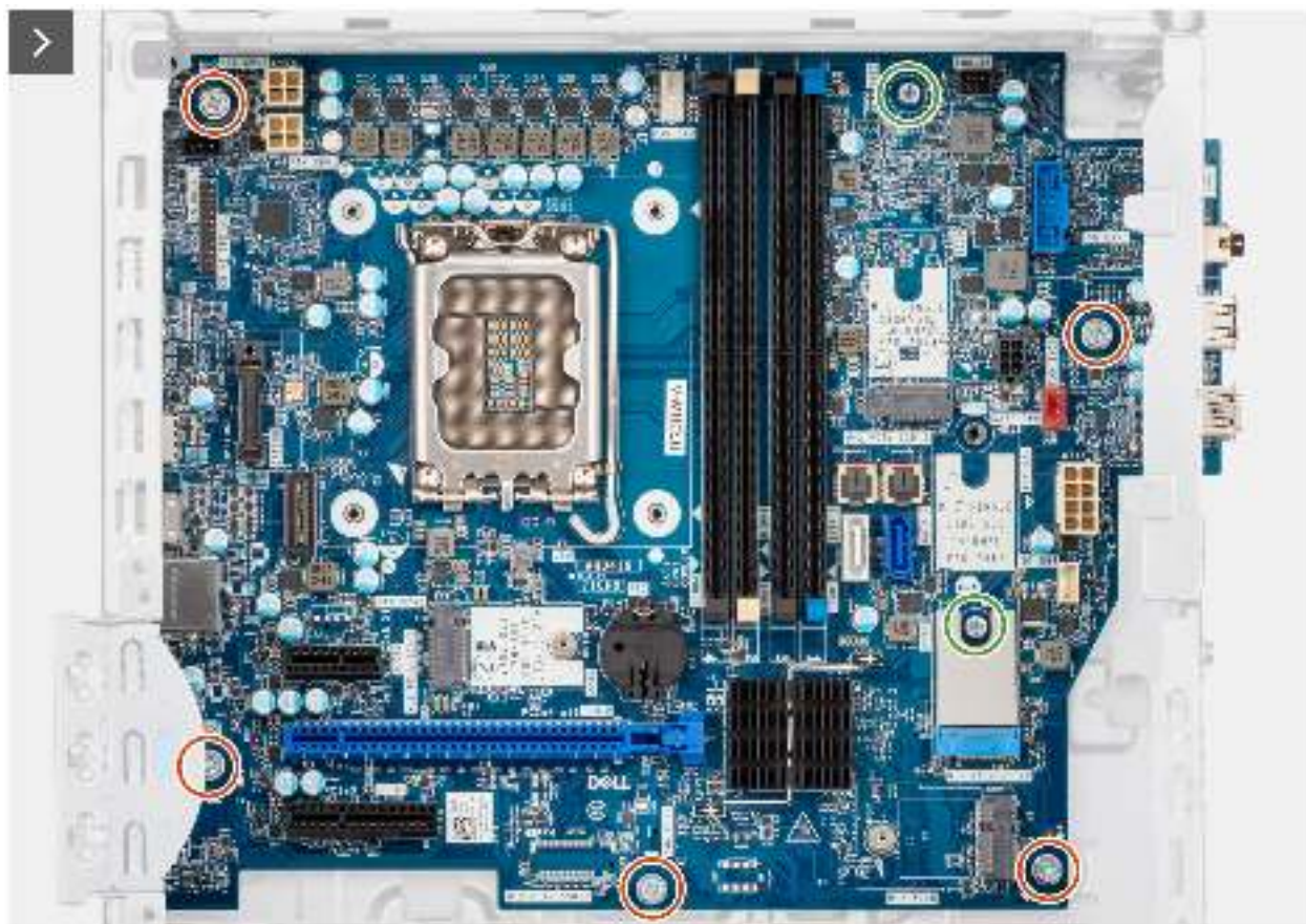
Abbildung 89. Einbauen der Systemplatine
