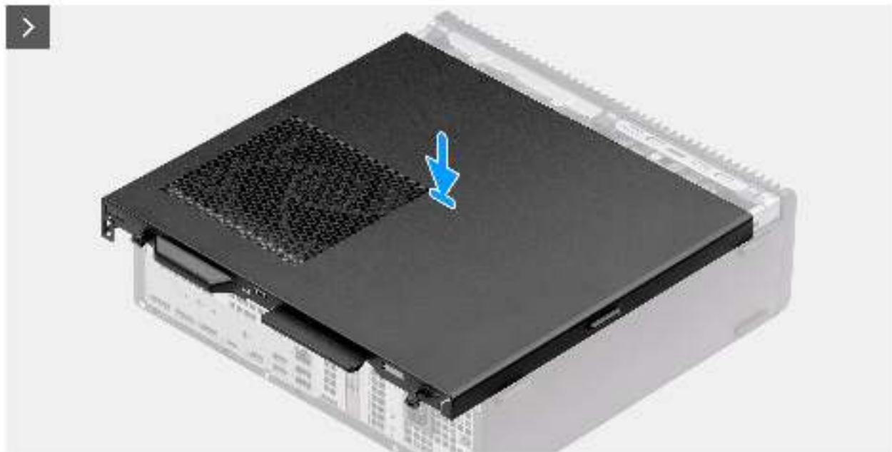
Abbildung 11. Anbringen der Seitenabdeckung
