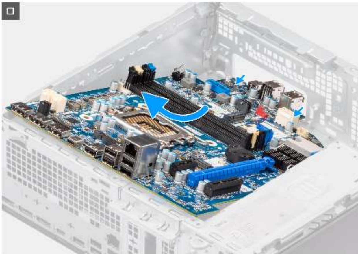
Abbildung 86. Entfernen der Systemplatine
