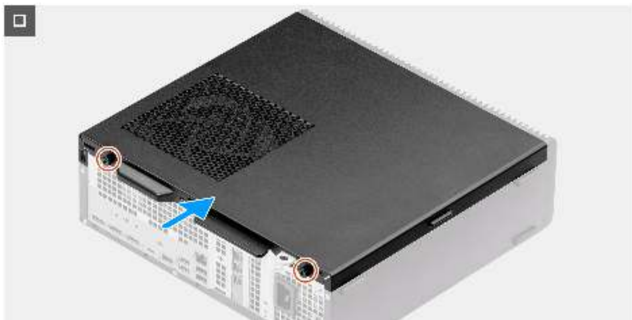
Abbildung 12. Anbringen der Seitenabdeckung
