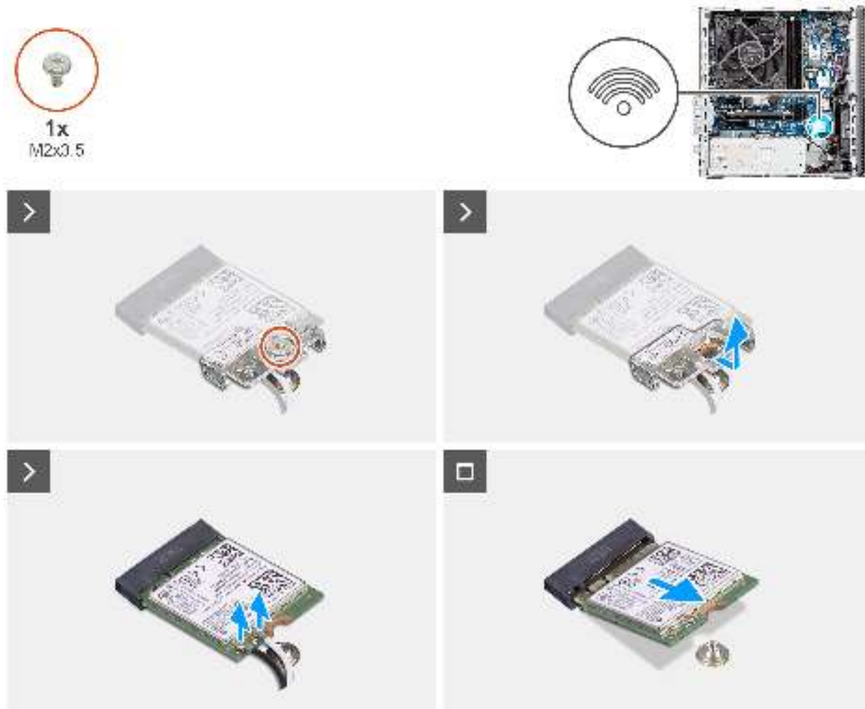
Abbildung 41. Entfernen der Wireless-Karte
