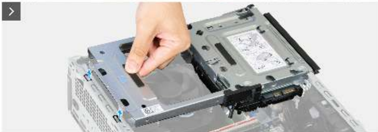
Abbildung 21. Entfernen des Laufwerksschachts
