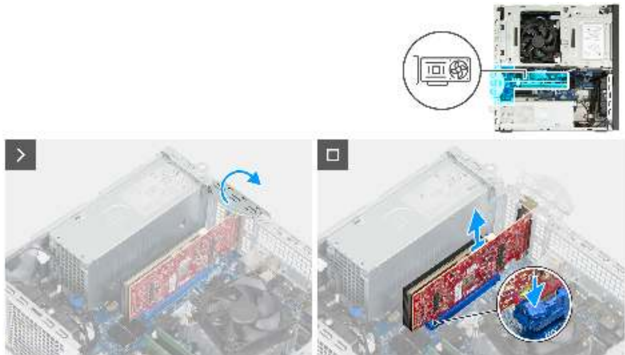
Abbildung 39. Entfernen der Grafikkarte
