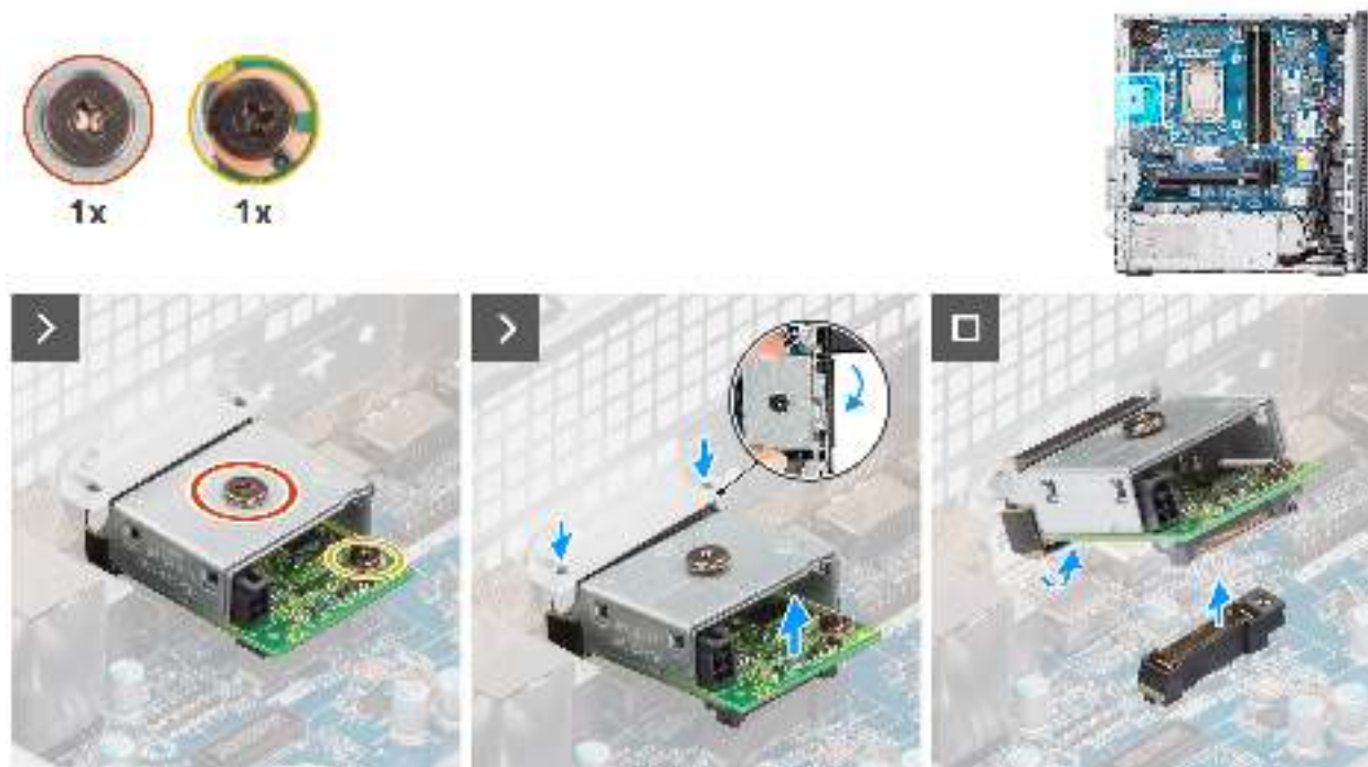
Abbildung 64. Entfernen des optionalen USB-Moduls
