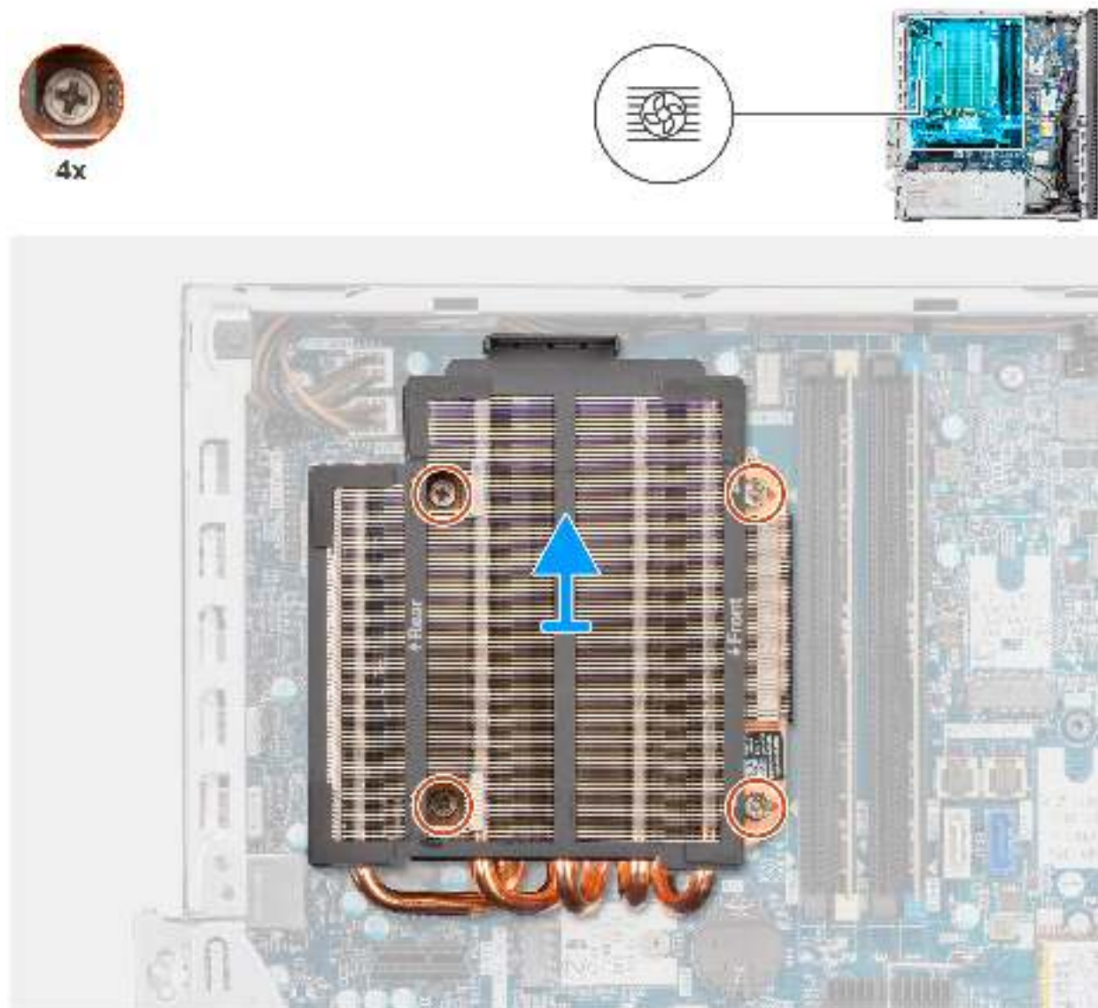
Abbildung 53. Entfernen der Kühlkörperbaugruppe des Prozessors
