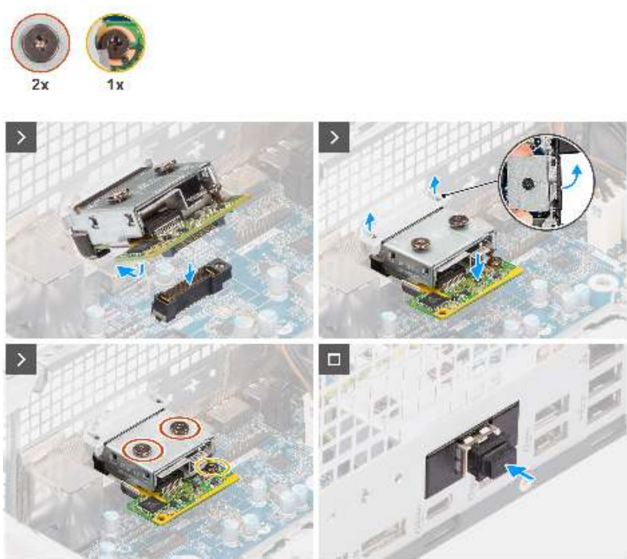
Abbildung 81. Installieren des optionalen optischen 5-GbE-Moduls
