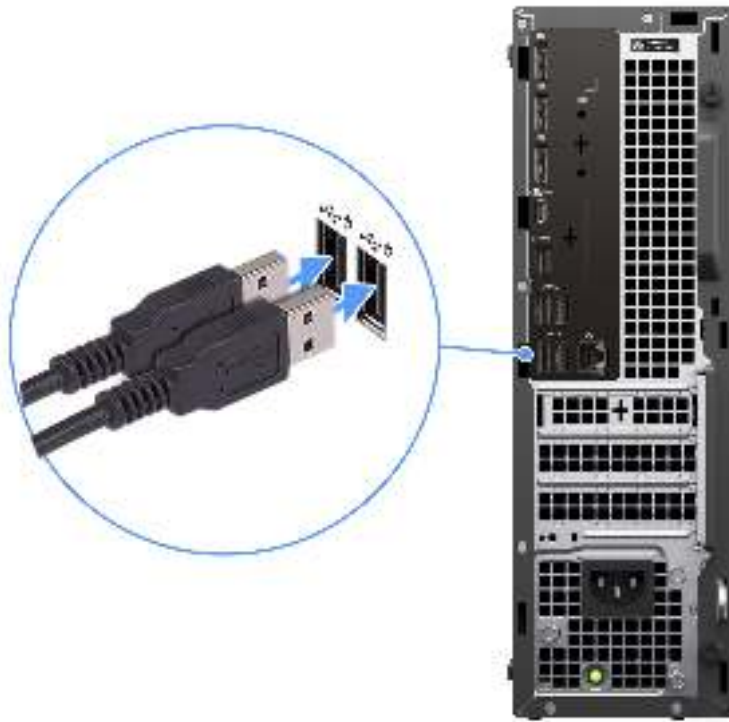
Abbildung 3. Tastatur und Maus anschließen
