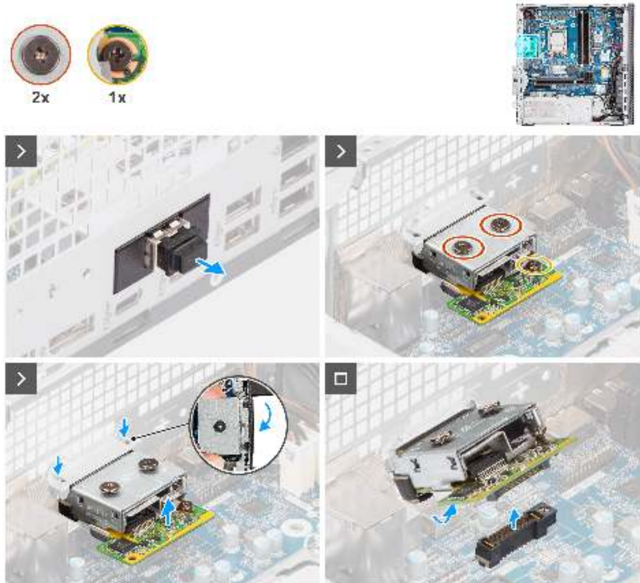
Abbildung 79. Entfernen des optionalen optischen 5-GbE-Moduls
