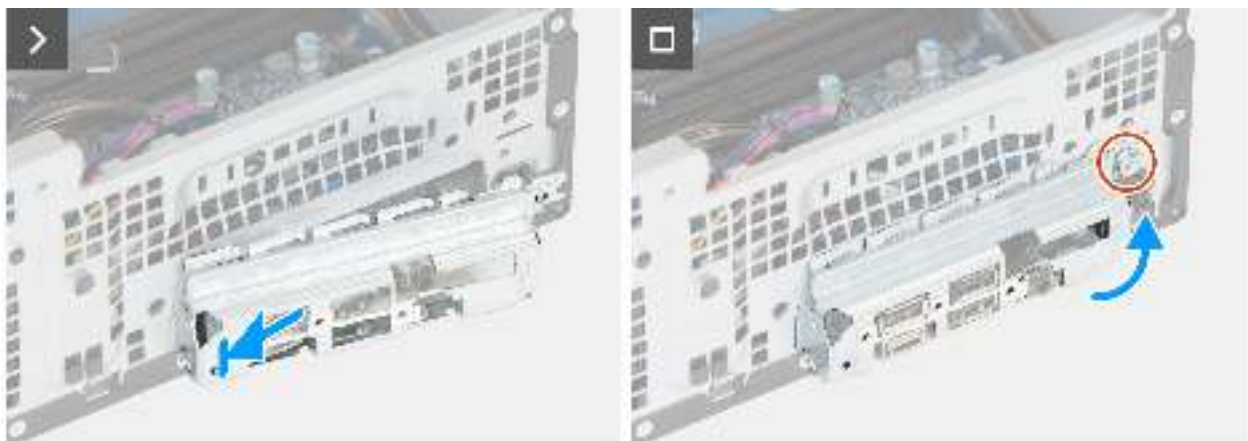
Abbildung 91. Einbauen der Systemplatine
