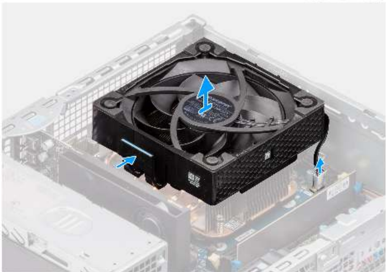
Abbildung 51. Entfernen des Prozessorlüfters
