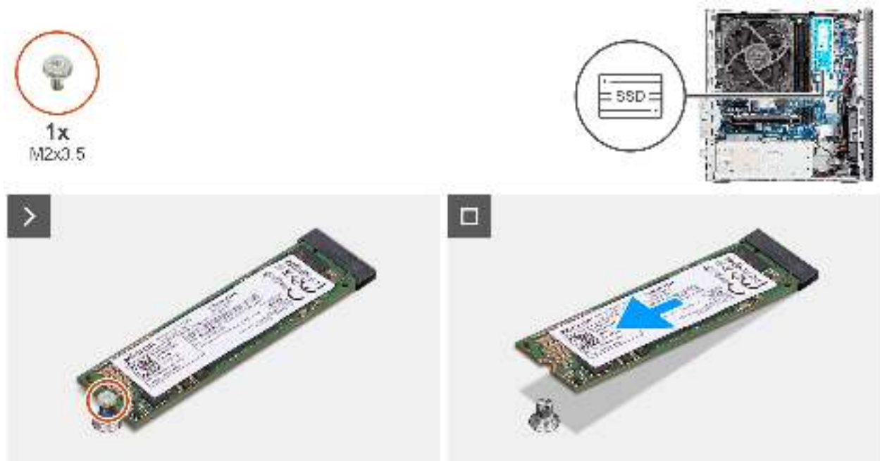
Abbildung 35. Entfernen des M.2-2280-Solid-State-Laufwerks
