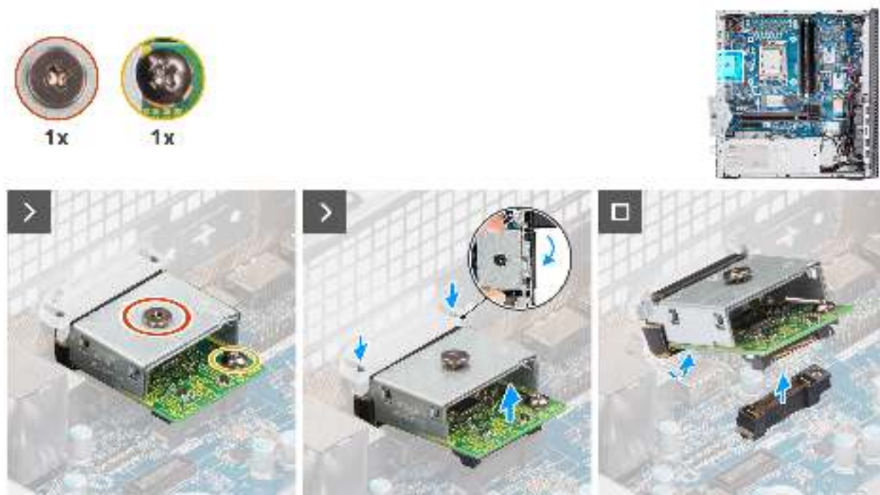
Abbildung 76. Entfernen des optionalen DisplayPort-Moduls
