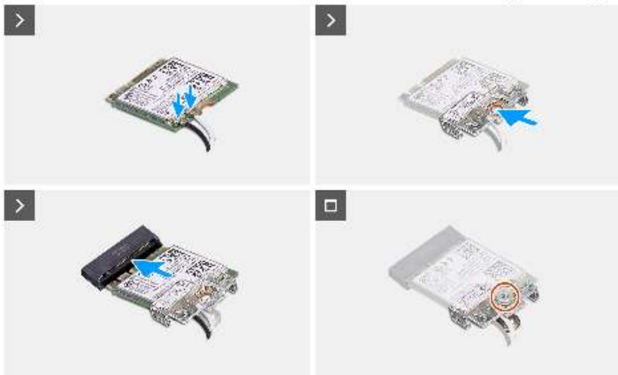
Abbildung 42. Installieren der Wireless-Karte
