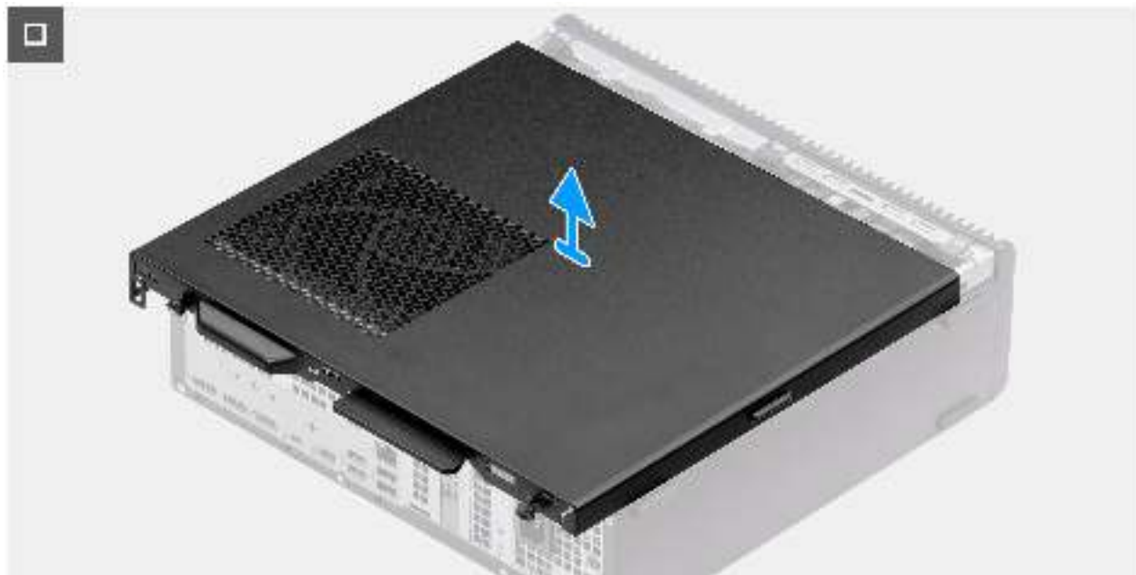
Abbildung 10. Entfernen der Seitenabdeckung
