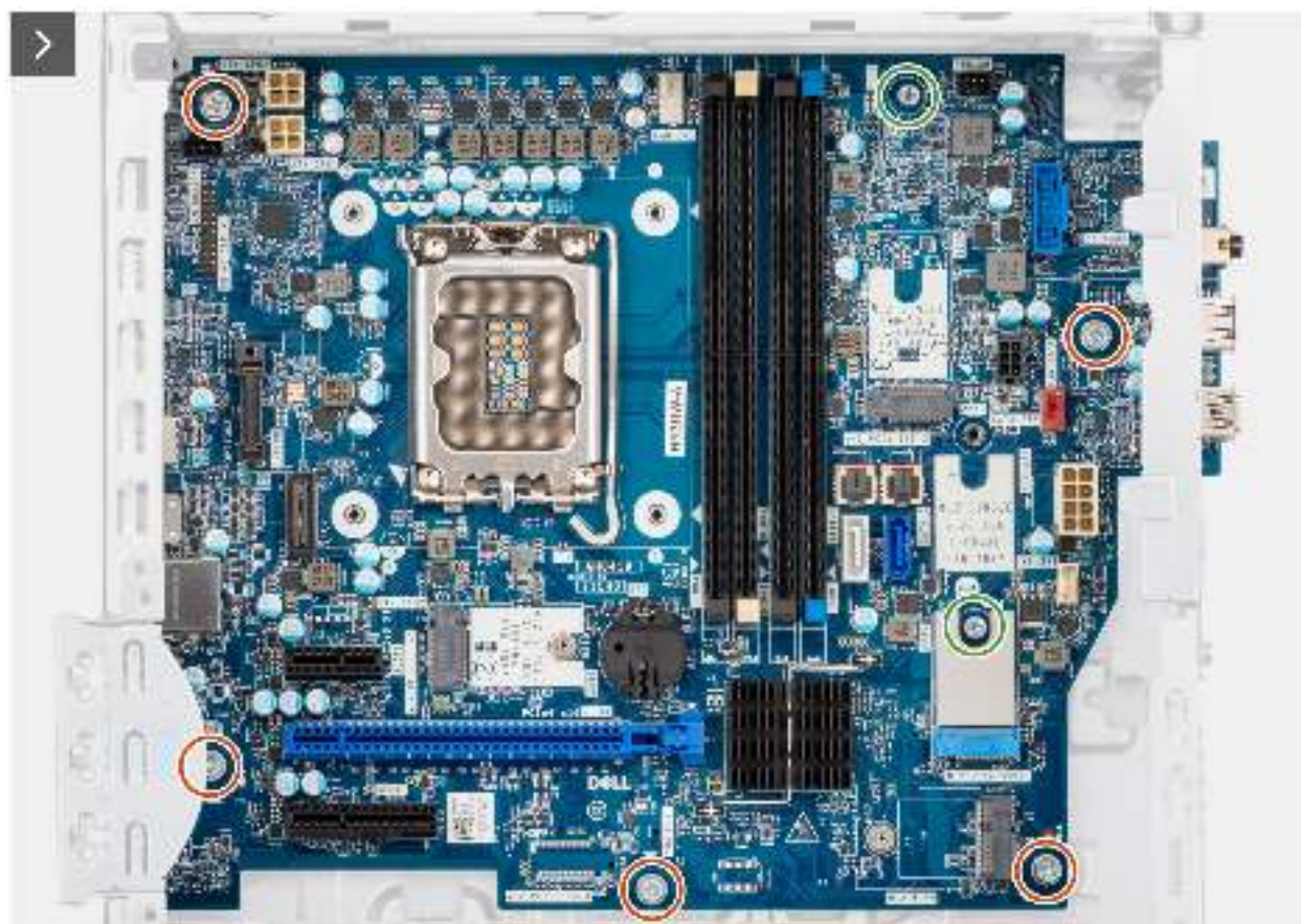
Abbildung 85. Entfernen der Systemplatine
