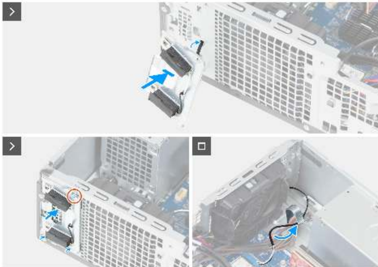
Abbildung 50. Einbauen des Antennenmoduls
