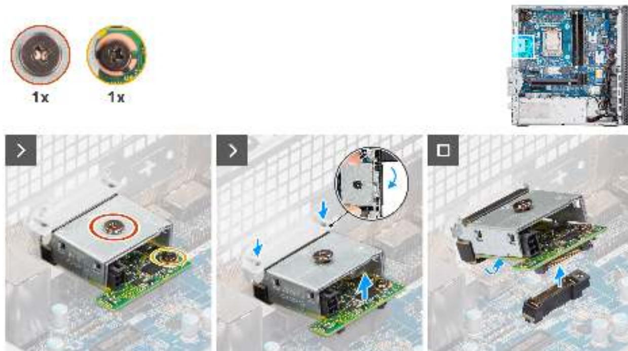
Abbildung 67. Entfernen des optionalen Thunderbolt-Moduls
