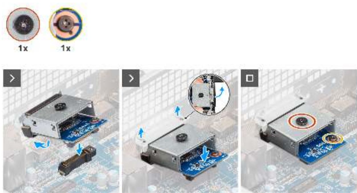
Abbildung 75. Installieren des optionalen HDMI-Moduls
