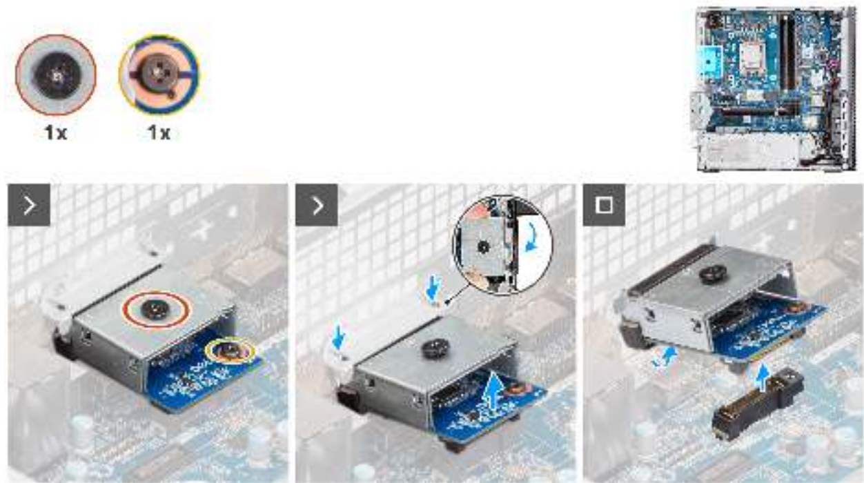
Abbildung 73. Entfernen des optionalen HDMI-Moduls
