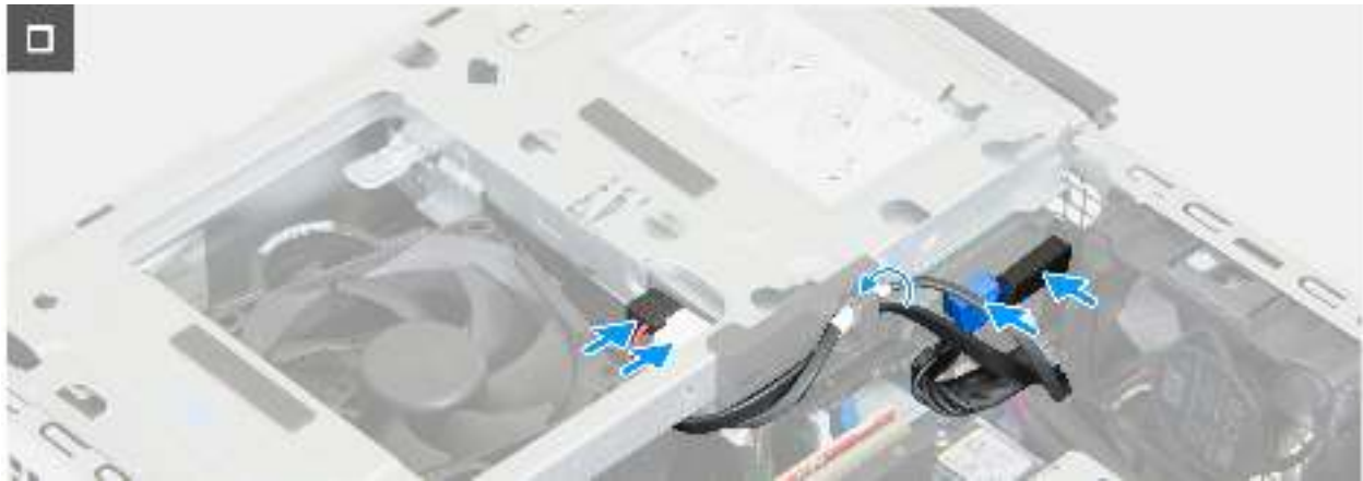
Abbildung 24. Installieren des Laufwerksschachts
