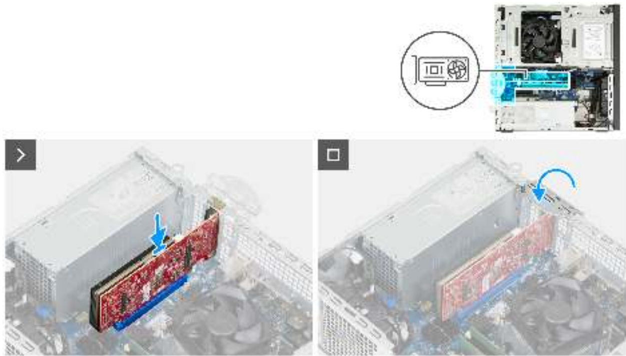
Abbildung 40. Installieren der Grafikkarte
