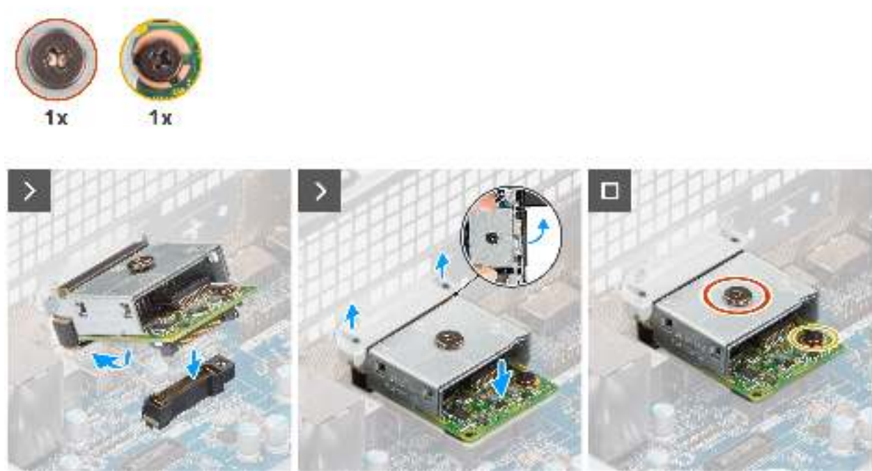
Abbildung 72. Installieren des optionalen LAN-Moduls
