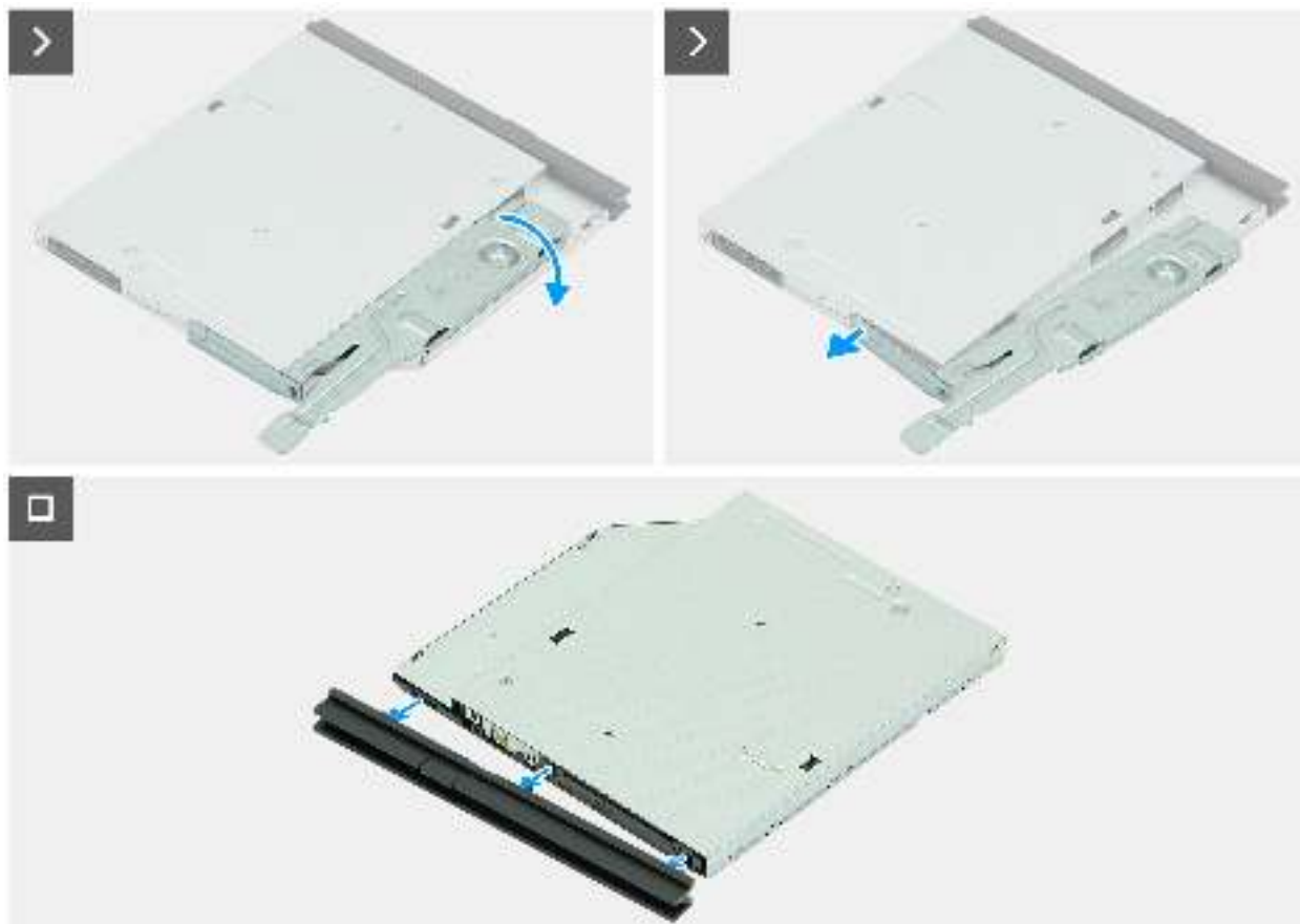
Abbildung 18. Entfernen des optischen Laufwerks
