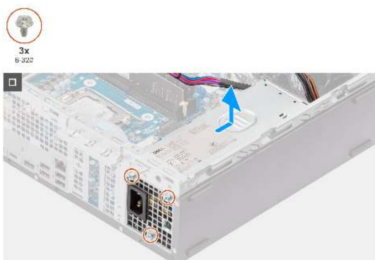
Abbildung 58. Installieren der Stromversorgungseinheit
