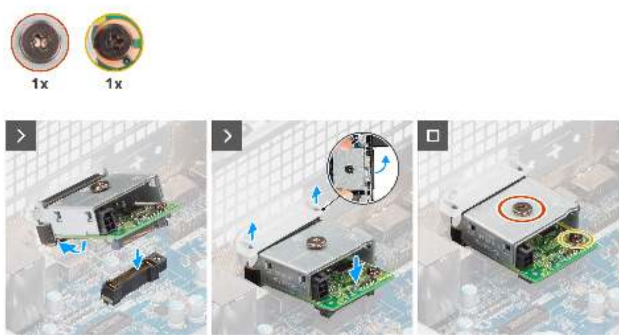
Abbildung 66. Installieren des optionalen USB-Moduls
