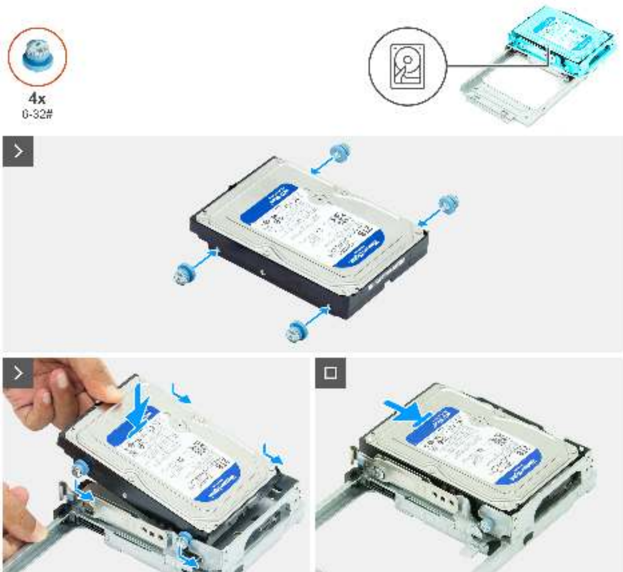
Abbildung 30. Einsetzen des Festplattenlaufwerks
