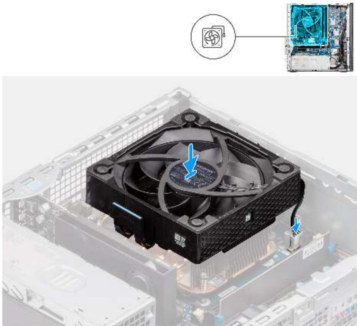
Abbildung 52. Installieren des Prozessorlüfters
