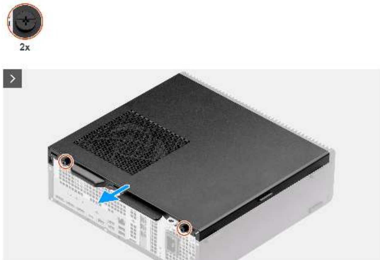
Abbildung 9. Entfernen der Seitenabdeckung
