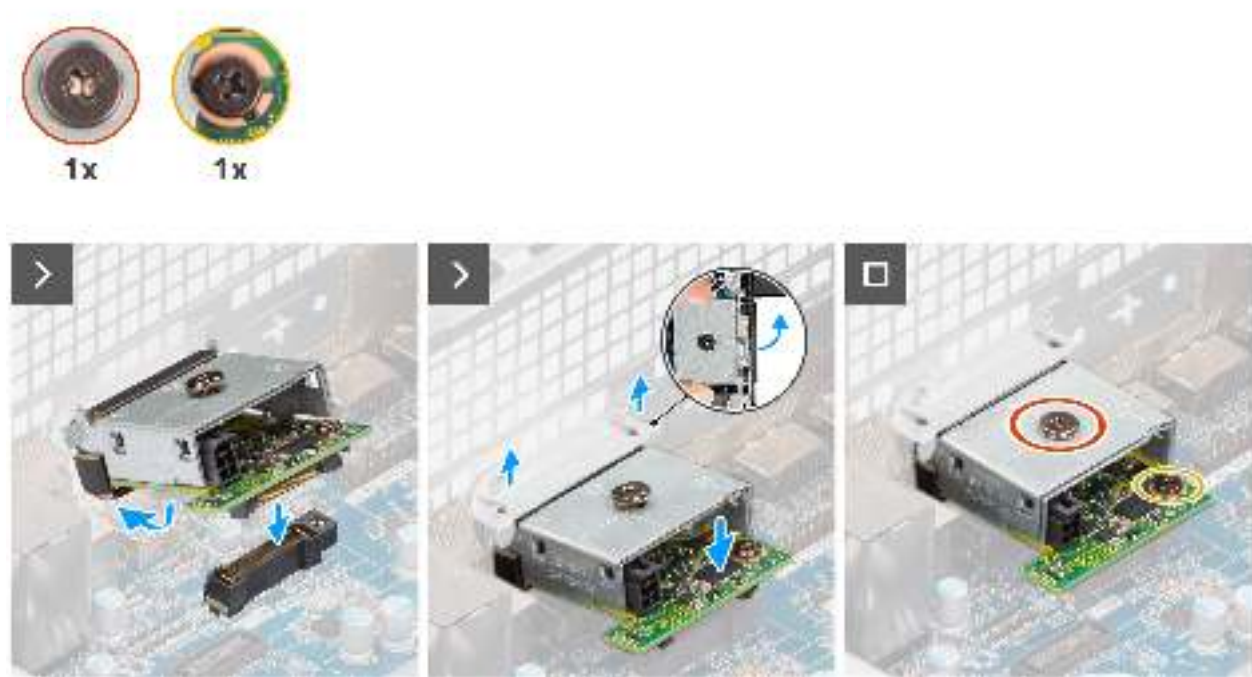
Abbildung 69. Installieren des optionalen Thunderbolt-Moduls
