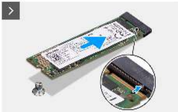
Abbildung 38. Einbauen des M.2-2280-Solid-State-Laufwerks
