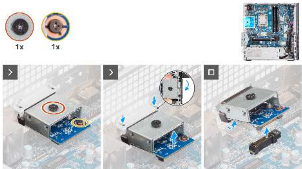
Abbildung 61. Entfernen des optionalen VGA-Moduls
