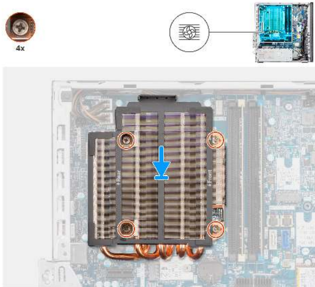
Abbildung 54. Installieren der Kühlkörperbaugruppe des Prozessors
