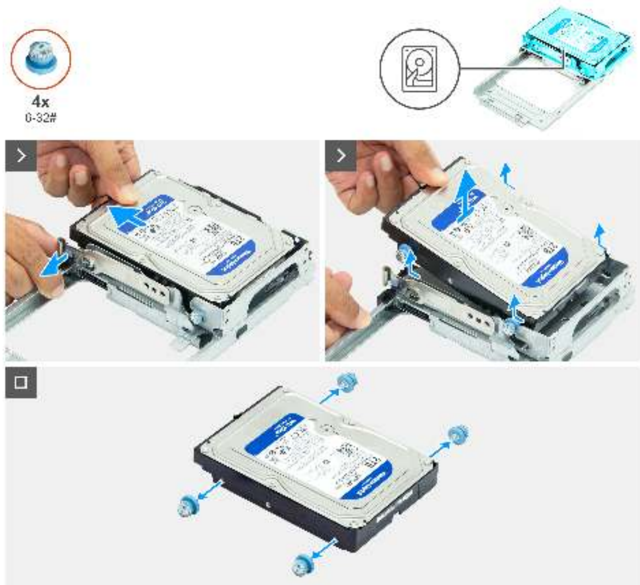
Abbildung 29. Entfernen der Festplatte
