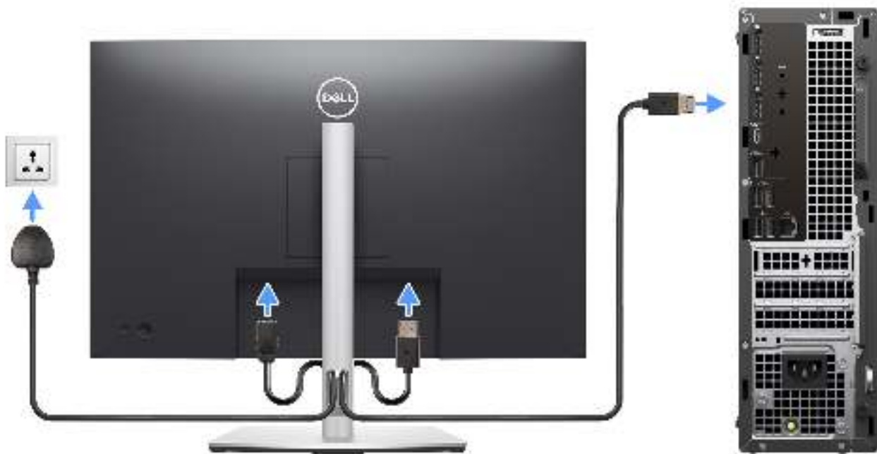
Abbildung 5. Anschließen des Displays
