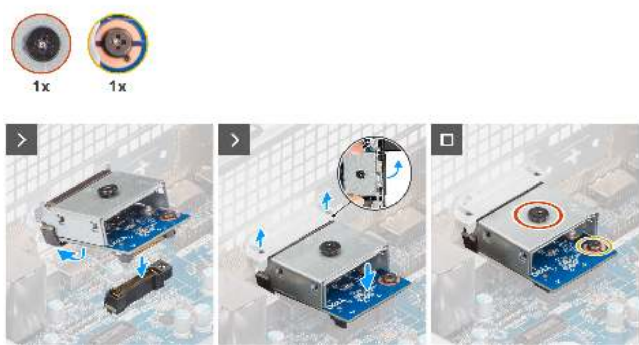
Abbildung 63. Installieren des optionalen VGA-Moduls
