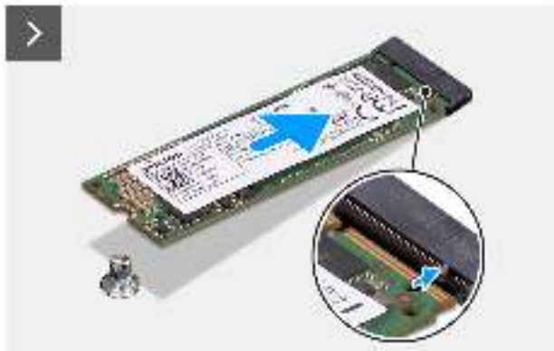
Abbildung 36. Einbauen des M.2-2280-Solid-State-Laufwerks
