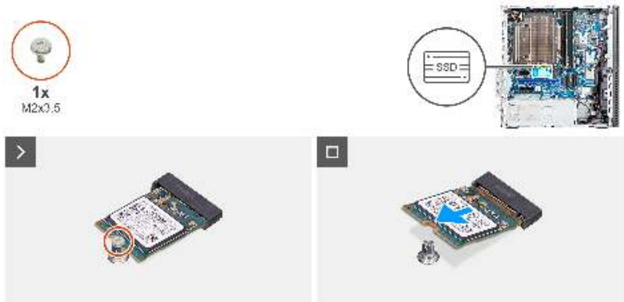
Abbildung 33. Entfernen des M.2-2230-Solid-State-Laufwerks
