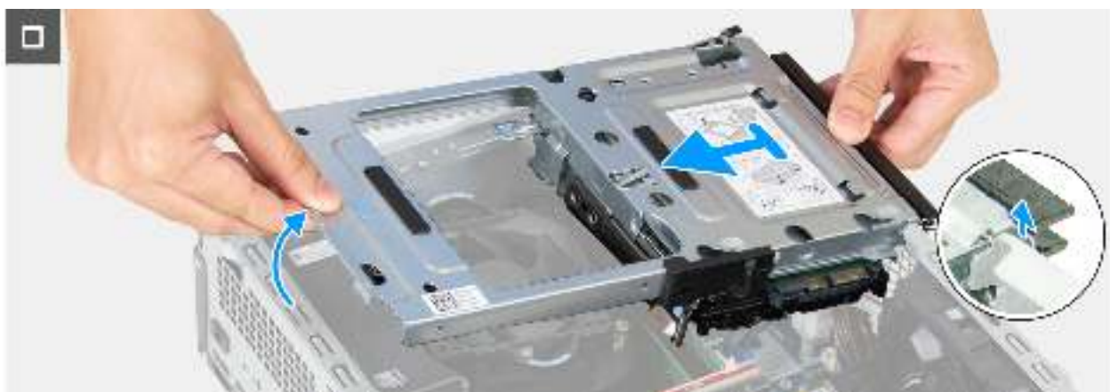
Abbildung 22. Entfernen des Laufwerksschachts
