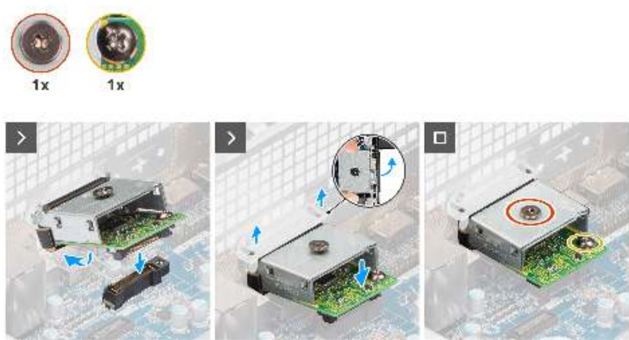
Abbildung 78. Installieren des optionalen DisplayPort-Moduls
