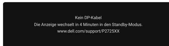
Abbildung 77. Warnmeldung: DP-Kabel getrennt
