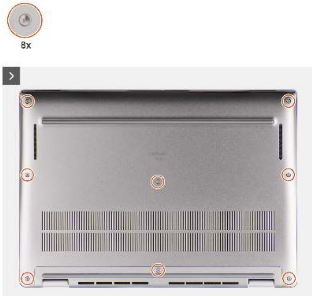
Abbildung 16. Entfernen der Bodenabdeckung
