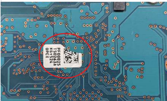
Beschädigter Barcode-Aufkleber auf Leiterplatte
