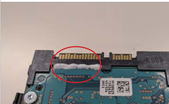
Klebstoff auf Steckverbinder
