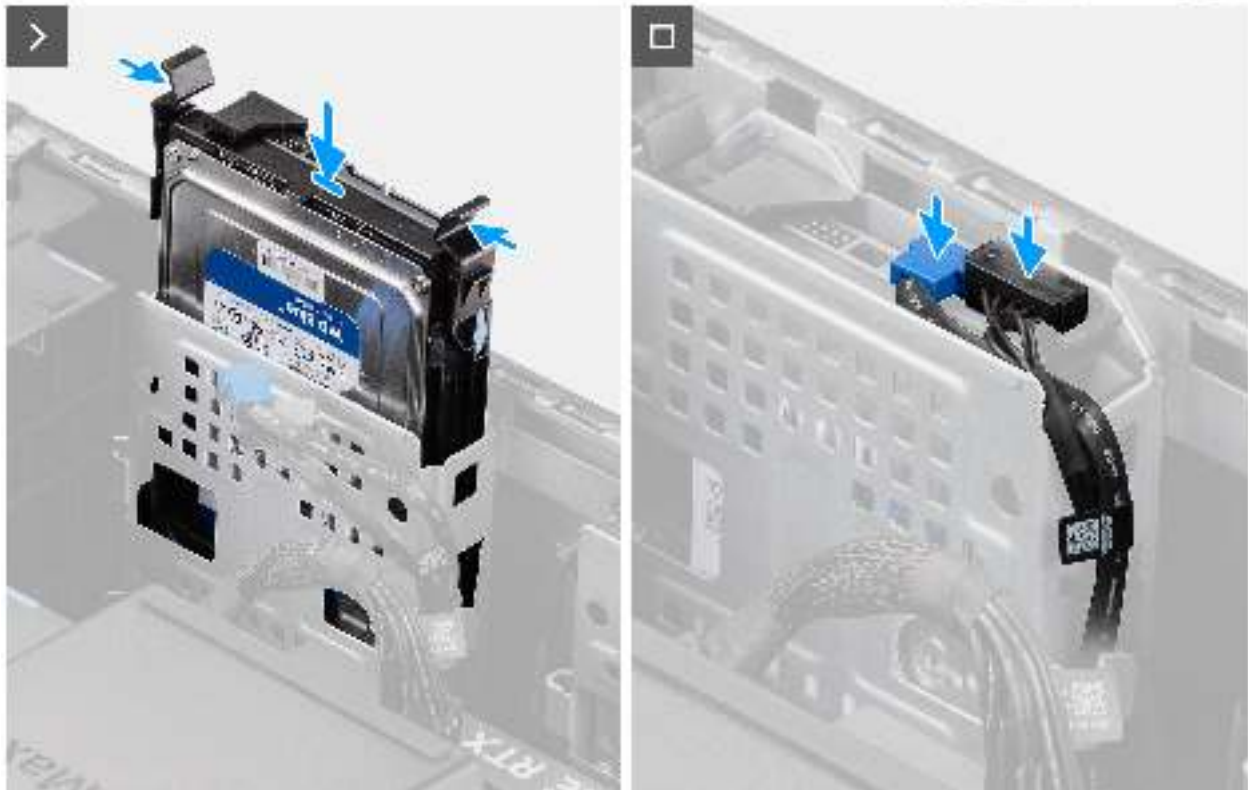
Abbildung 30. Installieren der 3,5-Zoll-Festplattenbaugruppe in Schacht 1
