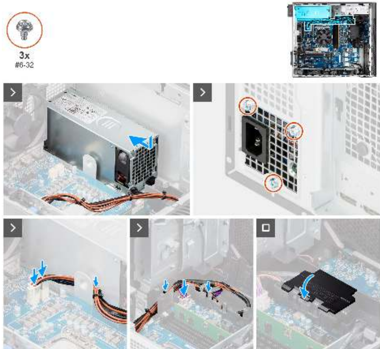
Abbildung 58. Installieren der 360-W-Stromversorgungseinheit
