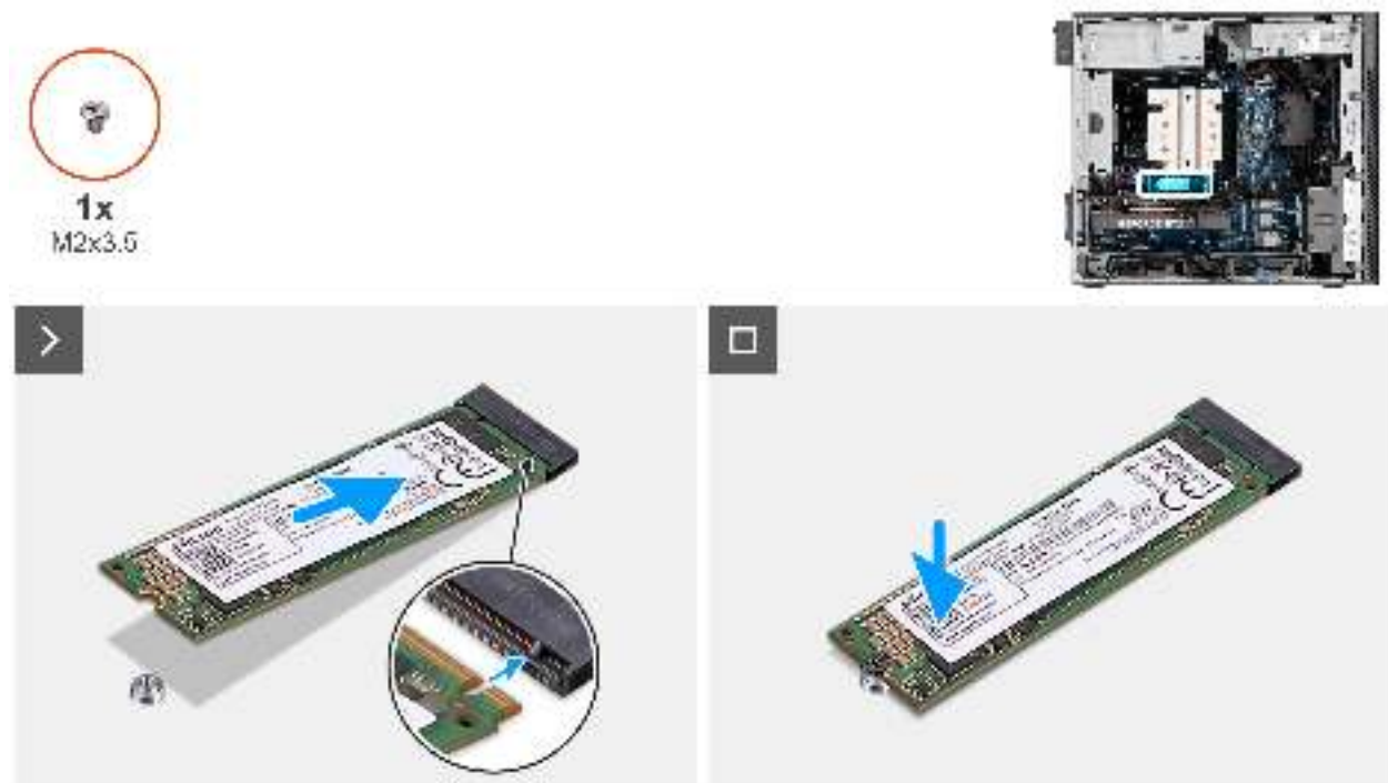
Abbildung 34. Einbauen des M.2 2280-PCIe-SSD-Laufwerks
