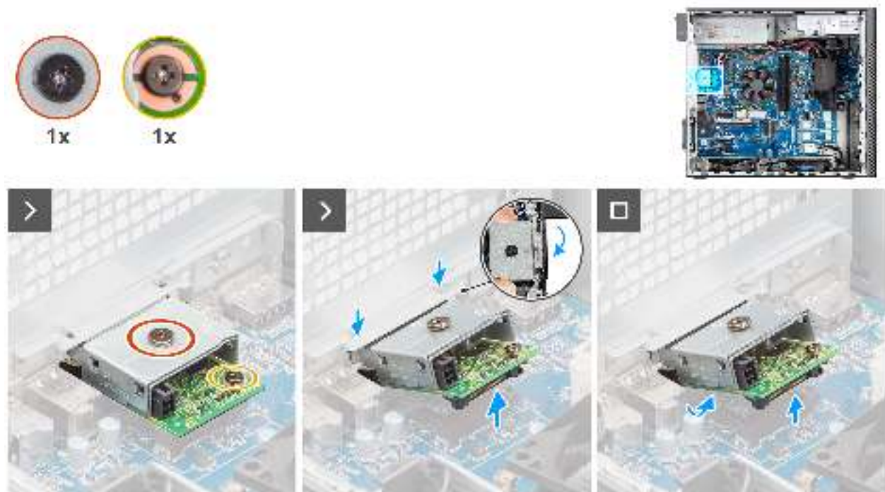
Abbildung 82. Entfernen des optionalen USB-Moduls
