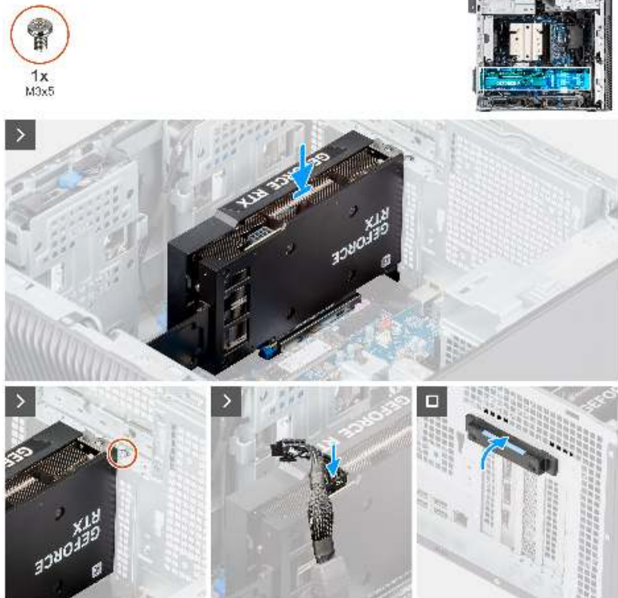
Abbildung 40. Einbauen der Grafikkarte mit Stromversorgung
