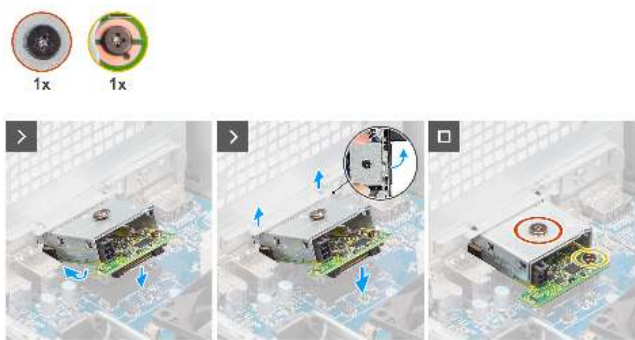
Abbildung 84. Installieren des optionalen USB-Moduls
