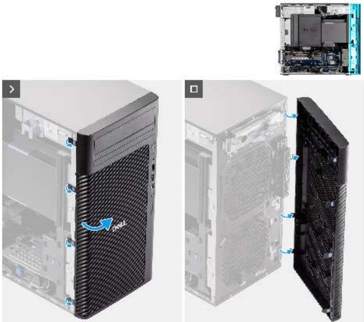
Abbildung 17. Entfernen der Frontverkleidung
