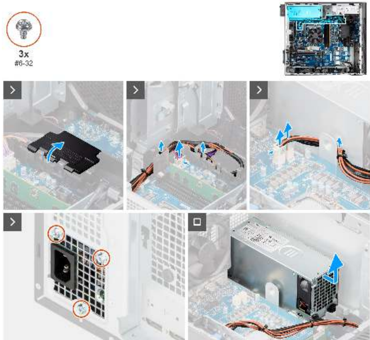
Abbildung 57. Entfernen des 360-W-Netzteils
