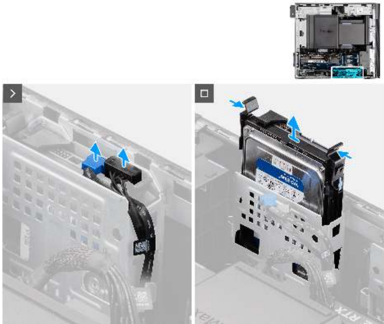
Abbildung 25. Entfernen der 3,5-Zoll-Festplattenbaugruppe aus Schacht 1
