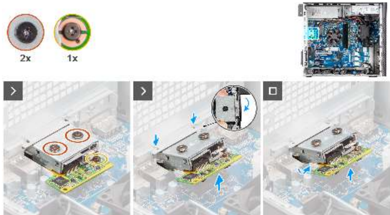
Abbildung 73. Entfernen des optionalen optischen 5-GbE-Moduls
