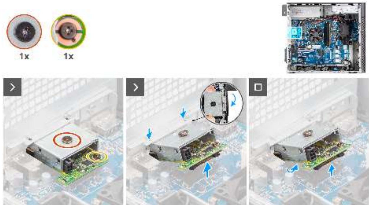
Abbildung 79. Entfernen des optionalen Thunderbolt-Moduls
