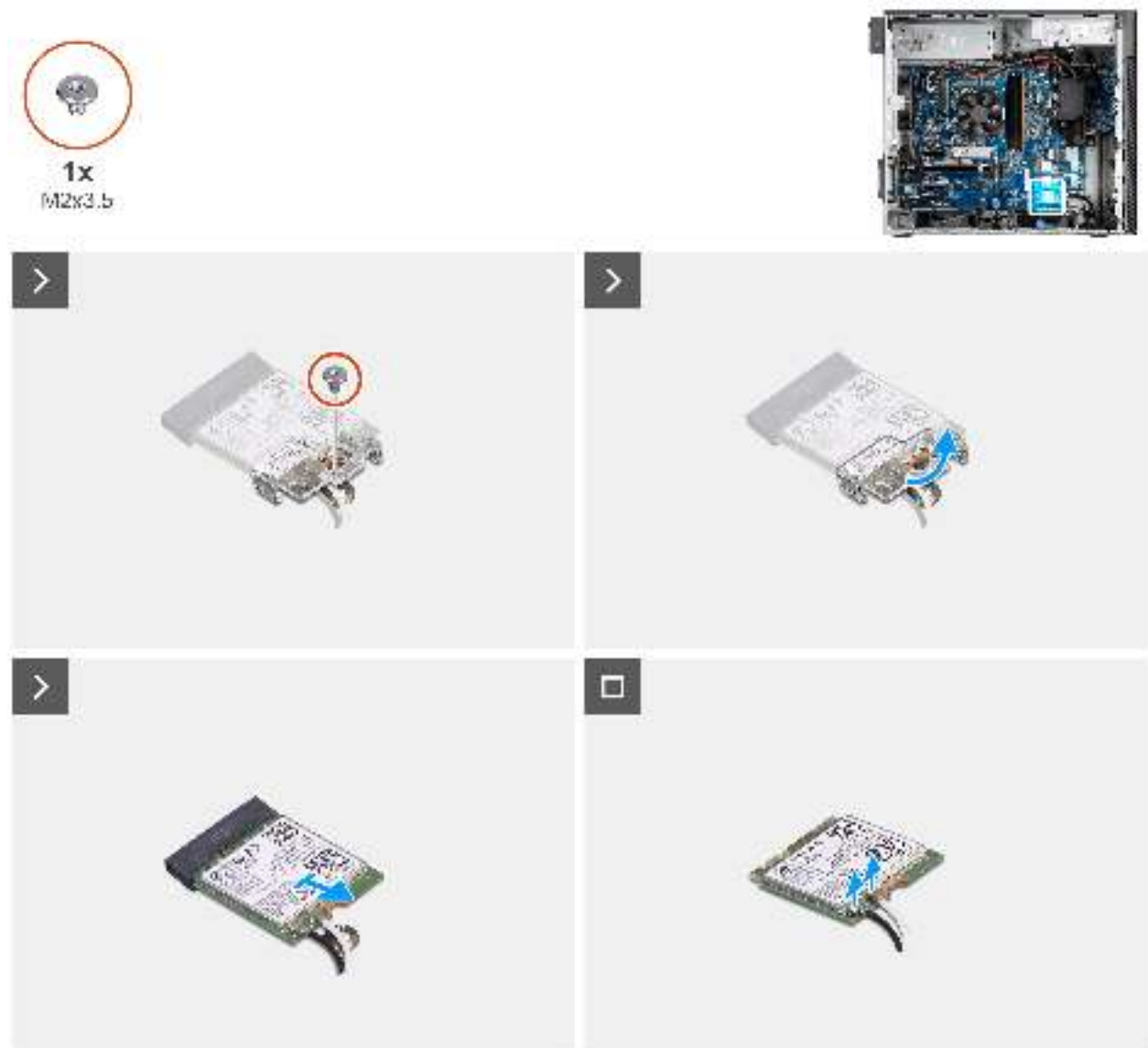
Abbildung 41. Entfernen der Wireless-Karte
