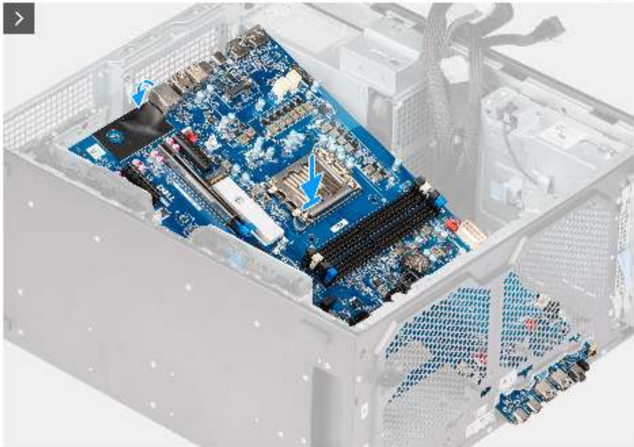
Abbildung 94. Einbauen der Systemplatine
