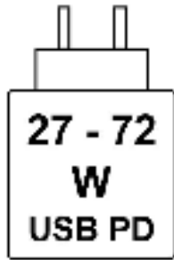
Abbildung 9. Piktogramm für die Anforderungen an die Stromversorgung
