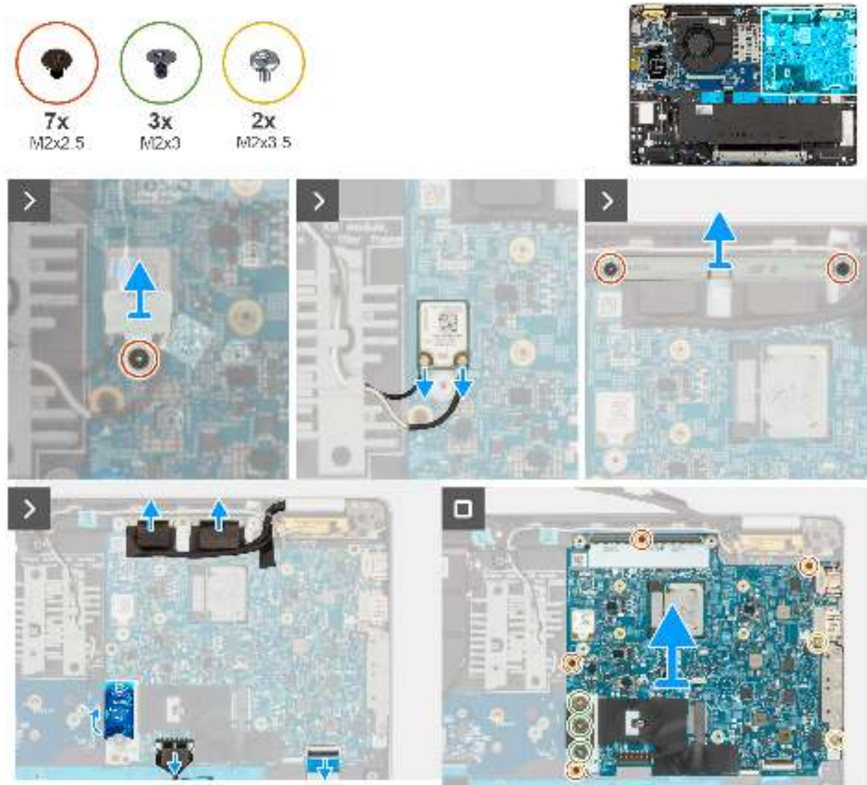
Abbildung 48. Entfernen der Systemplatine
