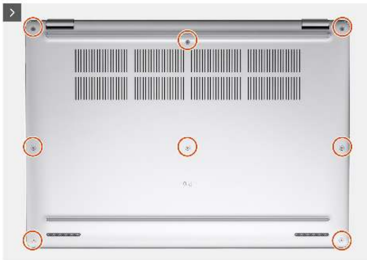
Abbildung 13. Entfernen der Bodenabdeckung
