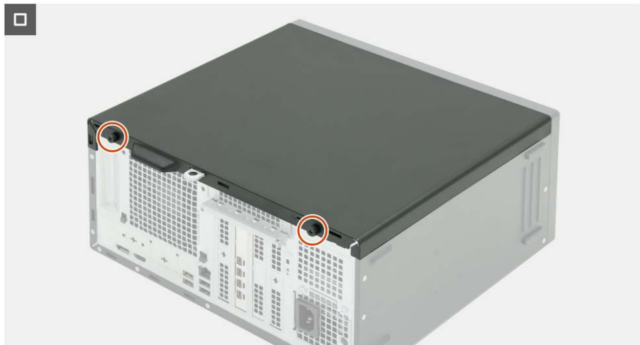
Abbildung 15. Installieren der linken Abdeckung
