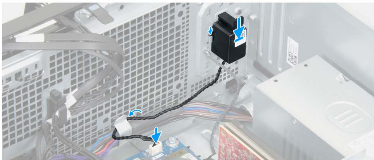
Abbildung 25. Einbauen des internen Lautsprechers
