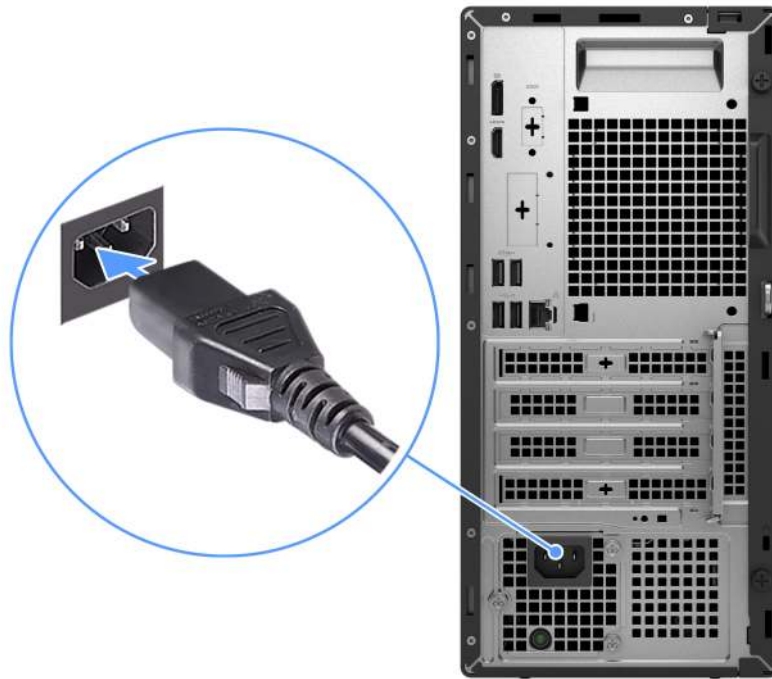
Abbildung 7. Anschließen des Stromkabels
