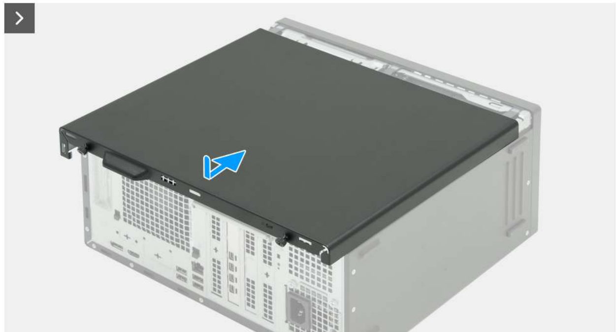
Abbildung 14. Installieren der linken Abdeckung
