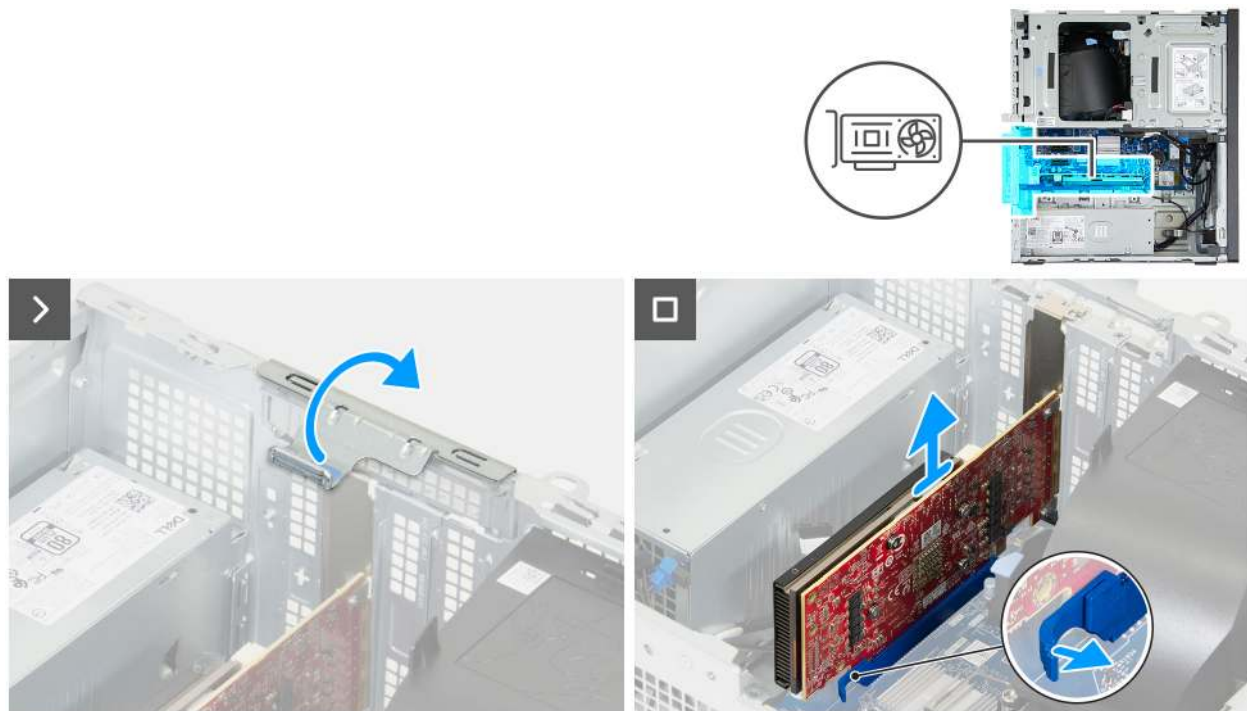
Abbildung 33. Entfernen der Grafikkarte
