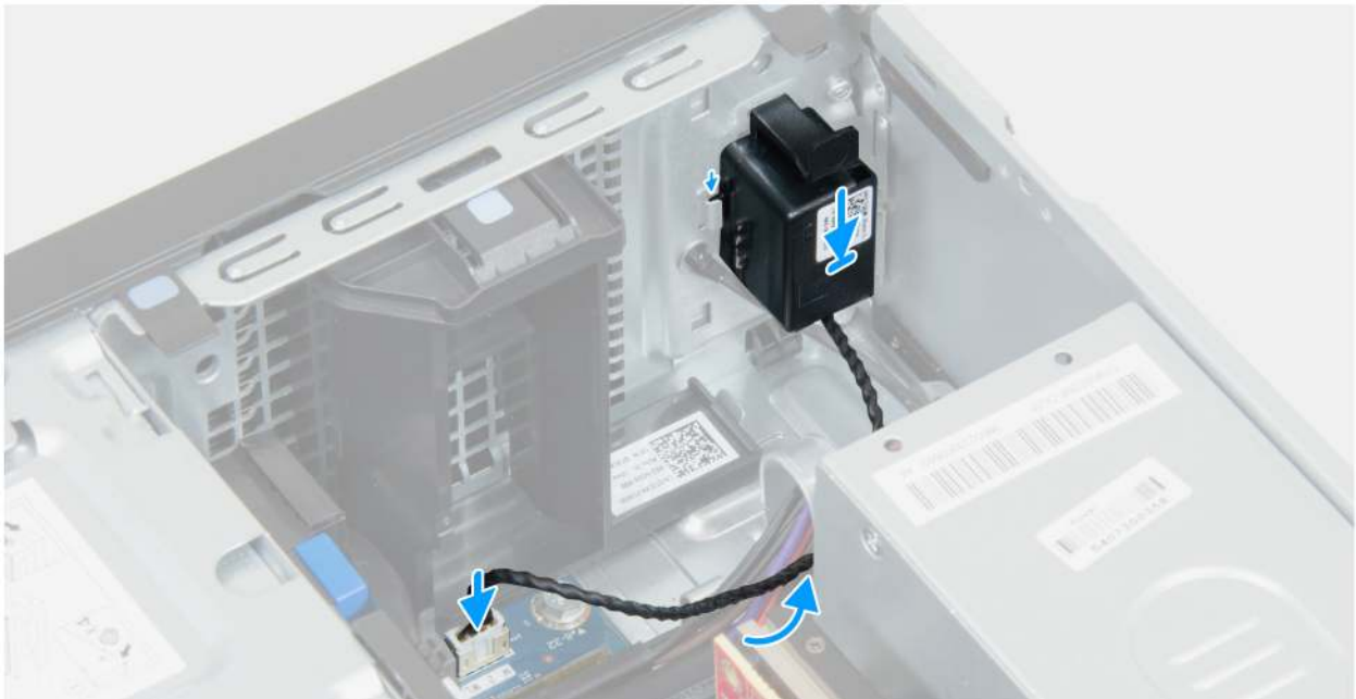
Abbildung 19. Einbauen des internen Lautsprechers
