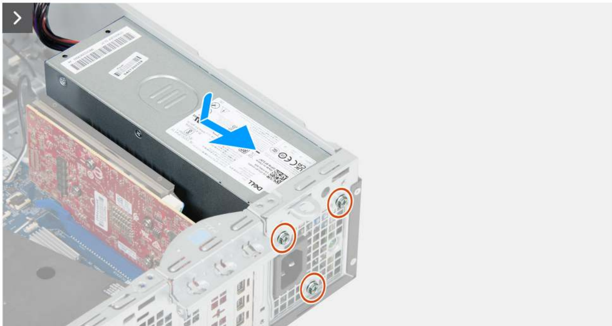
Abbildung 49. Installieren der Stromversorgungseinheit
