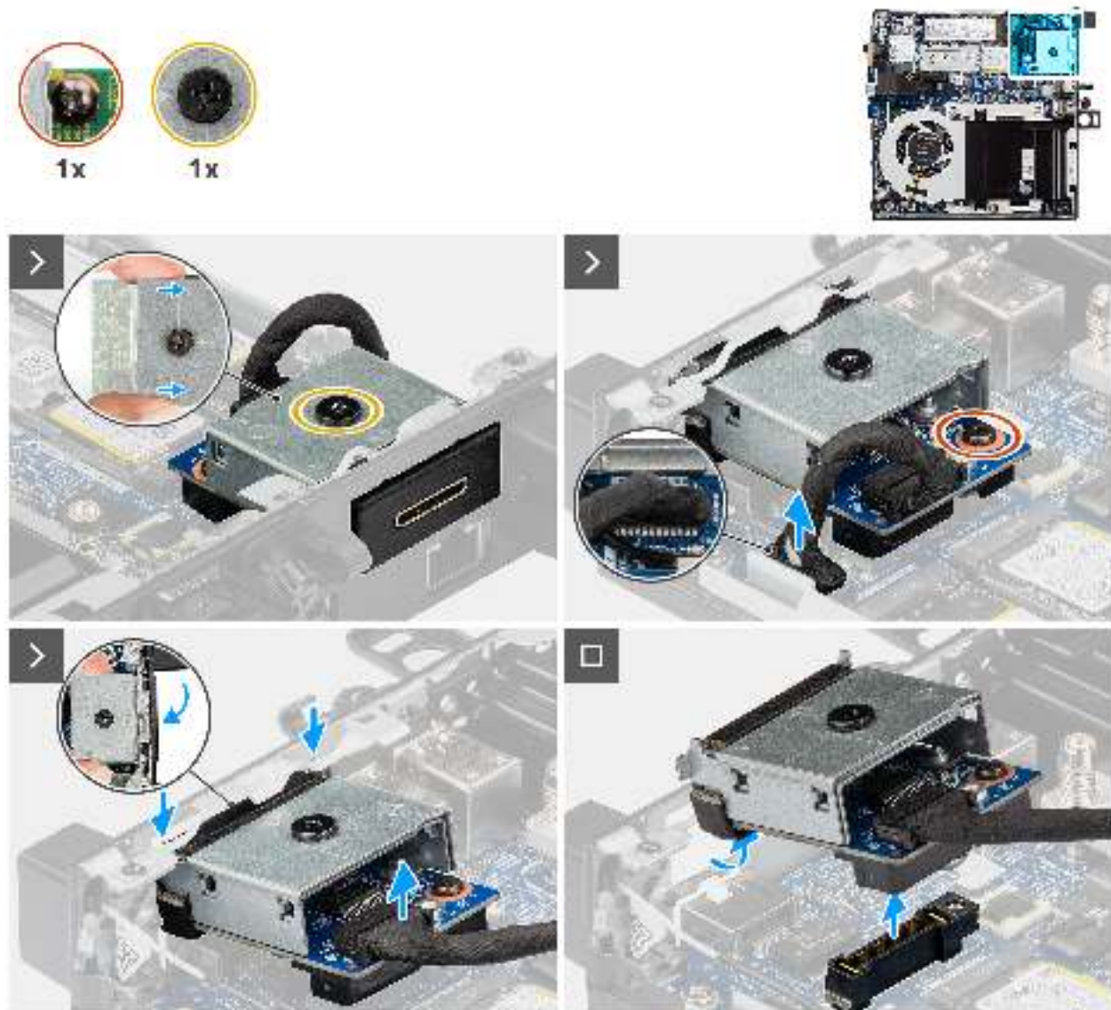
Abbildung 53. Entfernen des PS2-Anschlussmoduls
