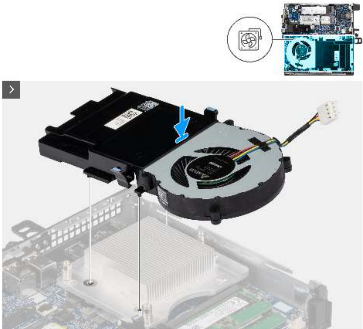
Abbildung 30. Einbauen des Lüfters
