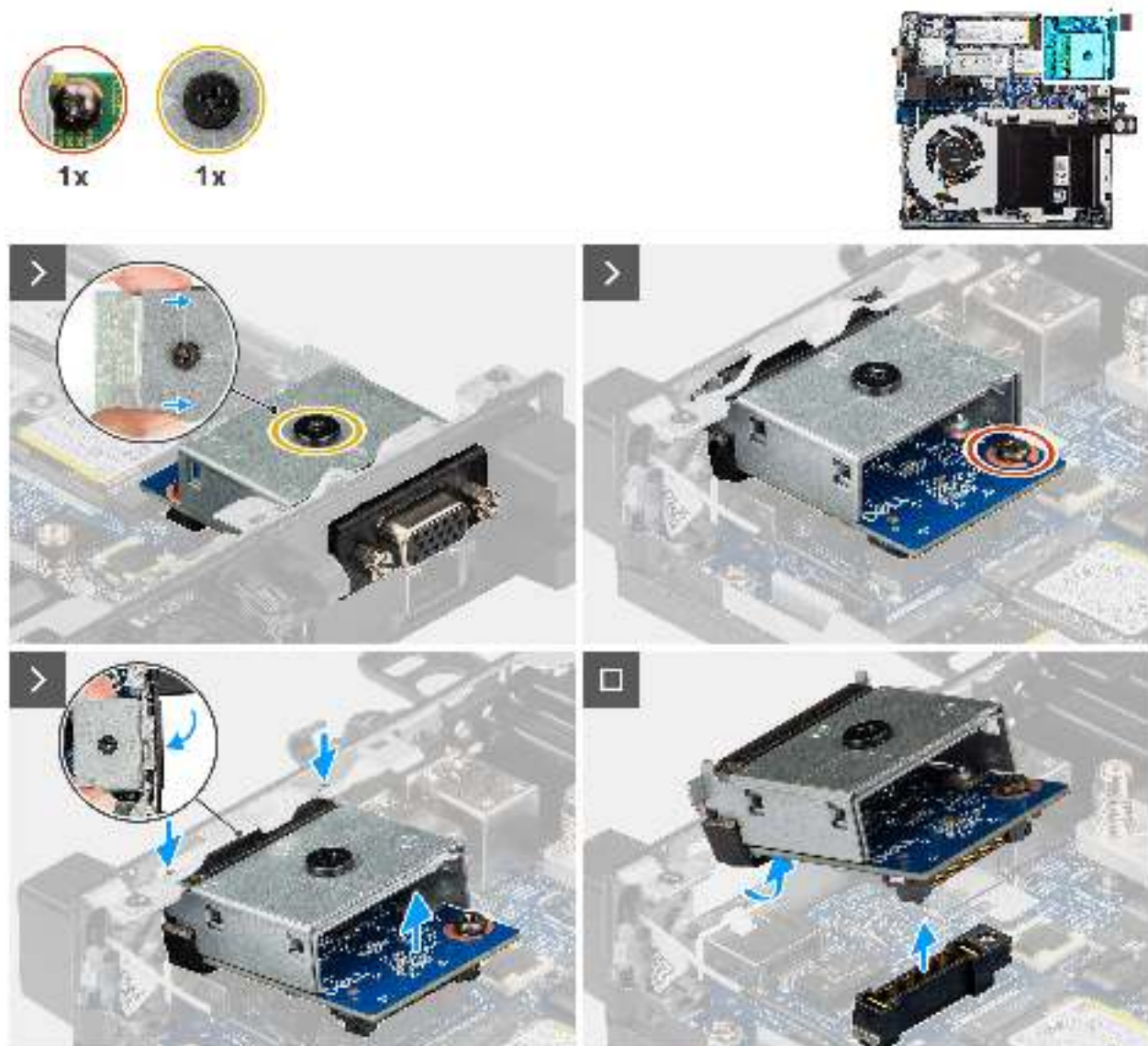
Abbildung 50. Entfernen des VGA-Anschlussmoduls
