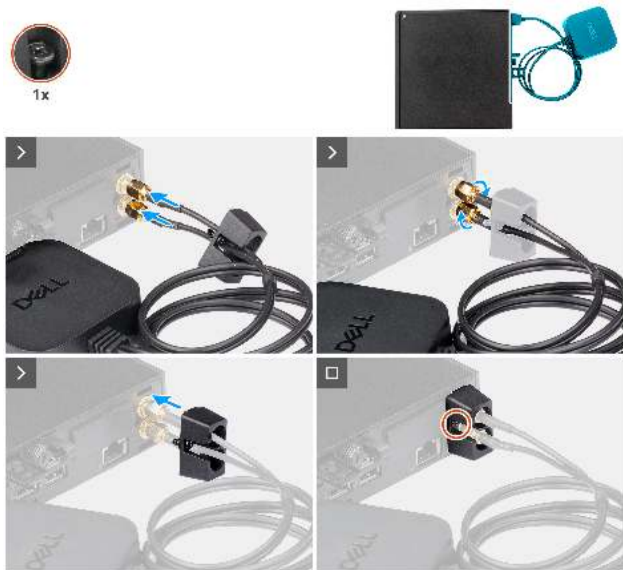
Abbildung 35. Einbauen der externen Puck-Antenne
