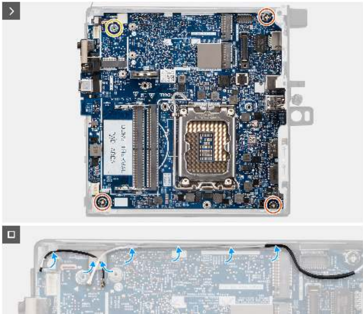
Abbildung 79. Einbauen der Systemplatine
