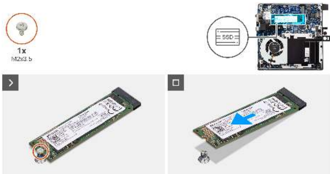
Abbildung 19. Entfernen des M.2-2280-Solid-State-Laufwerks
