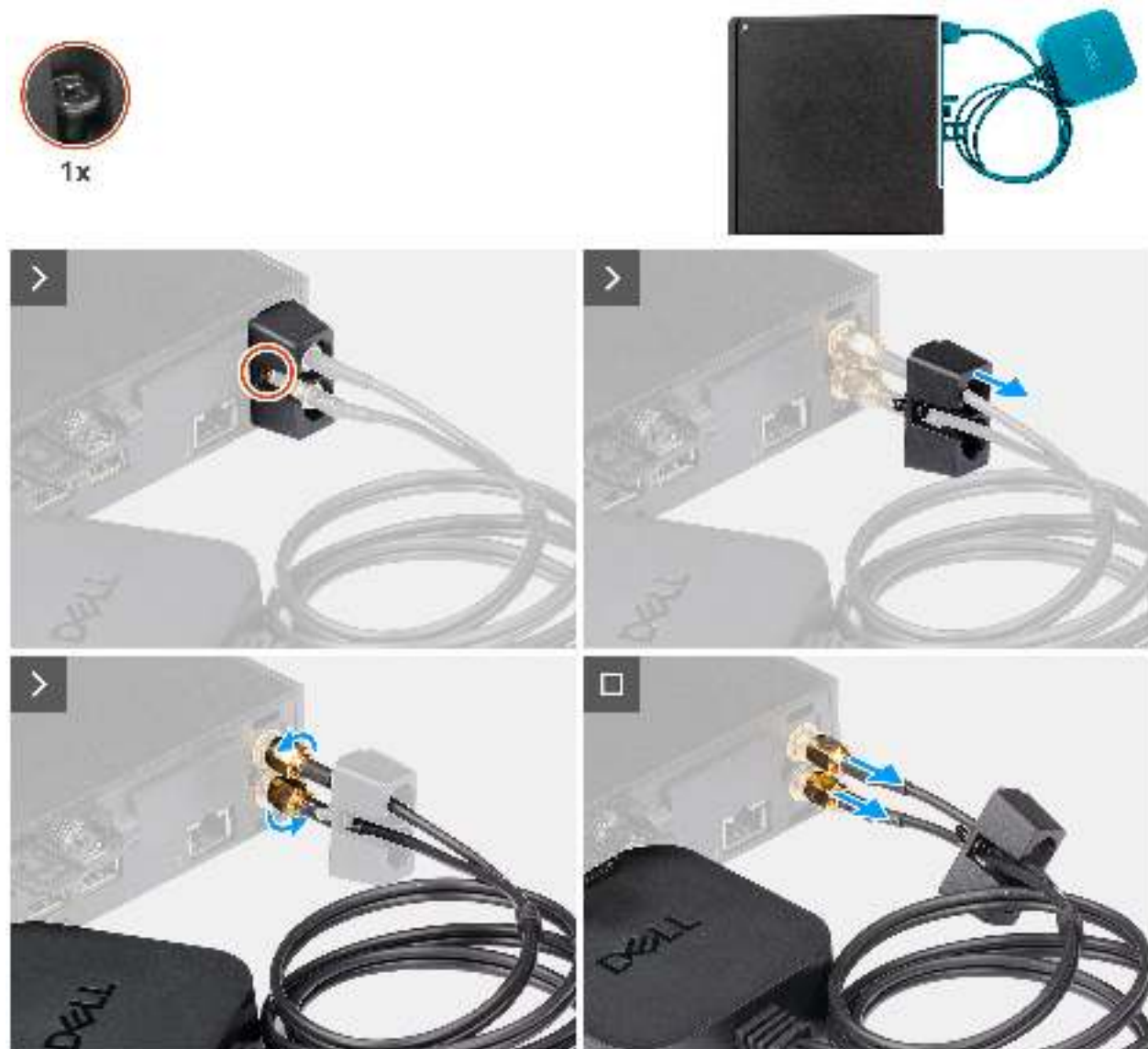
Abbildung 34. Entfernen der externen Puck-Antenne
