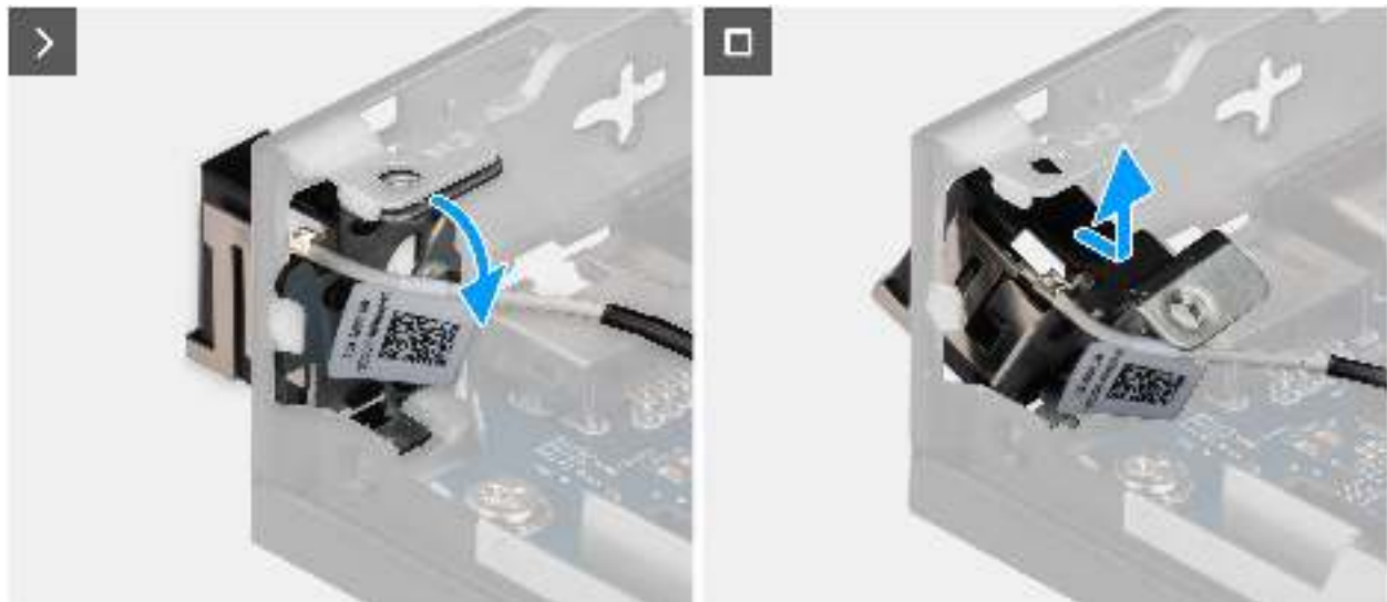
Abbildung 67. Entfernen des Antennenmoduls (weißes Kabel)
