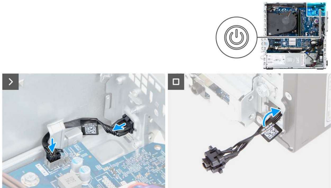
Abbildung 44. Installieren des Netzschalters
