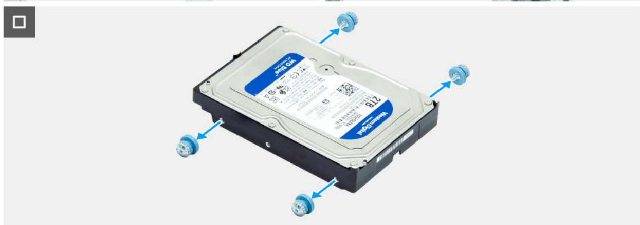
Abbildung 39. Entfernen der Festplatte
