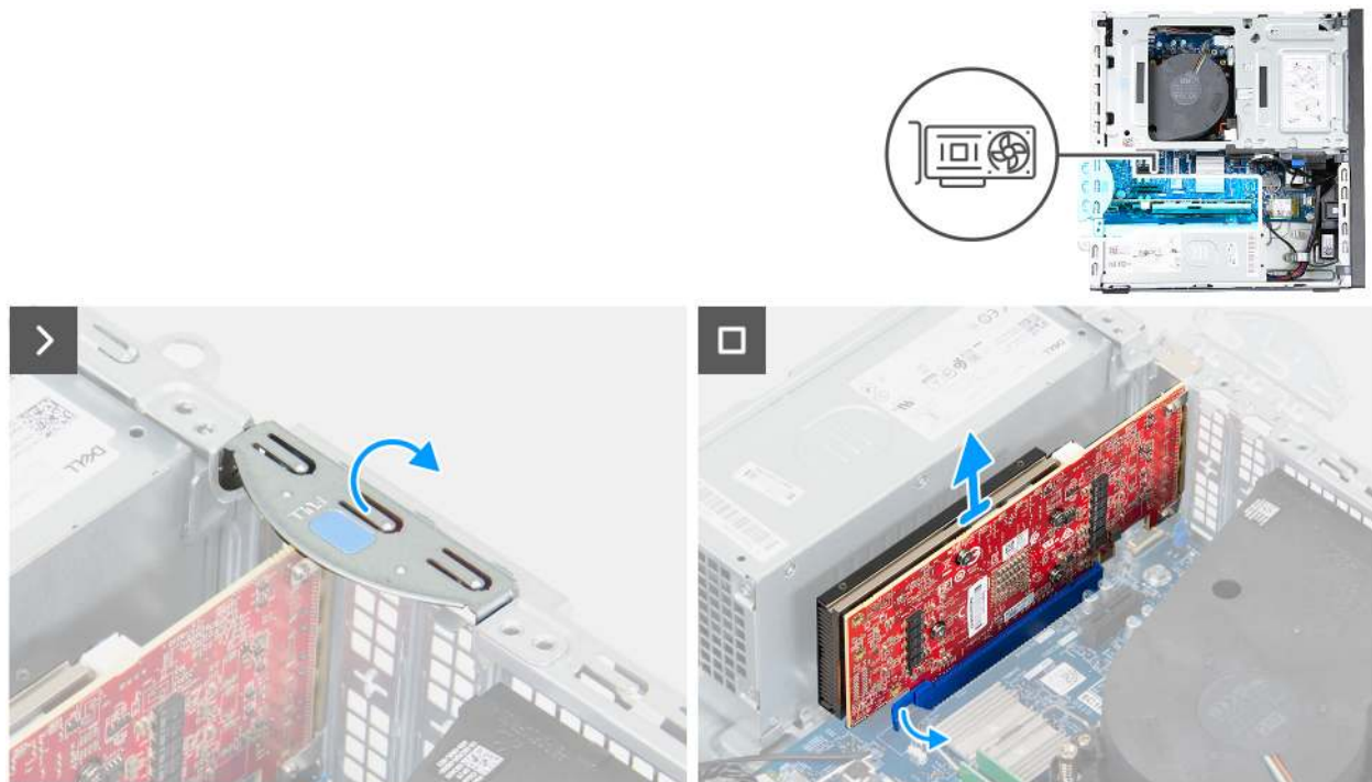
Abbildung 27. Entfernen der Grafikkarte
