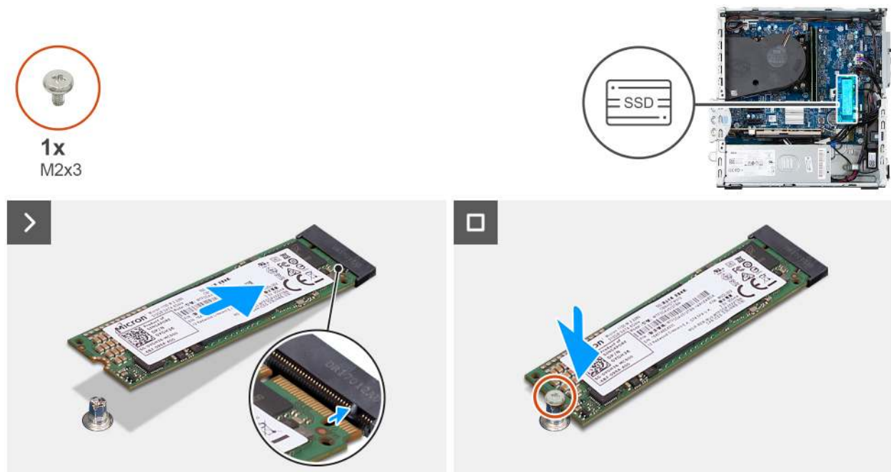
Abbildung 25. Installieren des M.2 2280-Solid-State-Laufwerks
