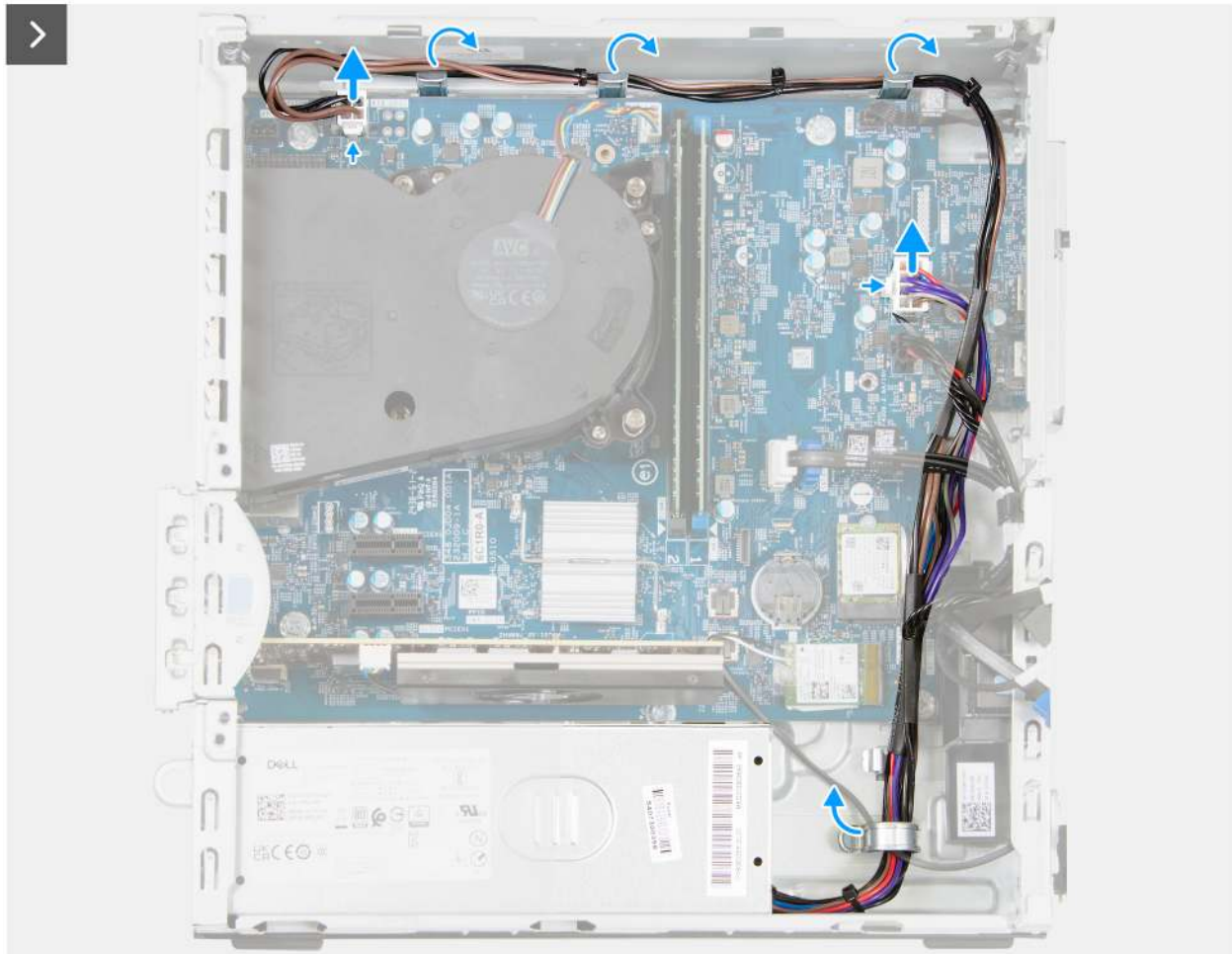
Abbildung 47. Entfernen der Stromversorgungseinheit
