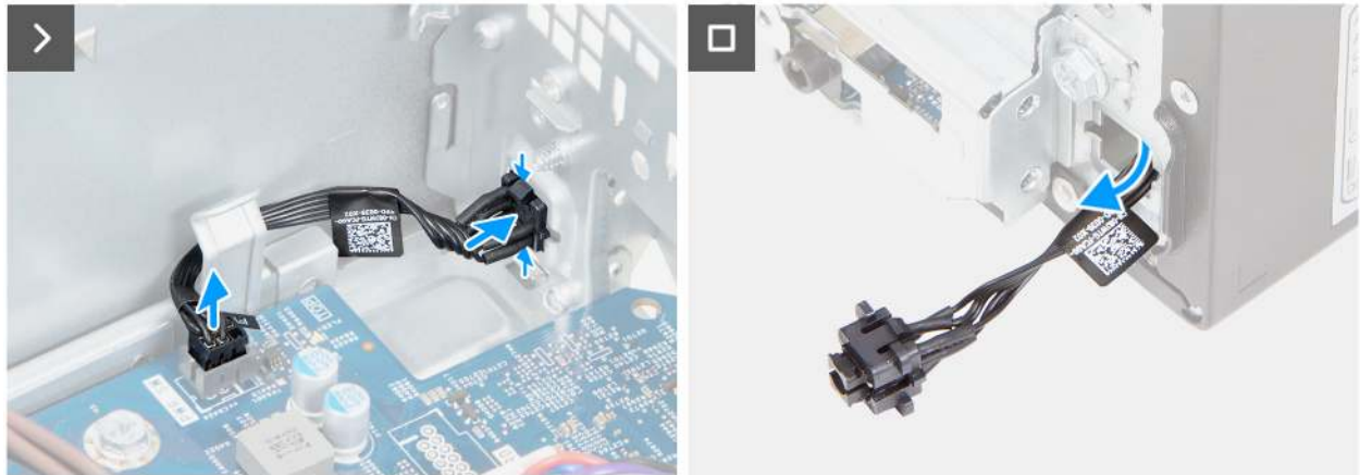
Abbildung 43. Entfernen des Netzschalters
