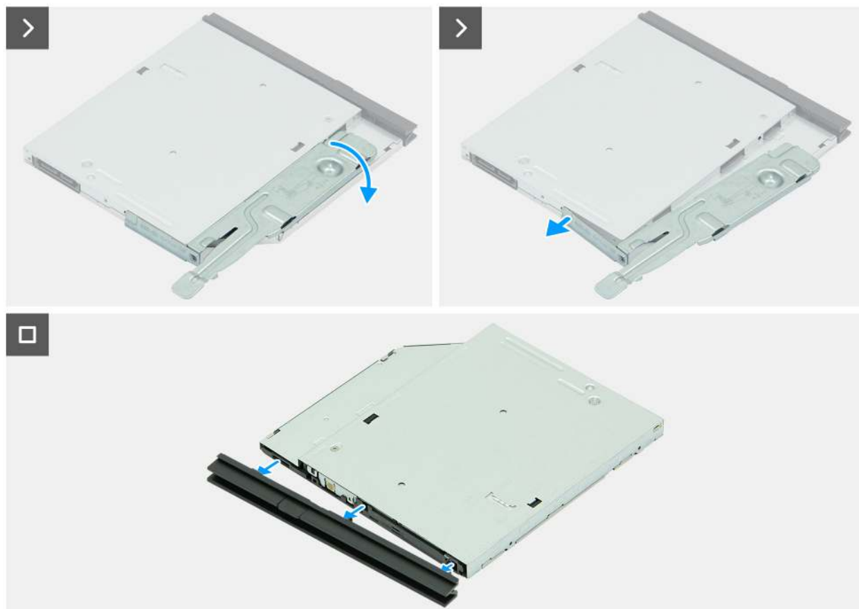
Abbildung 32. Entfernen des optischen Laufwerks
