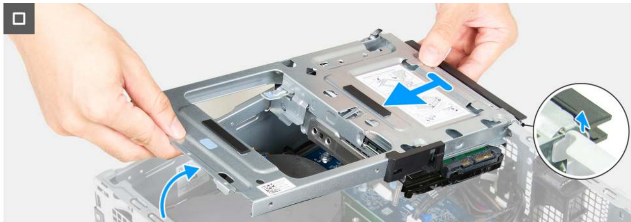
Abbildung 36. Entfernen des Laufwerksschachts
