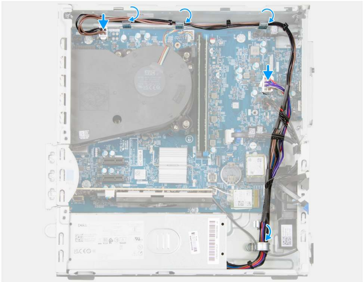
Abbildung 50. Installieren der Stromversorgungseinheit
