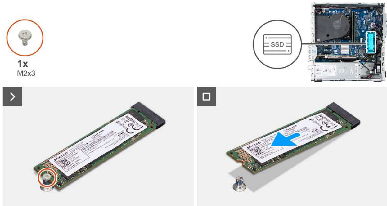
Abbildung 24. Entfernen des M.2-2280-Solid-State-Laufwerks
