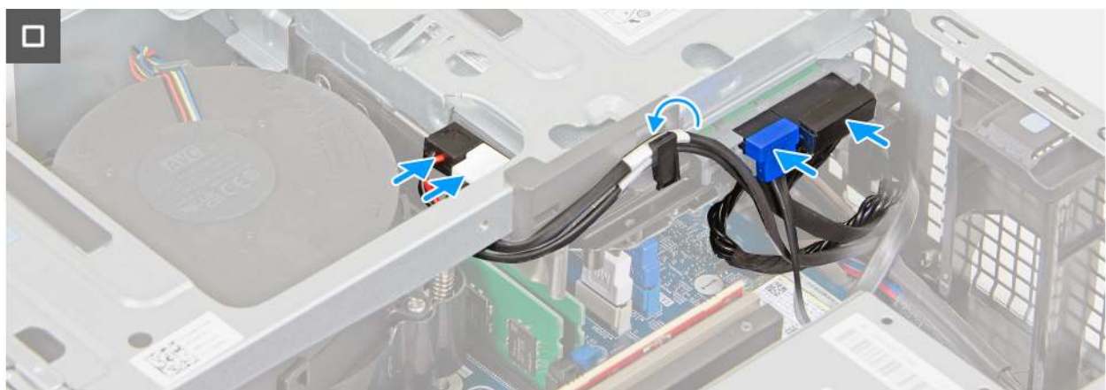
Abbildung 38. Installieren des Laufwerksschachts
