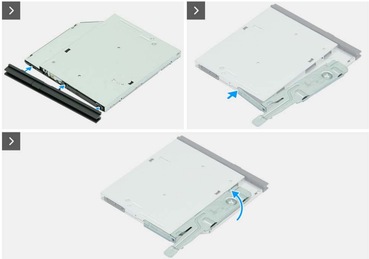
Abbildung 33. Installieren des optischen Laufwerks
