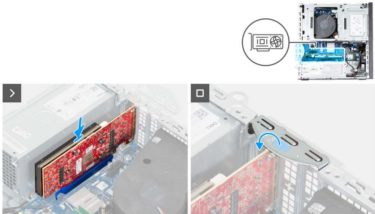
Abbildung 28. Installieren der Grafikkarte
