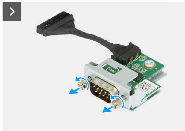
Abbildung 57. Installieren des seriellen Anschlussmoduls
