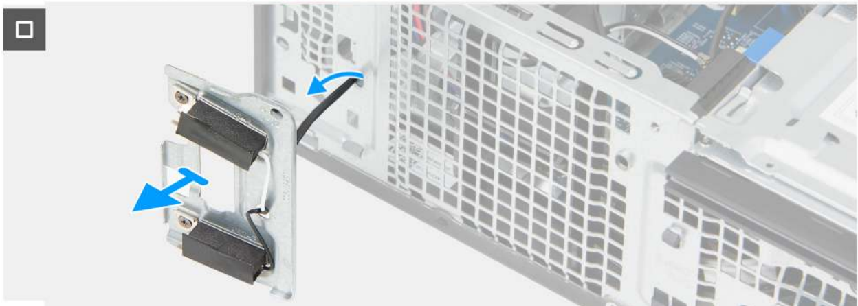
Abbildung 45. Entfernen der Antennenmodule
