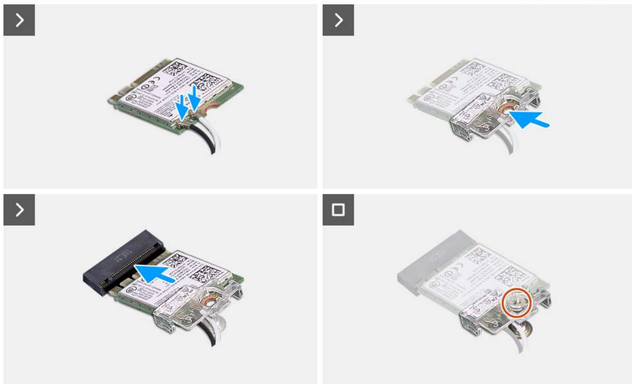
Abbildung 30. Installieren der Wireless-Karte
