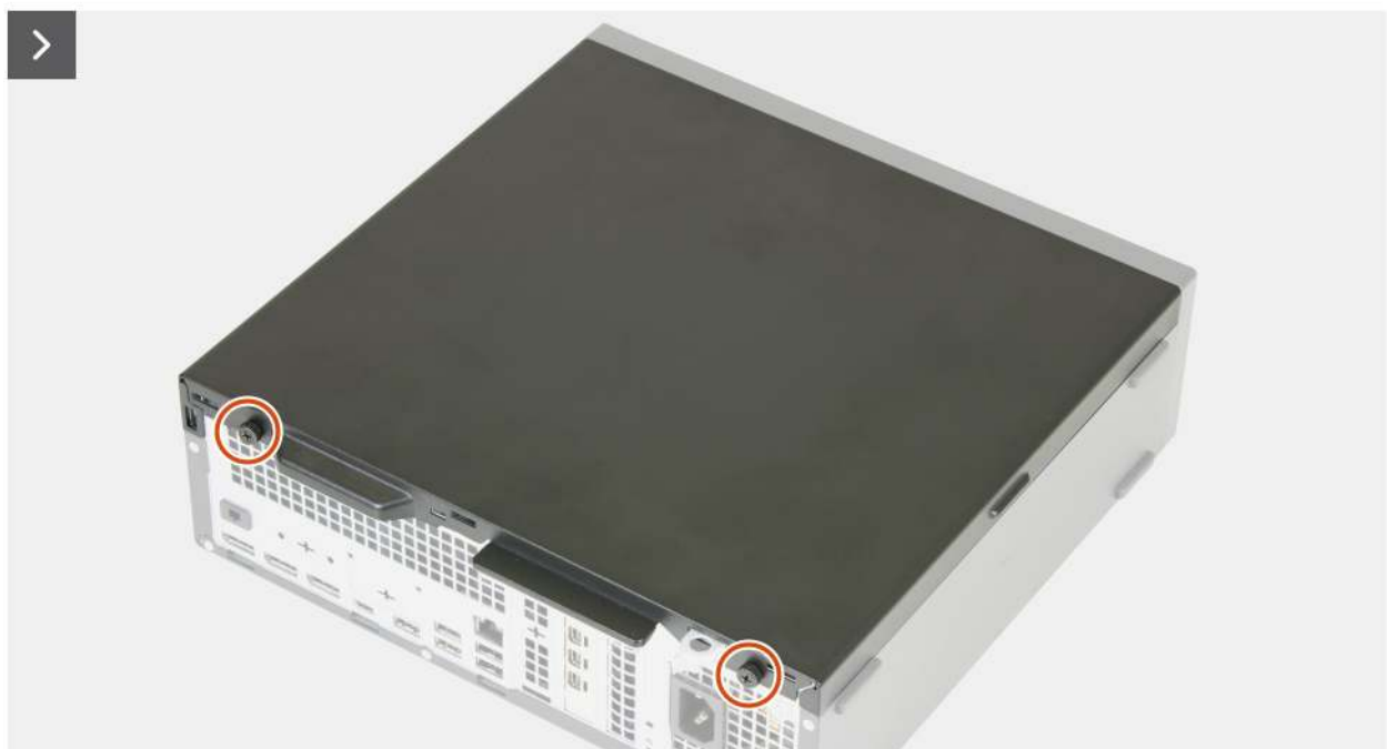
Abbildung 6. Entfernen der Seitenabdeckung
