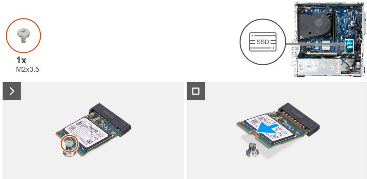
Abbildung 22. Entfernen des M.2-2230-Solid-State-Laufwerks
