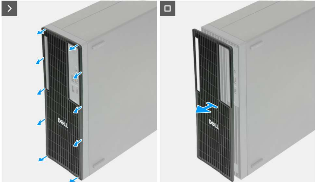
Abbildung 14. Entfernen des Staubfilters
