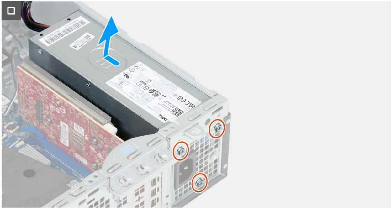
Abbildung 48. Entfernen der Stromversorgungseinheit
