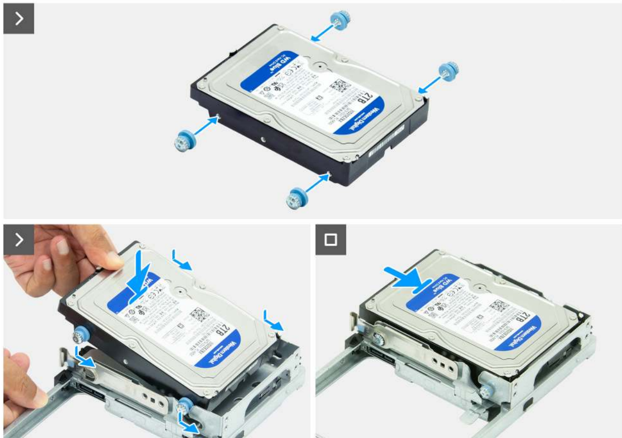
Abbildung 40. Einsetzen des Festplattenlaufwerks
