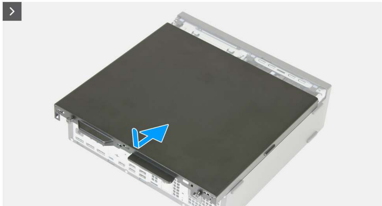
Abbildung 8. Anbringen der Seitenabdeckung
