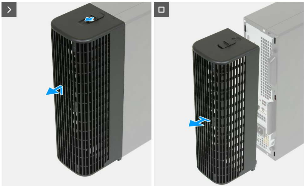
Abbildung 4. Entfernen der Kabelabdeckung
