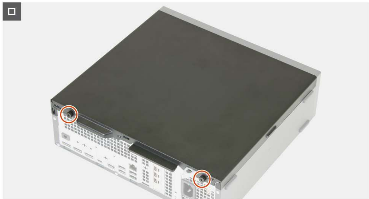
Abbildung 9. Anbringen der Seitenabdeckung
