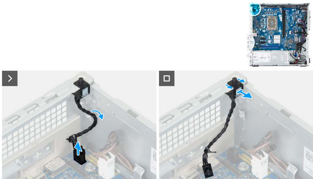
Abbildung 41. Entfernen des Eingriffsschalters
