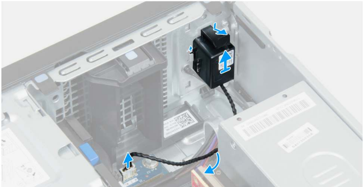
Abbildung 18. Entfernen des internen Lautsprechers
