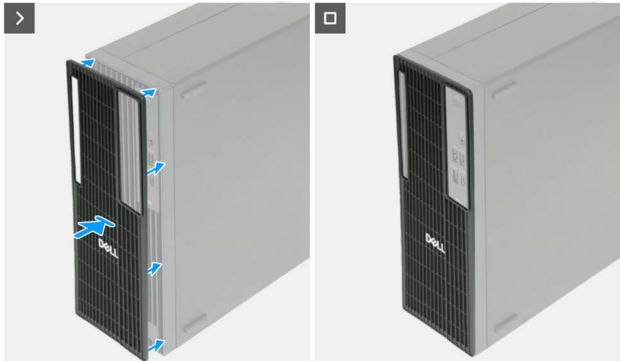
Abbildung 15. Installieren des Staubfilters
