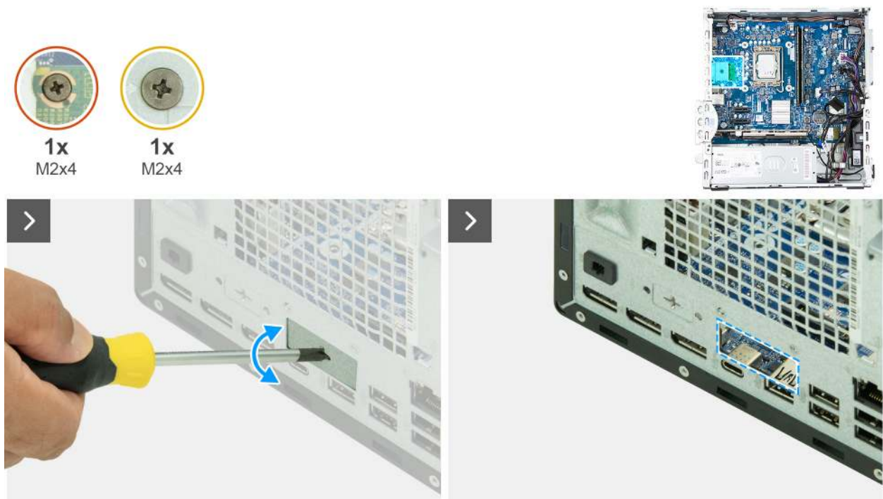
Abbildung 54. Installieren des optionalen Anschlussmoduls
