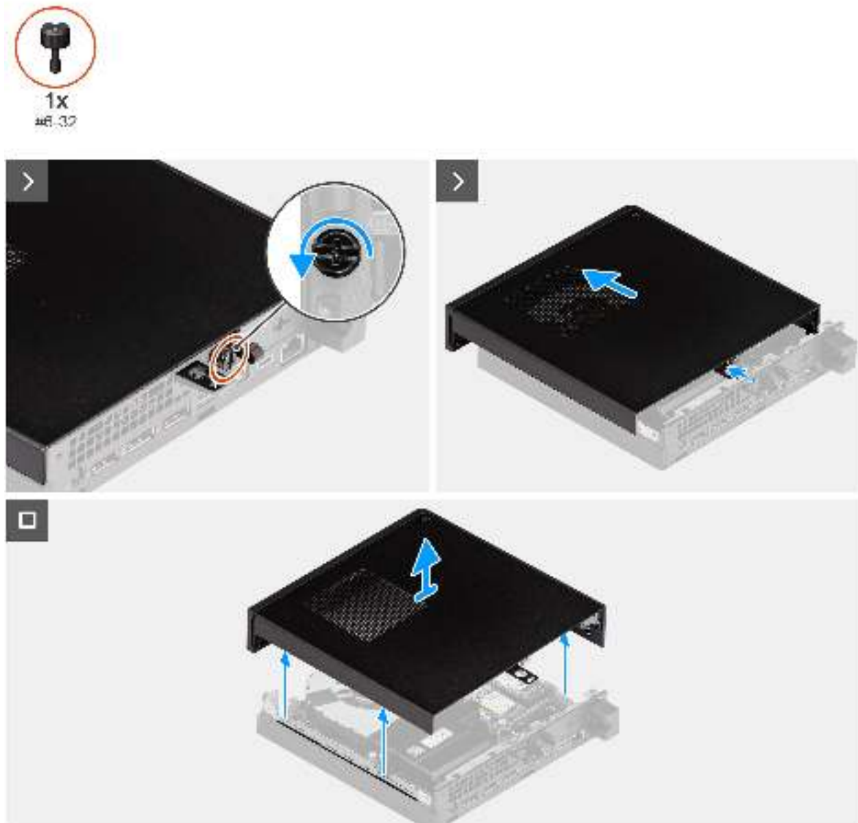
Abbildung 10. Entfernen der Seitenabdeckung
