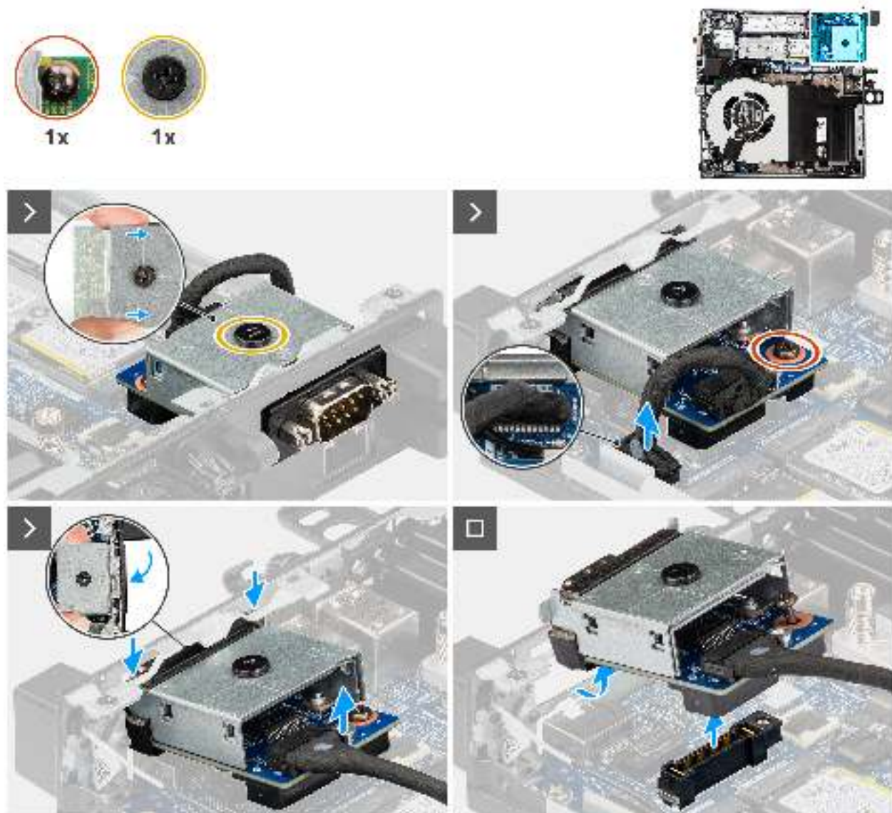
Abbildung 59. Entfernen des seriellen Anschlussmoduls
