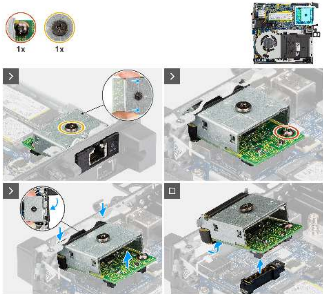
Abbildung 65. Entfernen des RJ45-Ethernet-Anschlussmoduls
