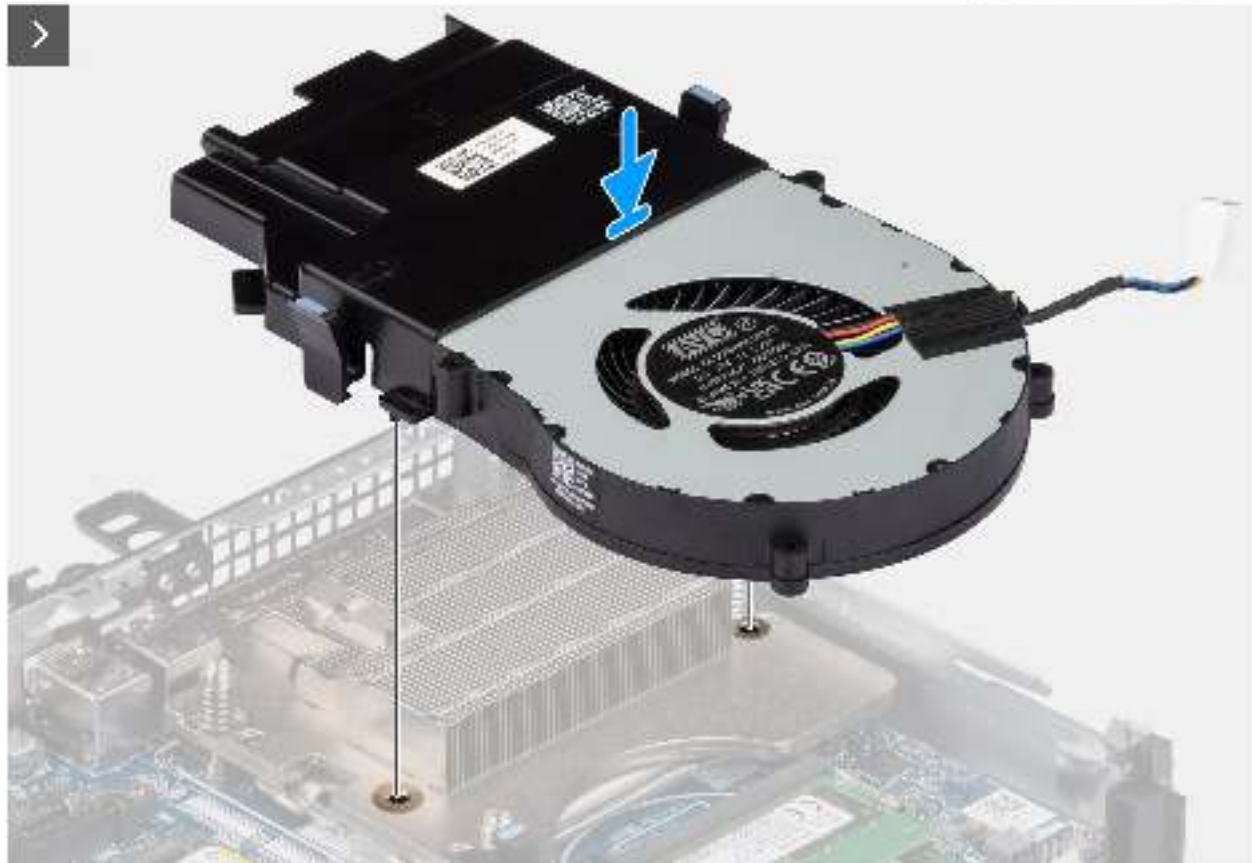
Abbildung 30. Einbauen des Lüfters
