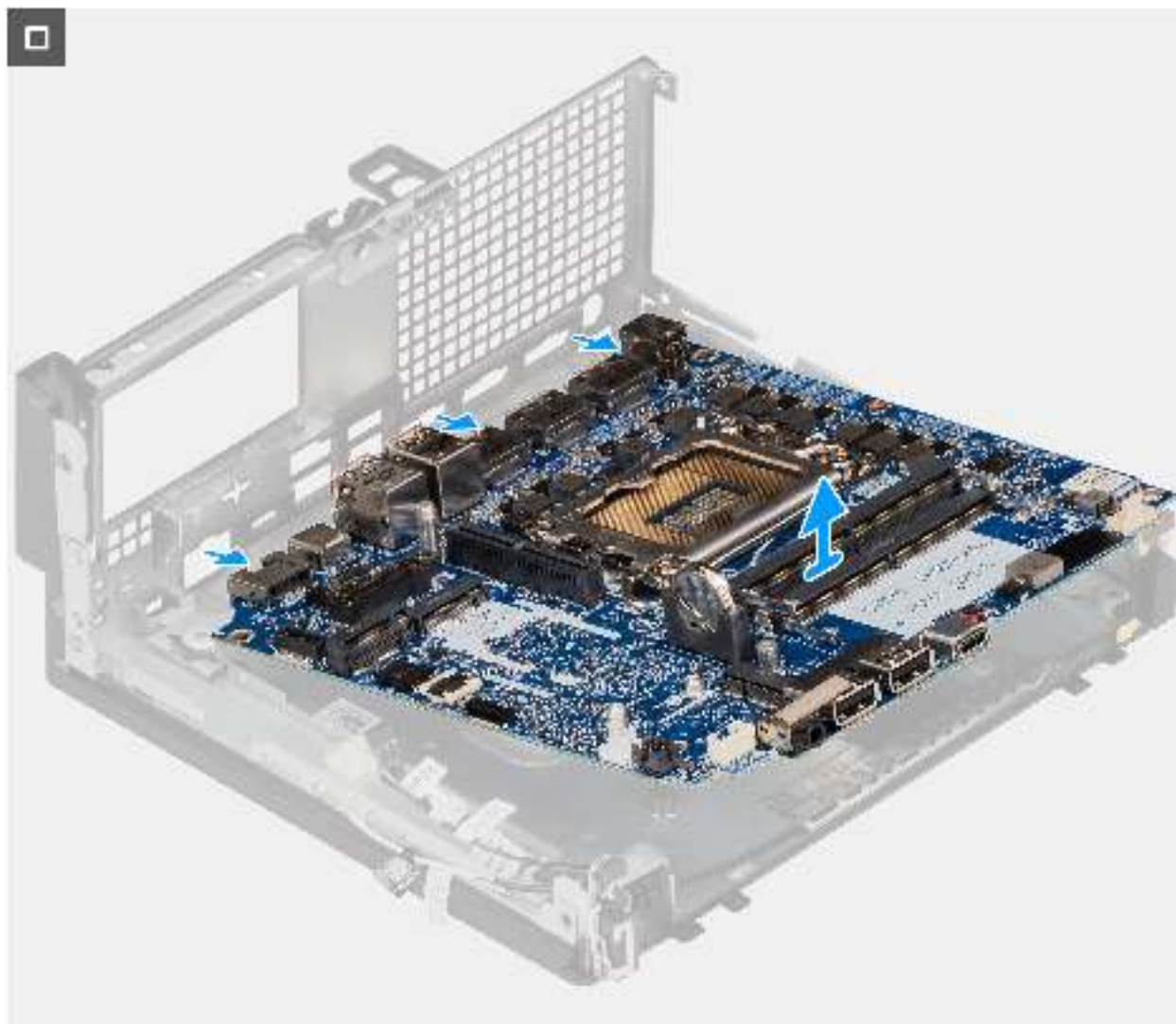
Abbildung 52. Entfernen der Systemplatine
