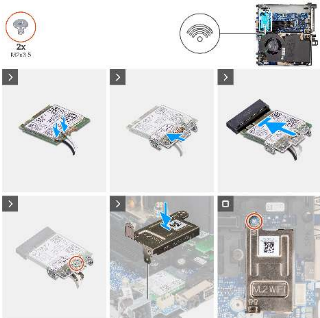
Abbildung 26. Installieren der Wireless-Karte
