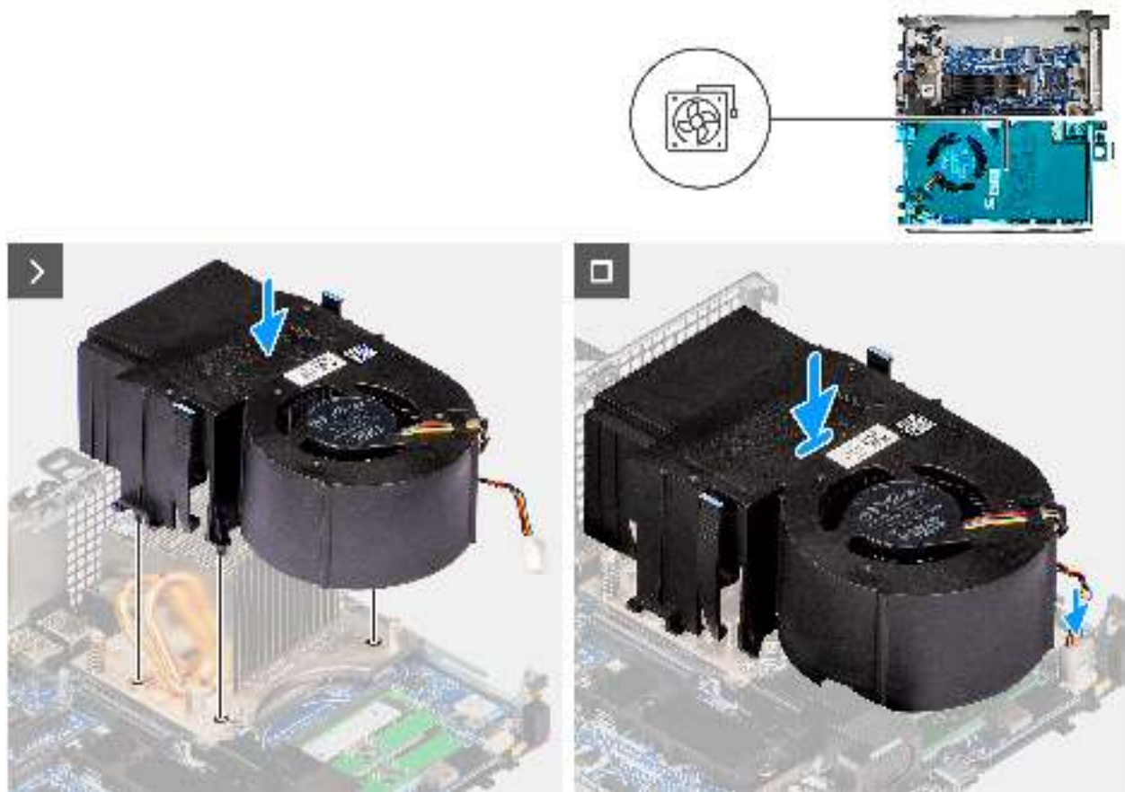
Abbildung 16. Einbauen des Systemlüfters
