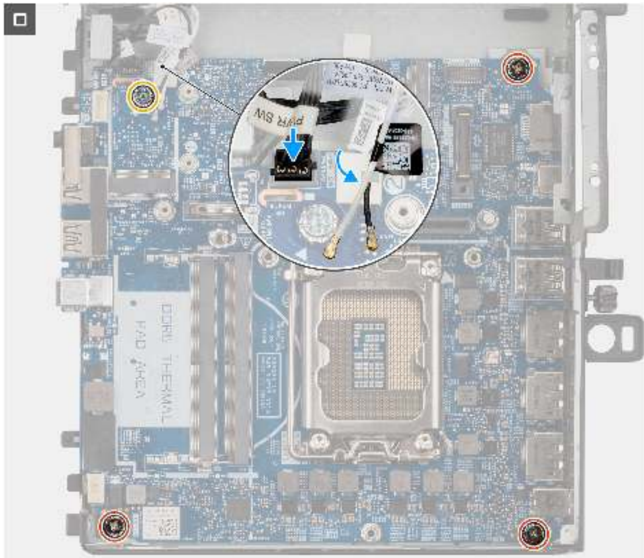
Abbildung 55. Einbauen der Systemplatine
