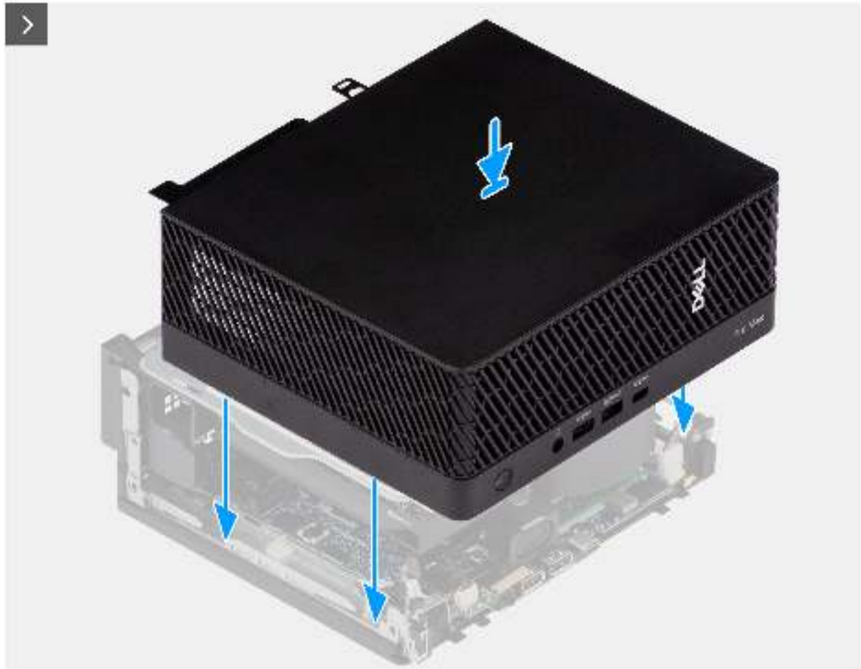
Abbildung 5. Anbringen der Seitenabdeckung
