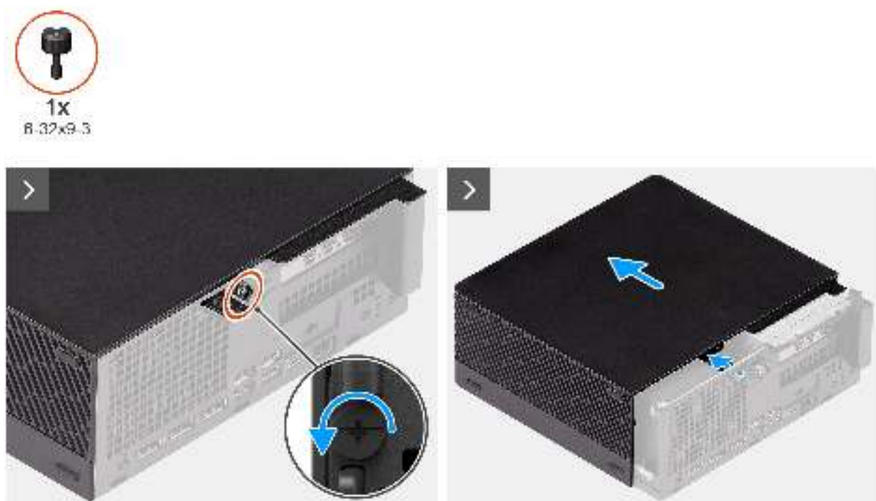
Abbildung 3. Entfernen der Seitenabdeckung
