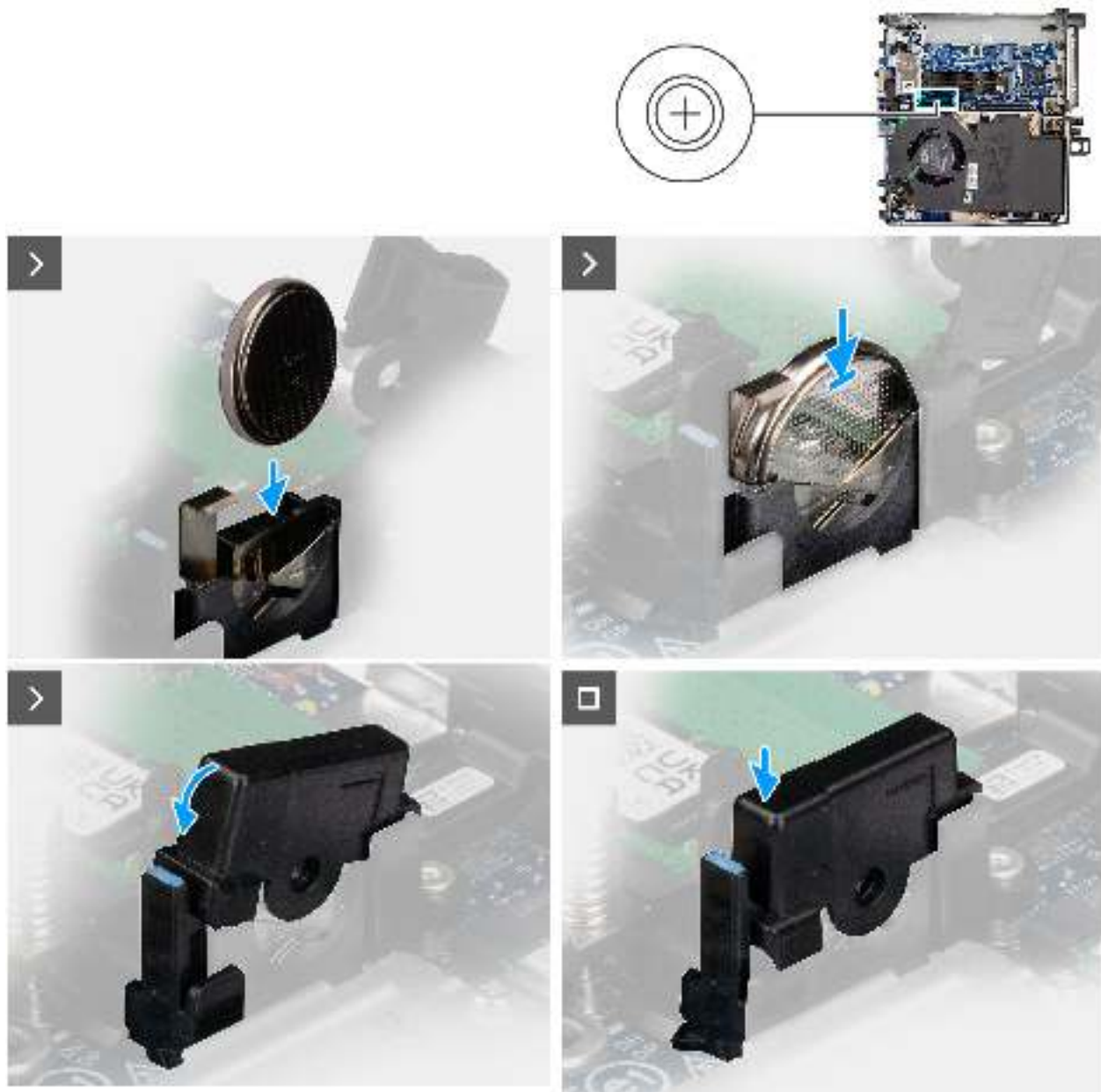
Abbildung 8. Einsetzen der Knopfzellenbatterie
