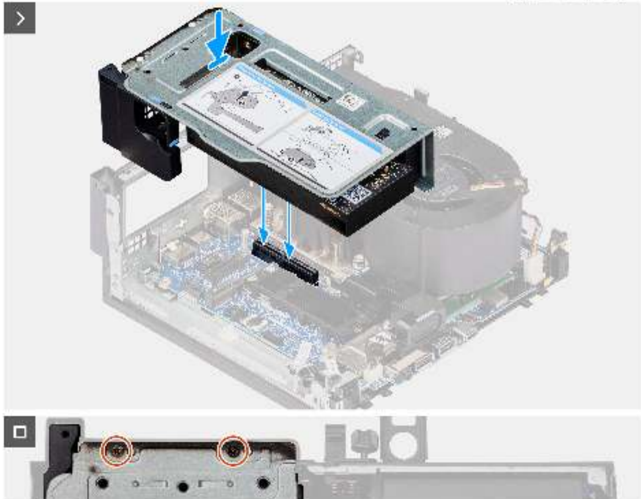
Abbildung 10. Einbauen des Riser-Kartenmoduls
