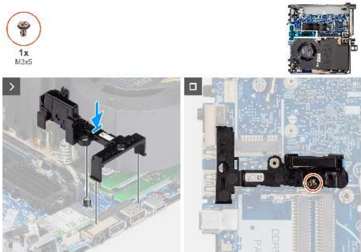
Abbildung 30. Einbauen der Lautsprecherbauhalterung
