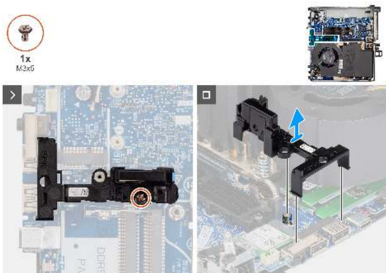
Abbildung 29. Entfernen der Lautsprecherbauhalterung
