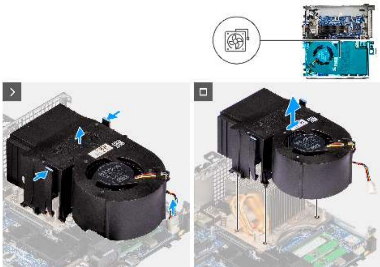
Abbildung 15. Entfernen des Systemlüfters
