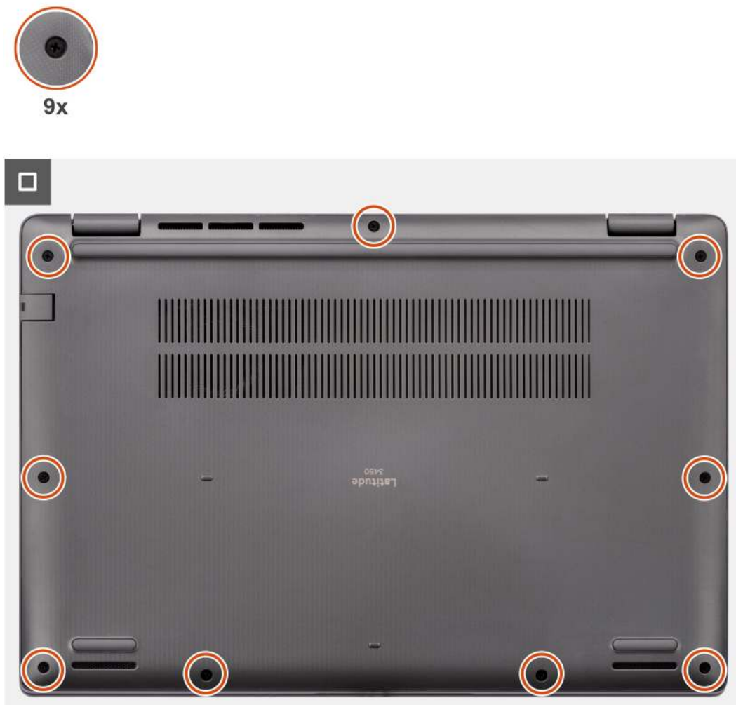
Abbildung 12. Anbringen der Bodenabdeckung
