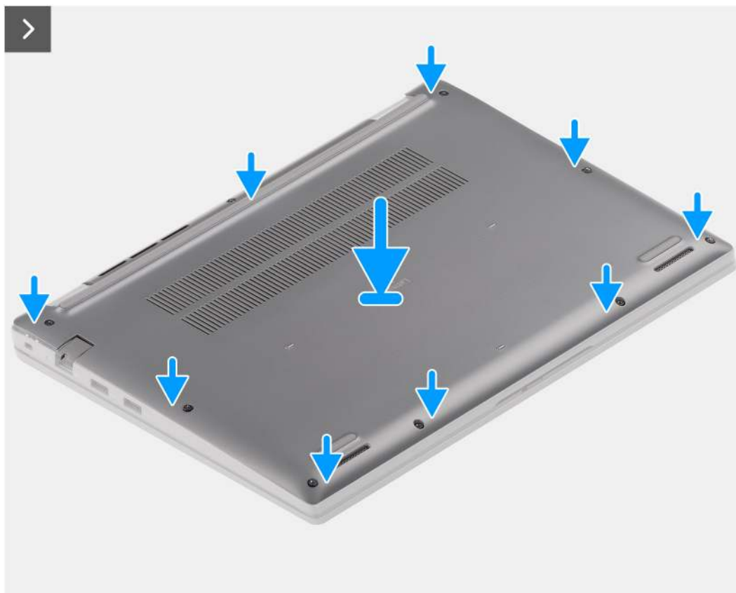
Abbildung 11. Anbringen der Bodenabdeckung
