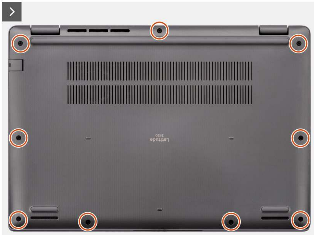
Abbildung 9. Entfernen der Bodenabdeckung
