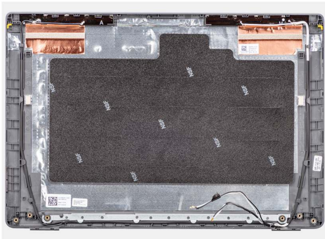
Abbildung 69. Entfernen der hinteren Bildschirmabdeckung
