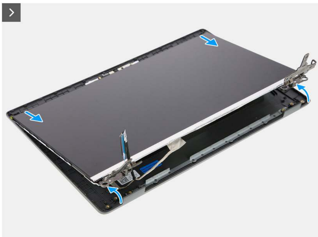
Abbildung 56. Entfernen des Bildschirms
