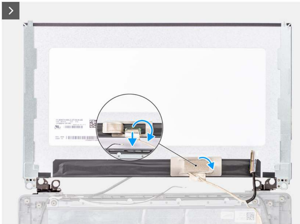
Abbildung 57. Entfernen des Bildschirms
