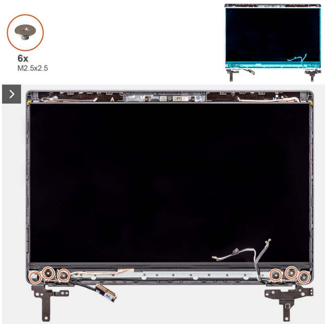
Abbildung 54. Entfernen des Bildschirms
