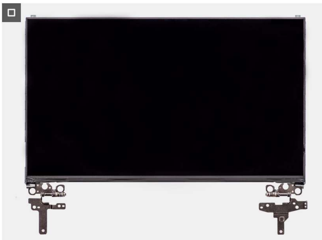
Abbildung 58. Entfernen des Bildschirms
