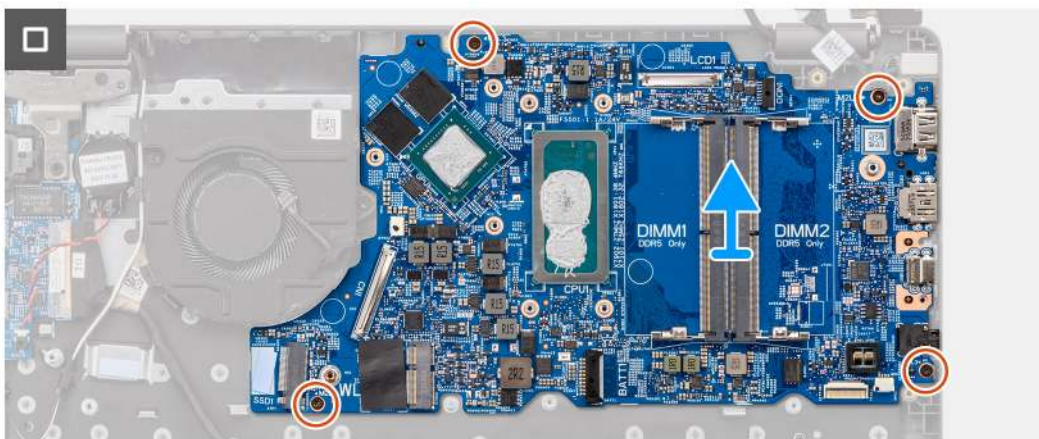
Abbildung 42. Entfernen der Hauptplatine
