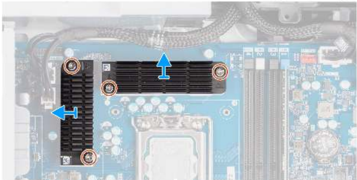
Abbildung 65. Entfernen des VR-Kühlkörpers
