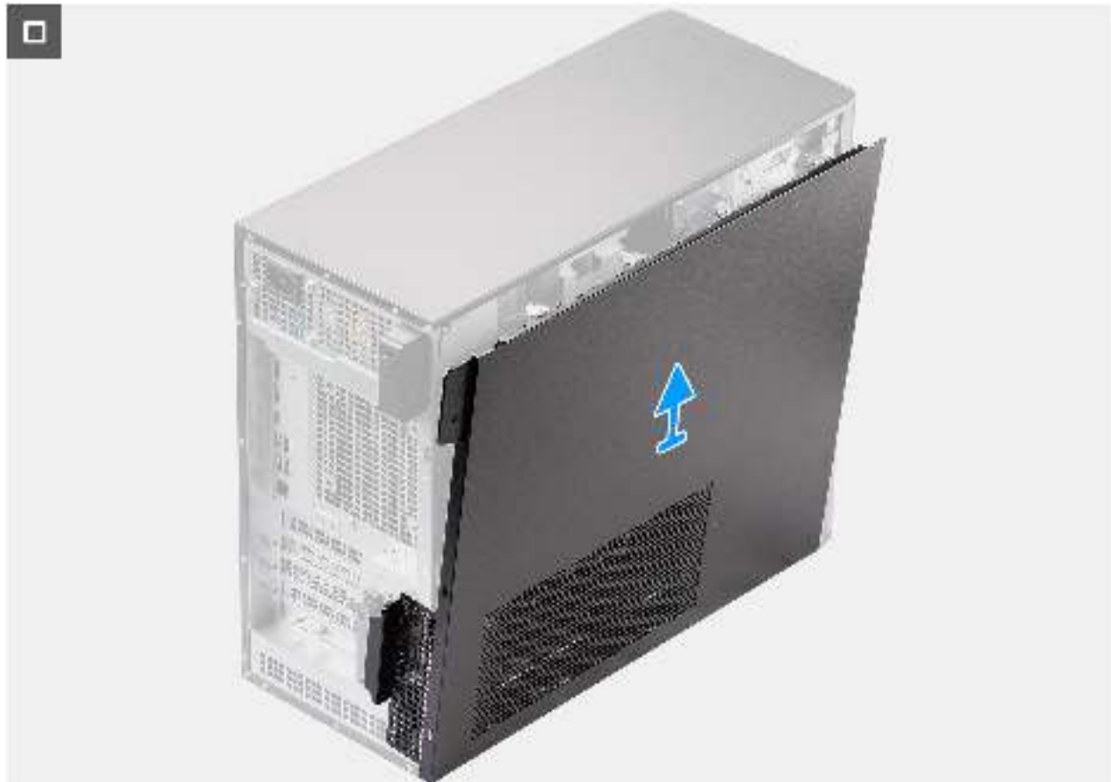
Abbildung 10. Entfernen der Seitenabdeckung
