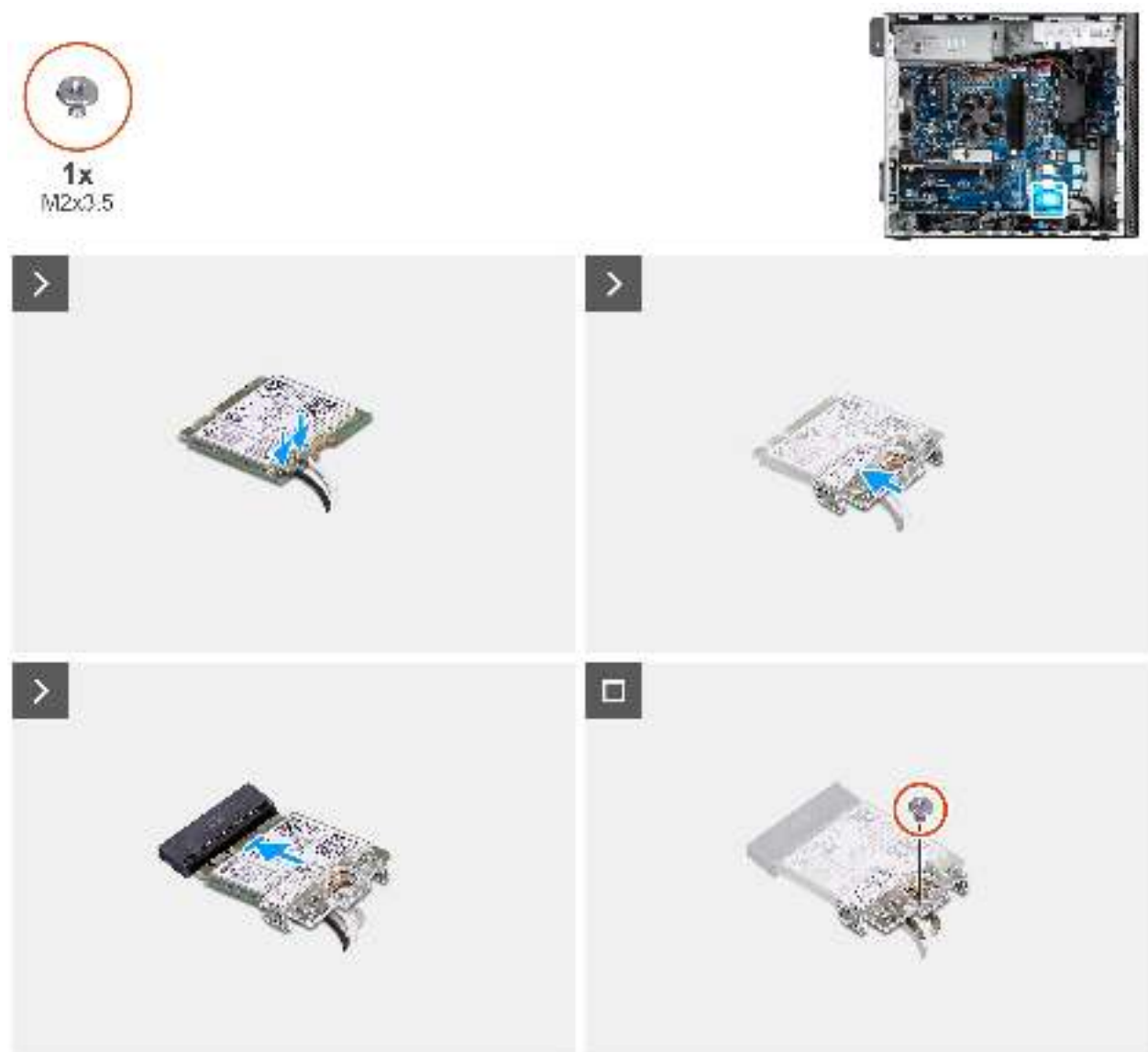
Abbildung 42. Installieren der Wireless-Karte
