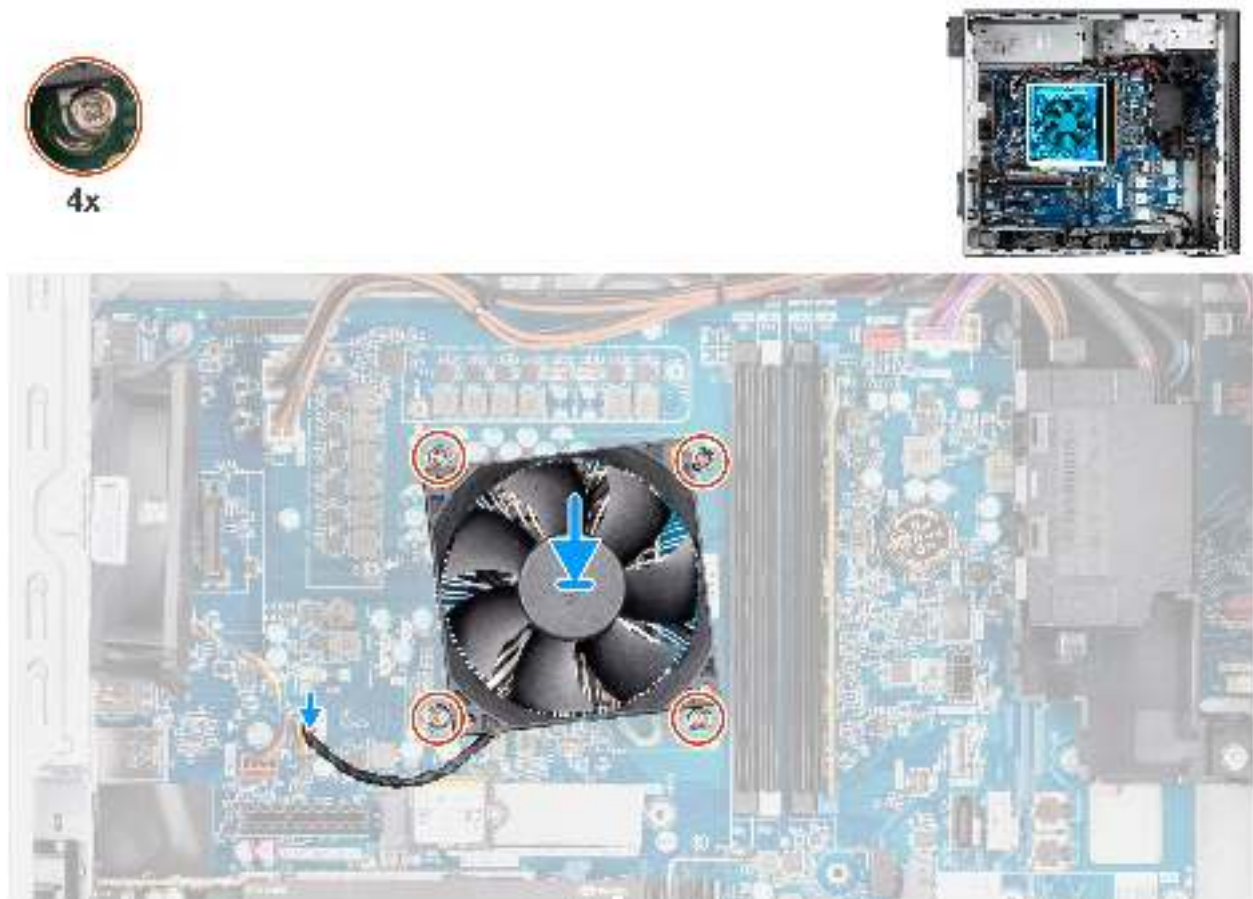
Abbildung 62. Installieren des Prozessorlüfters und der 65-W-Kühlkörperbaugruppe
