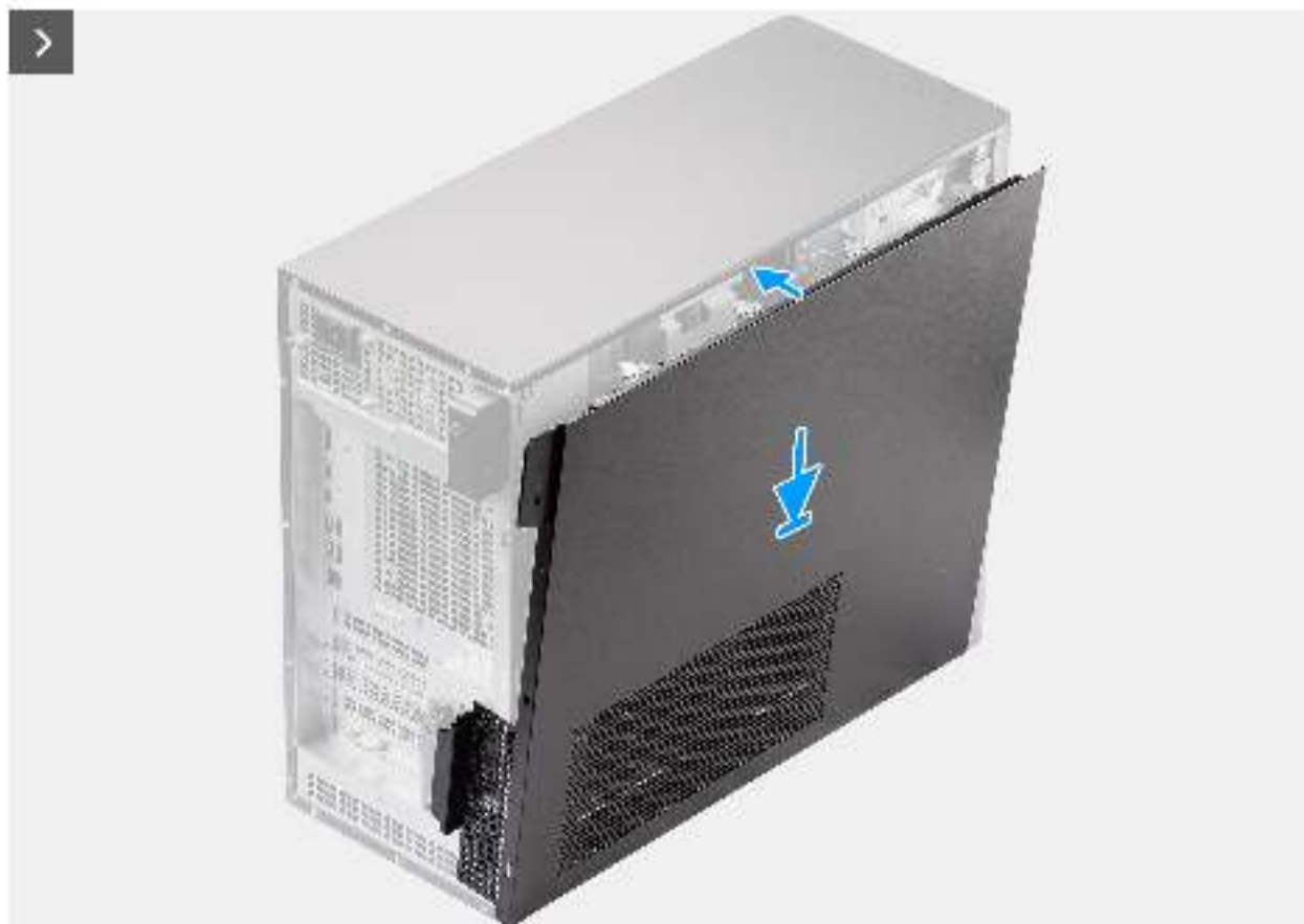
Abbildung 11. Anbringen der Seitenabdeckung
