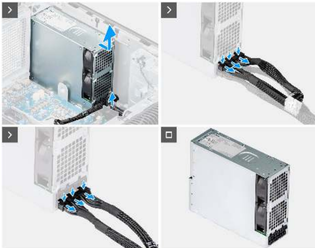
Abbildung 54. Entfernen des 1500-W-Netzteils
