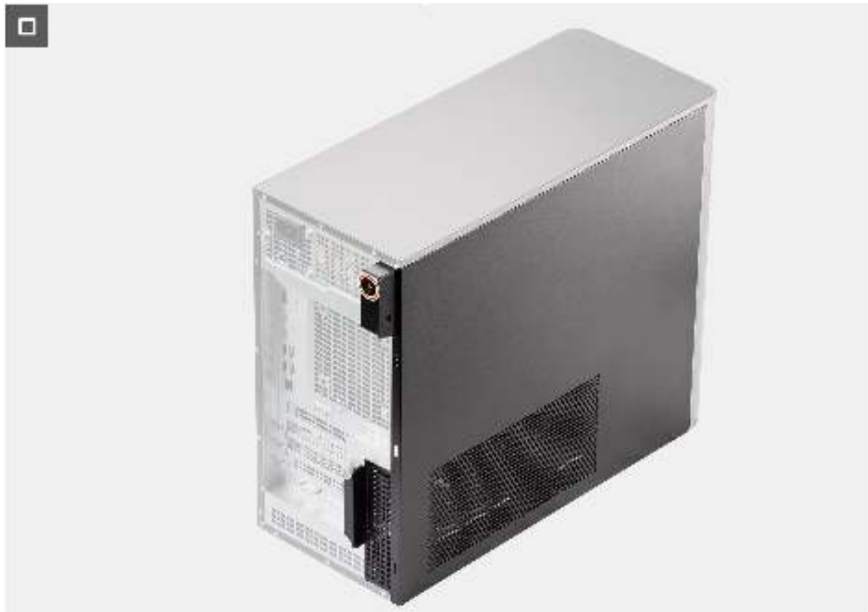
Abbildung 12. Anbringen der Seitenabdeckung
