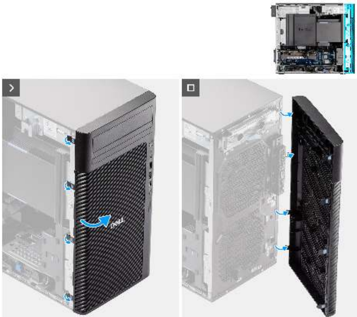
Abbildung 17. Entfernen der Frontverkleidung
