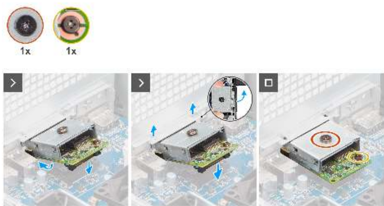
Abbildung 78. Installieren des optionalen LAN-Moduls
