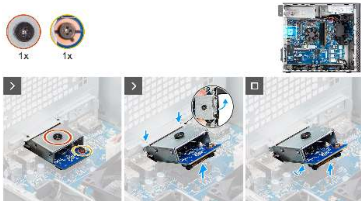
Abbildung 85. Entfernen des optionalen VGA-Moduls
