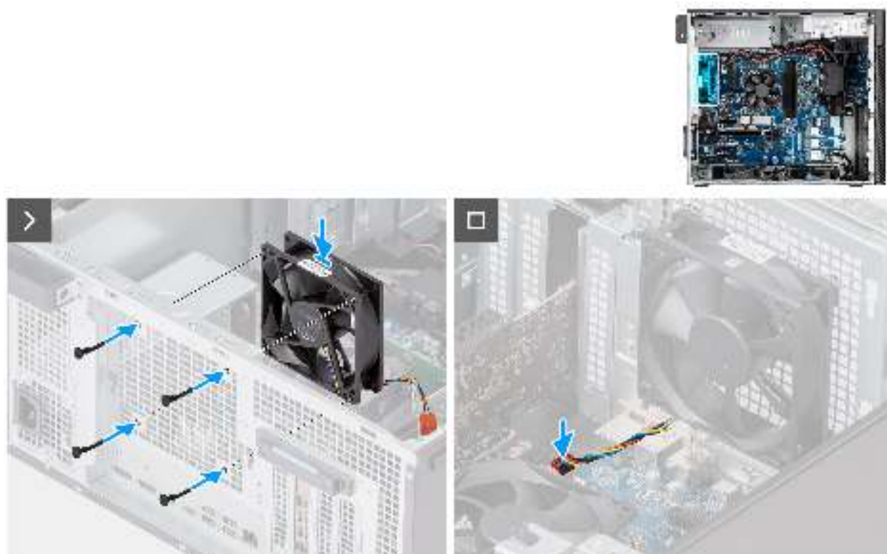
Abbildung 50. Installieren des hinteren Lüfters bei Computern mit 360-W-Netzteilen
