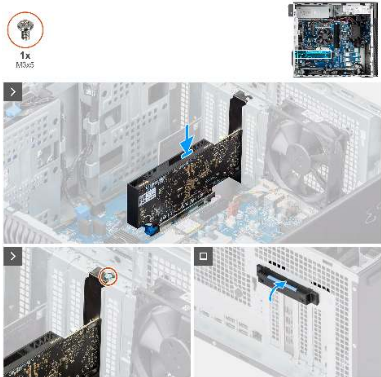
Abbildung 38. Installieren der Grafikkarte
