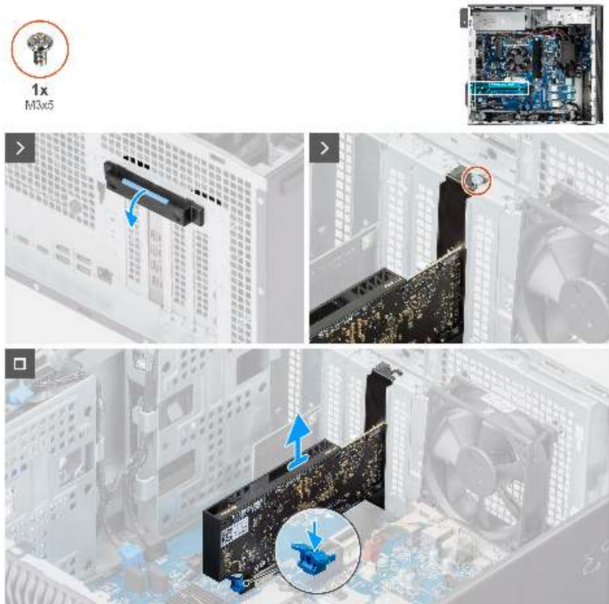
Abbildung 37. Entfernen der Grafikkarte
