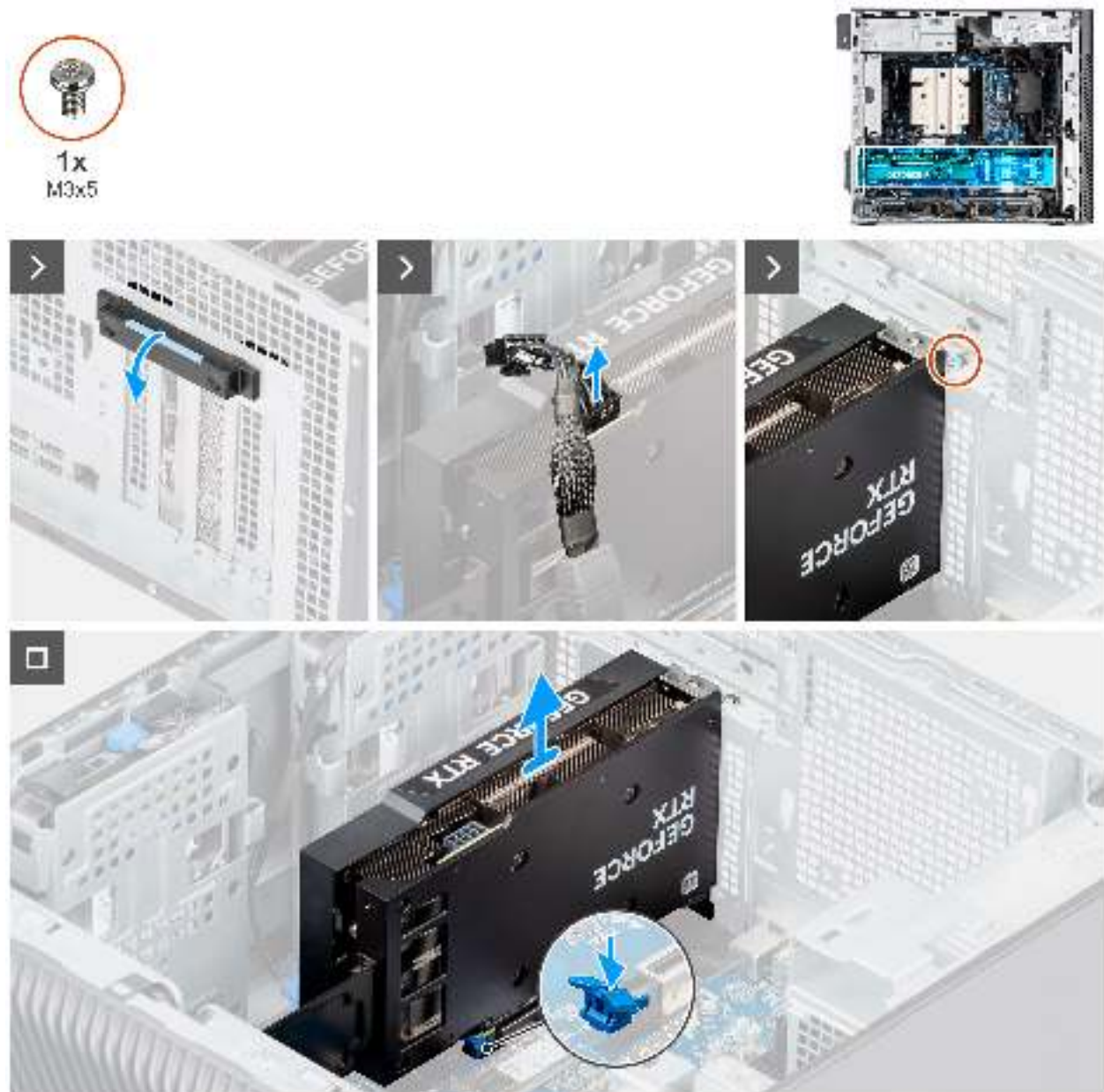
Abbildung 39. Entfernen der Grafikkarte mit Stromversorgung
