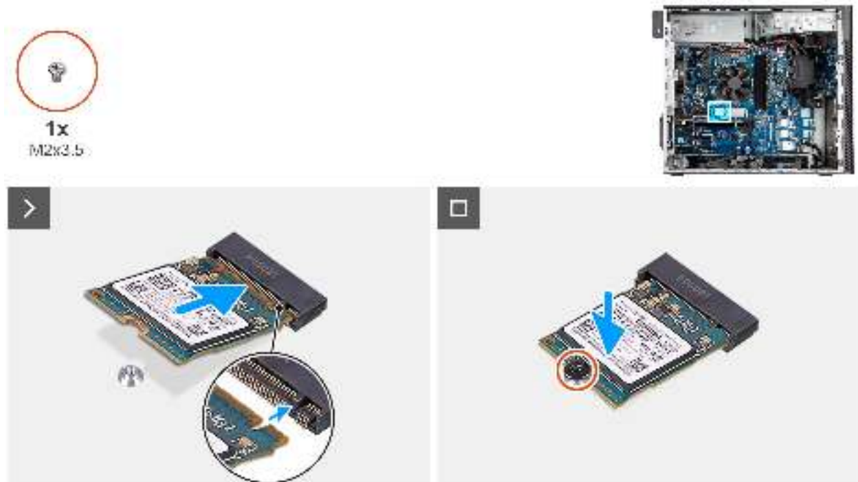
Abbildung 32. Einbauen des M.2 2230-PCIe-SSD-Laufwerks
