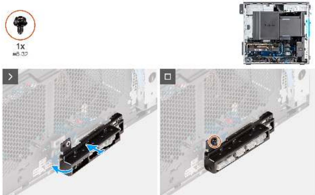
Abbildung 20. Anbringen der vorderen E/A-Halterung
