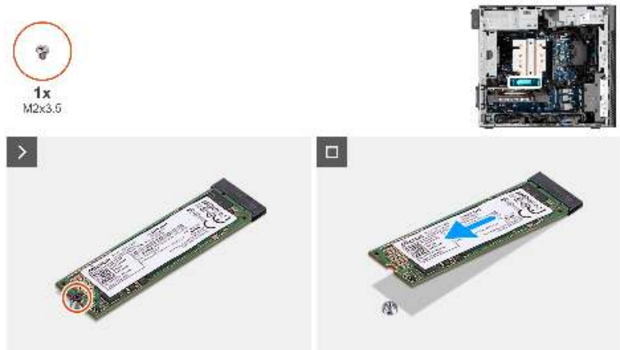
Abbildung 33. Entfernen des M.2 2280-PCIe-SSD-Laufwerks
