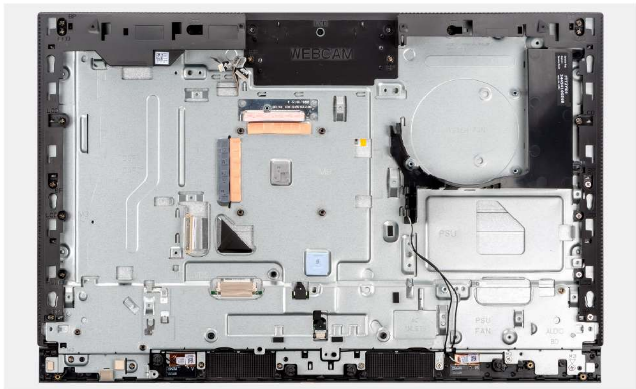
Abbildung 73. Entfernen der Grundplatte der Bildschirmbaugruppe
