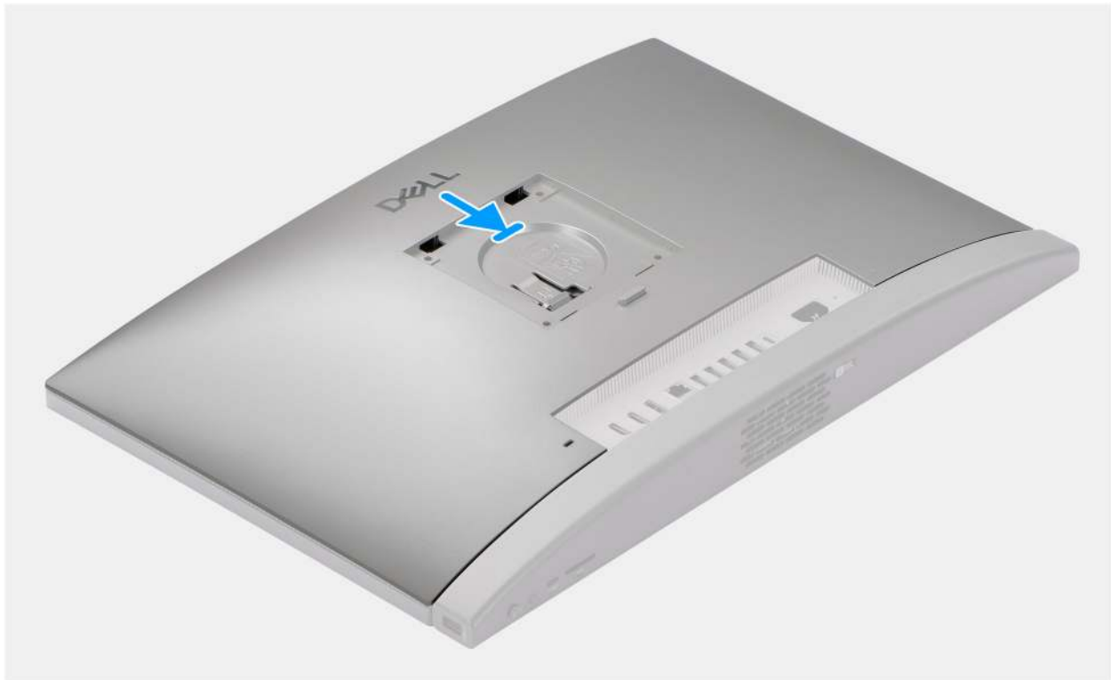
Abbildung 20. Einbauen der Rückabdeckung
