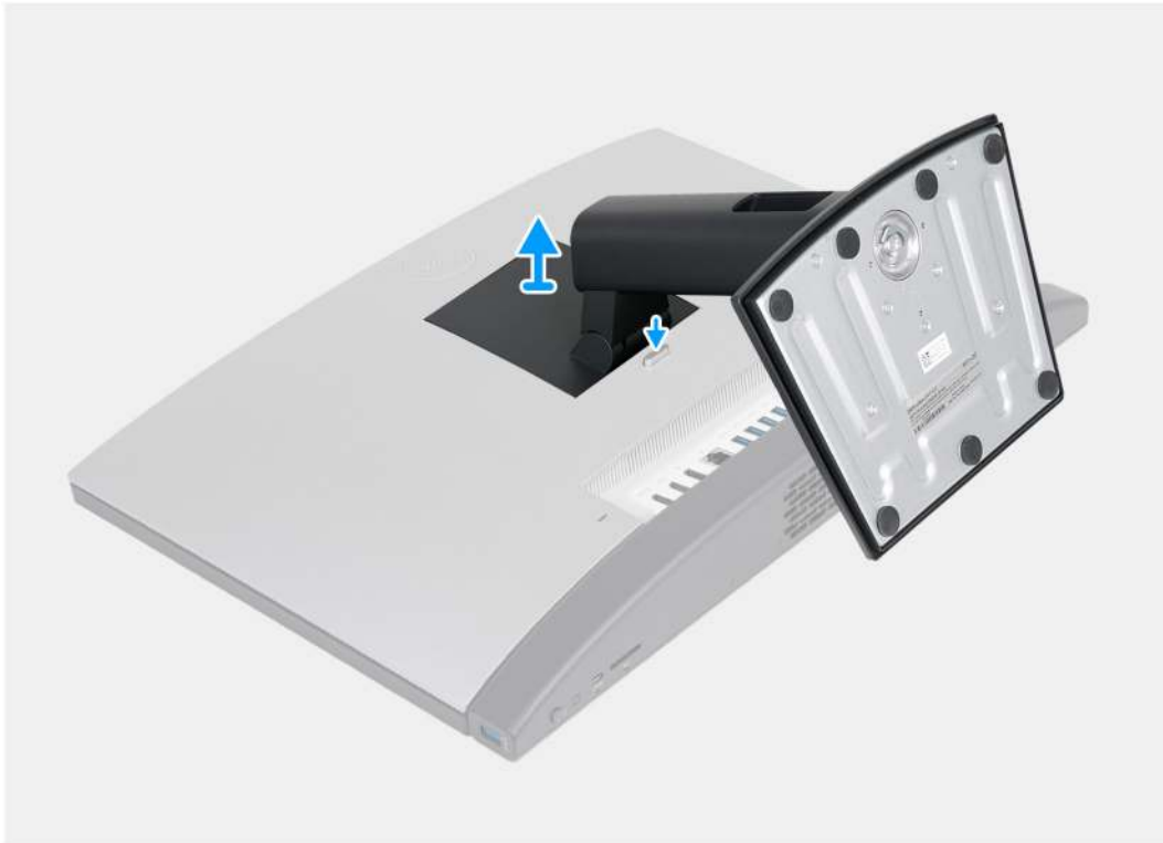
Abbildung 16. Entfernen des feststehenden Ständers
