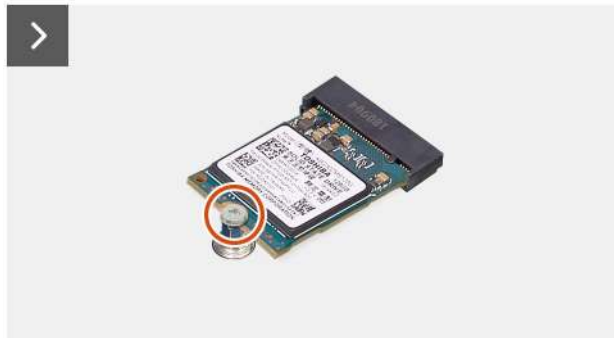
Abbildung 36. Entfernen des M.2 2230-SSD-Laufwerks aus M.2-Steckplatz 1
