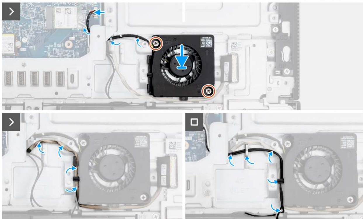
Abbildung 54. Einbauen des Netzteil Lüfters
