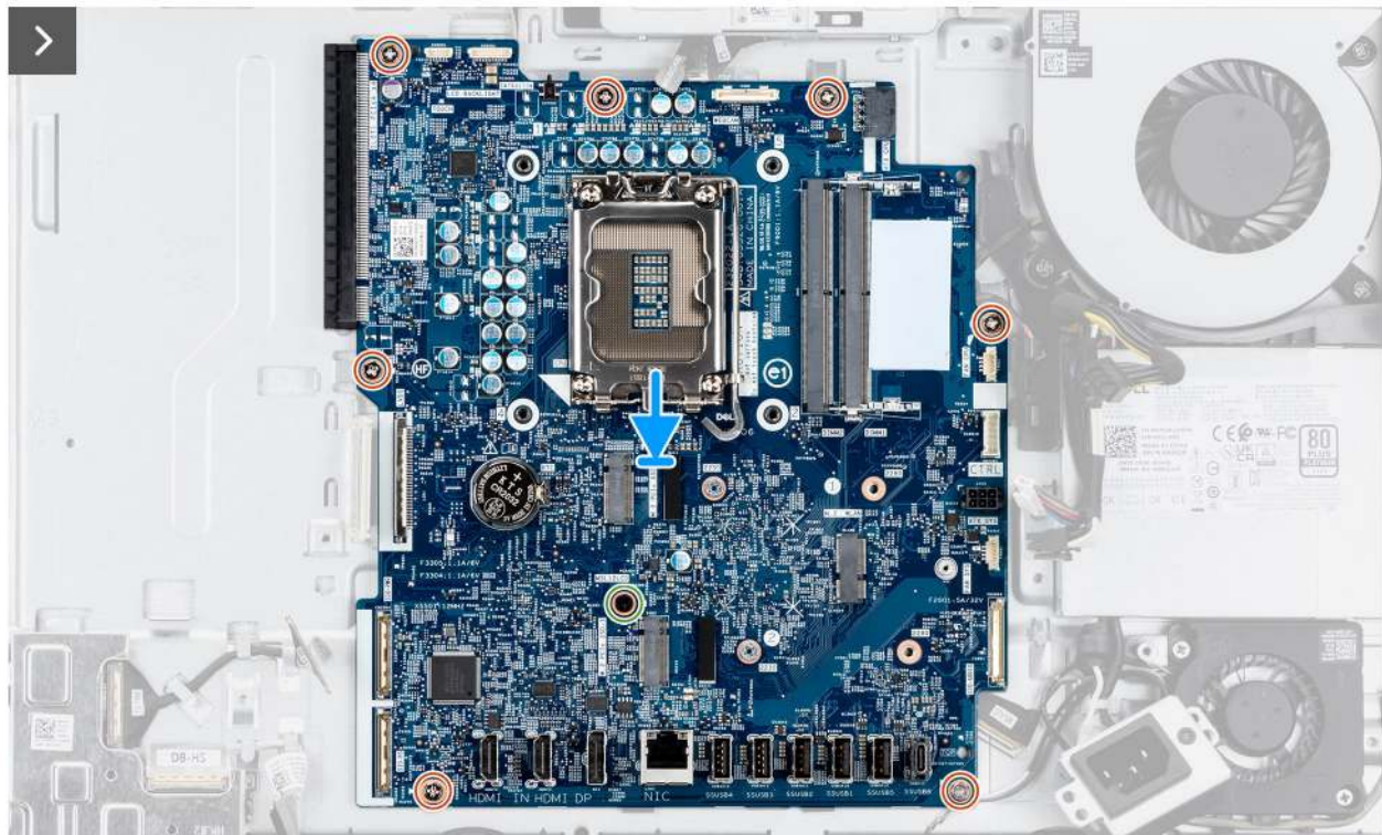
Abbildung 67. Einbauen der Systemplatine
