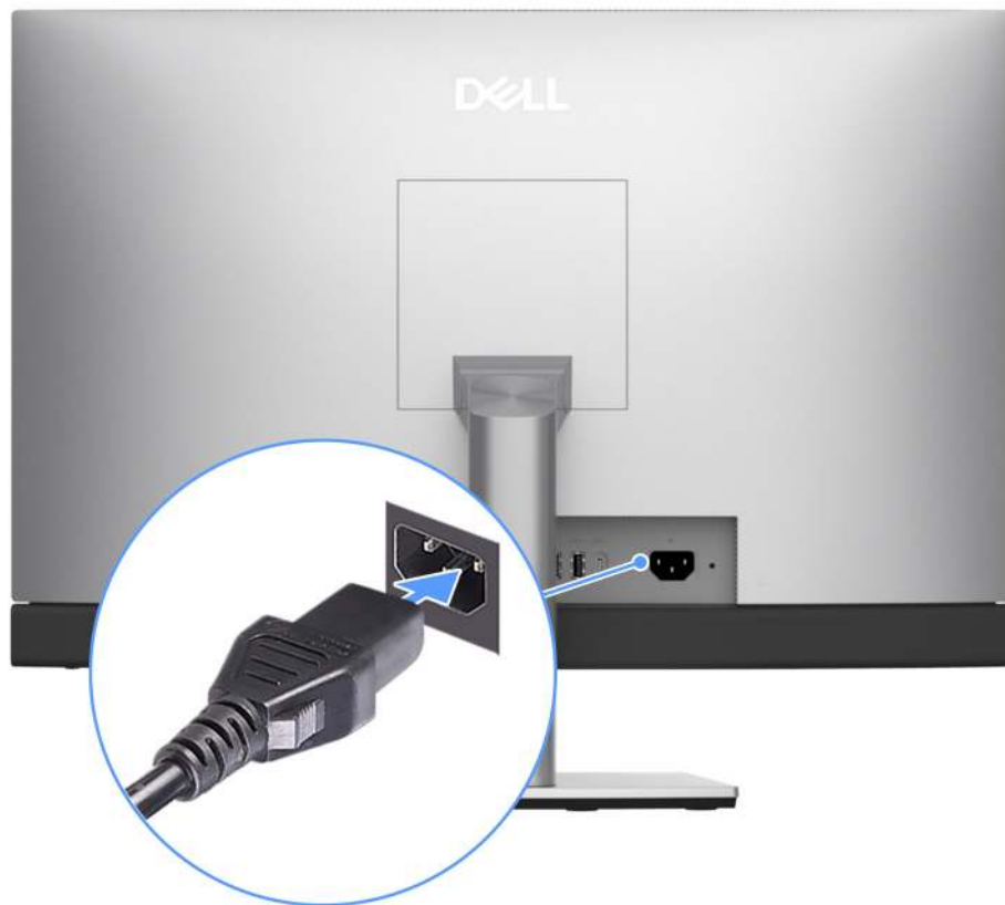
Abbildung 12. Anschließen des Stromkabels
