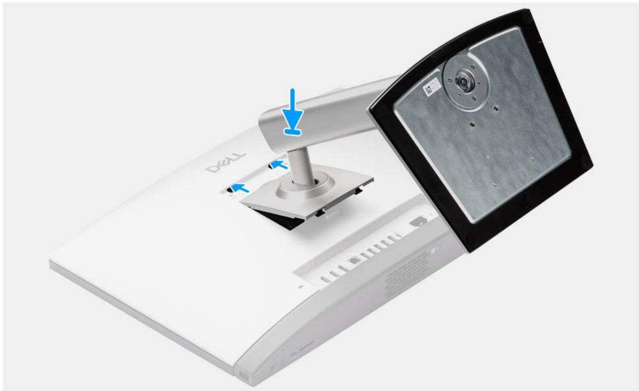
Abbildung 17. Installieren des höhenverstellbaren Ständers (HAS)
