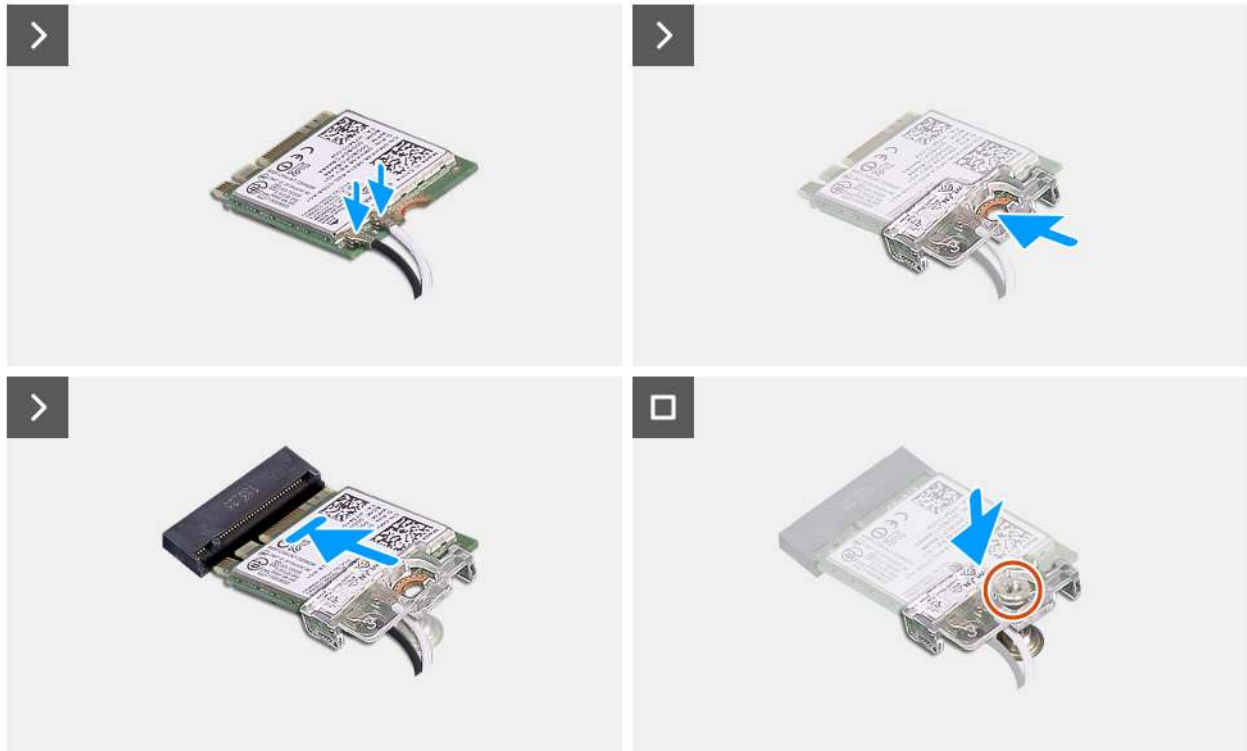
Abbildung 30. Installieren der Wireless-Karte
