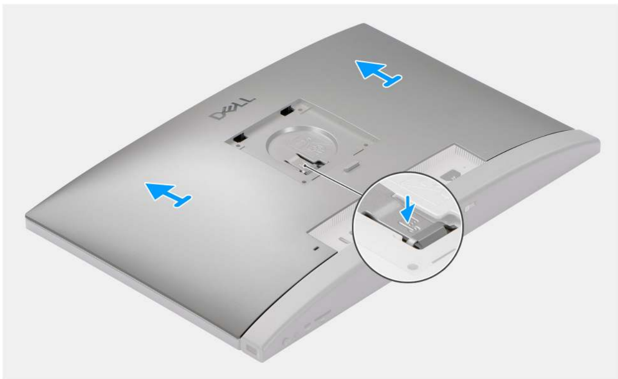
Abbildung 19. Entfernen der Rückabdeckung
