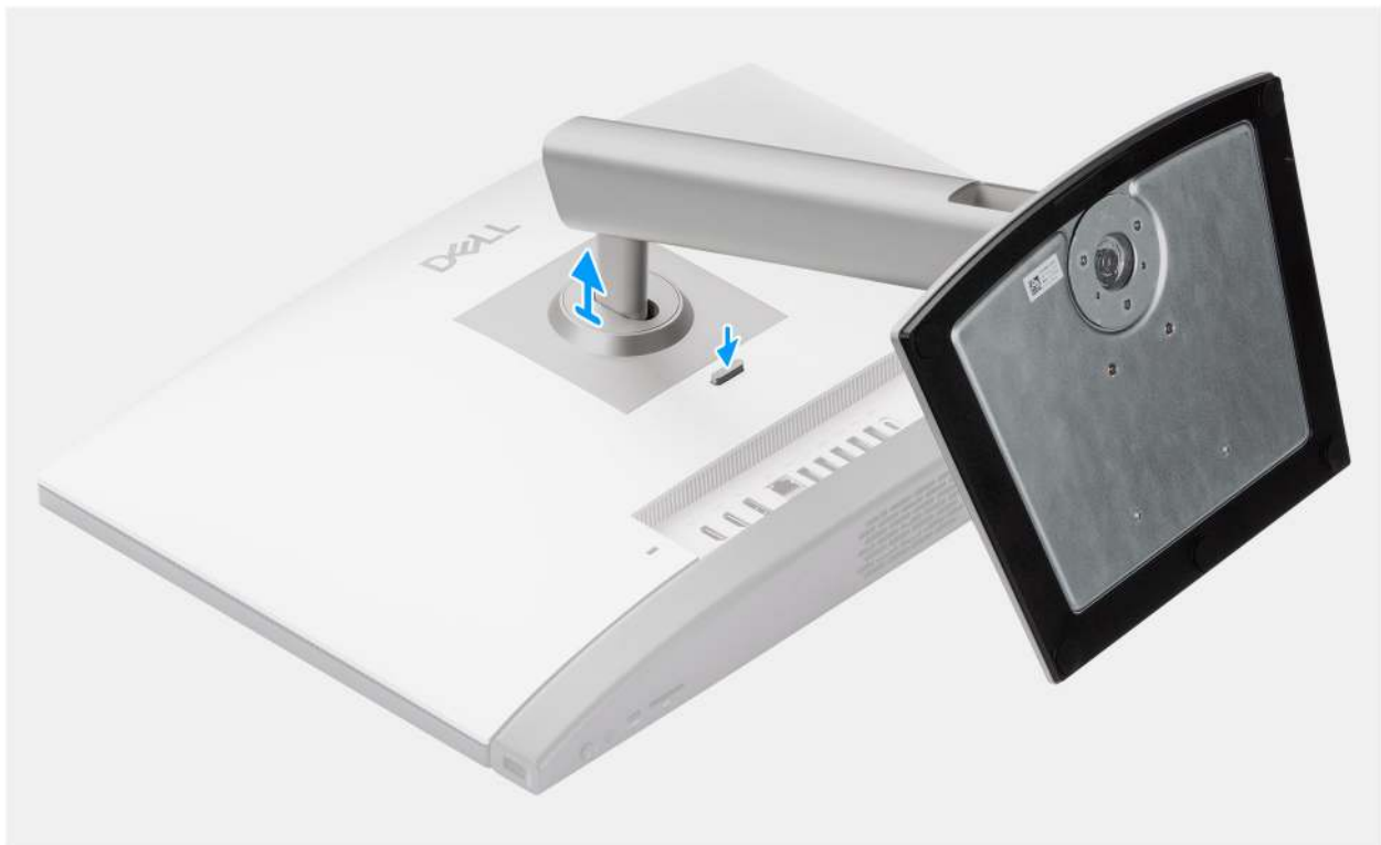
Abbildung 15. Entfernen des höhenverstellbaren Ständers (HAS)
