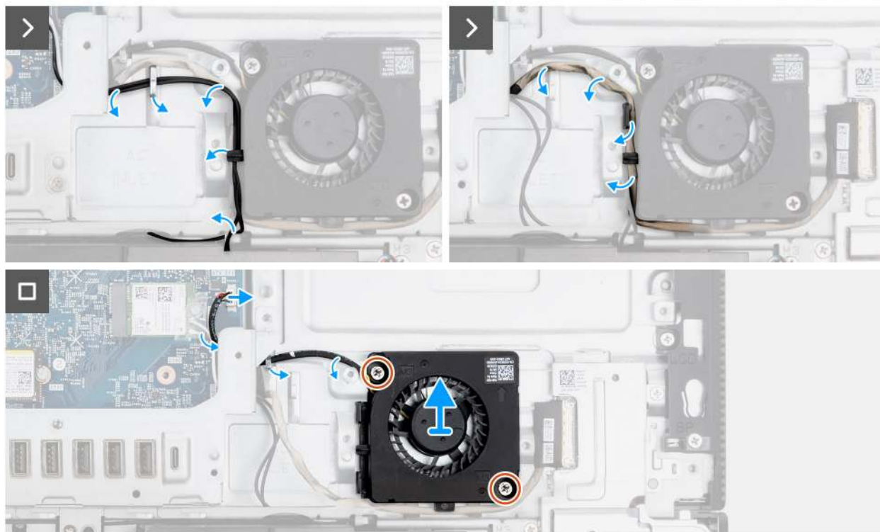
Abbildung 53. Entfernen des Netzteil­lüfters
