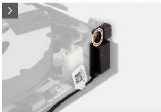
Abbildung 64. Entfernen des Antennenmoduls (schwarzes Kabel)
