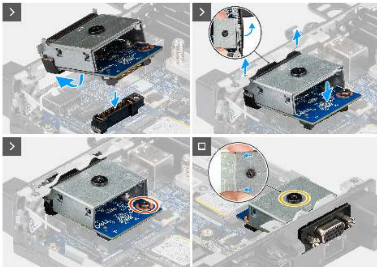
Abbildung 52. Installieren des VGA-Anschlussmoduls
