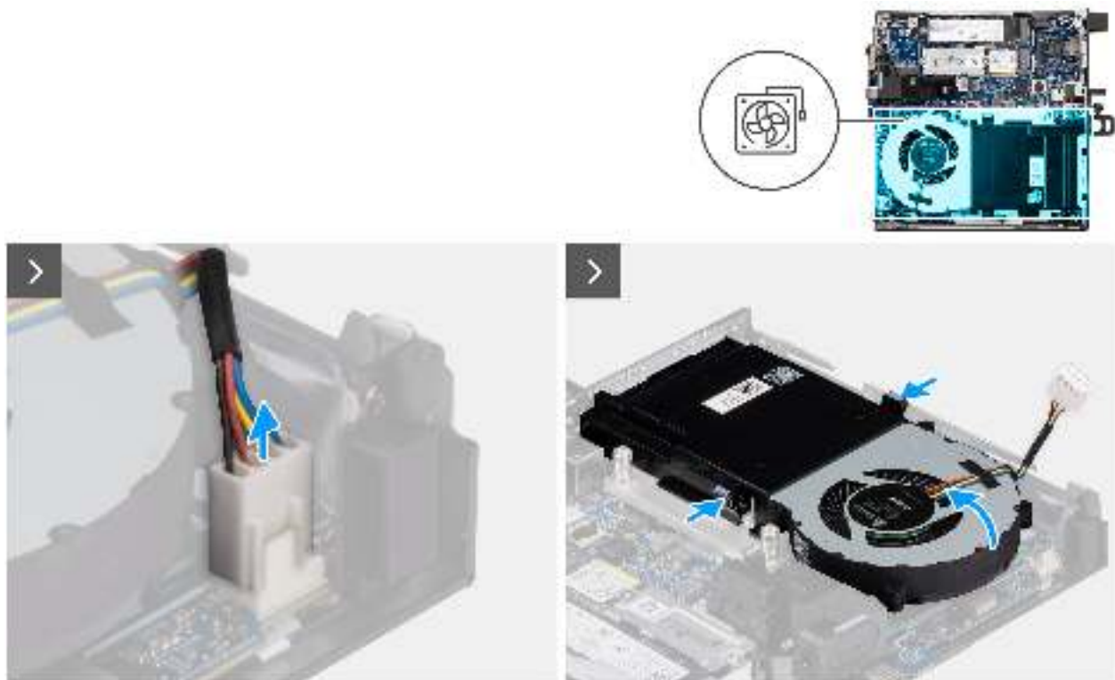
Abbildung 28. Entfernen des Lüfters
