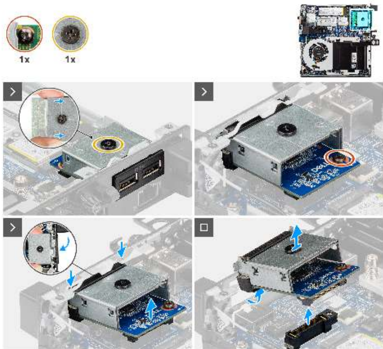
Abbildung 38. Entfernen des dualen USB-3.2-Gen2-Anschlussmoduls
