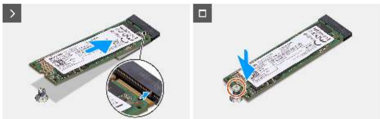
Abbildung 21. Einbauen des M.2-2280-Solid-State-Laufwerks
