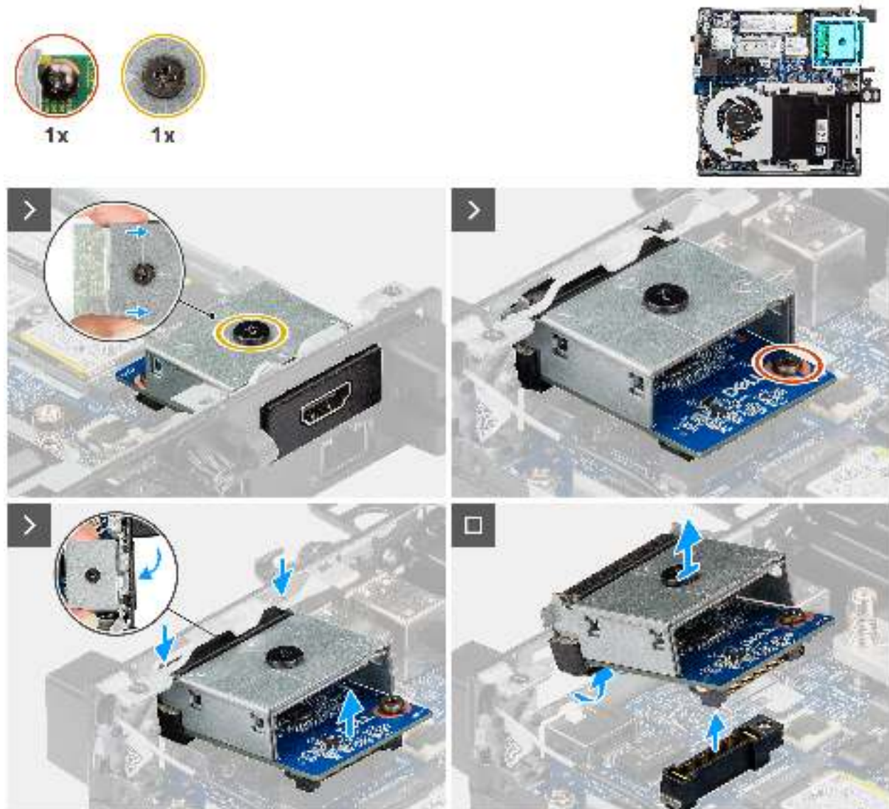
Abbildung 47. Entfernen des HDMI-Anschlussmoduls
