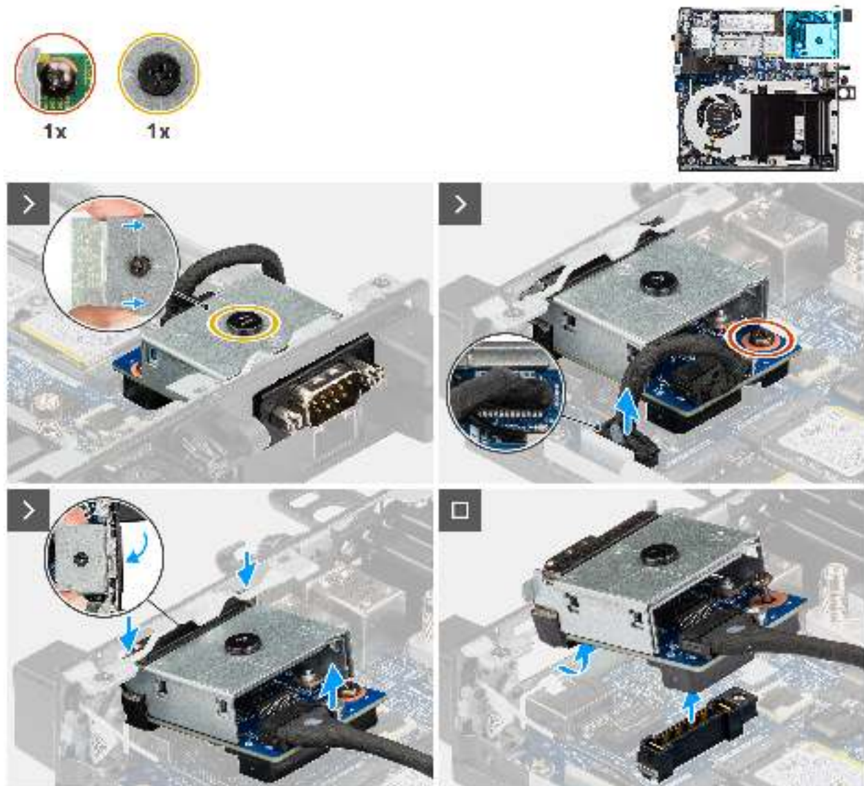
Abbildung 56. Entfernen des seriellen Anschlussmoduls
