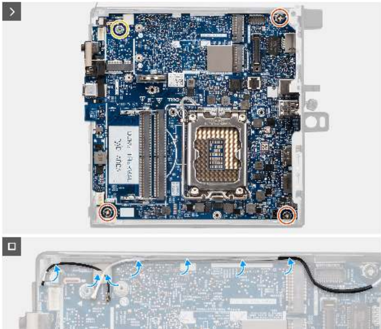
Abbildung 79. Einbauen der Systemplatine
