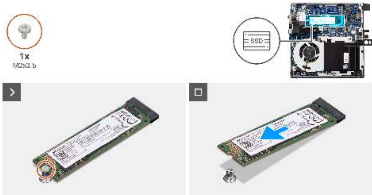
Abbildung 19. Entfernen des M.2-2280-Solid-State-Laufwerks
