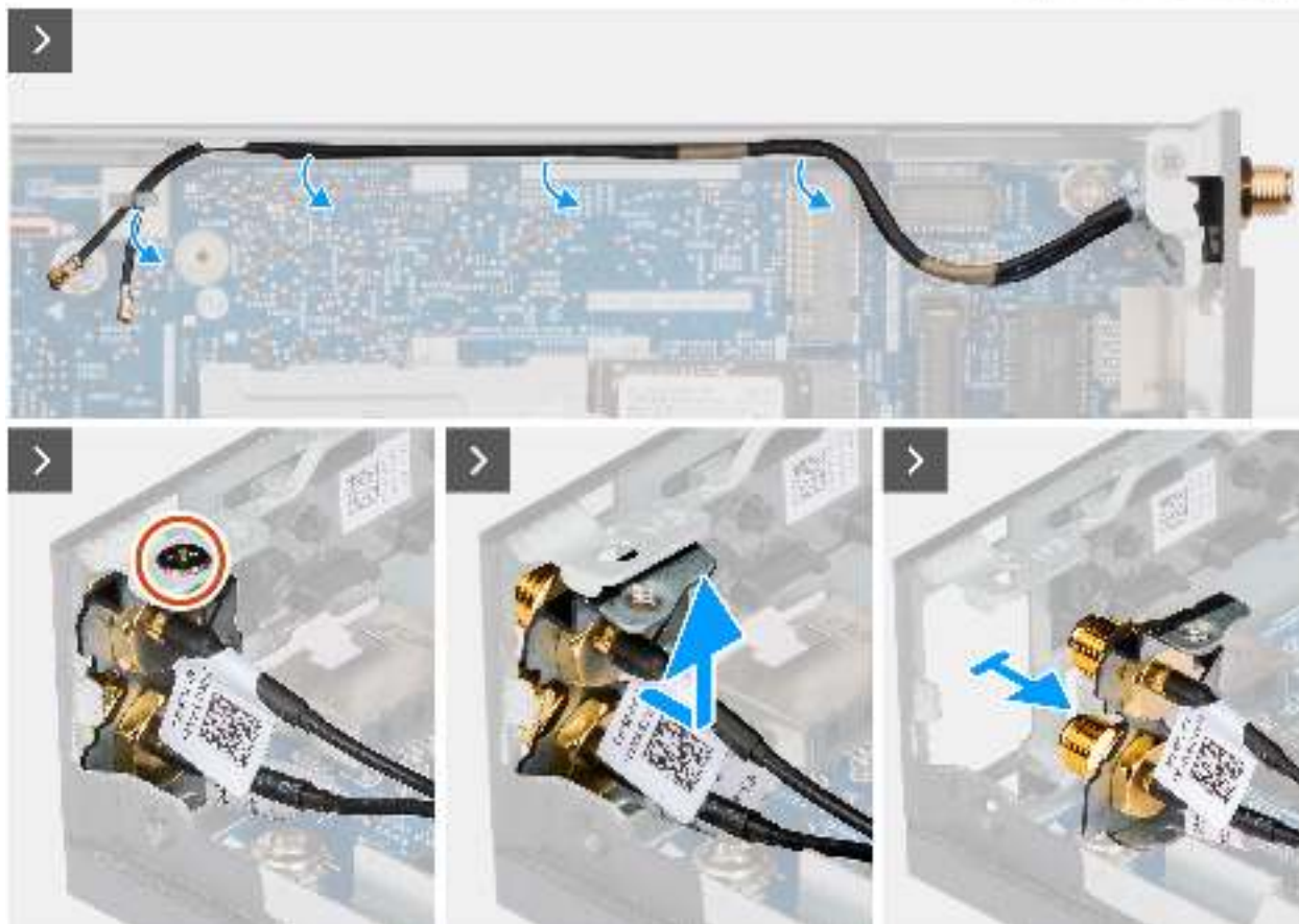
Abbildung 36. Entfernen der SMA-Antenne
