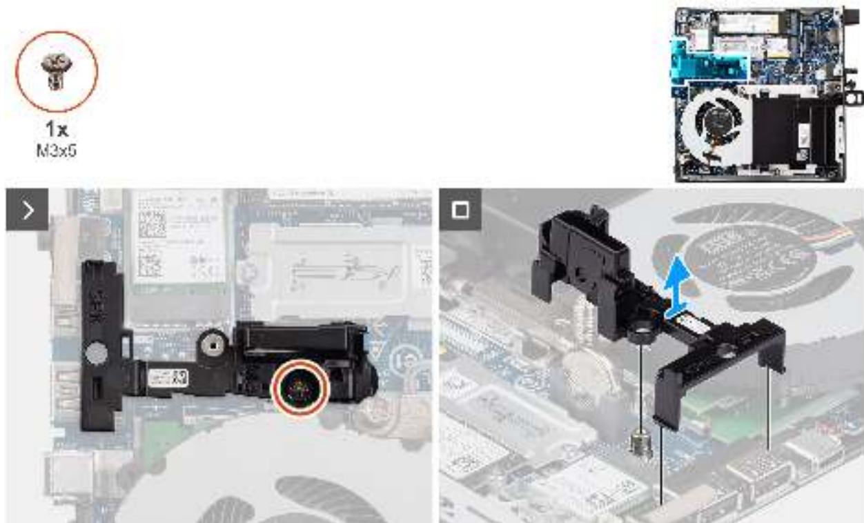
Abbildung 72. Entfernen der Lautsprecherhalterung
