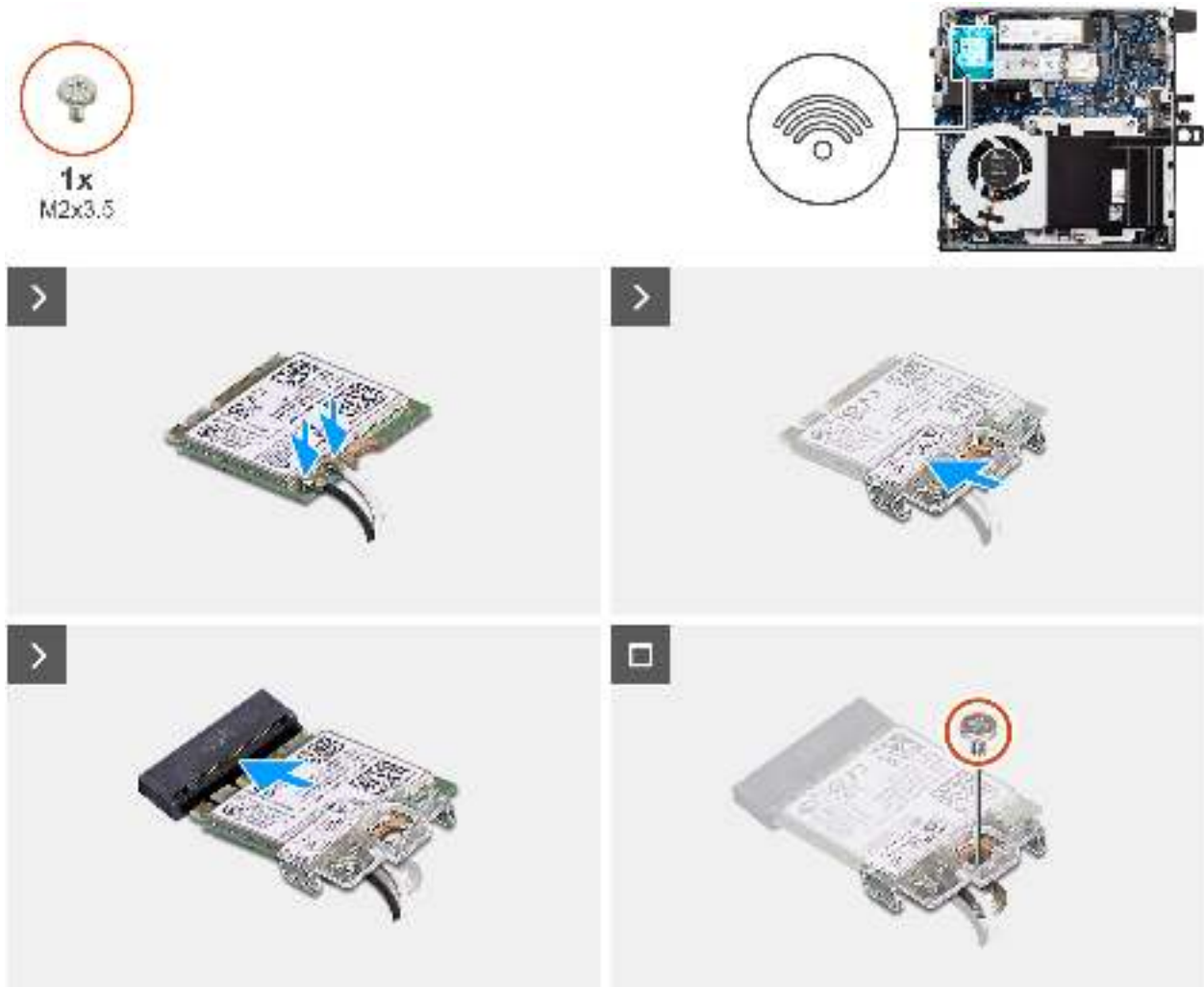
Abbildung 27. Installieren der Wireless-Karte
