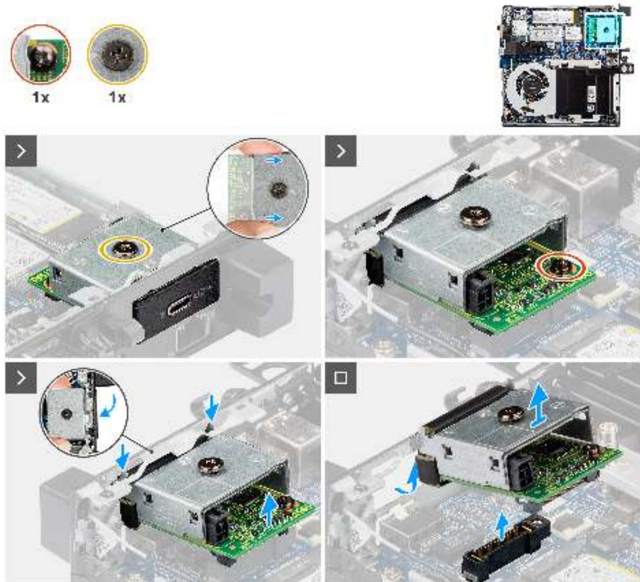
Abbildung 41. Entfernen des USB-Typ-C-Anschlussmoduls
