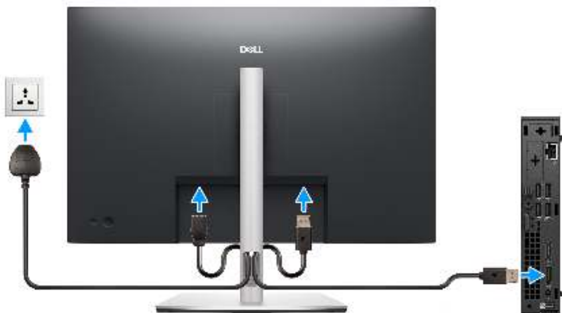
Abbildung 6. Anschließen des Bildschirms
