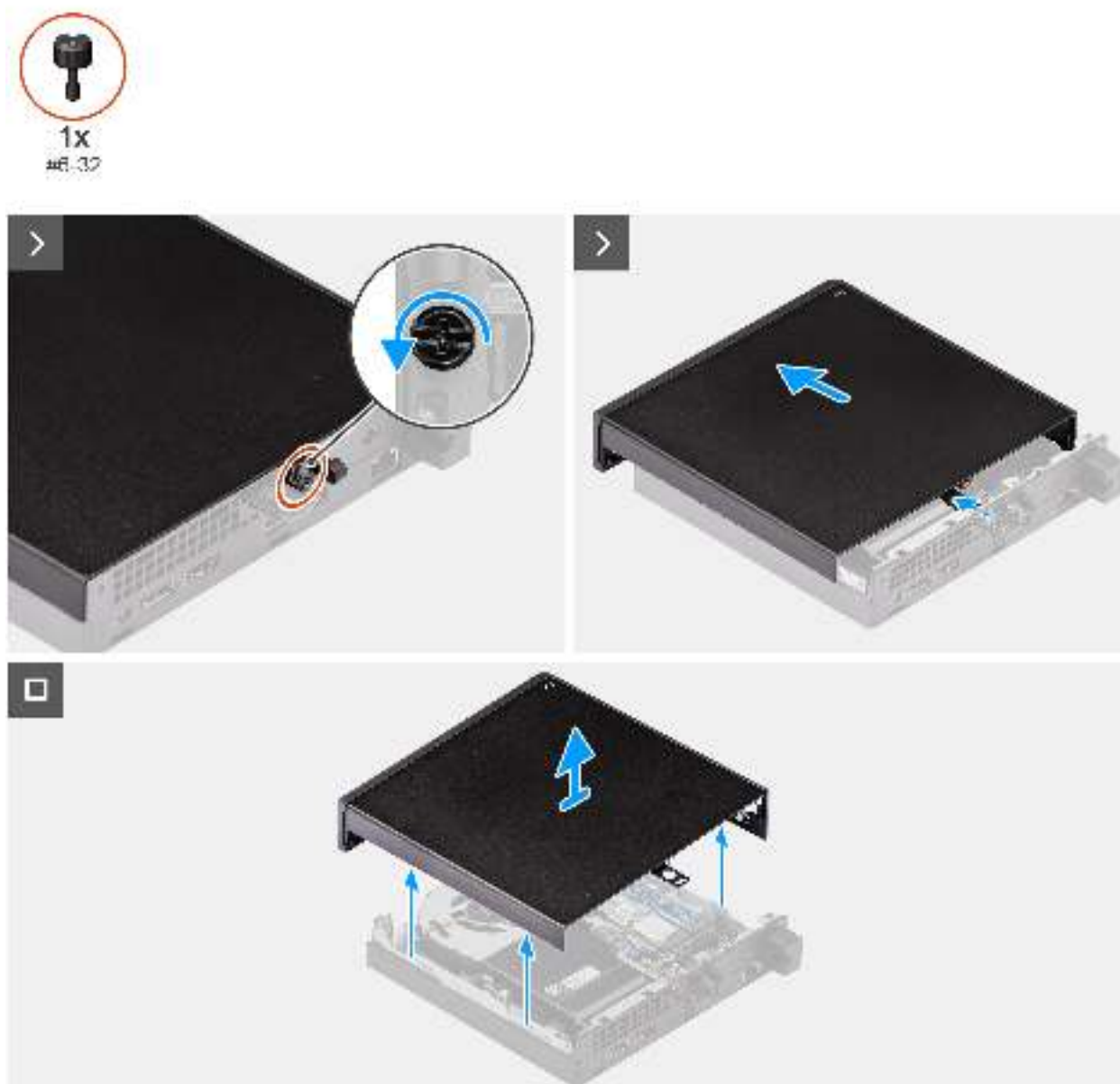
Abbildung 10. Entfernen der Seitenabdeckung
