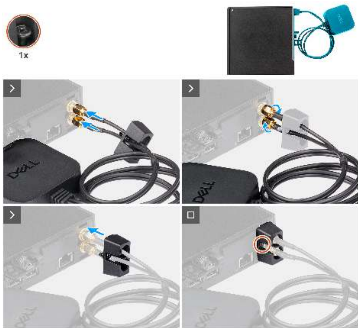
Abbildung 35. Einbauen der externen Puck-Antenne
