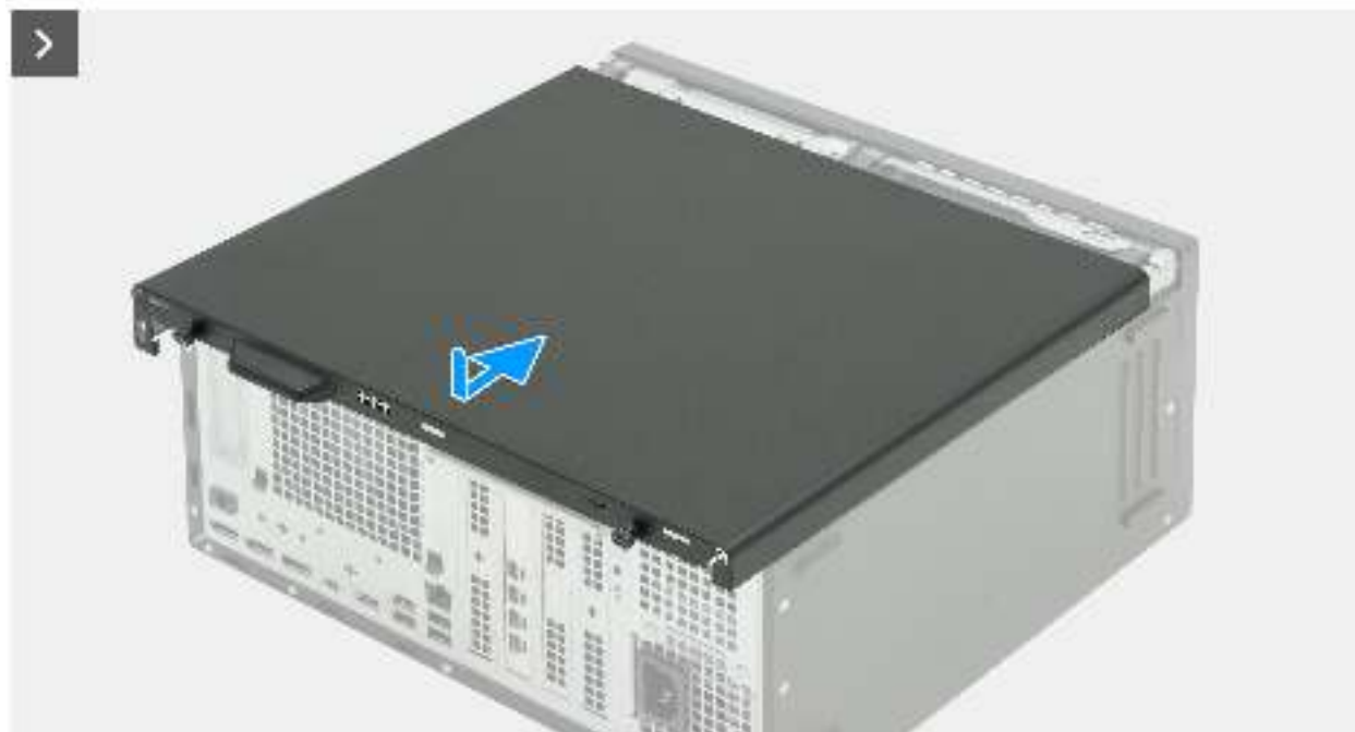
Abbildung 14. Installieren der linken Abdeckung
