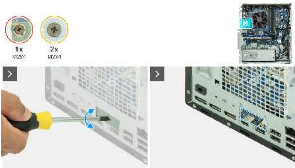
Abbildung 77. Installieren des Glasfaser-Anschlussmoduls
