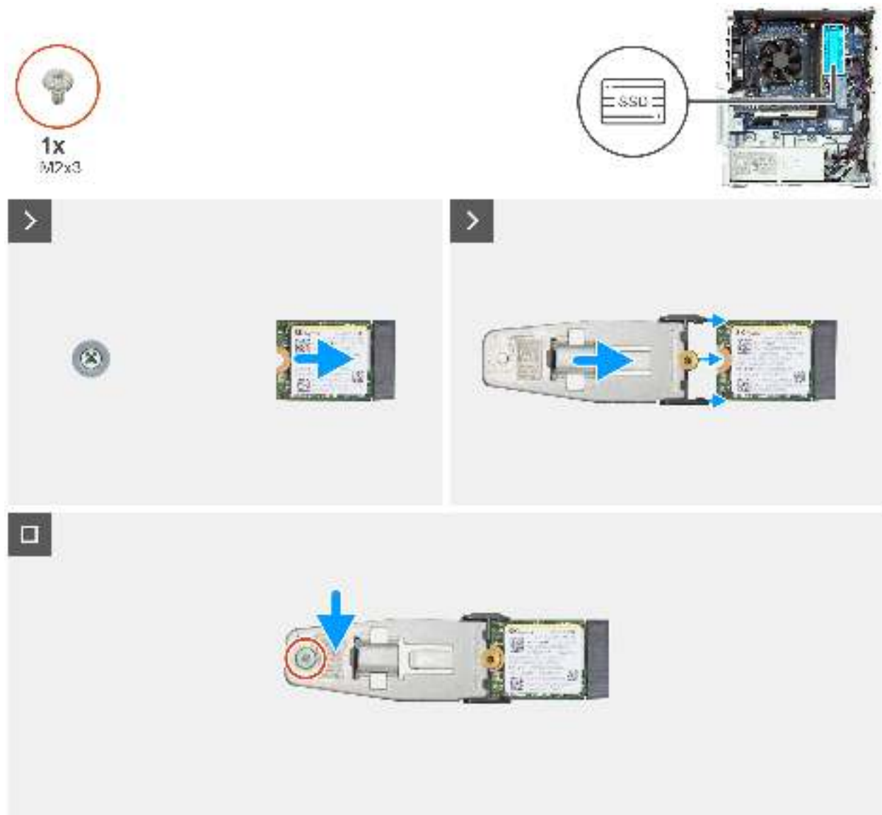
Abbildung 36. Installieren des M.2 2230-Solid-State-Laufwerks in Steckplatz 2
