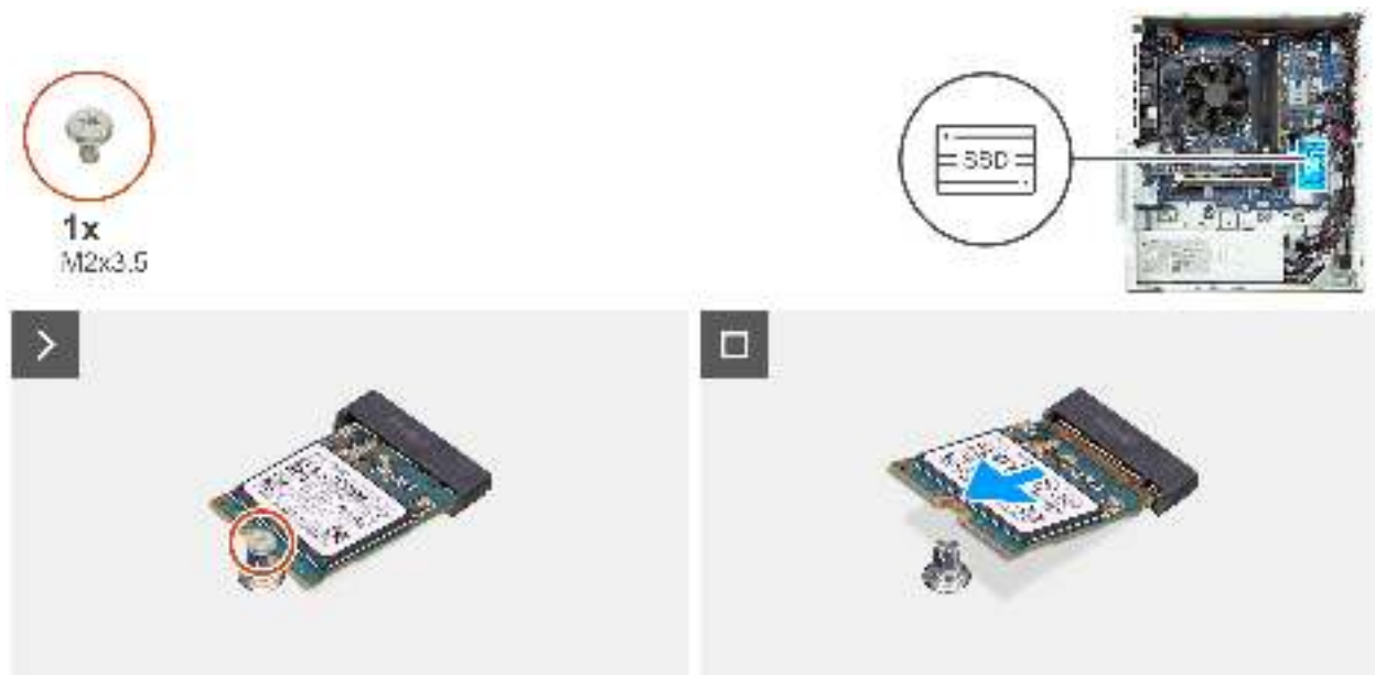
Abbildung 28. Entfernen des M.2-2230-SSD-Laufwerks aus Steckplatz 0
