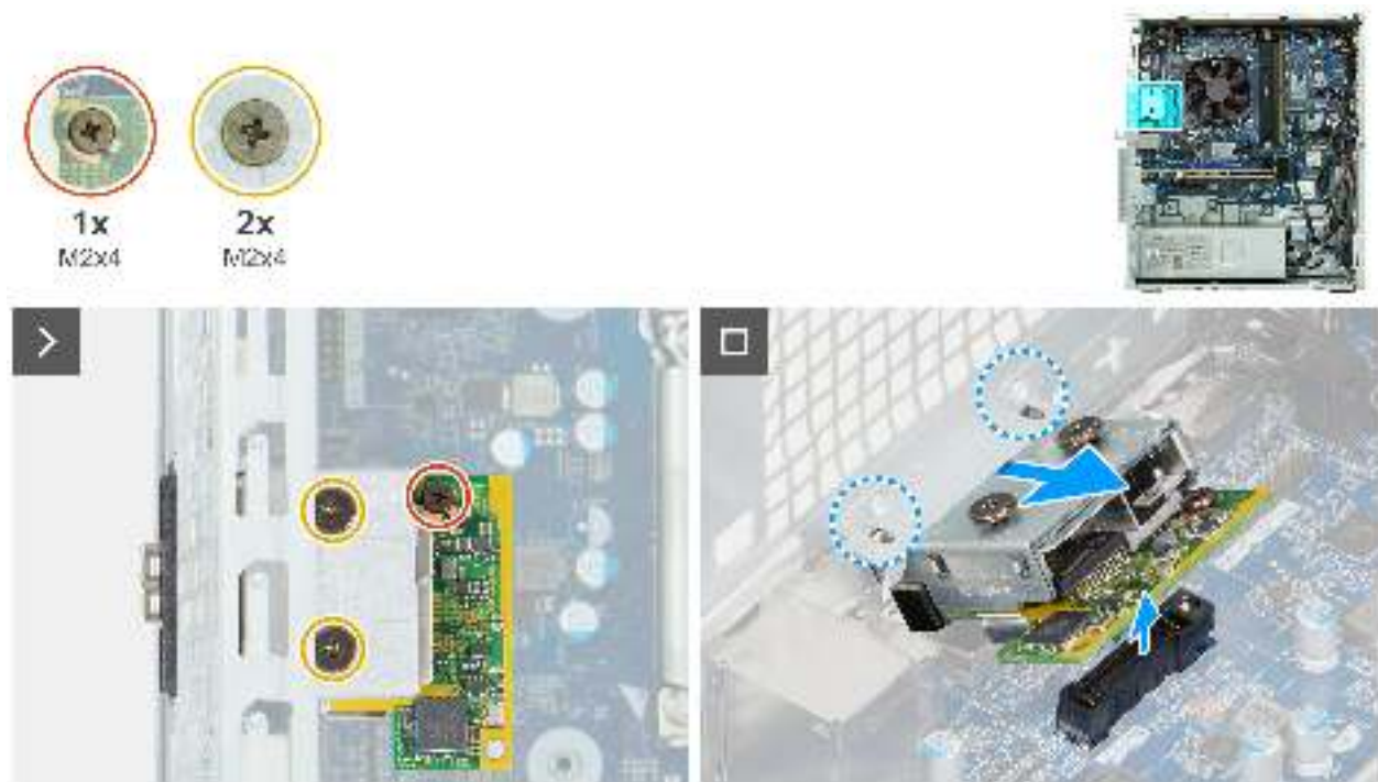
Abbildung 76. Entfernen des Glasfaser-Anschlussmoduls
