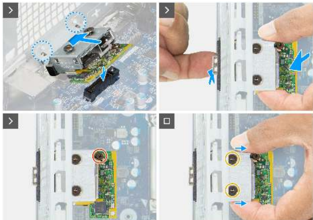
Abbildung 78. Installieren des Glasfaser-Anschlussmoduls
