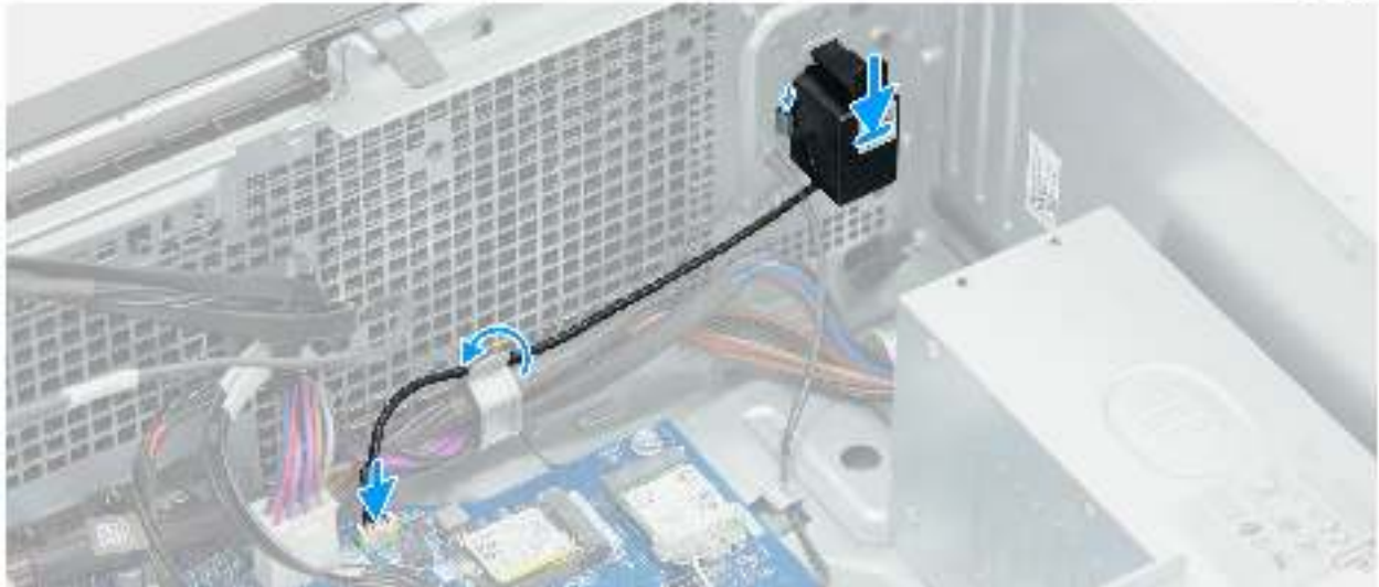
Abbildung 25. Einbauen des internen Lautsprechers
