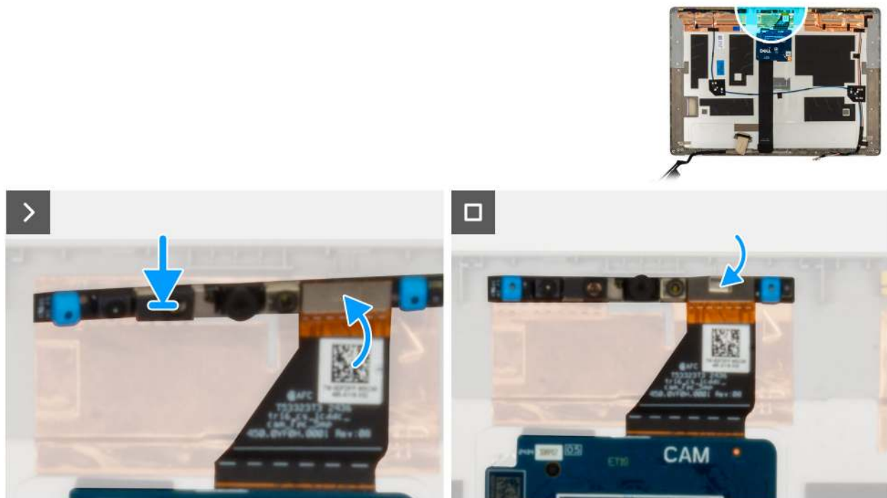
Abbildung 56. Installieren des Kameramoduls
