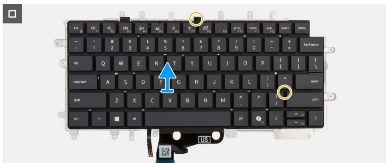
Abbildung 41. Entfernen der Tastatur
