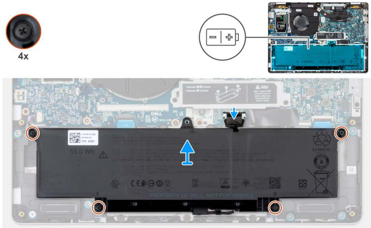
Abbildung 8. Entfernen des Akkus
