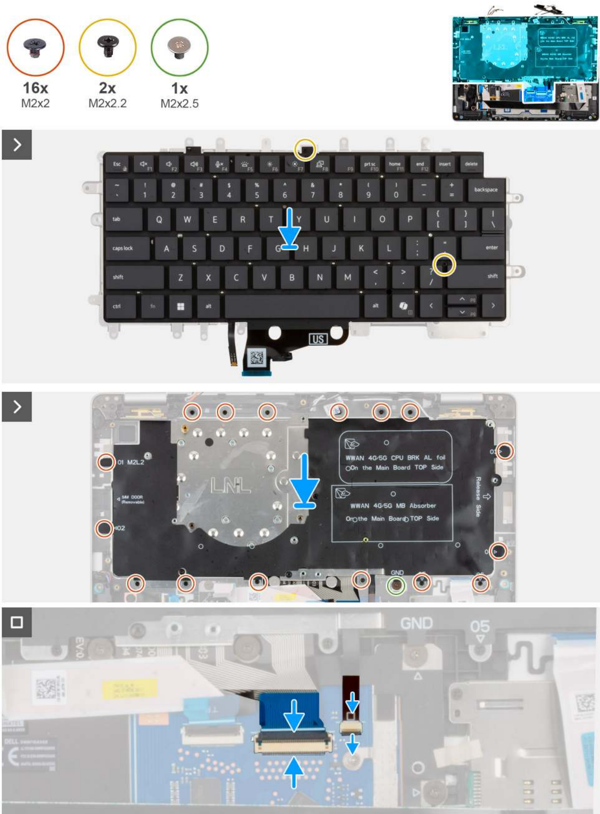
Abbildung 42. Einbauen der Tastatur
