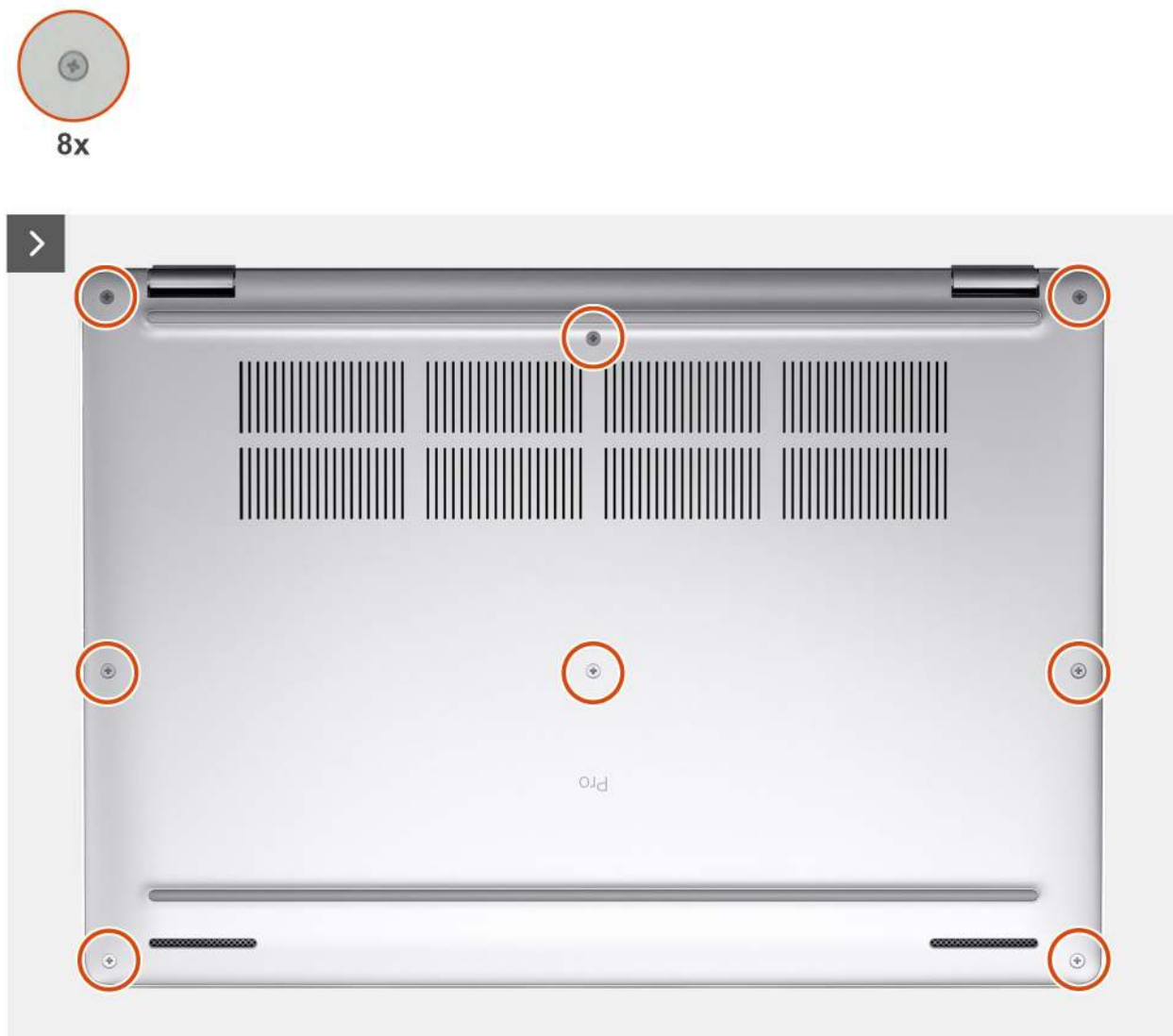
Abbildung 6. Entfernen der Bodenabdeckung
