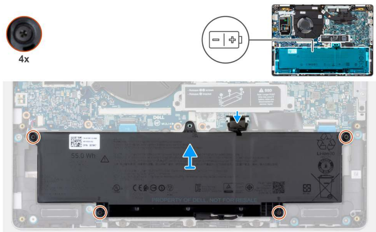
Abbildung 10. Einsetzen des Akkus
