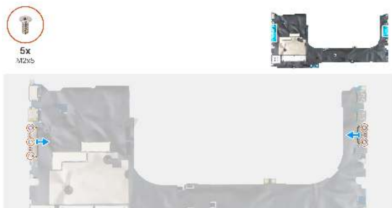
Abbildung 115. Entfernen des USB-Typ-C-Anschlussmoduls
