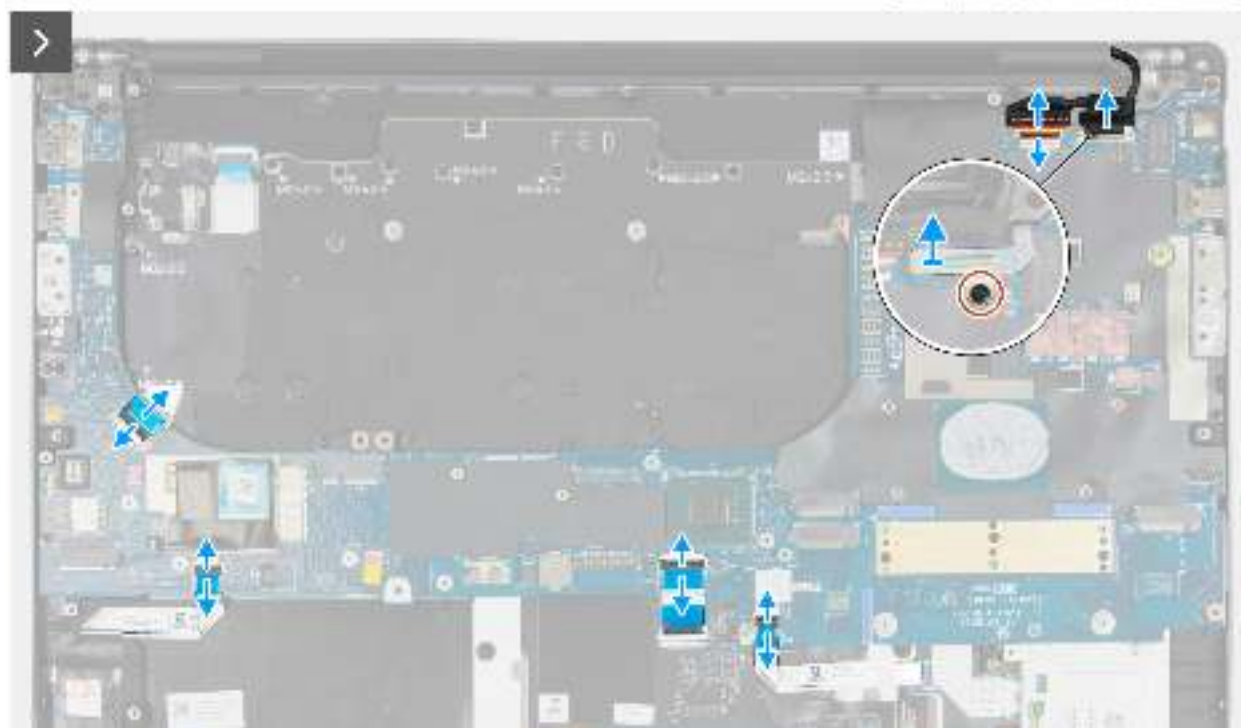
Abbildung 109. Entfernen der Systemplatine
