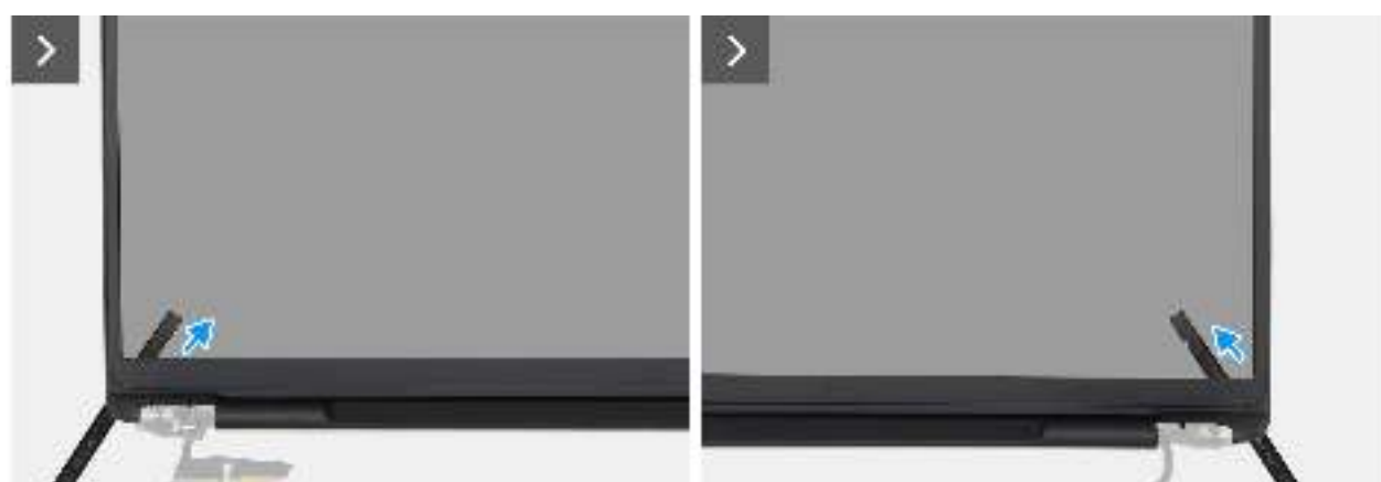
Abbildung 84. Entfernen der Bildschirmblende
