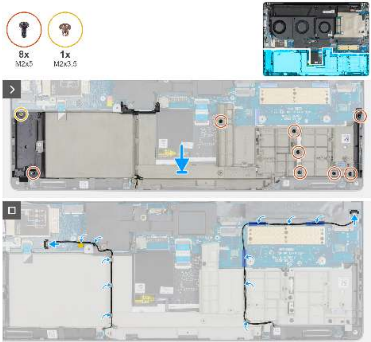
Abbildung 80. Installieren des inneren Rahmens
