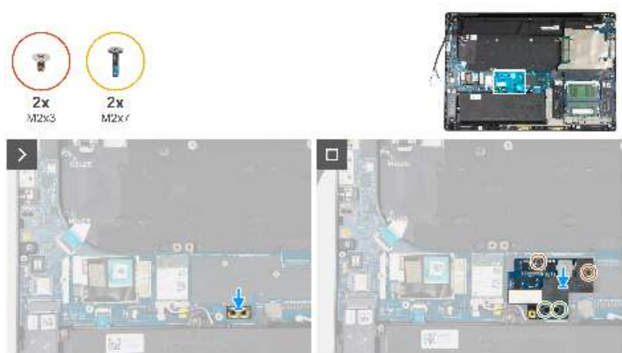
Abbildung 72. Einbauen der Netzteilplatine
