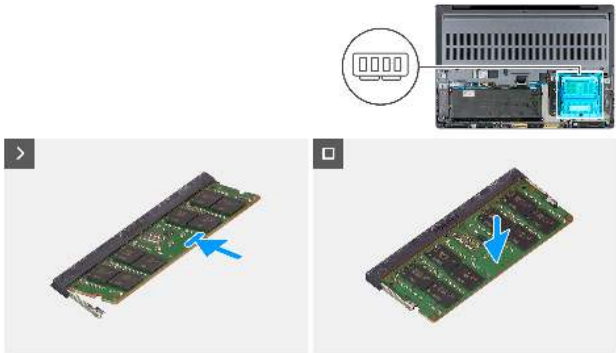
Abbildung 31. Einsetzen des Speichermoduls
