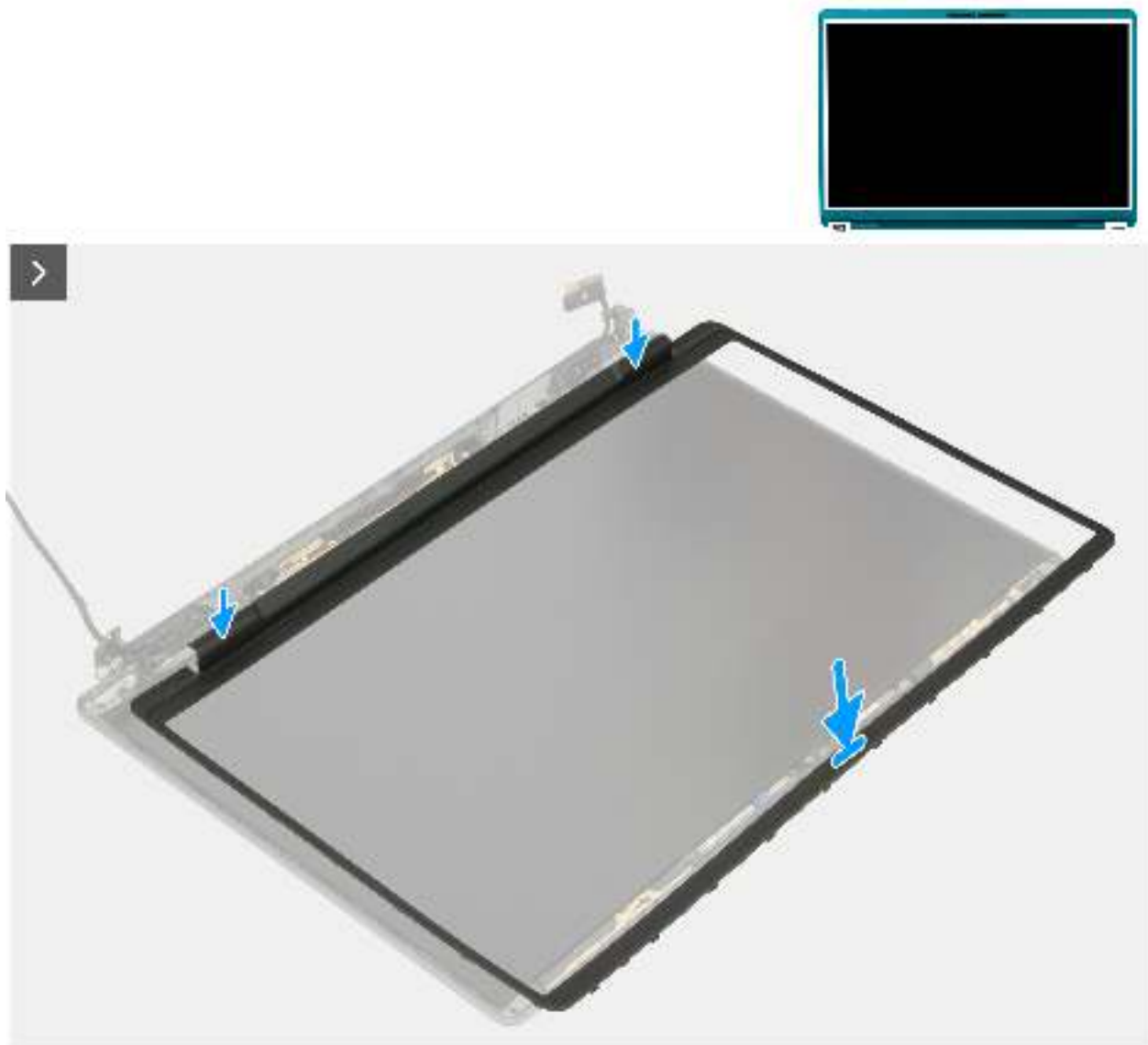
Abbildung 89. Einbauen der Bildschirmblende
