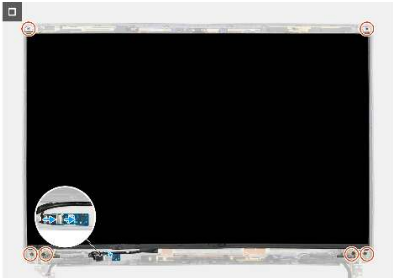
Abbildung 98. Einbauen des Bildschirms
