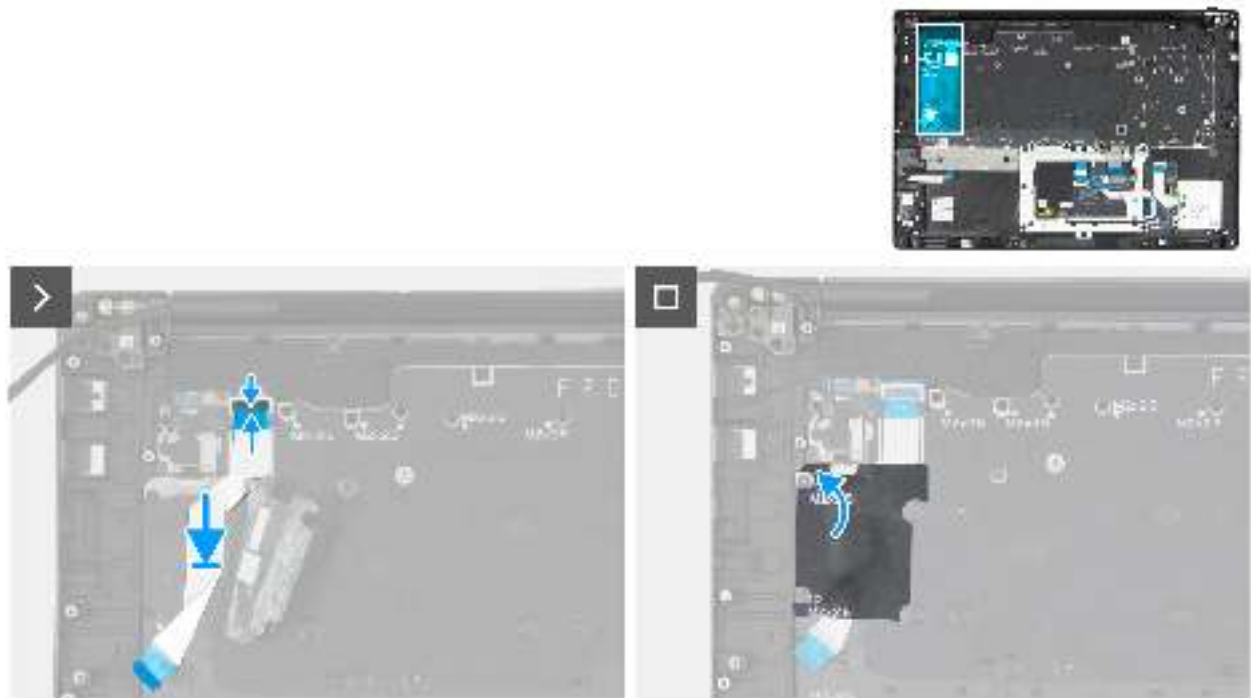
Abbildung 126. Einbauen des Kabels der Netzschalterplatine
