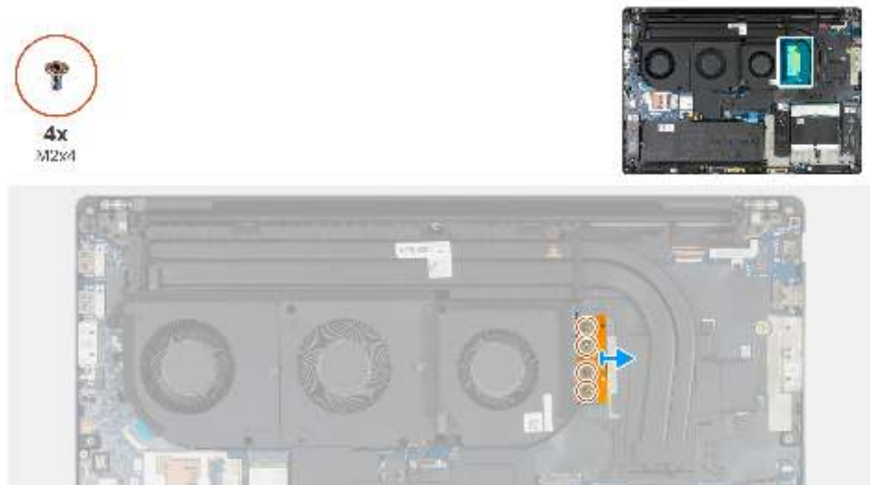
Abbildung 57. Entfernen des integrierten FPC-Trägerverbinders
