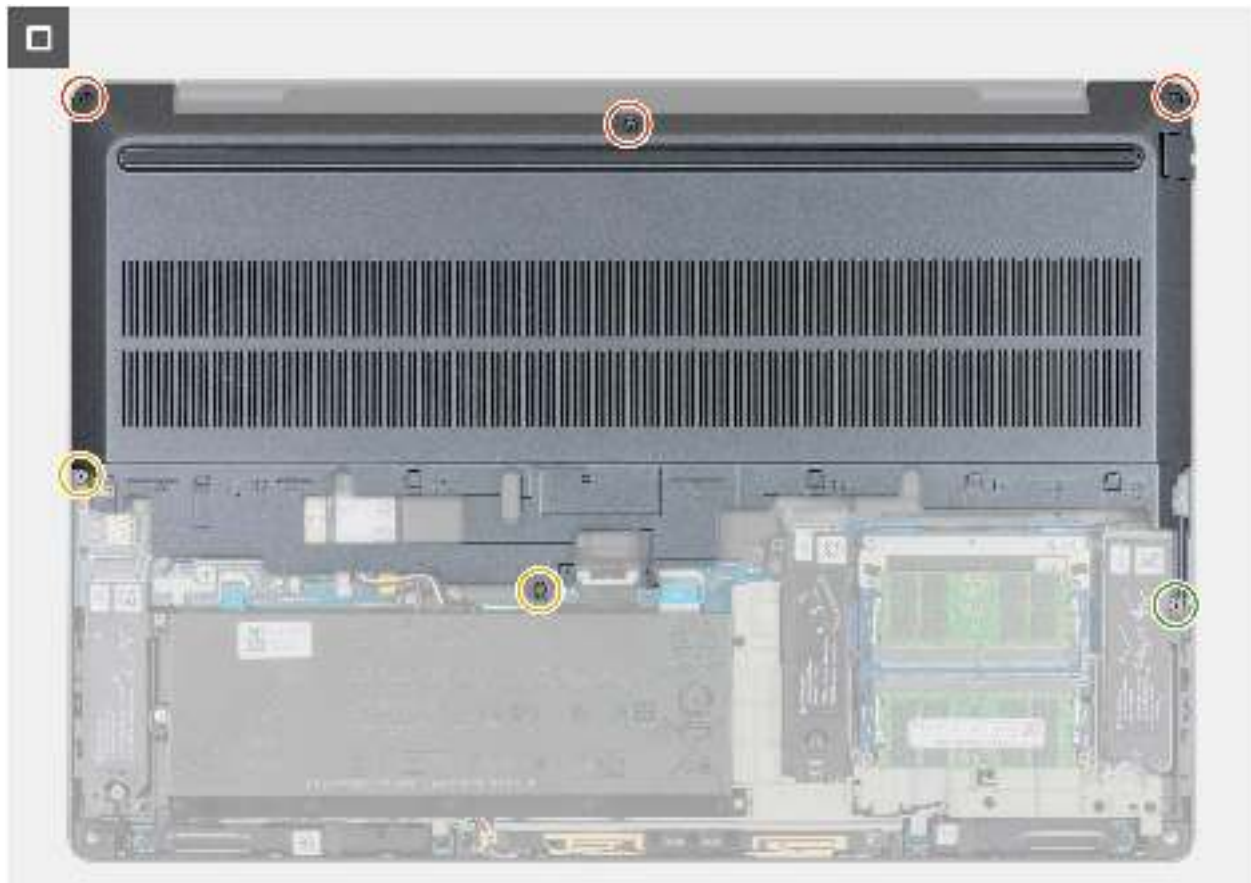
Abbildung 23. Anziehen der drei unverlierbaren Schrauben und Wiedereinsetzen der drei Schrauben
