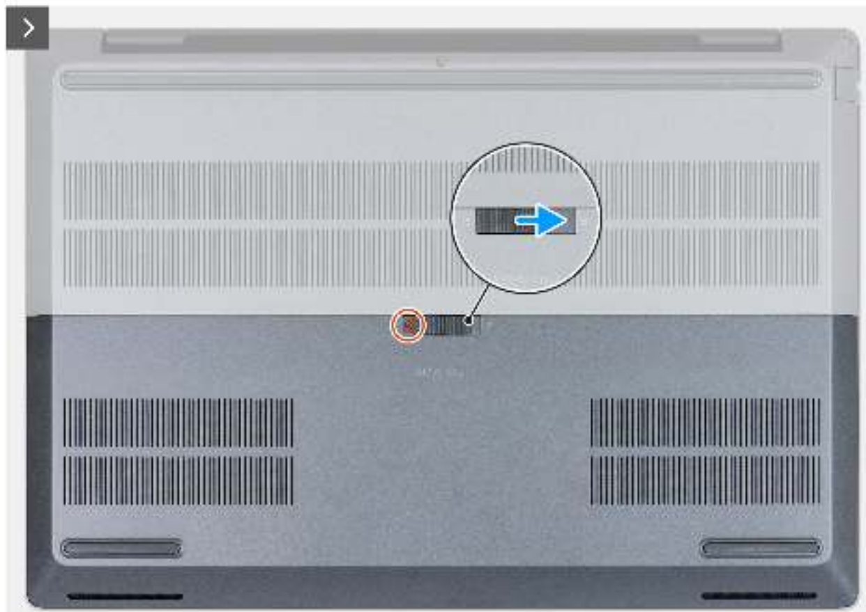
Abbildung 12. Schieben des Türschlosses in die Vorverriegelungsposition und Entfernen der Schraube
