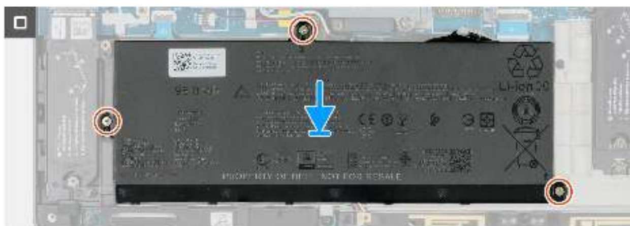
Abbildung 47. Wiedereinbauen des Akkus
