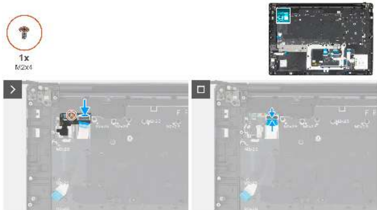
Abbildung 128. Einbauen der Netzschalterplatine
