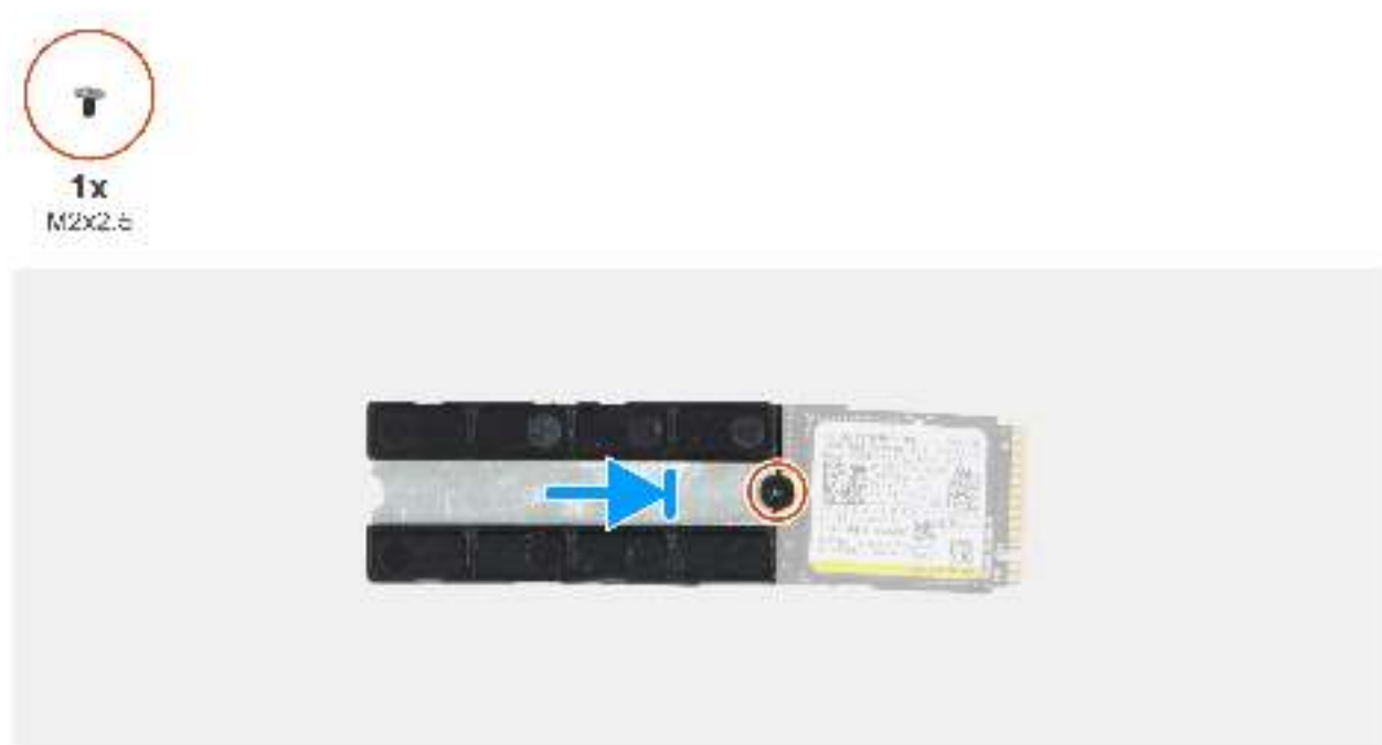
Abbildung 43. Einbauen des M.2-2280-SSD
