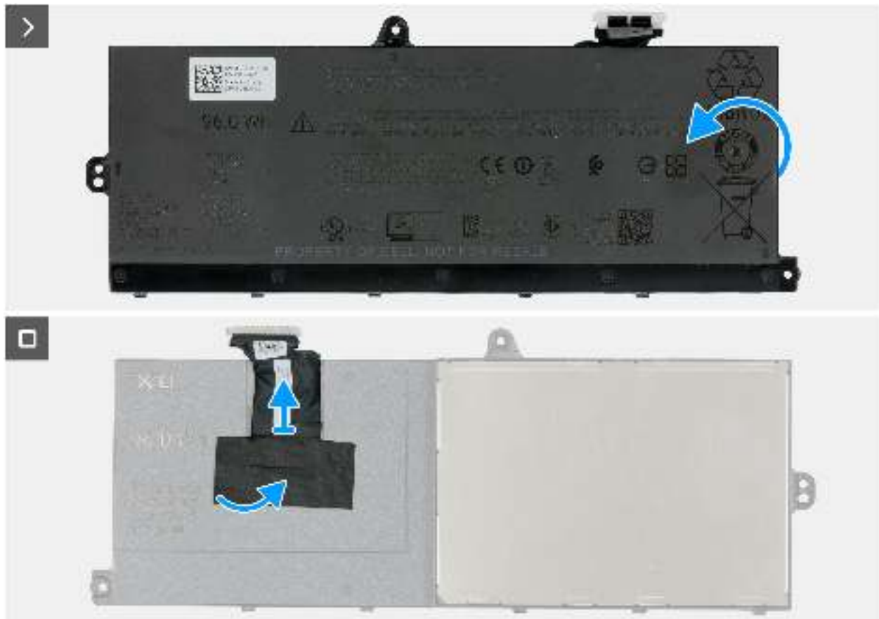
Abbildung 45. Entfernen des Akkukabels vom Akku
