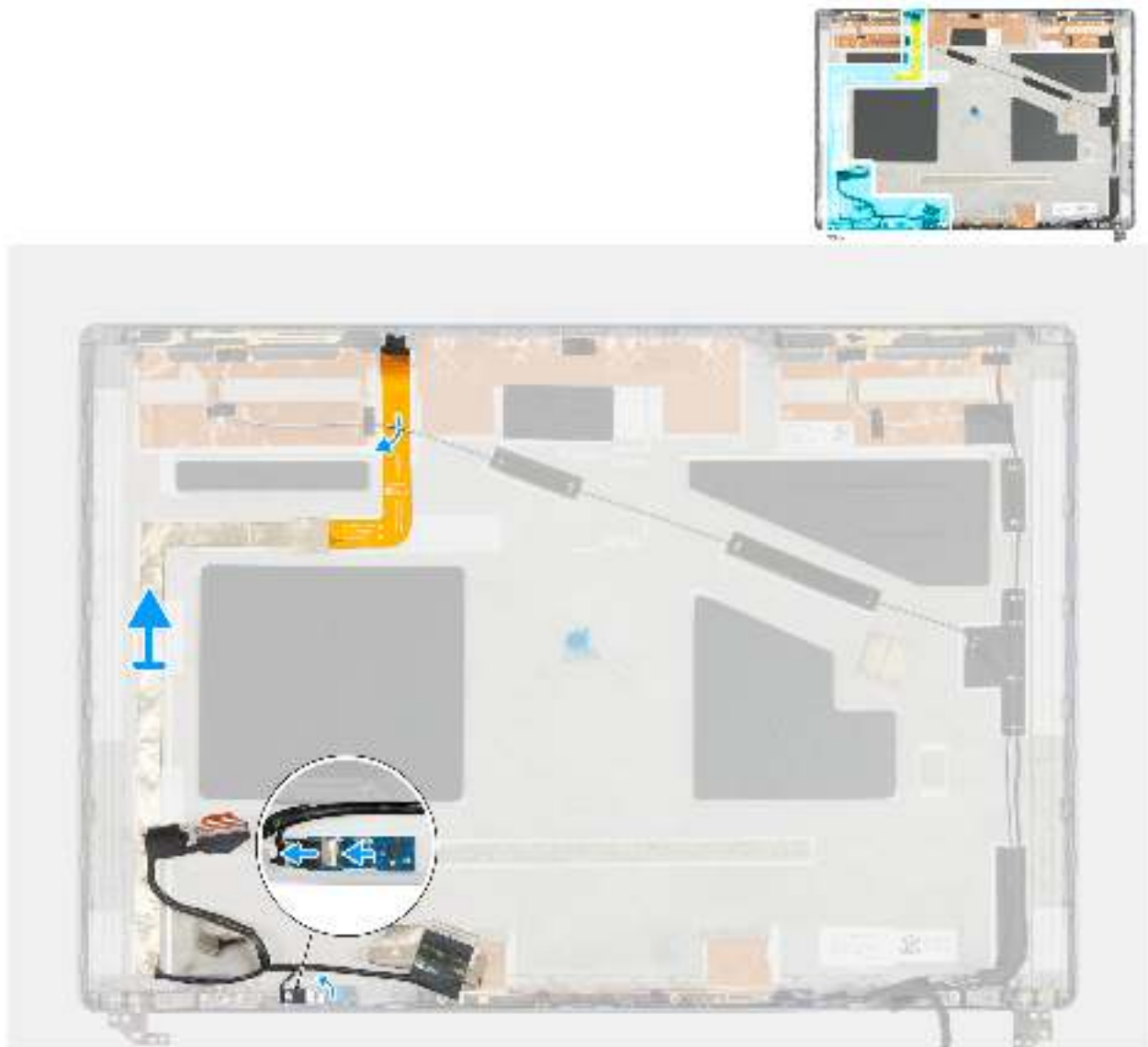
Abbildung 104. Entfernen des Bildschirmkabels
