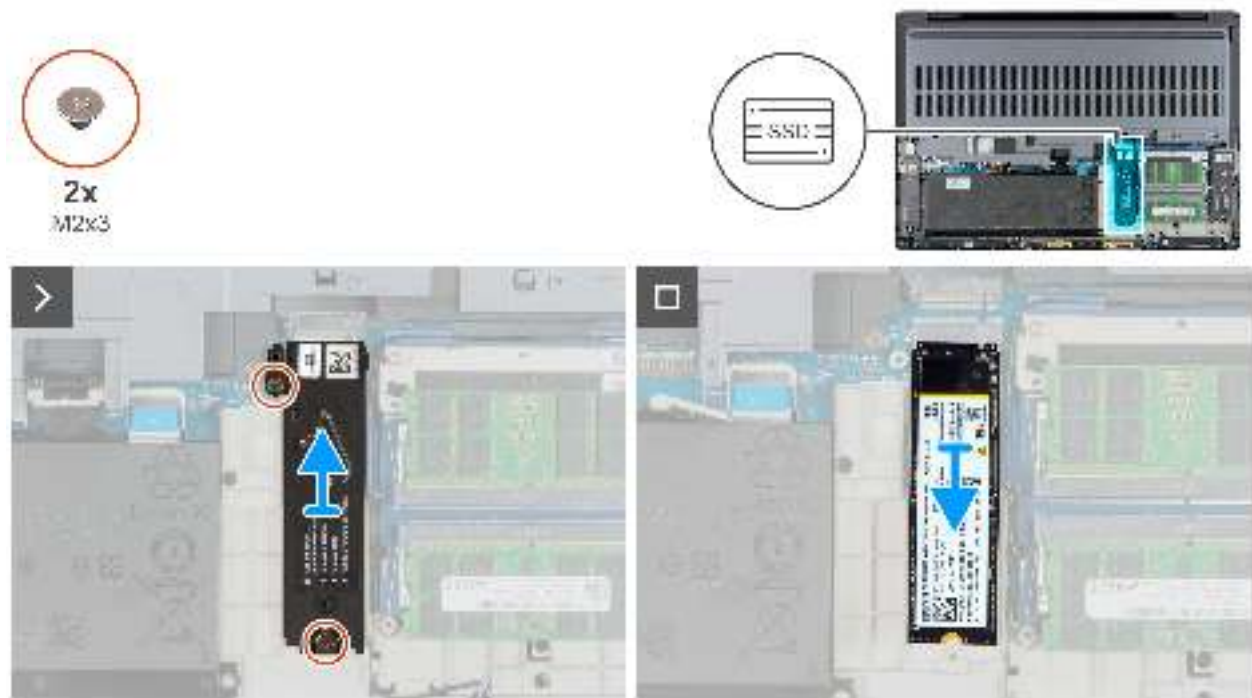
Abbildung 36. Entfernen der M.2-2280-SSD aus Steckplatz 3 (SSD3)
