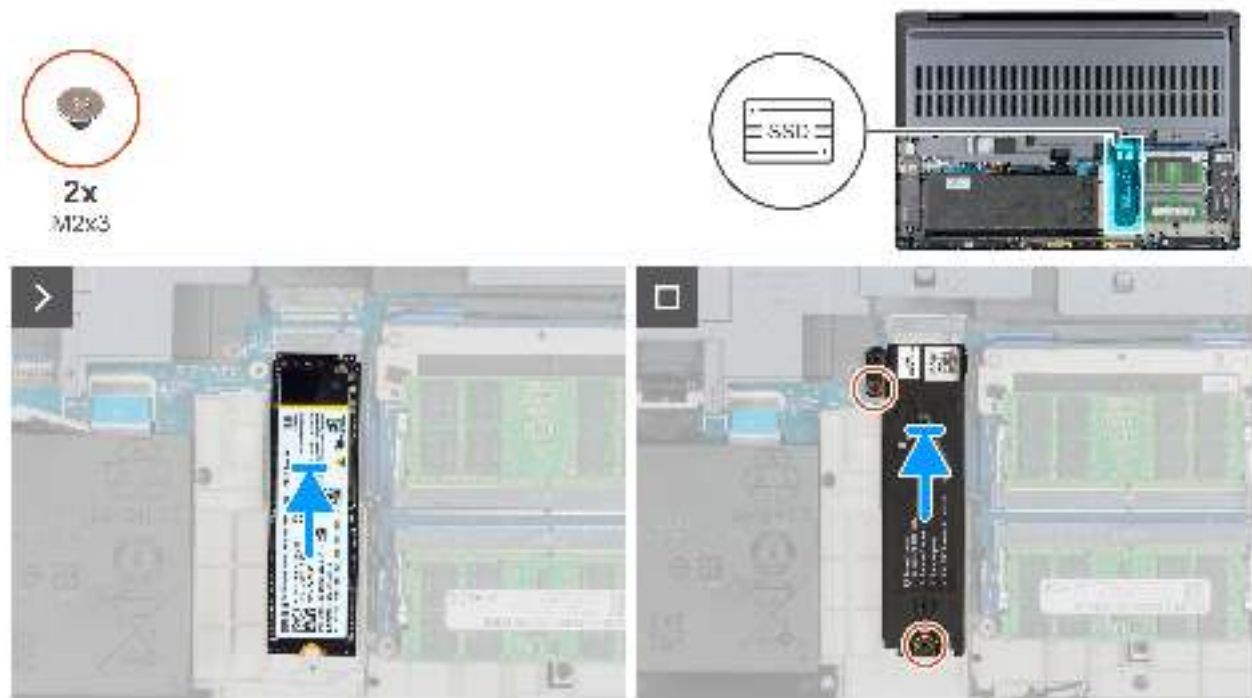
Abbildung 39. Installieren der M.2-2280-SSD in Steckplatz 2 (SSD2)
