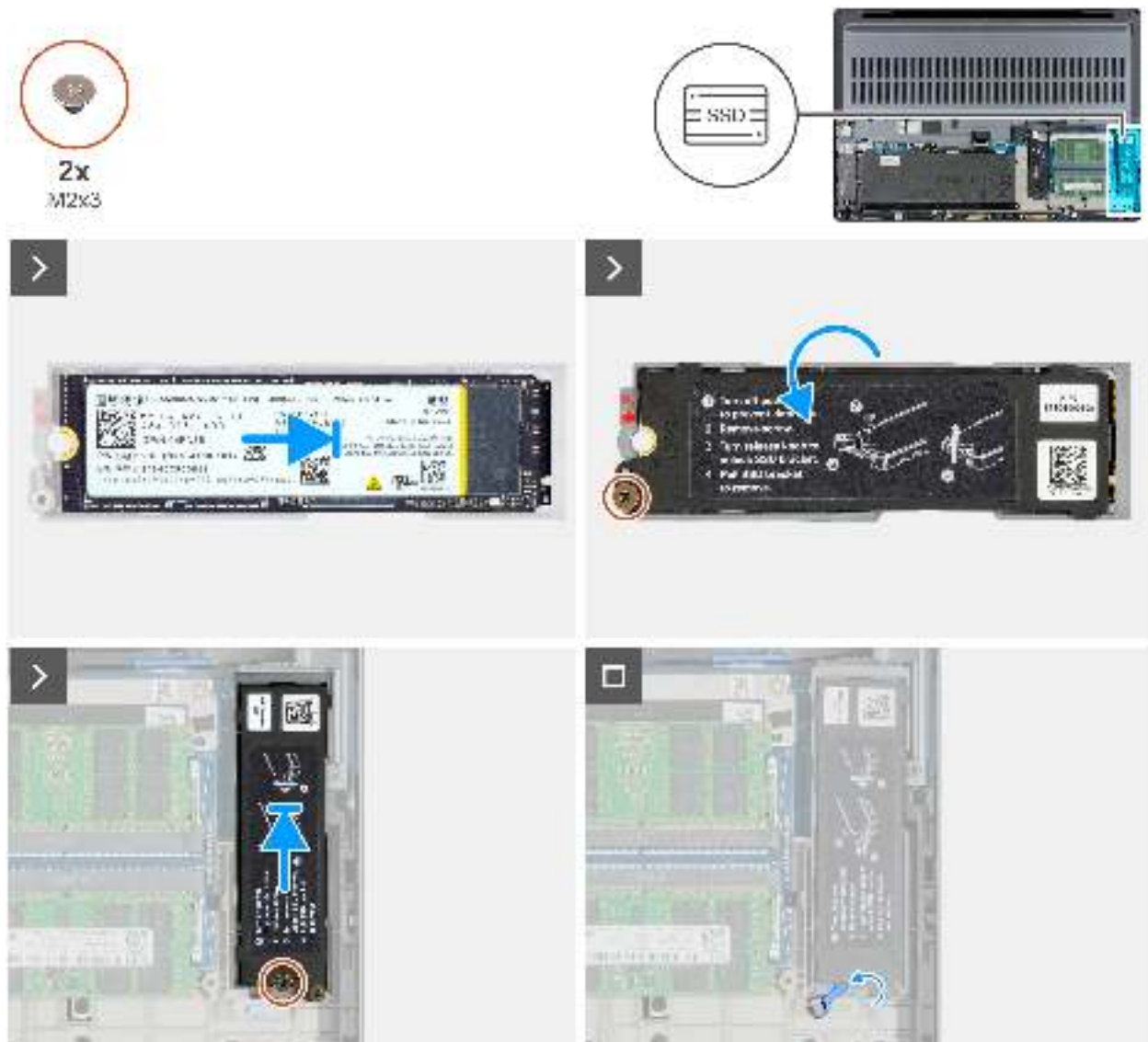
Abbildung 35. Installieren der M.2-2280-SSD in Steckplatz 1 (SSD1)
