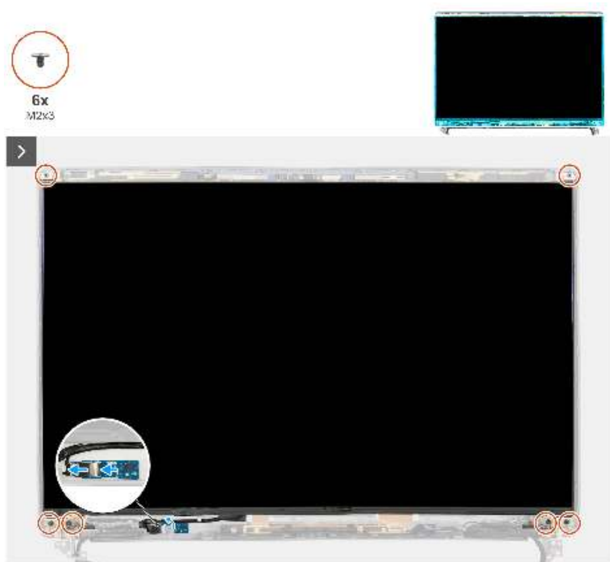
Abbildung 95. Entfernen des Bildschirms
