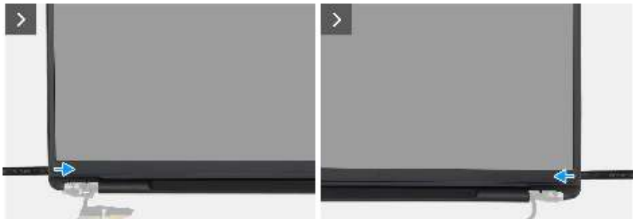
Abbildung 87. Entfernen der Bildschirmblende
