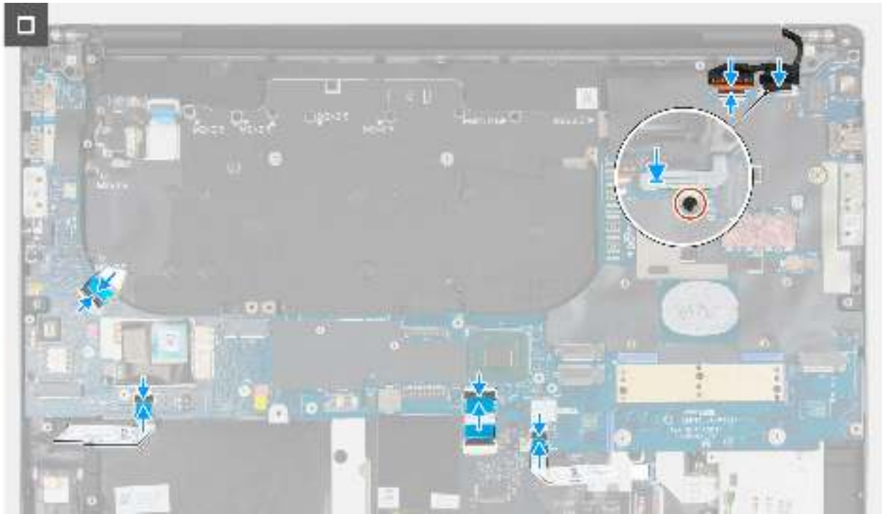
Abbildung 114. Einbauen der Systemplatine
