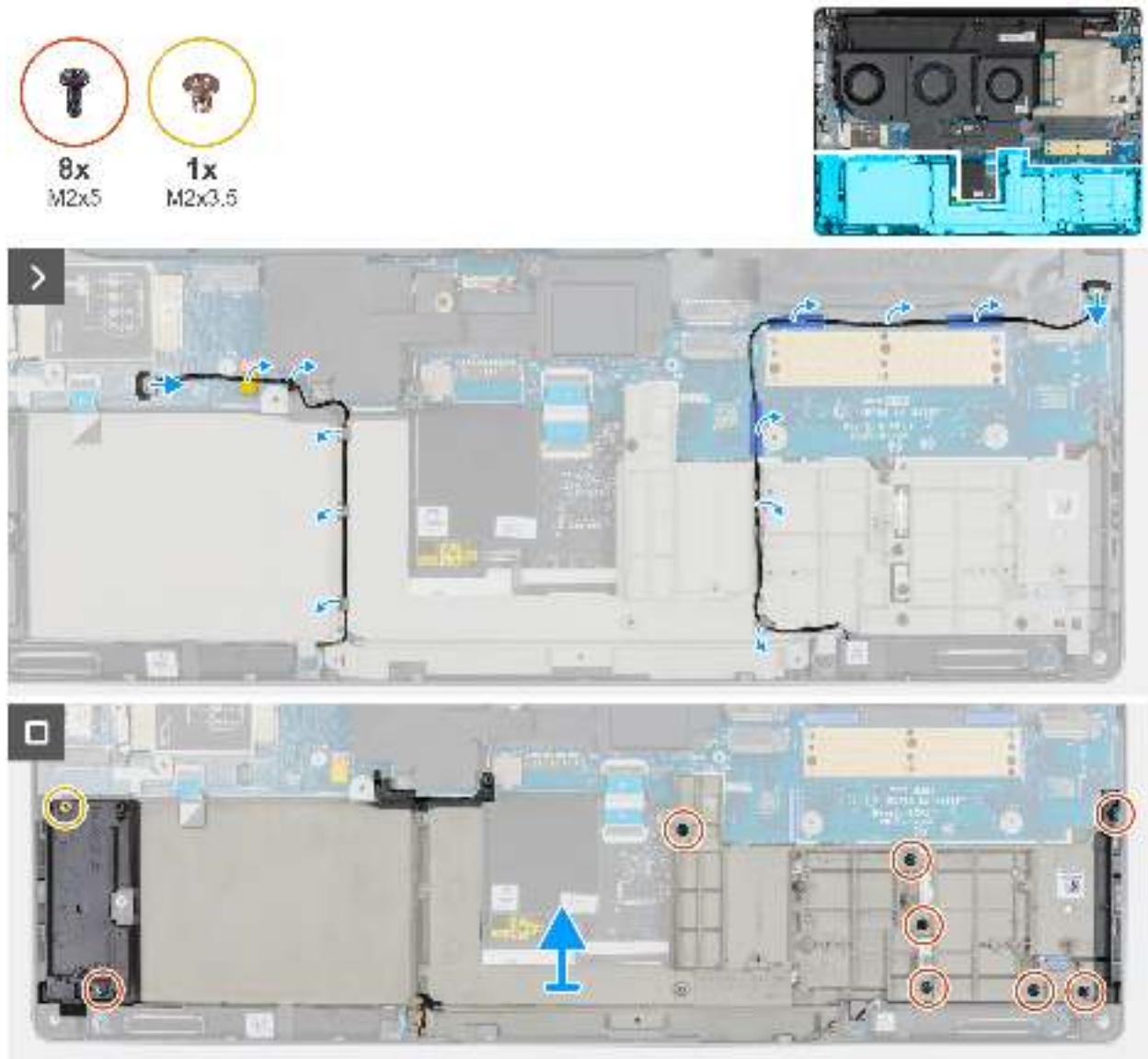
Abbildung 79. Entfernen des inneren Rahmens
