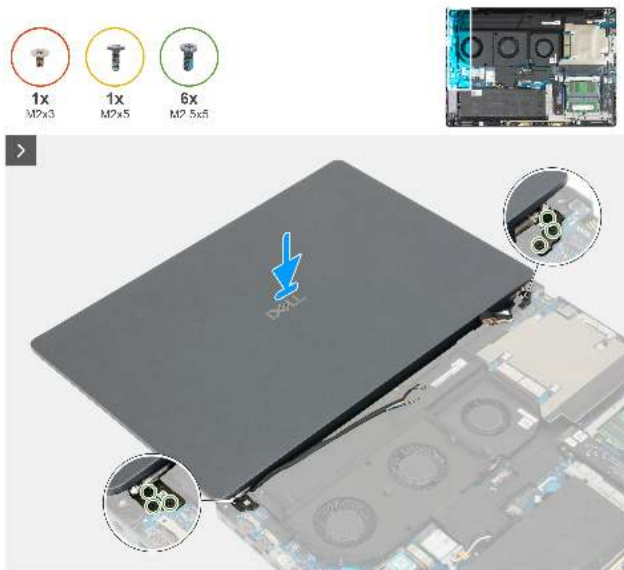
Abbildung 65. Einbauen der Bildschirmbaugruppe
