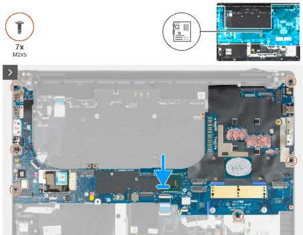
Abbildung 113. Einbauen der Systemplatine
