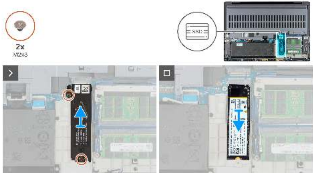
Abbildung 38. Entfernen der M.2-2280-SSD aus Steckplatz 2 (SSD2)
