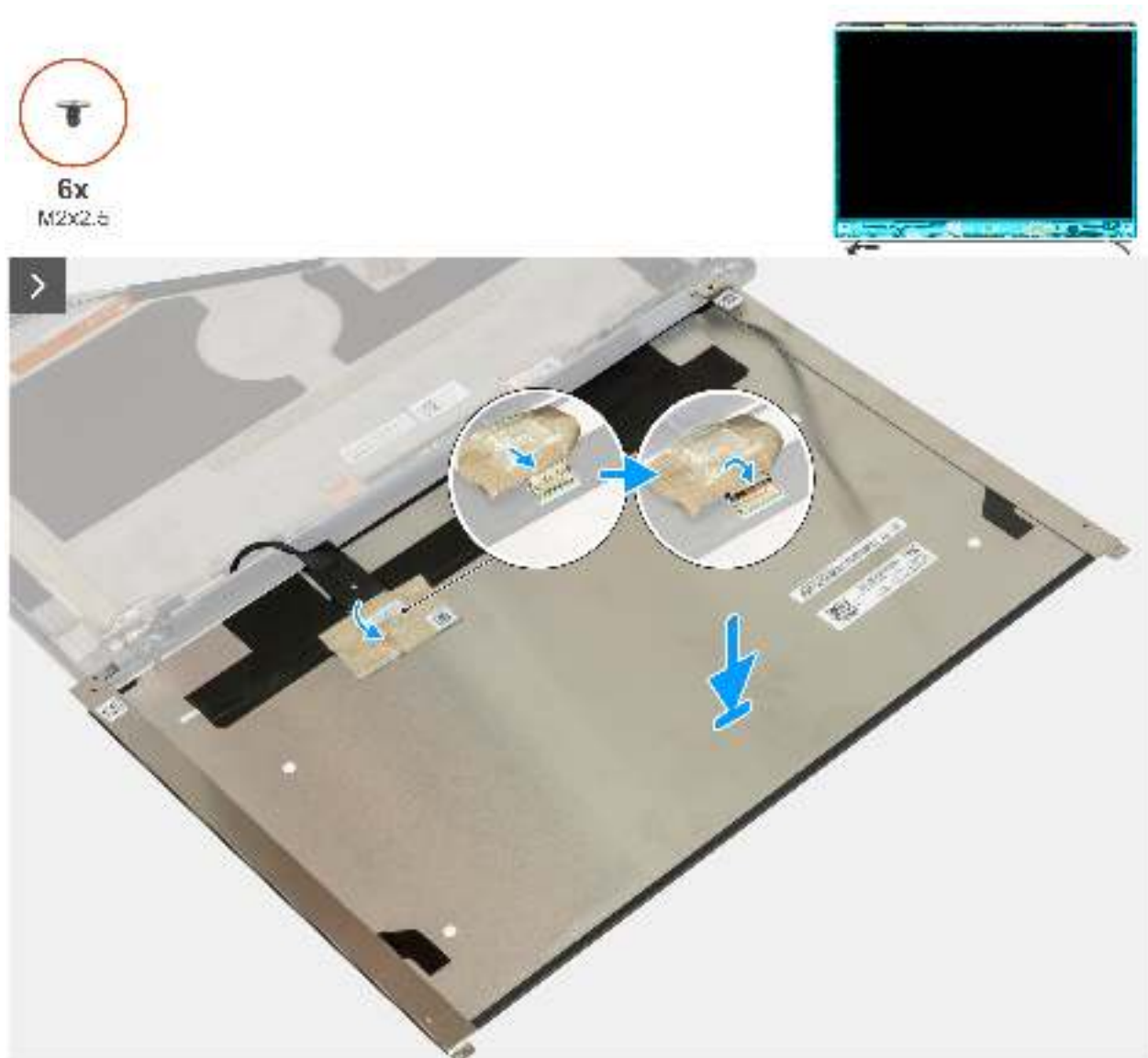
Abbildung 93. Einbauen des Bildschirms für Touchscreen-Displays
