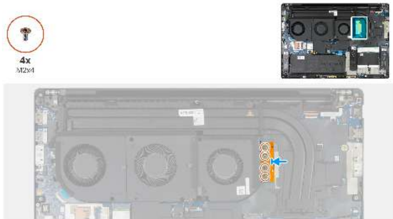
Abbildung 58. Installieren des integrierten FPC-Trägerverbinders
