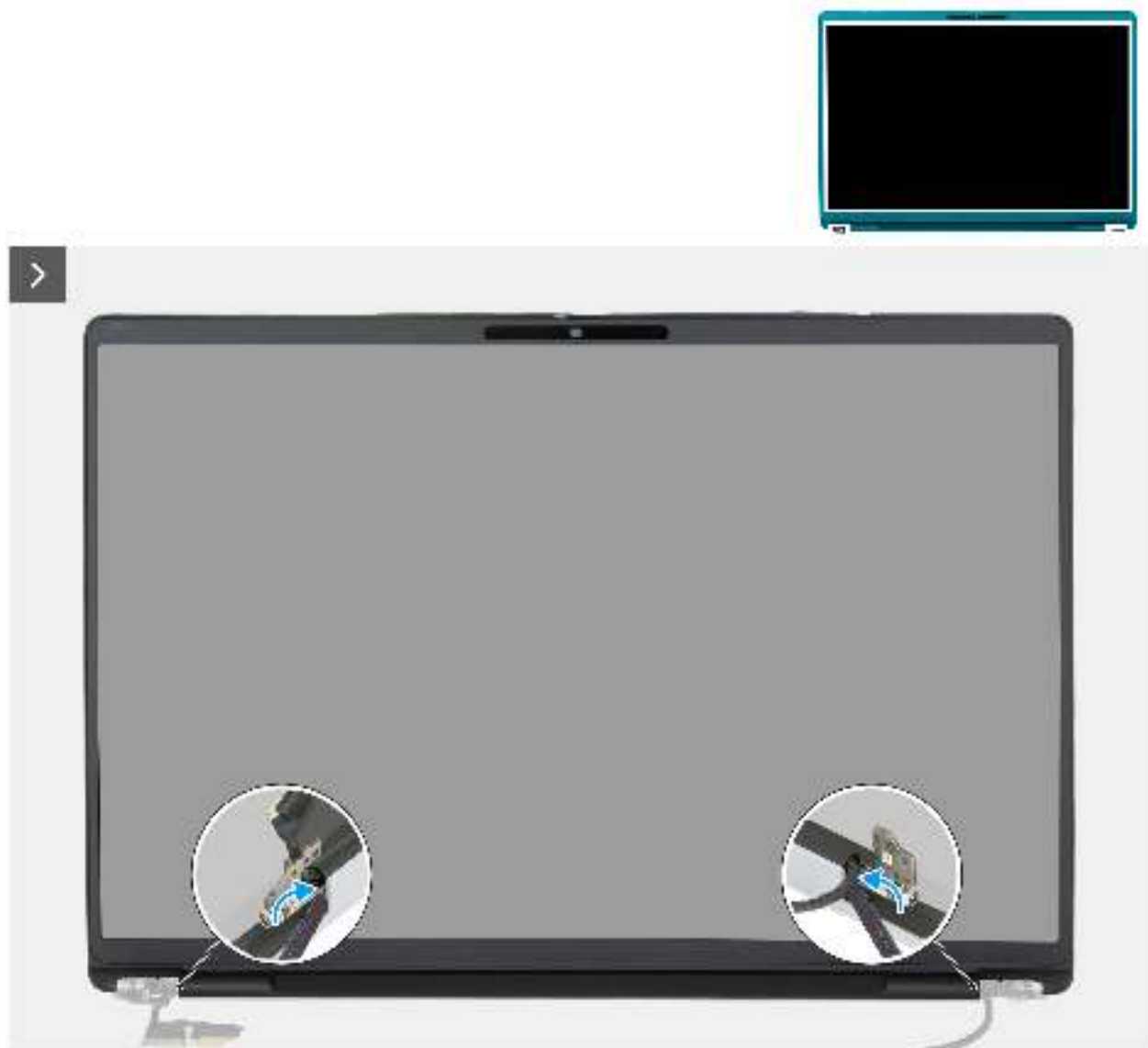
Abbildung 83. Entfernen der Bildschirmblende
