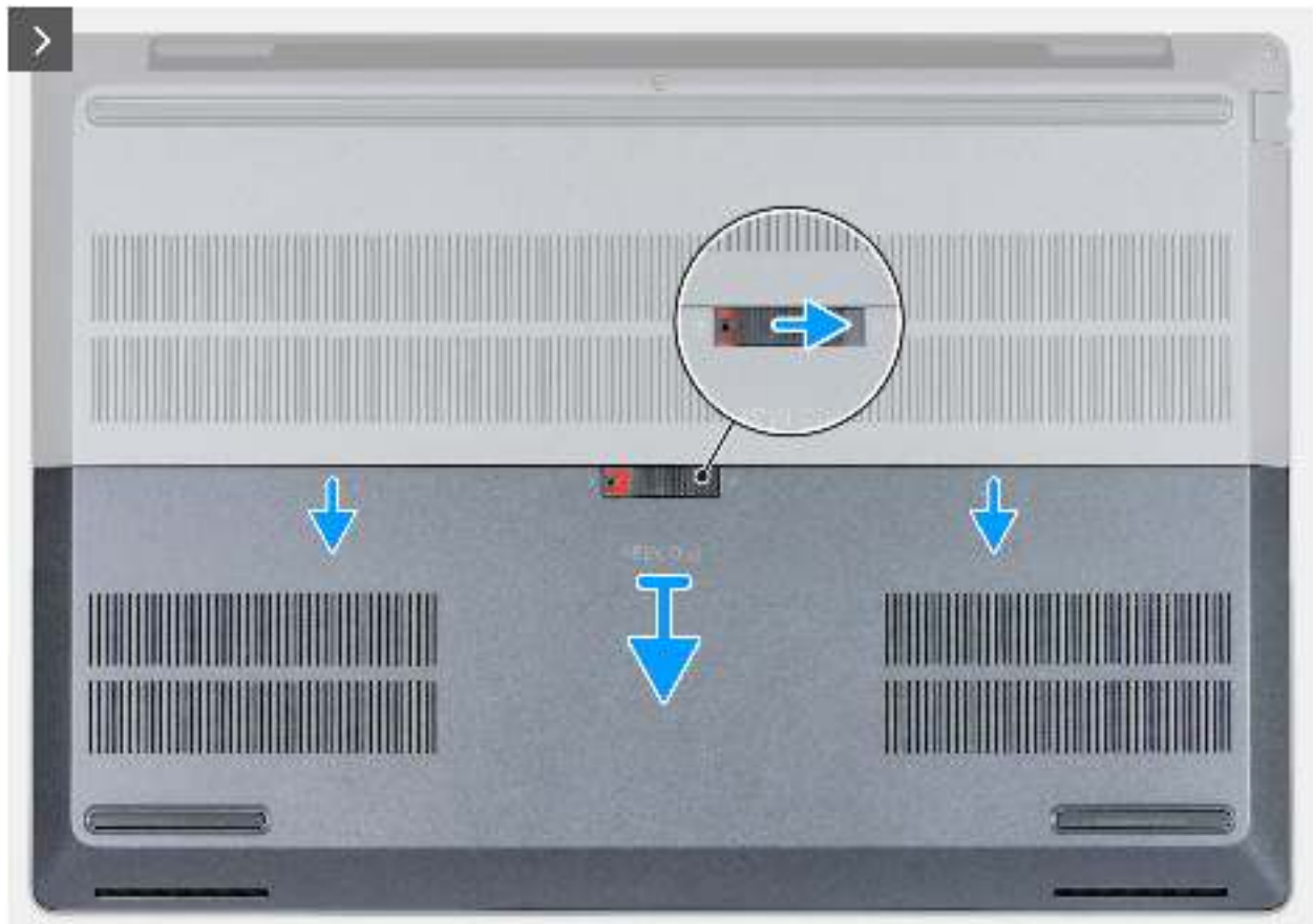
Abbildung 13. Schieben des Türschlosses in die entriegelte Position und Entfernen der Schiebetür
