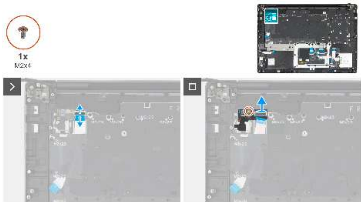
Abbildung 127. Entfernen der Netzschalterplatine
