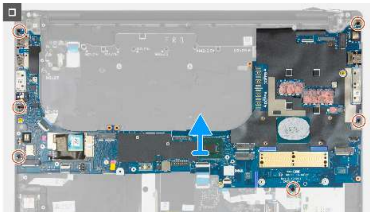
Abbildung 110. Entfernen der Systemplatine
