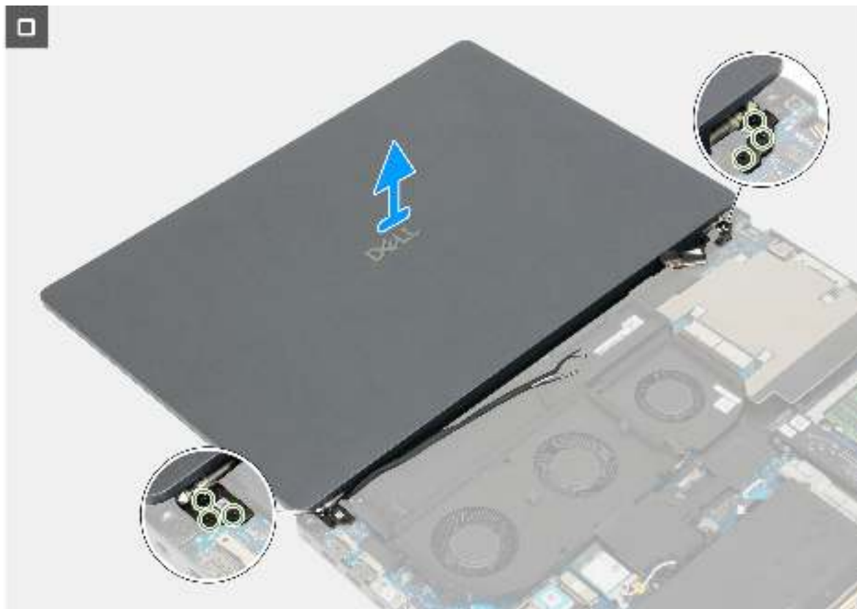
Abbildung 64. Entfernen der Bildschirmbaugruppe
