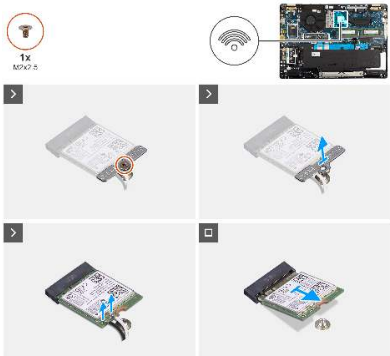
Abbildung 35. Entfernen der WLAN-Karte
