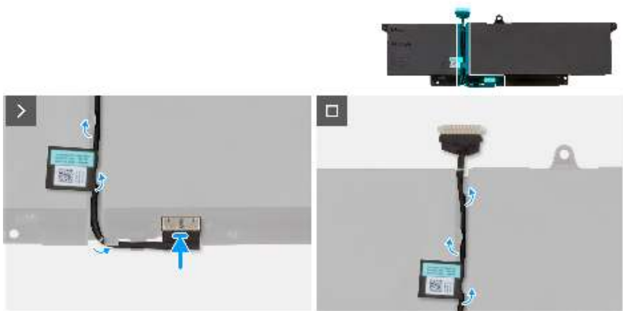
Abbildung 21. Einsetzen des Akkukabels
