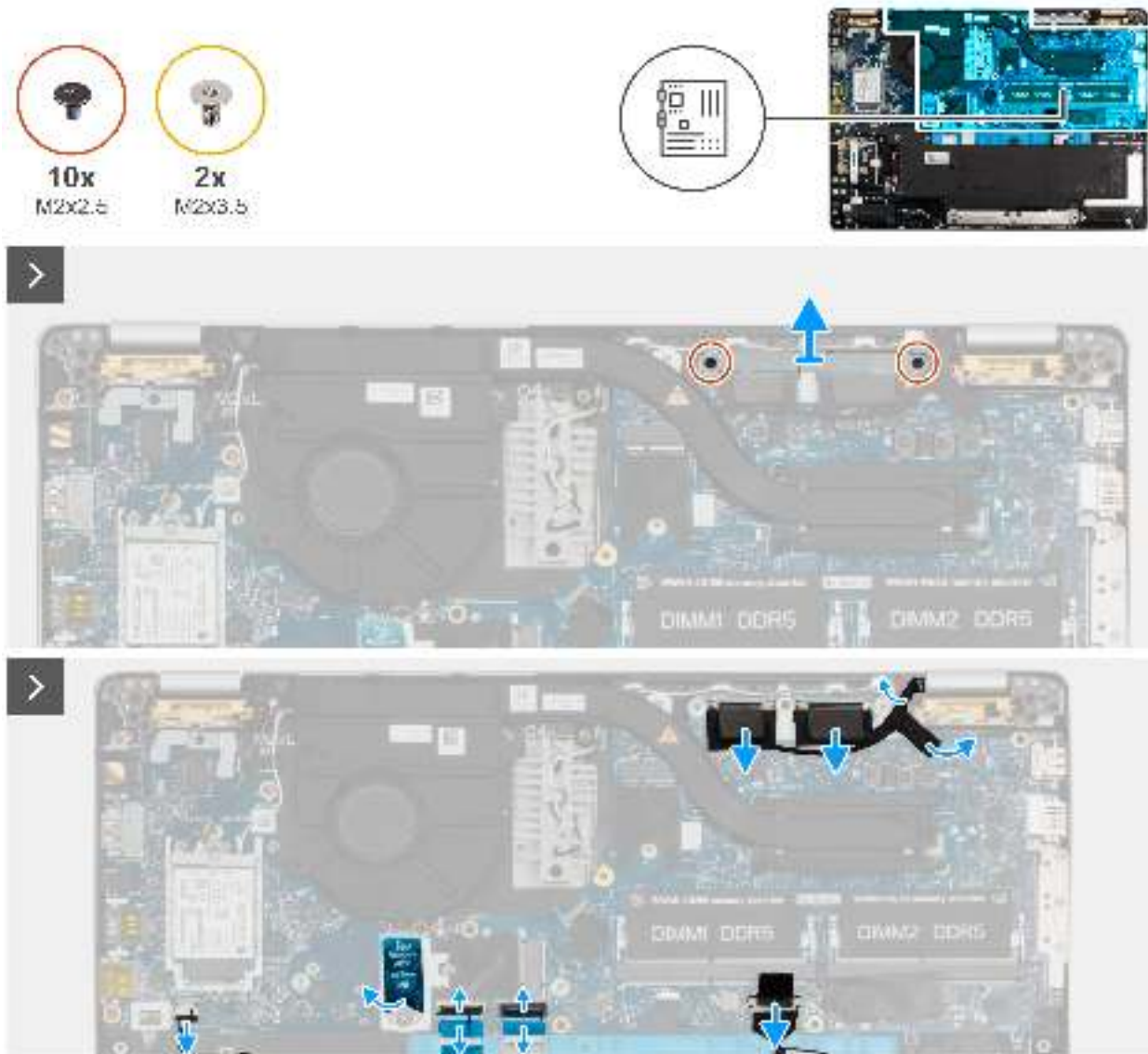
Abbildung 52. Entfernen der Hauptplatine
