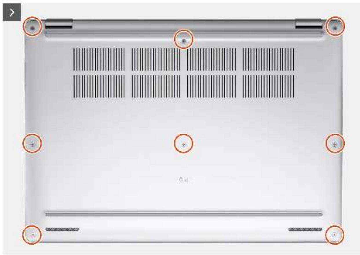
Abbildung 13. Entfernen der Bodenabdeckung
