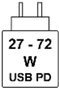
Abbildung 9. Piktogramm für die Anforderungen an die Stromversorgung
