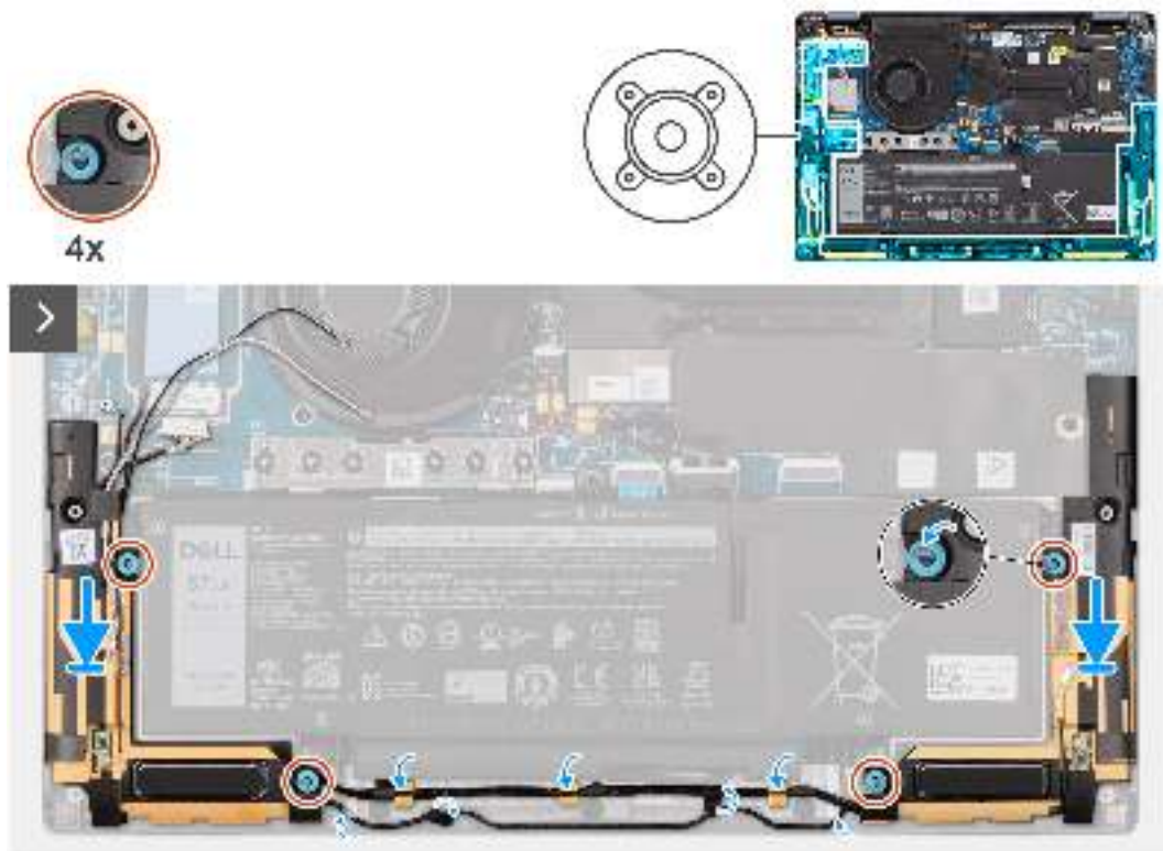
Abbildung 28. Installieren der Lautsprecher (Ultralight)
