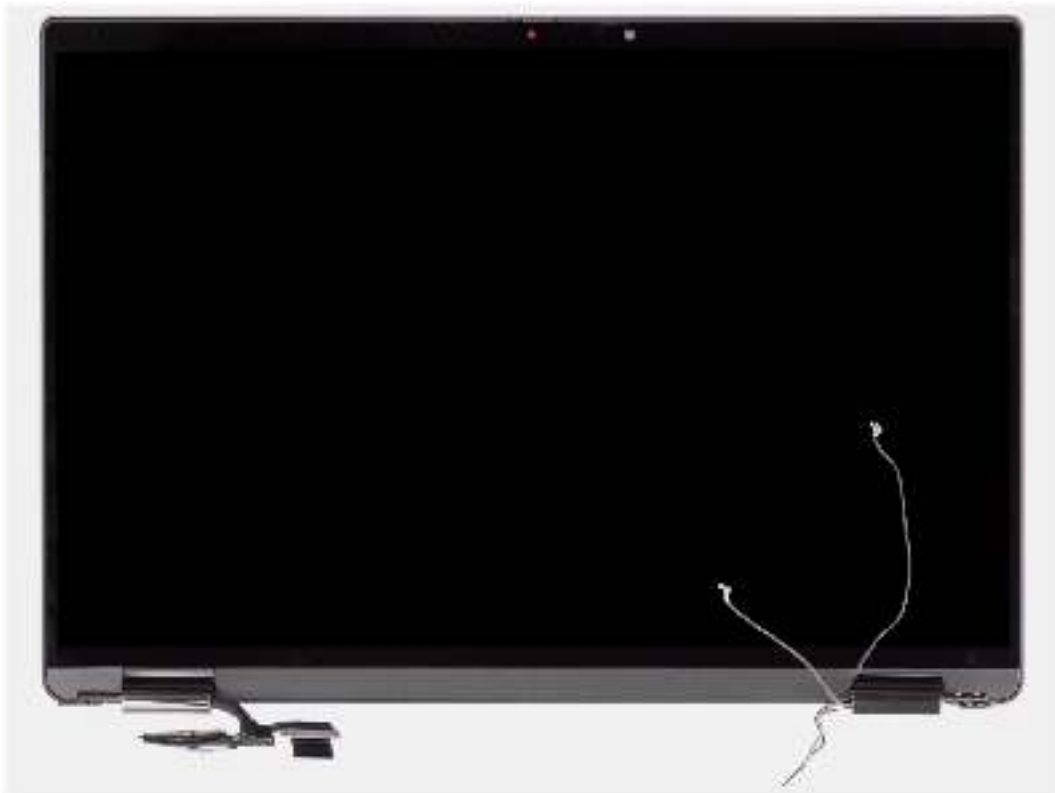
Abbildung 48. Displaybaugruppe mit WWAN-Antennenkabeln
