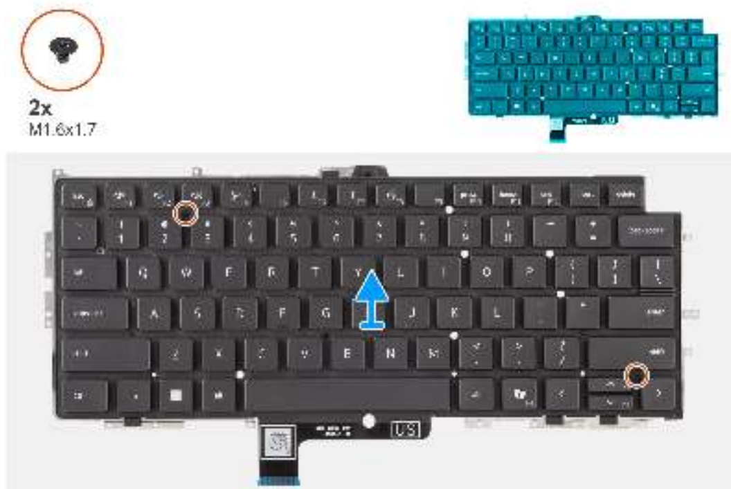
Abbildung 76. Entfernen der Tastatur
