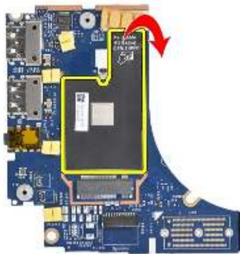
Abbildung 70. Latitude 7450 2-in-1 in der 4G-WWAN-Konfiguration (Dichtungsaufkleber)
