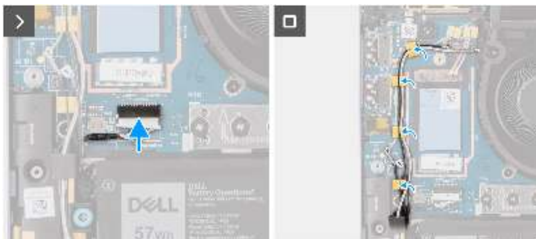
Abbildung 29. Installieren der Lautsprecher (Ultralight)
