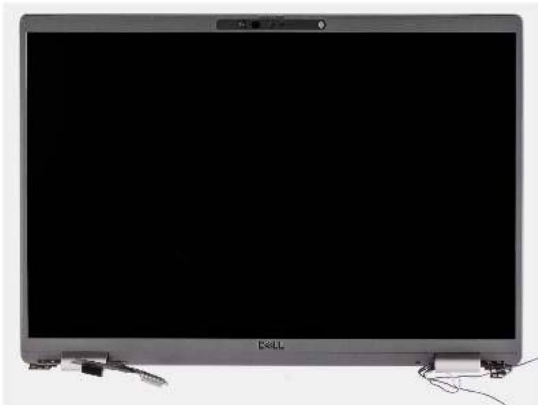
Abbildung 49. Displaybaugruppe mit WWAN-Antennenkabeln
