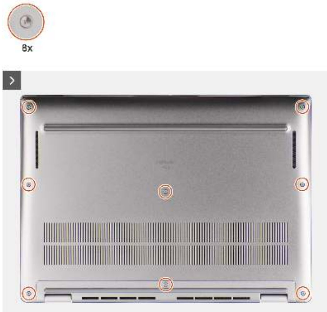
Abbildung 15. Entfernen der Bodenabdeckung
