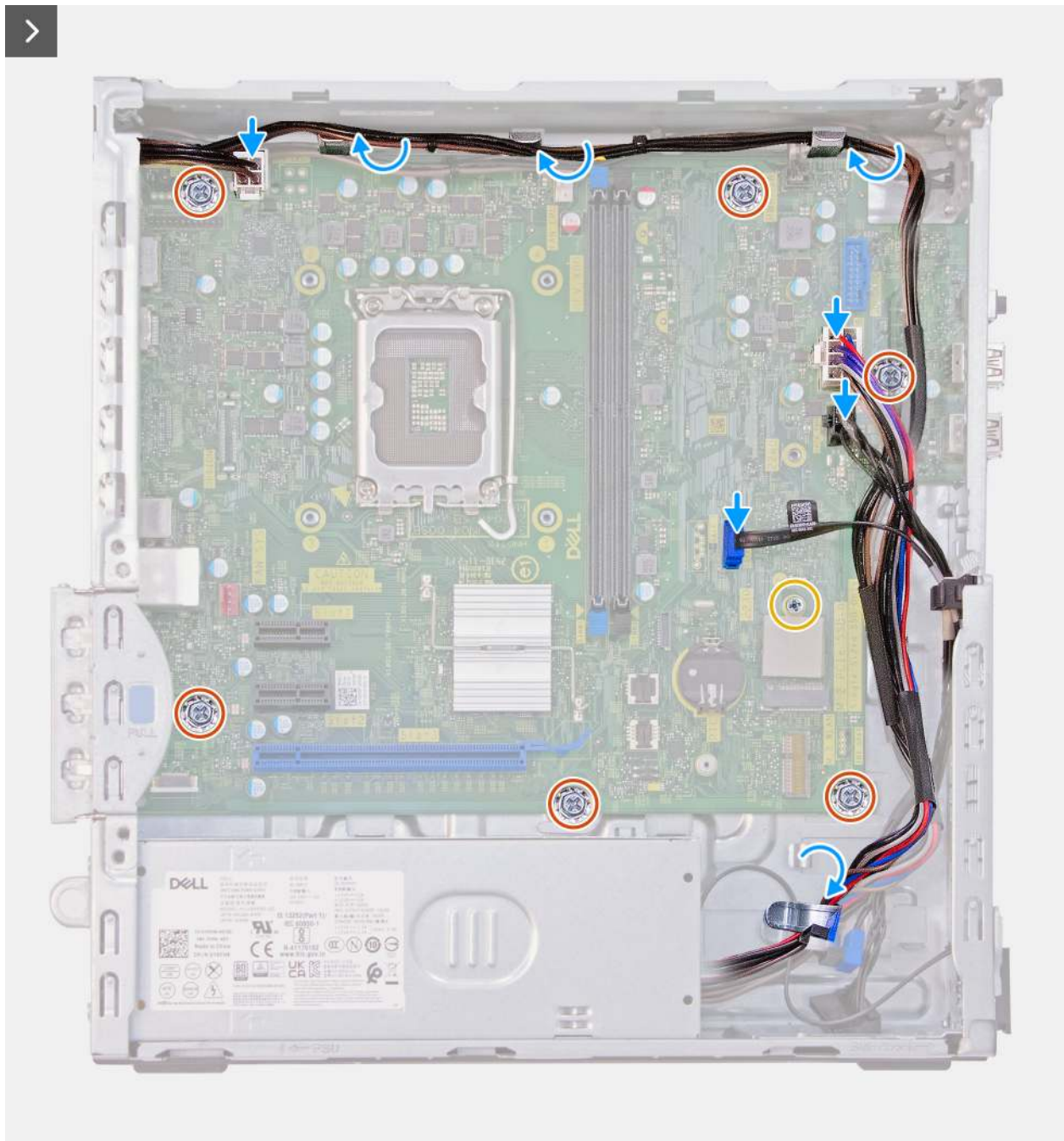
Abbildung 54. Einbauen der Systemplatine
