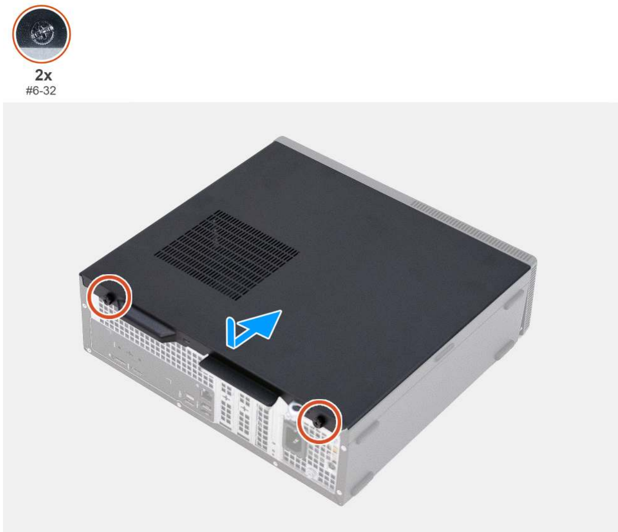
Abbildung 11. Installieren der linken Abdeckung
