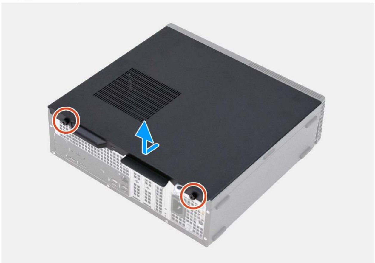
Abbildung 10. Entfernen der linken Abdeckung
