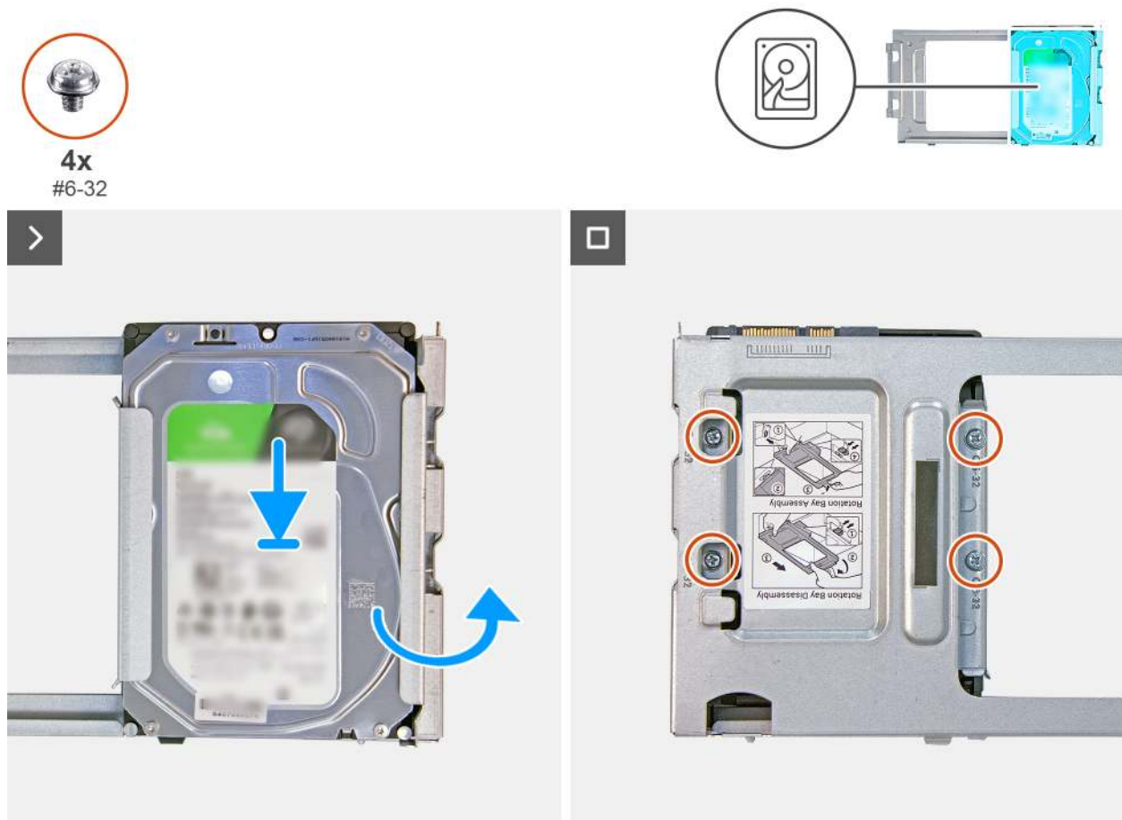
Abbildung 22. Einsetzen des Festplattenlaufwerks
