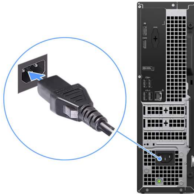
Abbildung 7. Anschließen des Stromkabels
