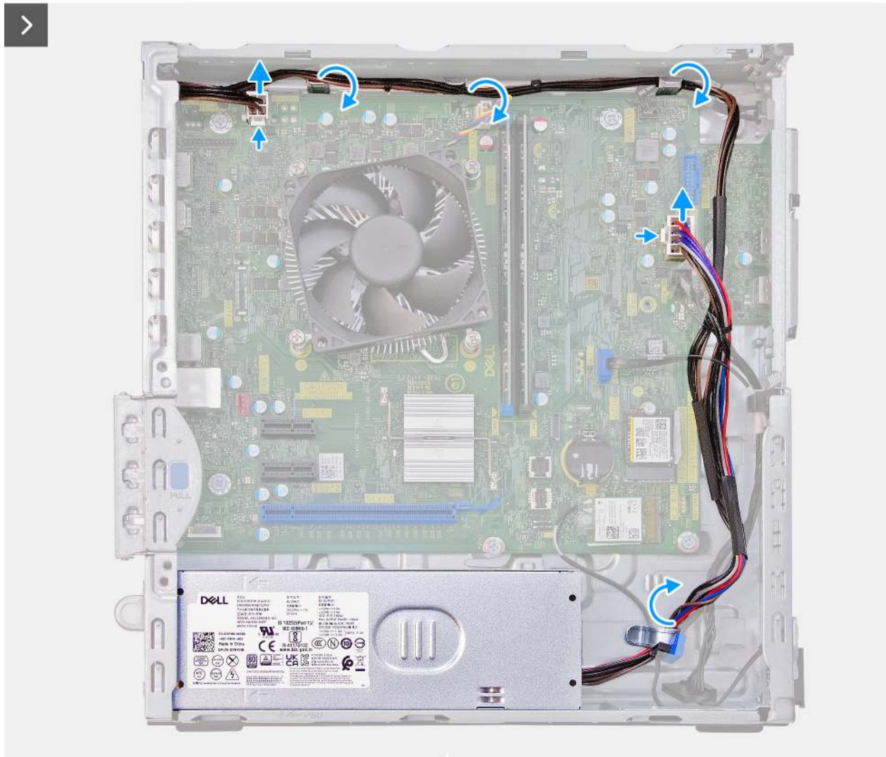
Abbildung 33. Entfernen der Stromversorgungseinheit
