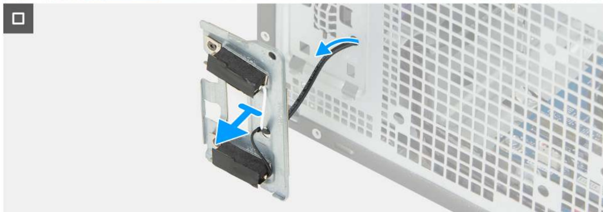
Abbildung 31. Entfernen des Antennenmoduls
