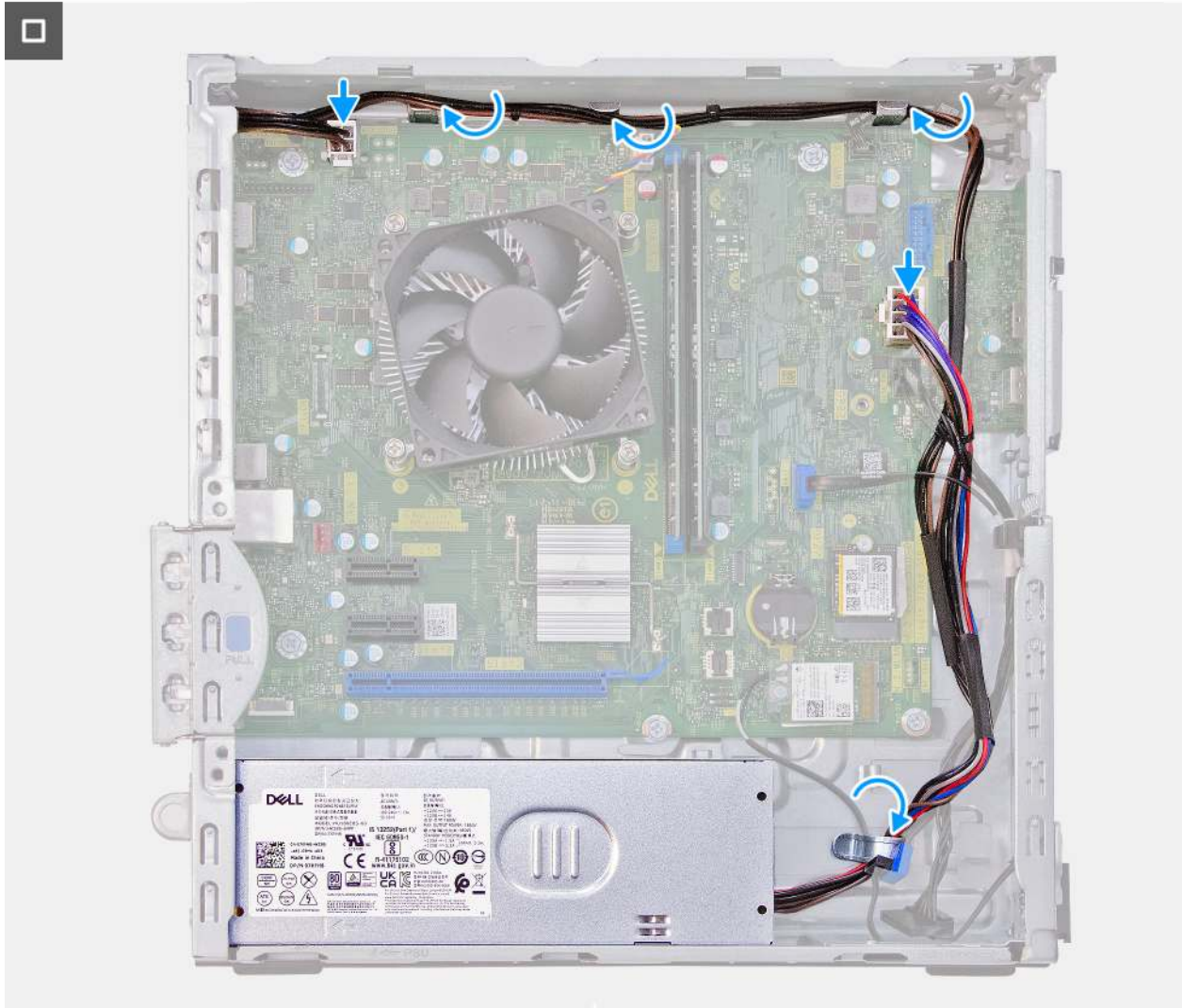
Abbildung 36. Installieren der Stromversorgungseinheit
