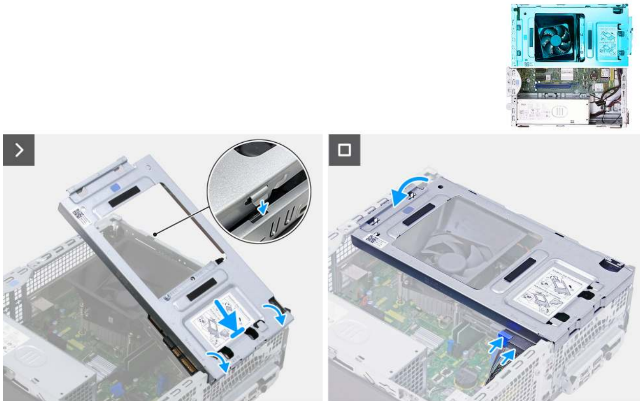
Abbildung 20. Einbauen des Laufwerkschachts
