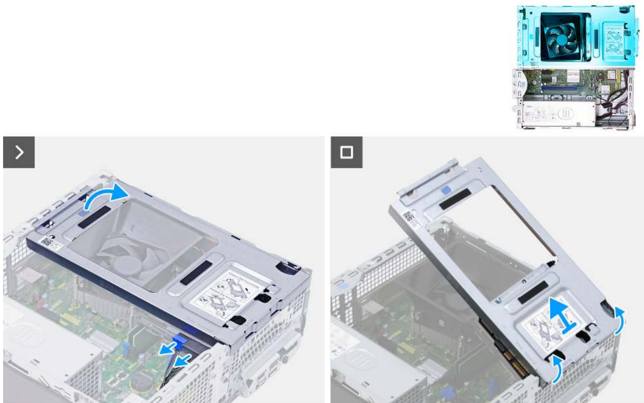
Abbildung 18. Entfernen des Laufwerksschachts
