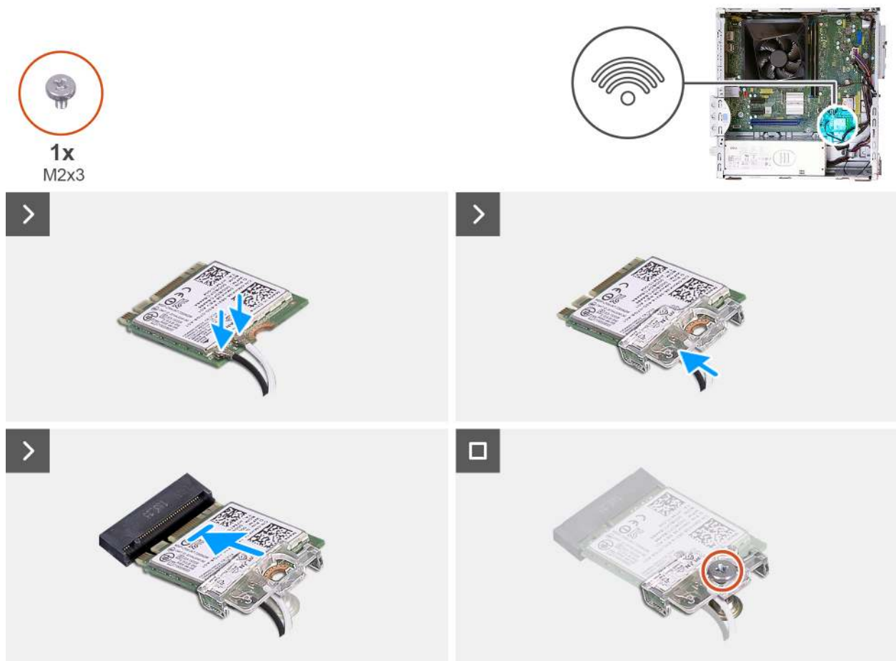
Abbildung 28. Installieren der Wireless-Karte
