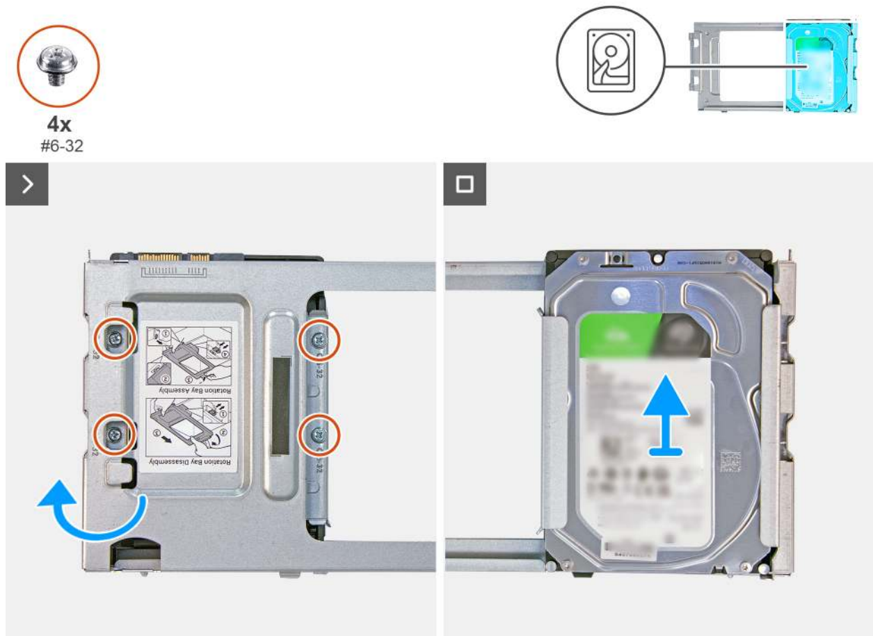
Abbildung 21. Entfernen der Festplatte
