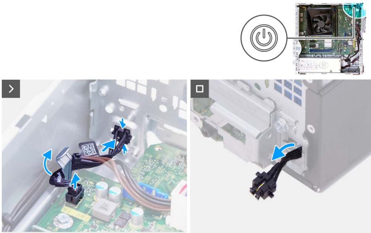
Abbildung 43. Entfernen des Netzschalters
