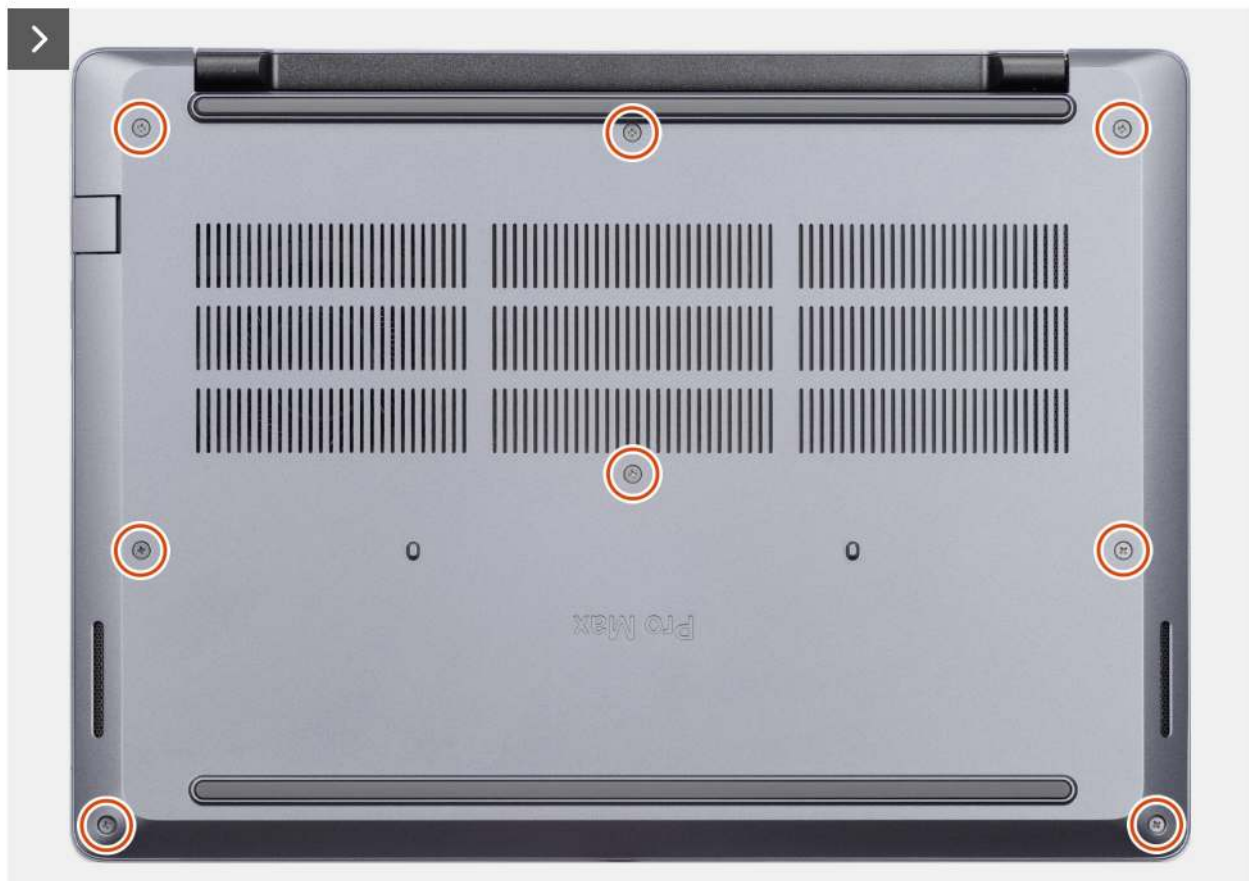
Abbildung 11. Entfernen der Bodenabdeckung
