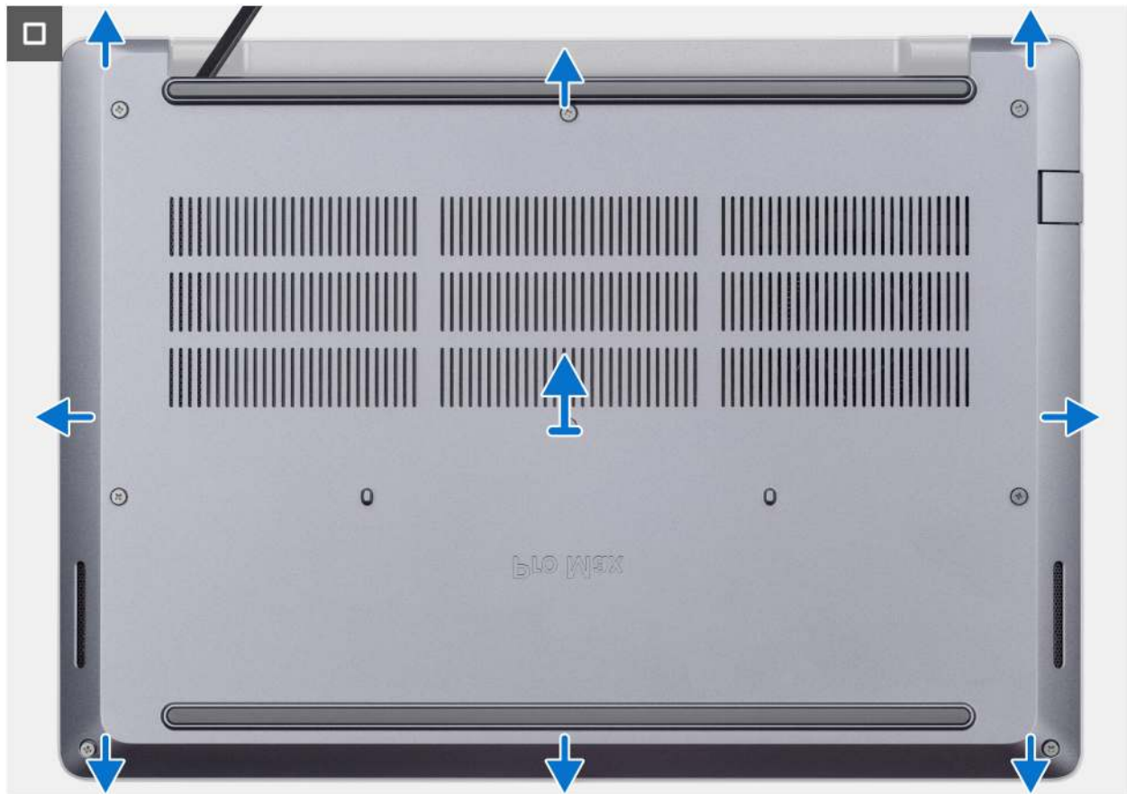
Abbildung 12. Entfernen der Bodenabdeckung
