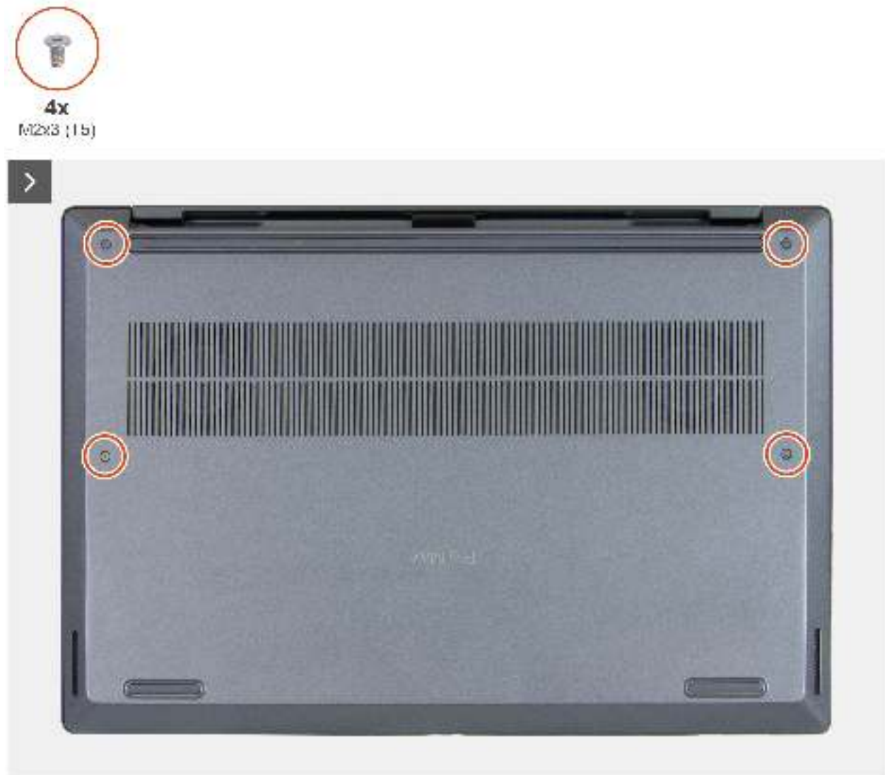
Abbildung 12. Entfernen der Bodenabdeckung
