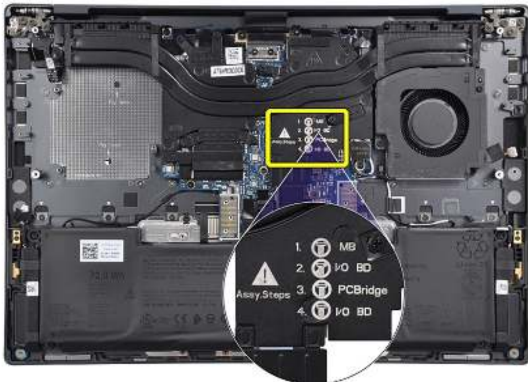
Abbildung 61. Auf dem Kühlkörper aufgedruckte Montageschritte
