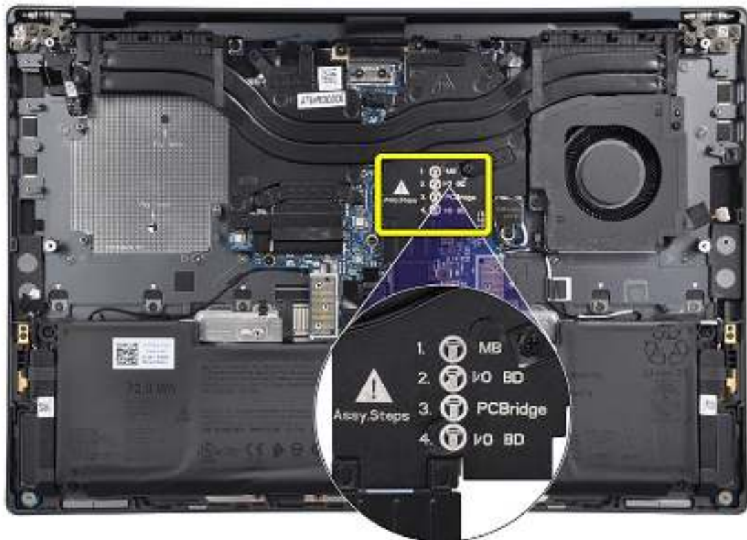
Abbildung 57. Auf dem Kühlkörper aufgedruckte Montageschritte
