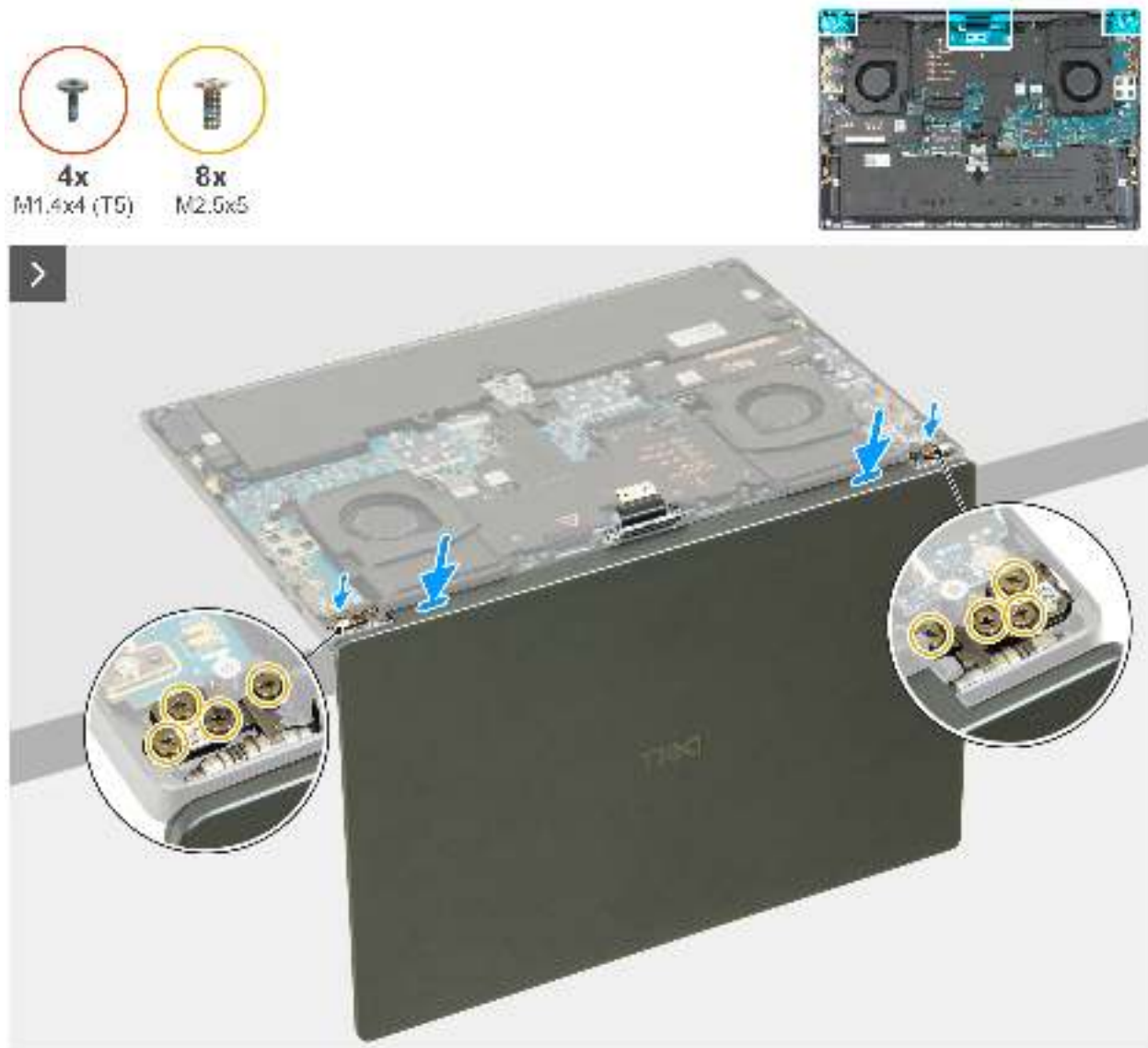
Abbildung 38. Einbauen der Bildschirmbaugruppe
