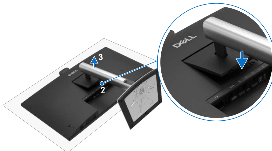
Abbildung 60. Entfernen des Monitorständers
