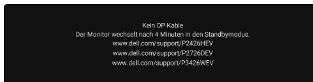
Abbildung 78. Warnmeldung: DP-Kabel nicht angeschlossen
