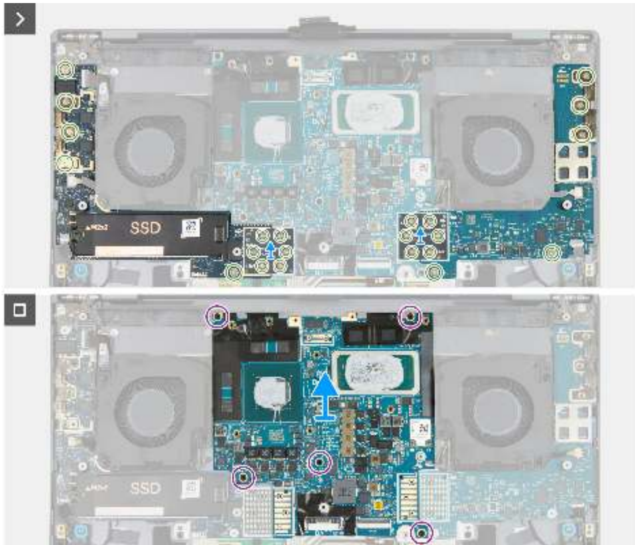
Abbildung 60. Entfernen der Hauptplatine (separate Grafikkarte)
