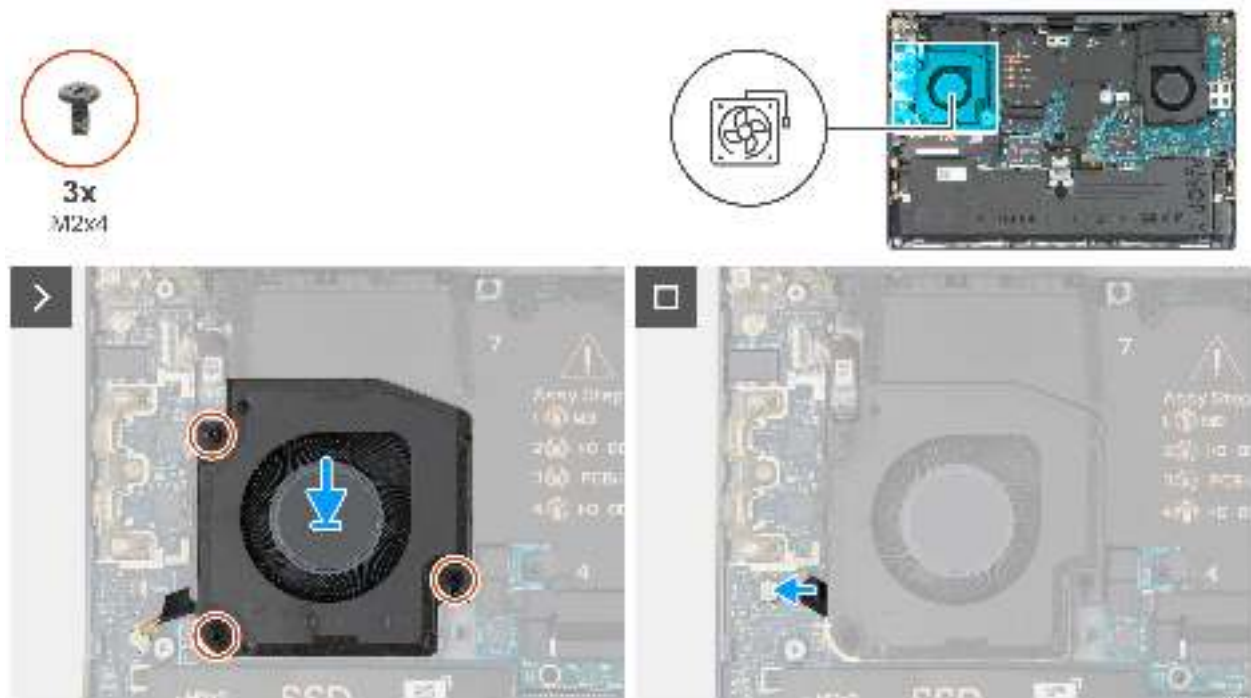
Abbildung 30. Installieren des rechten Lüfters
