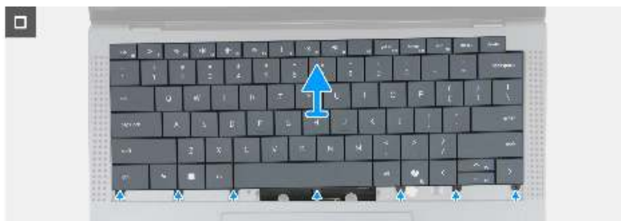
Abbildung 72. Entfernen der Tastatur
