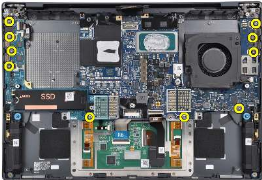
Abbildung 65. Schrauben der I/O-Platinen
