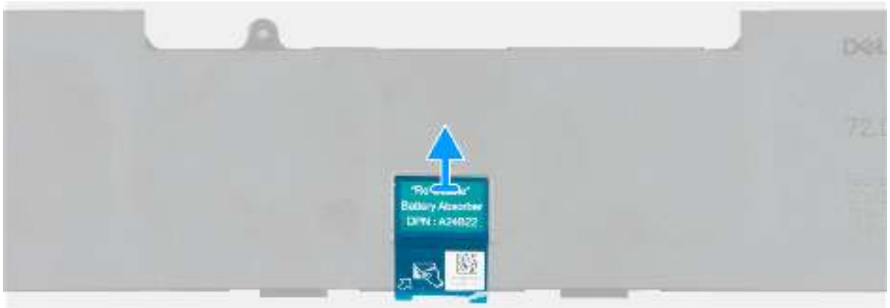
Abbildung 18. Entfernen des Batterieabsorbers
