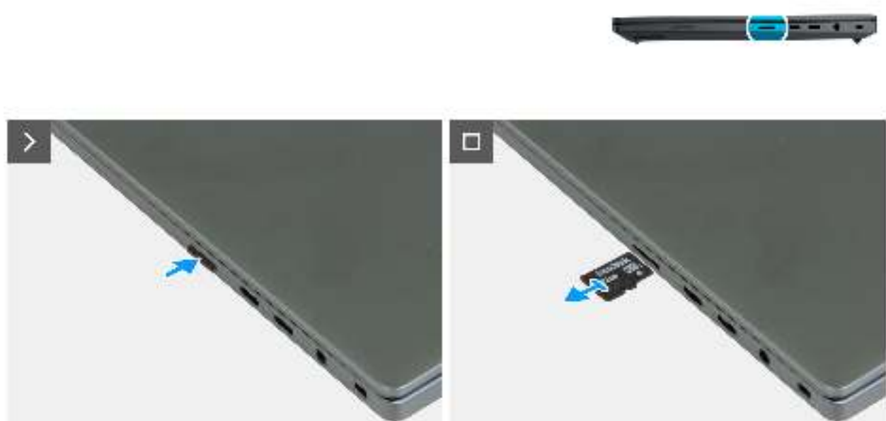
Abbildung 10. Entfernen der Speicherkarte
