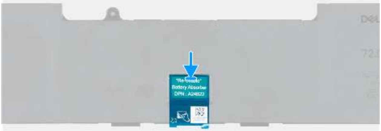
Abbildung 20. Einbauen des Batterieabsorbers
