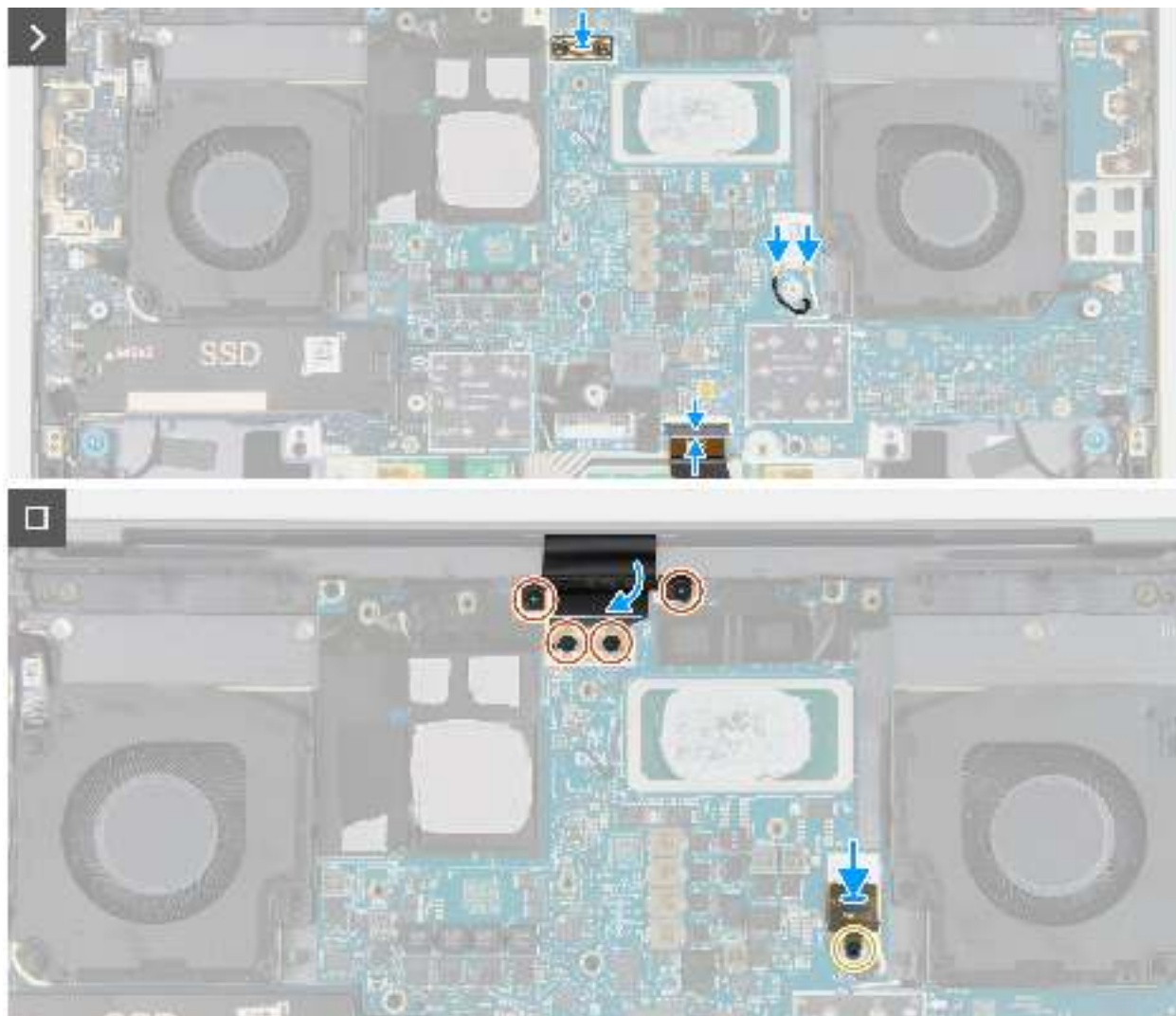
Abbildung 55. Einbauen der Hauptplatine (integrierte Grafikkarte)
