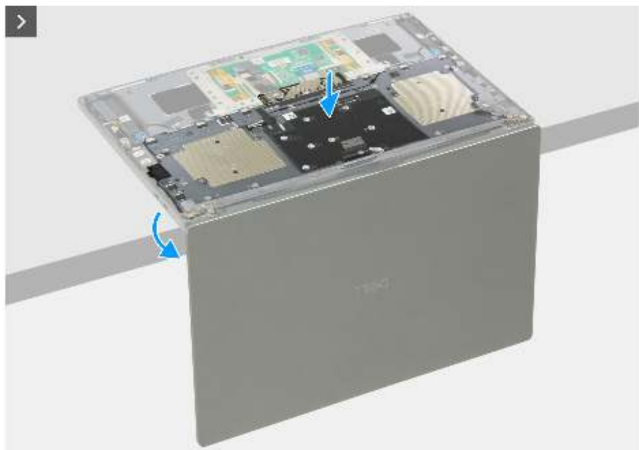
Abbildung 75. Einbauen der Tastatur
