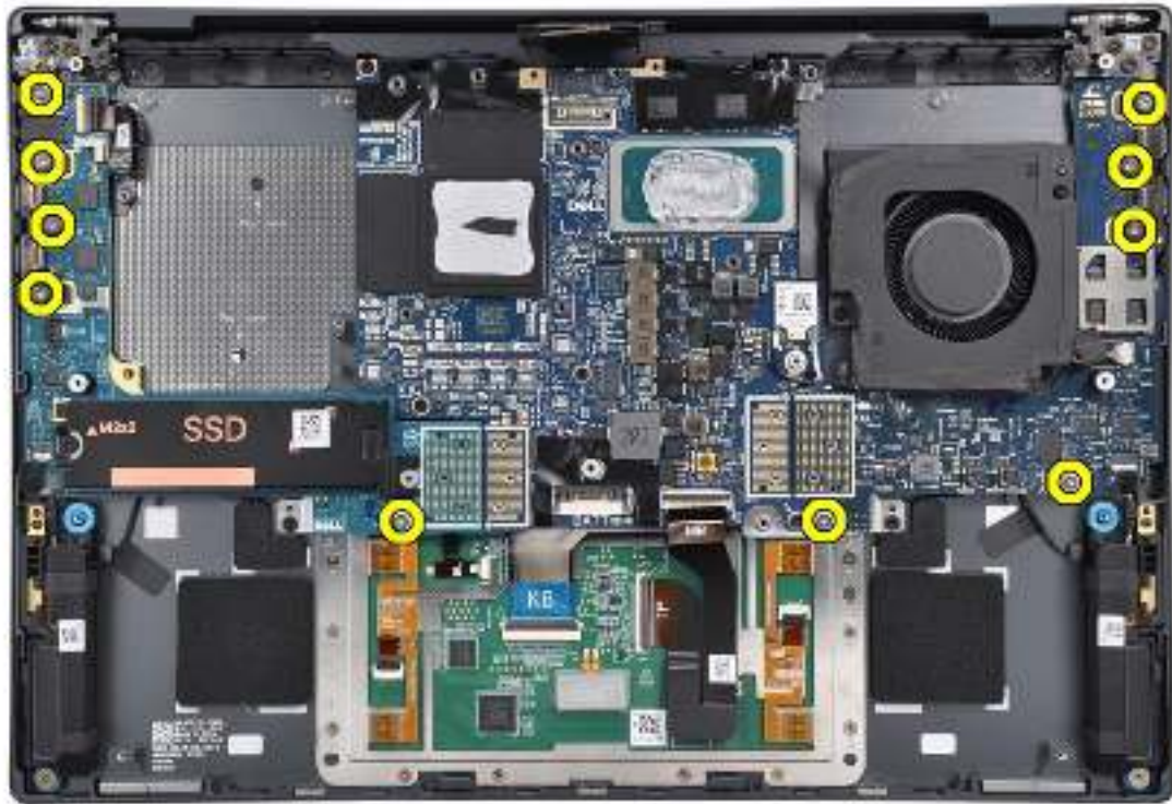
Abbildung 56. Schrauben der I/O-Platinen
