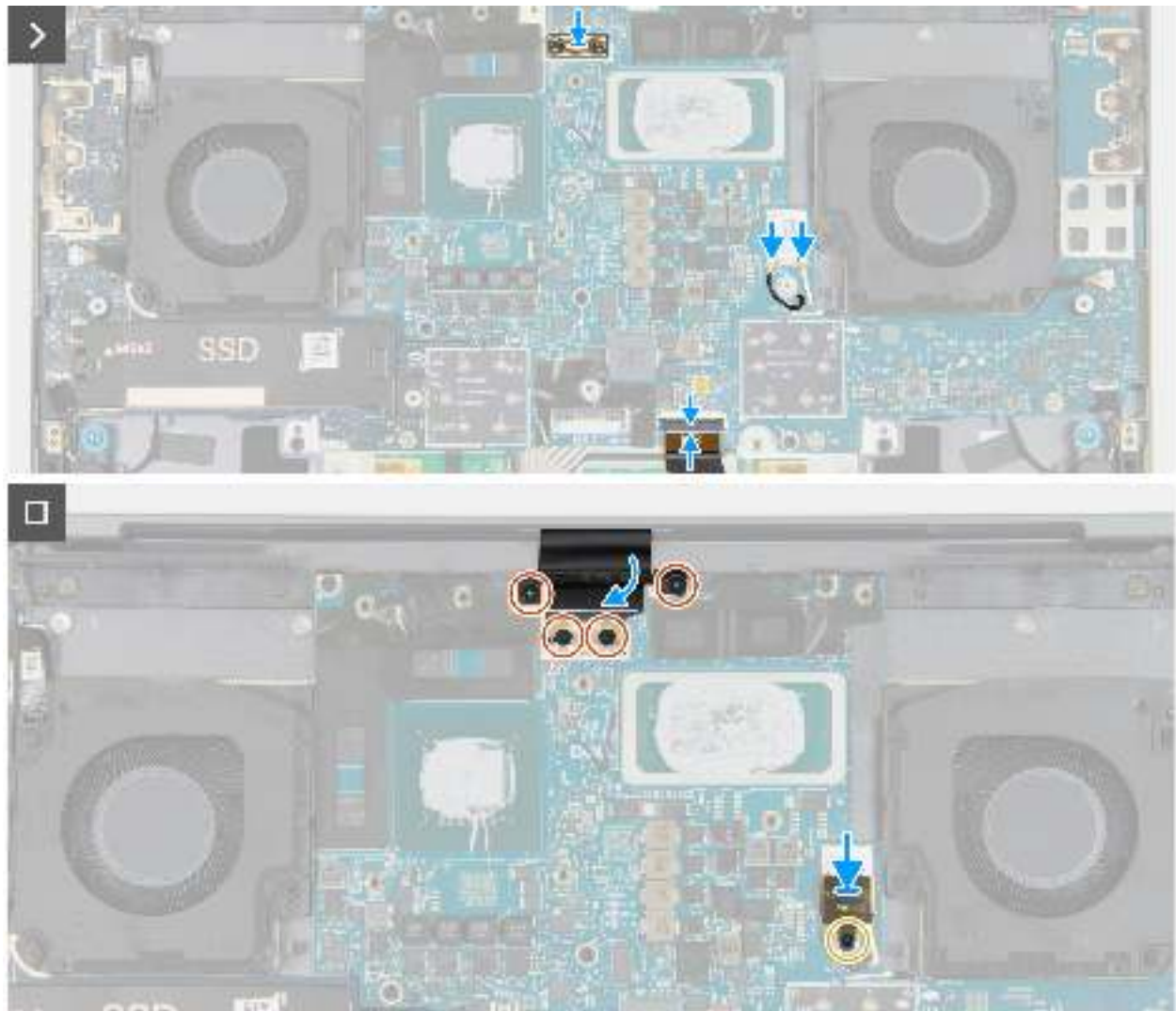
Abbildung 64. Einbauen der Hauptplatine (separate Grafikkarte)
