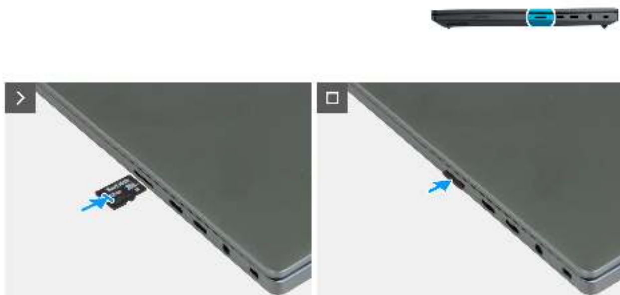
Abbildung 11. Einsetzen der Speicherkarte
