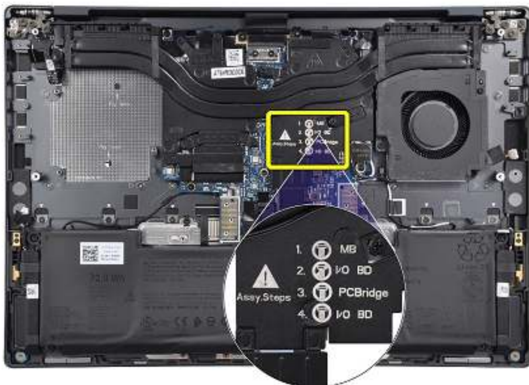
Abbildung 57. Auf dem Kühlkörper aufgedruckte Montageschritte
