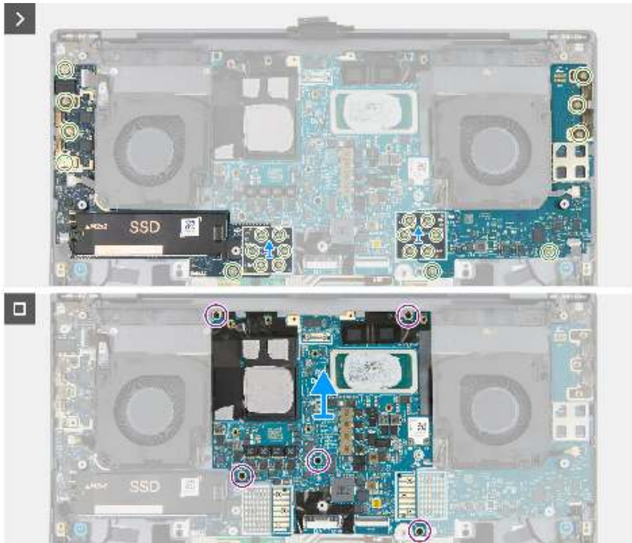
Abbildung 51. Entfernen der Hauptplatine (integrierte Grafikkarte)
