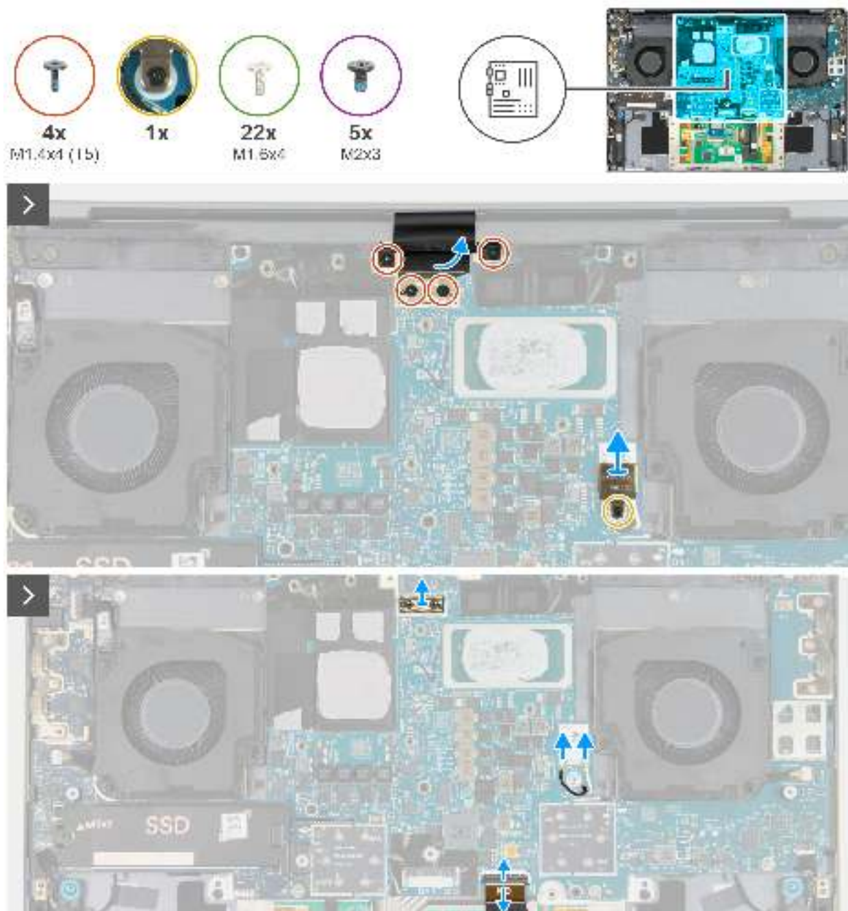
Abbildung 50. Entfernen der Hauptplatine (integrierte Grafikkarte)
