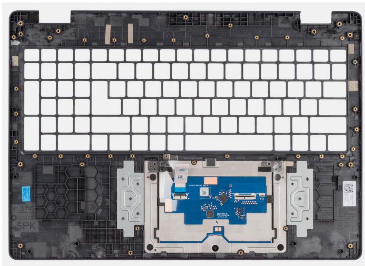
Abbildung 61. Installieren der Handauflagenbaugruppe
