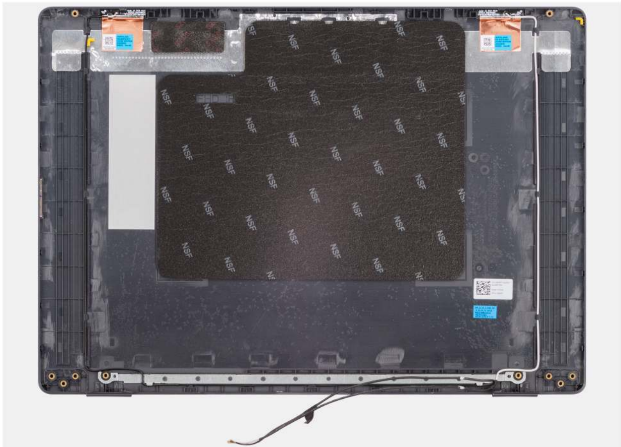
Abbildung 86. Entfernen der Baugruppe der hinteren Bildschirmabdeckung
