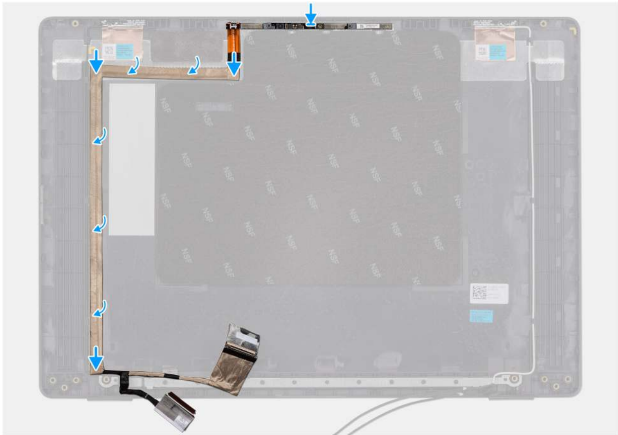
Abbildung 85. Einbauen des eDP-Kabels
