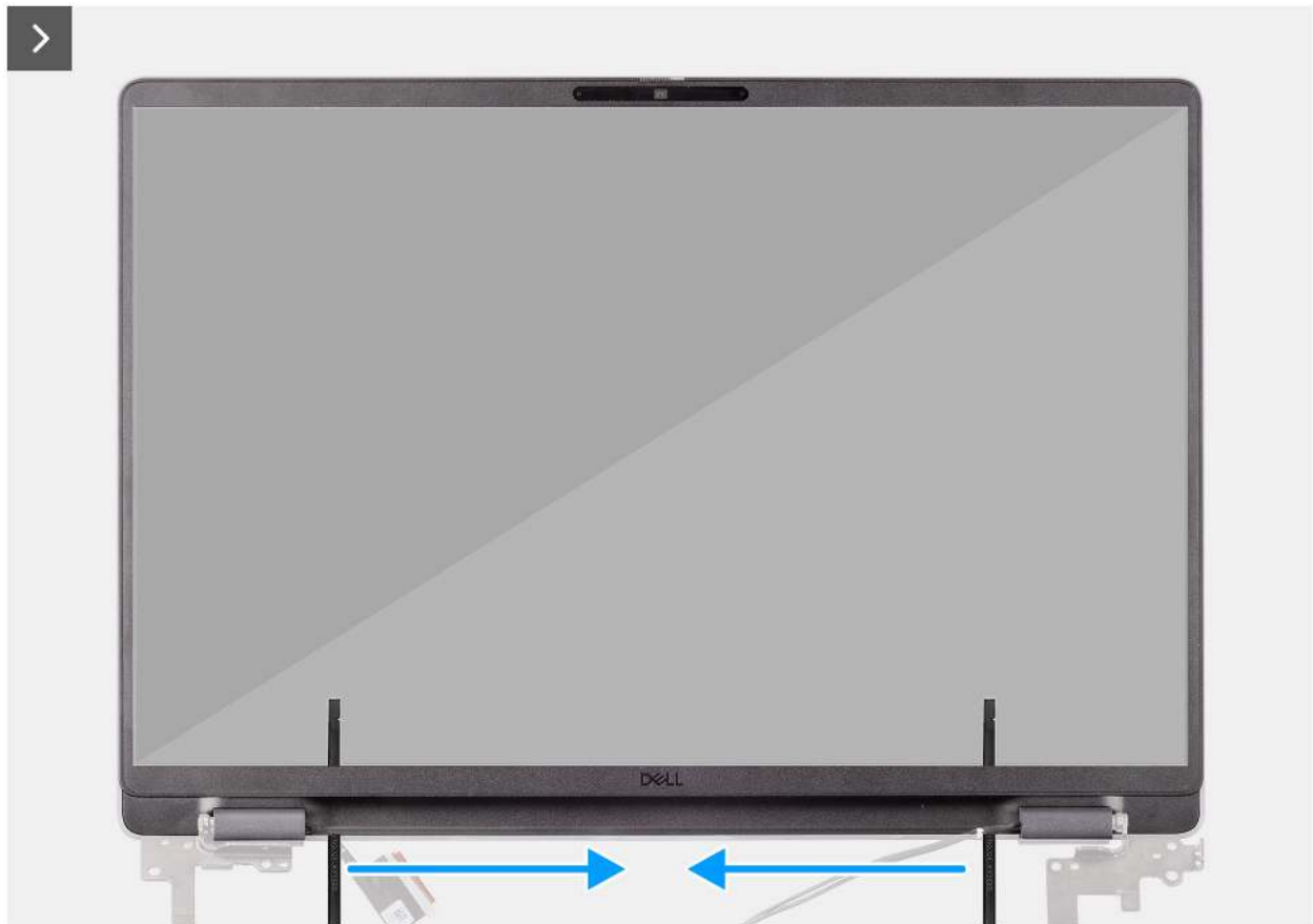
Abbildung 68. Entfernen der Bildschirmblende
