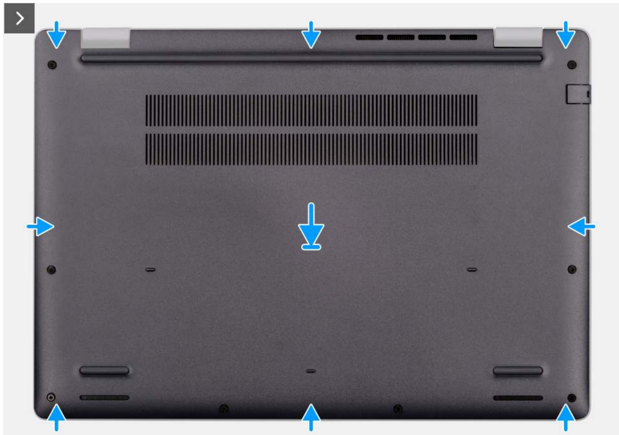
Abbildung 15. Anbringen der Bodenabdeckung
