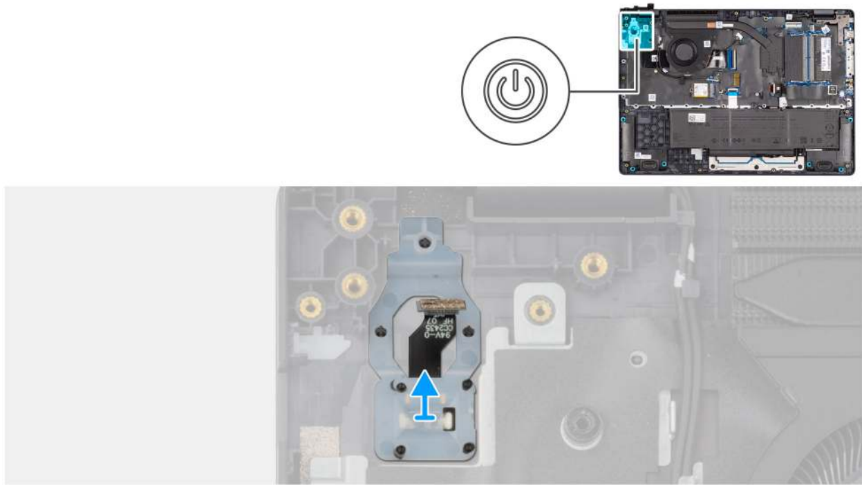
Abbildung 40. Entfernen des Netzschalters mit Fingerabdruck-Lesegerät
