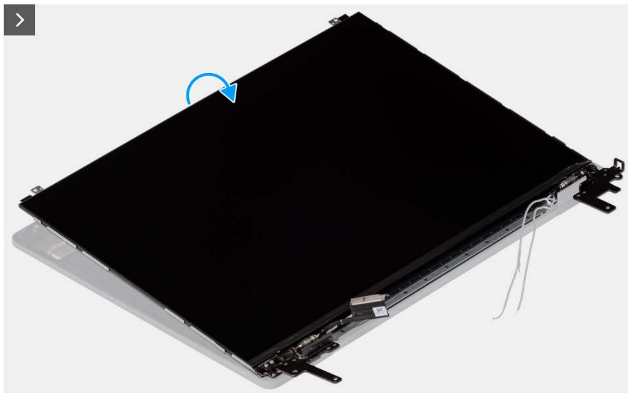
Abbildung 75. Entfernen der Bildschirmbaugruppe
