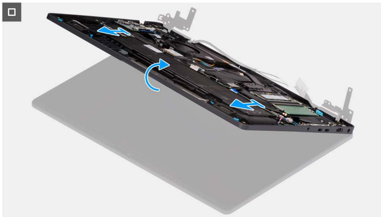
Abbildung 63. Entfernen der Bildschirmbaugruppe
