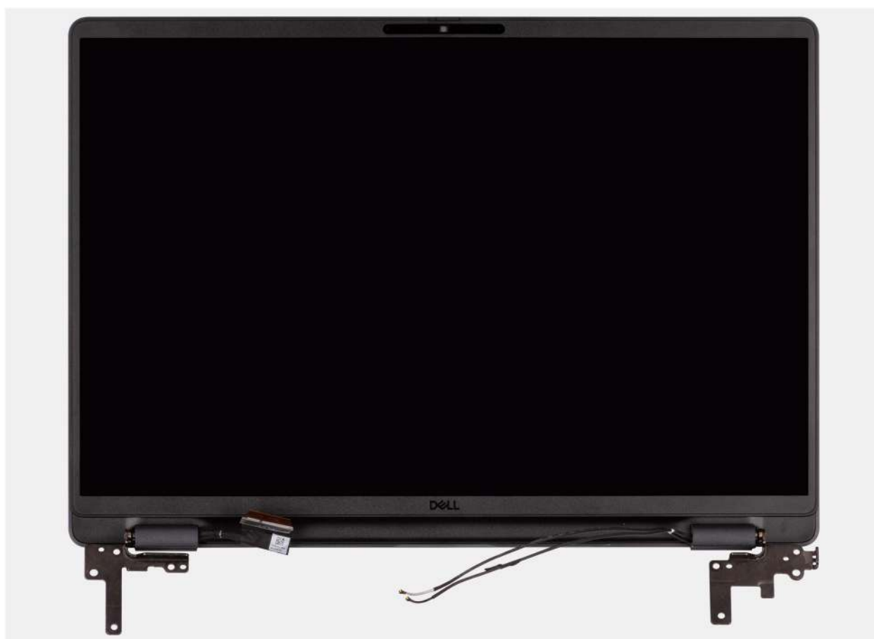
Abbildung 64. Entfernen der Bildschirmbaugruppe
