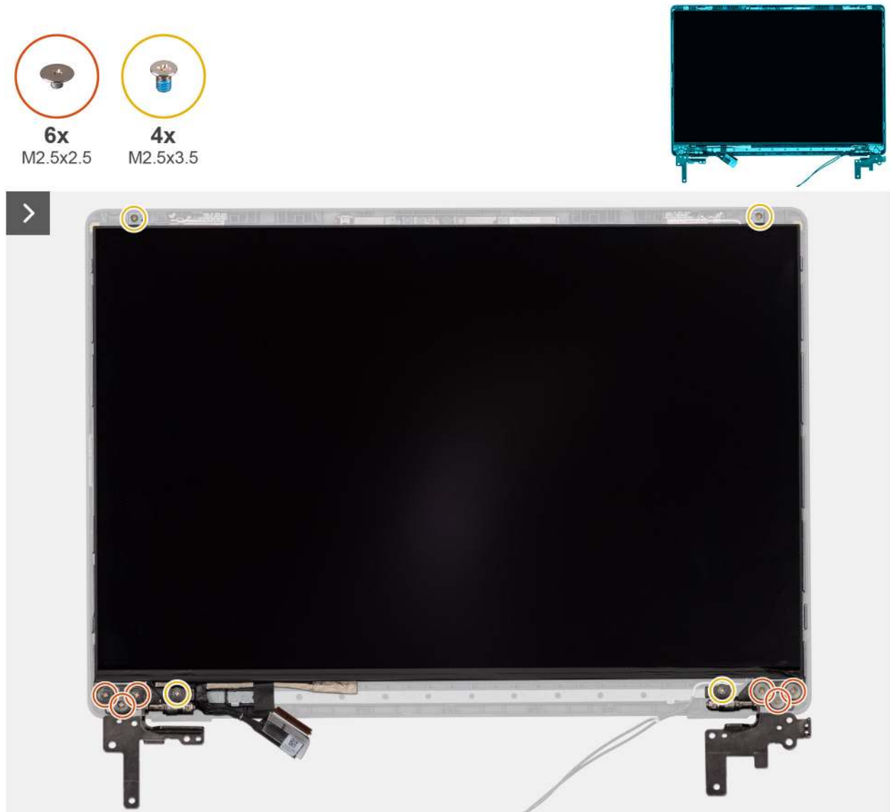
Abbildung 74. Entfernen der Bildschirmbaugruppe
