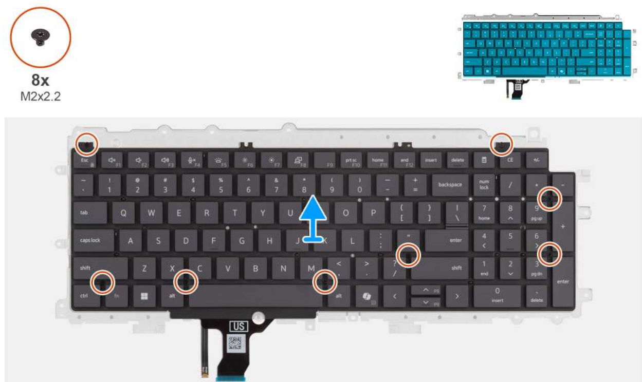
Abbildung 56. Entfernen der Tastaturstützplatte
