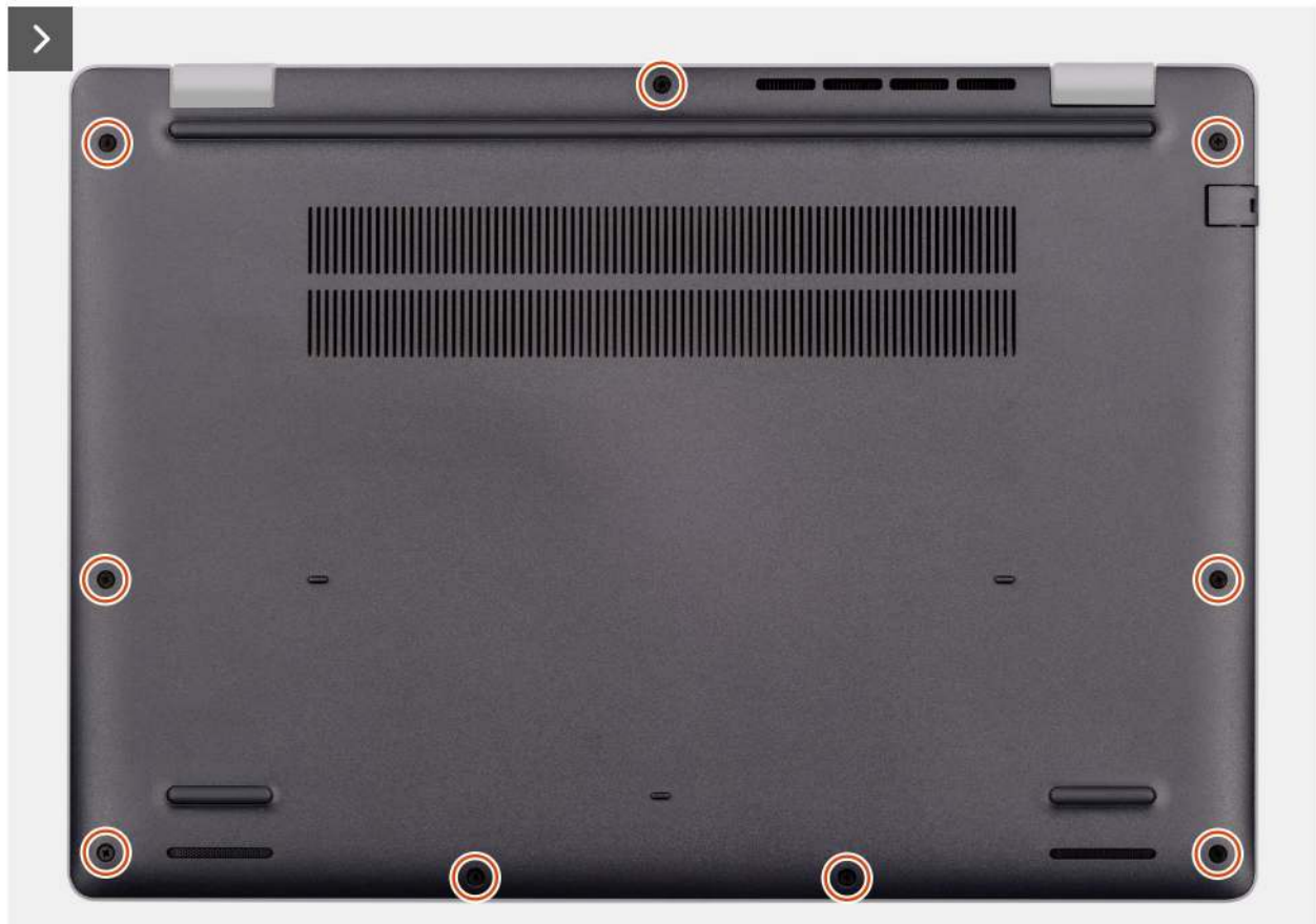
Abbildung 11. Entfernen der Bodenabdeckung
