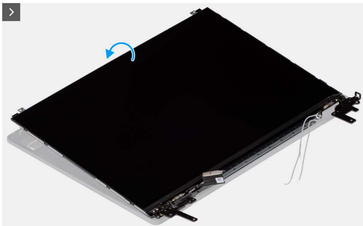
Abbildung 80. Installieren der Bildschirmbaugruppe
