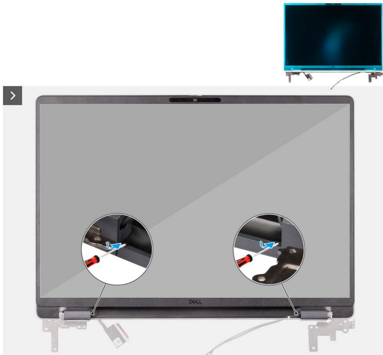
Abbildung 67. Entfernen der Bildschirmblende
