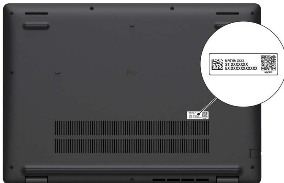
Abbildung 6. Position des Service-Tags/Express-Servicecodes
