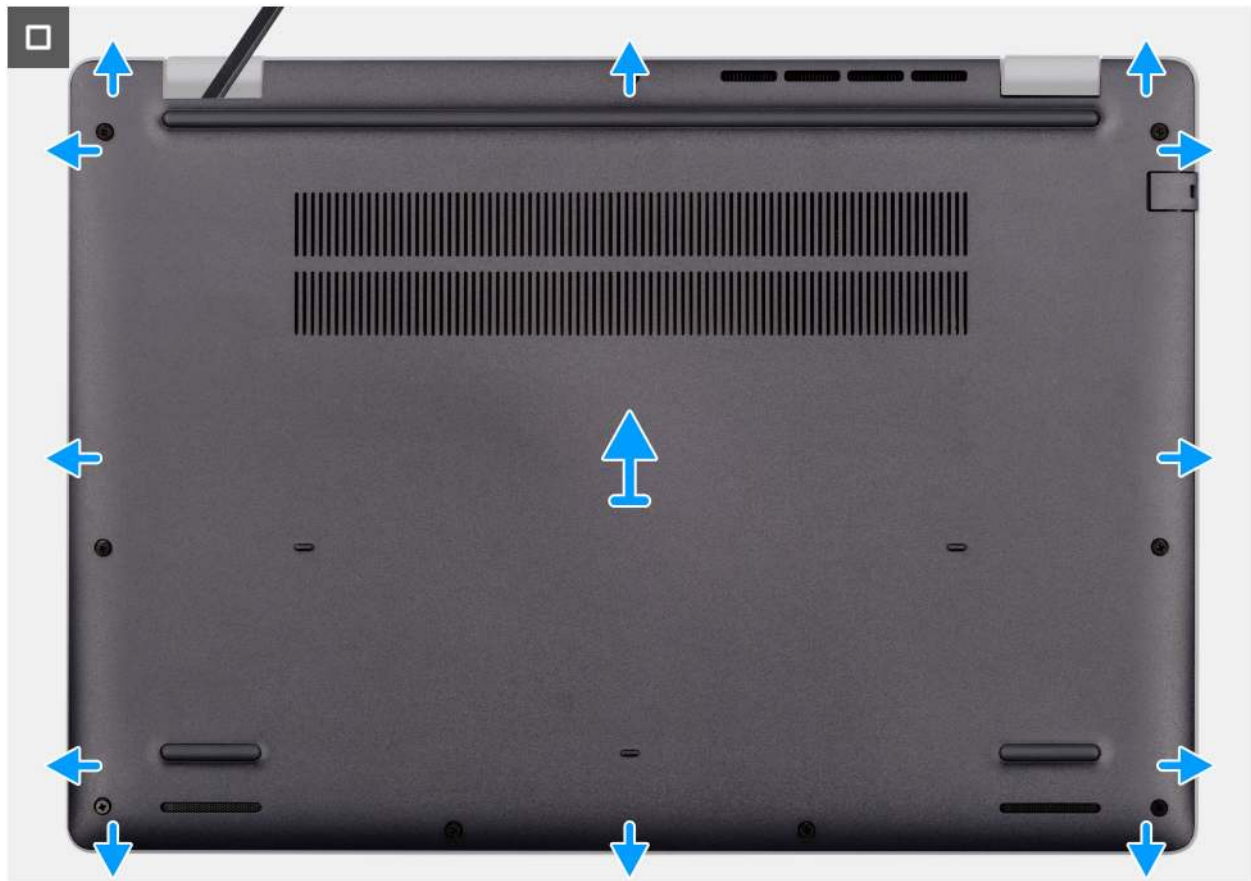
Abbildung 12. Entfernen der Bodenabdeckung
