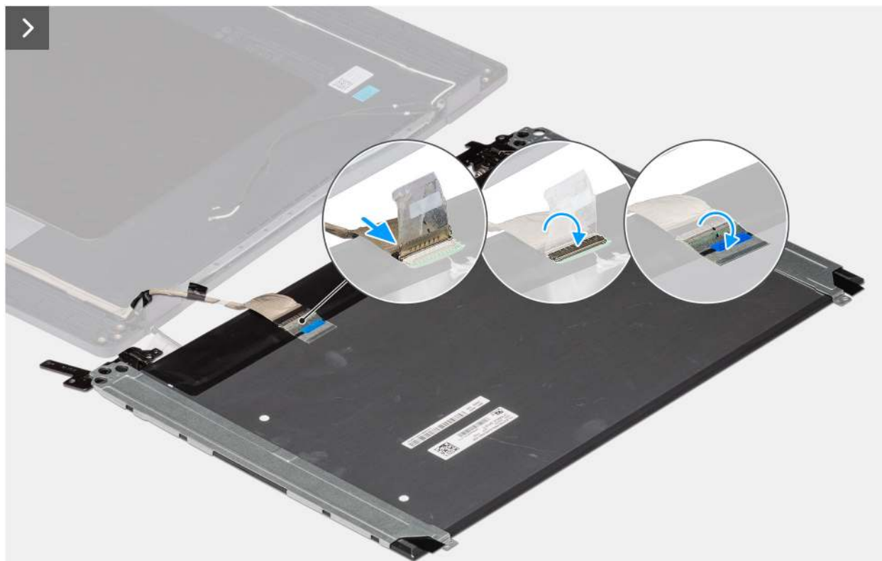
Abbildung 79. Installieren der Bildschirmbaugruppe
