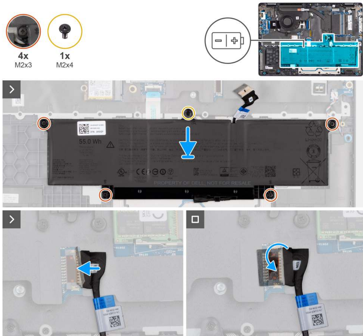
Abbildung 18. Einsetzen des Akkus
