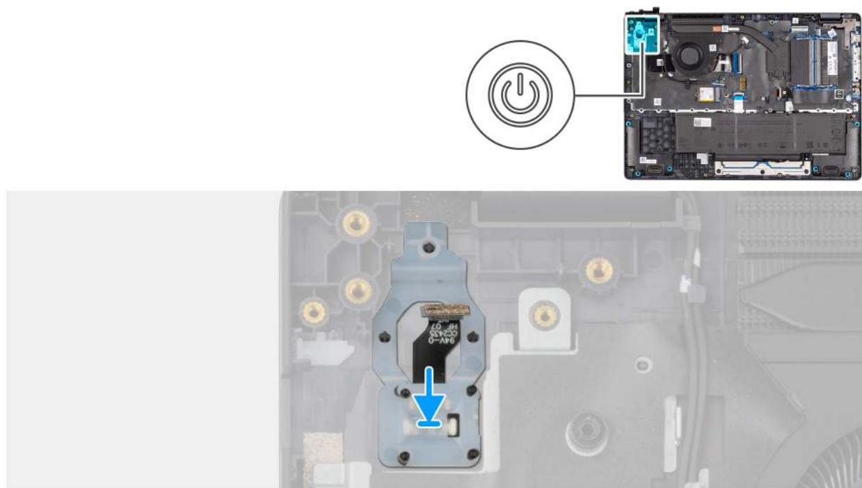
Abbildung 41. Einbauen des Netzschalters mit Fingerabdruck-Lesegerät
