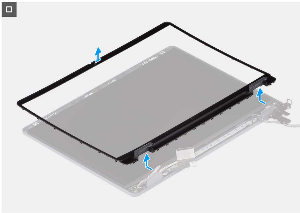
Abbildung 71. Entfernen der Bilderamblende
