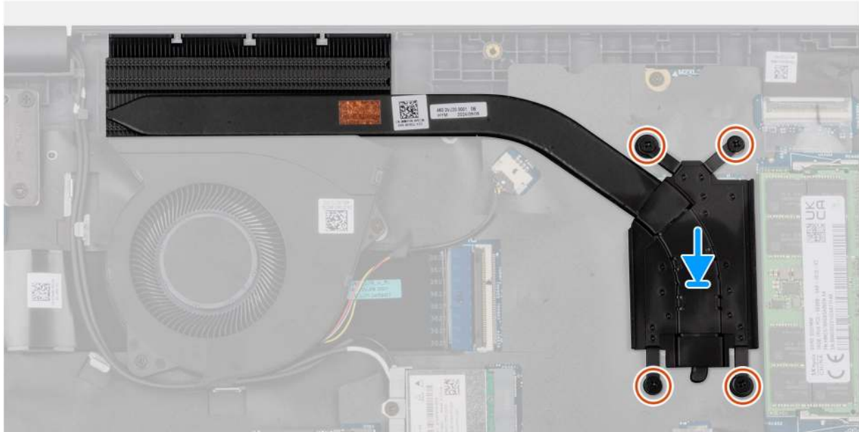
Abbildung 35. Einsetzen des Kühlkörpers
