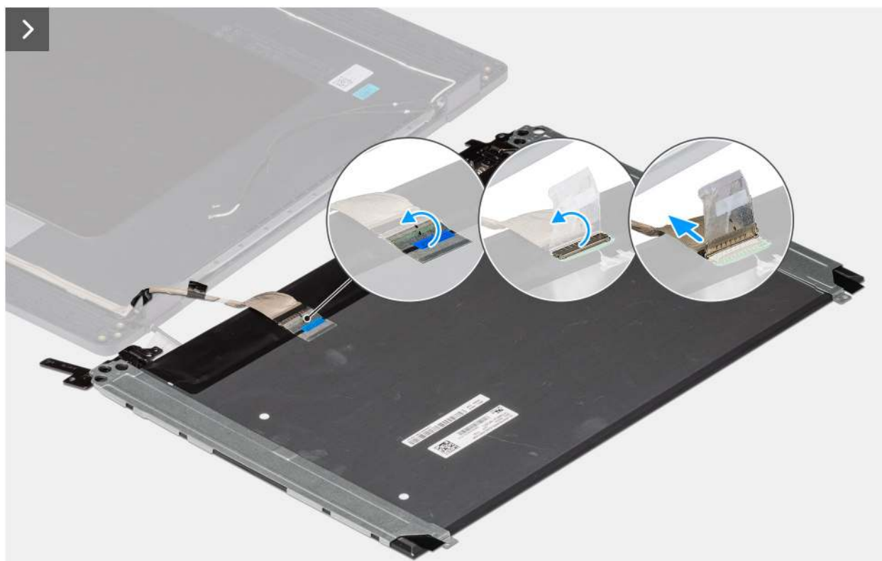
Abbildung 76. Entfernen der Bildschirmbaugruppe
