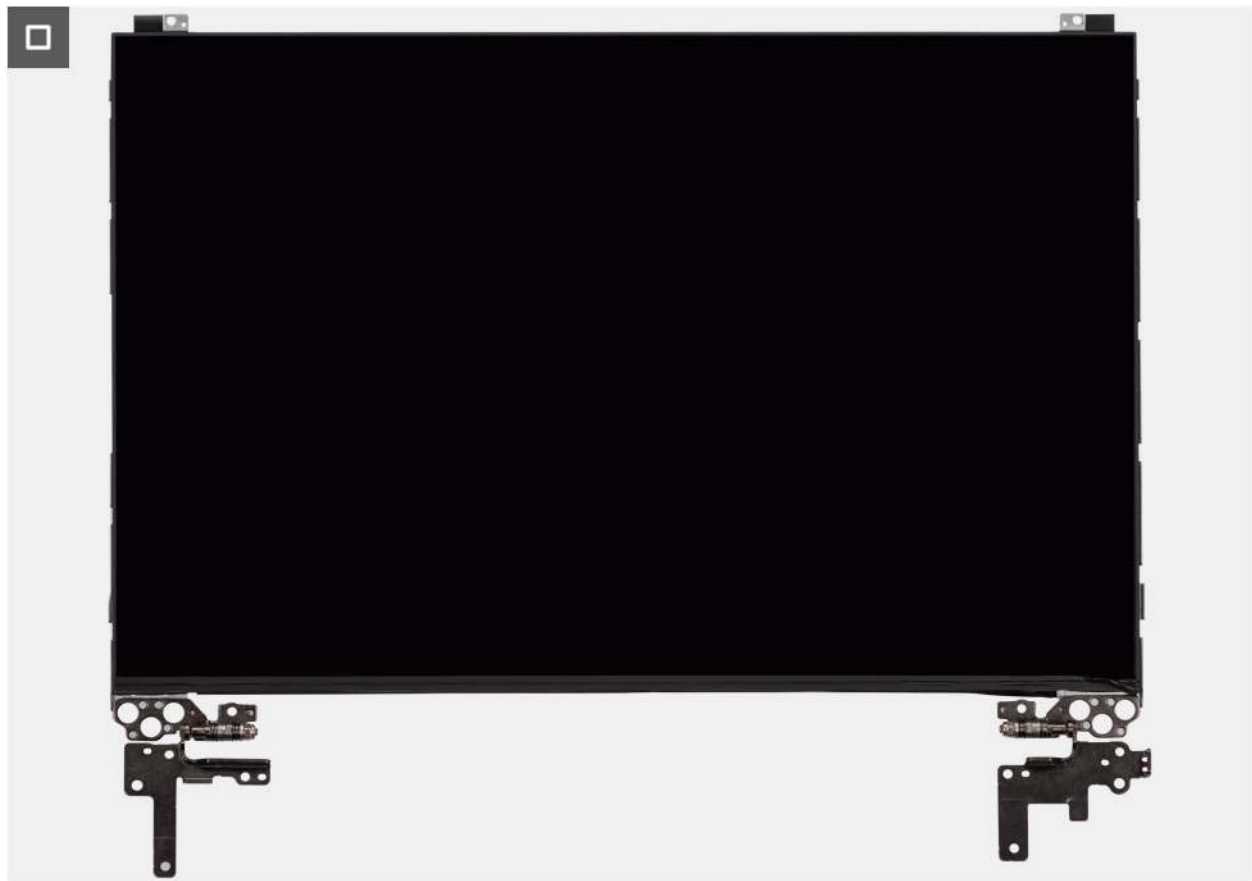
Abbildung 77. Entfernen der Bildschirmbaugruppe
