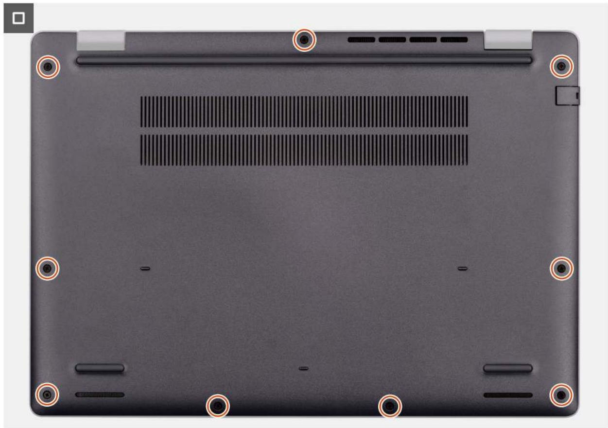
Abbildung 16. Anbringen der Bodenabdeckung
