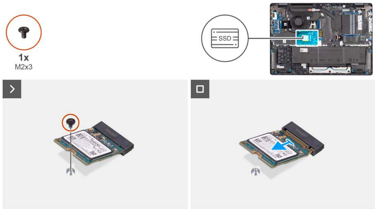
Abbildung 23. Entfernen des SSD
