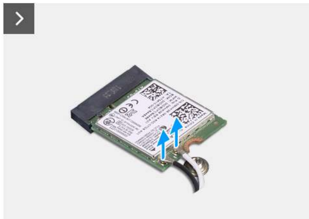
Abbildung 25. Entfernen der Wireless-Karte
