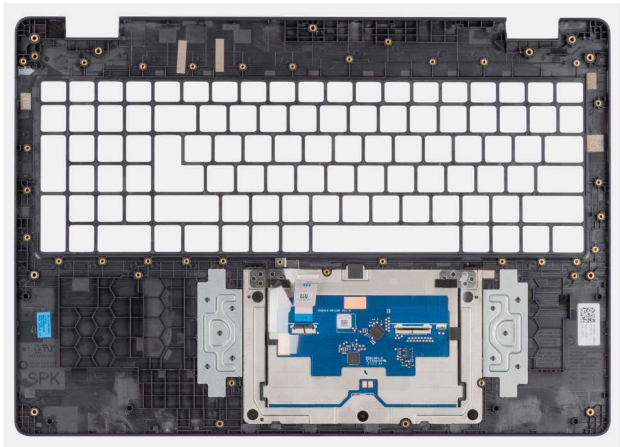
Abbildung 60. Entfernen der Handauflagenbaugruppe
