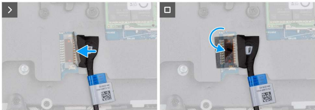
Abbildung 14. Verbinden des Akkukabels
