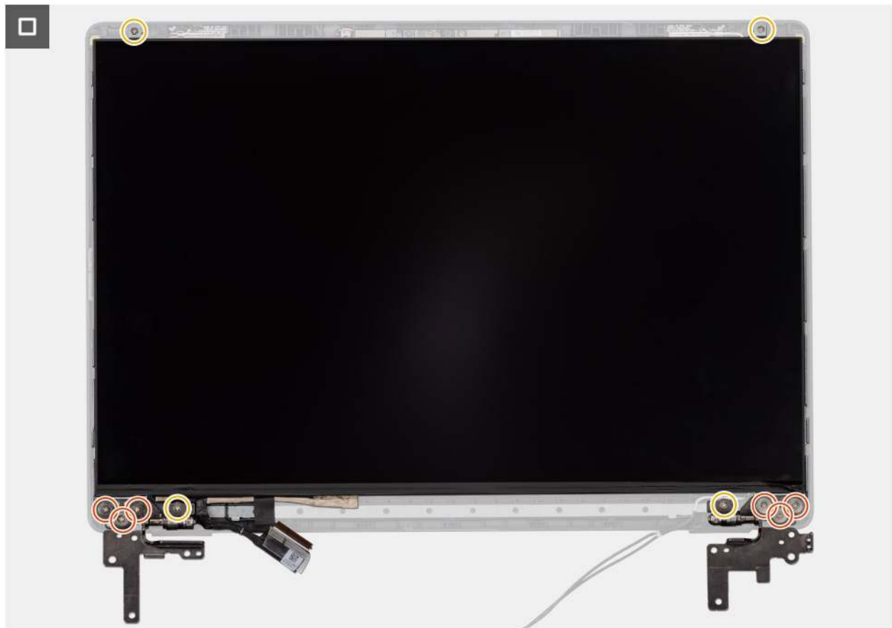
Abbildung 81. Installieren der Bildschirmbaugruppe
