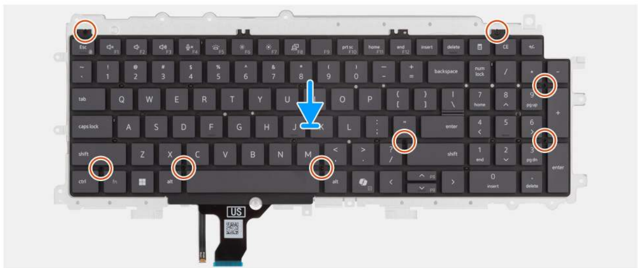
Abbildung 59. Installieren der Tastaturstützplatte
