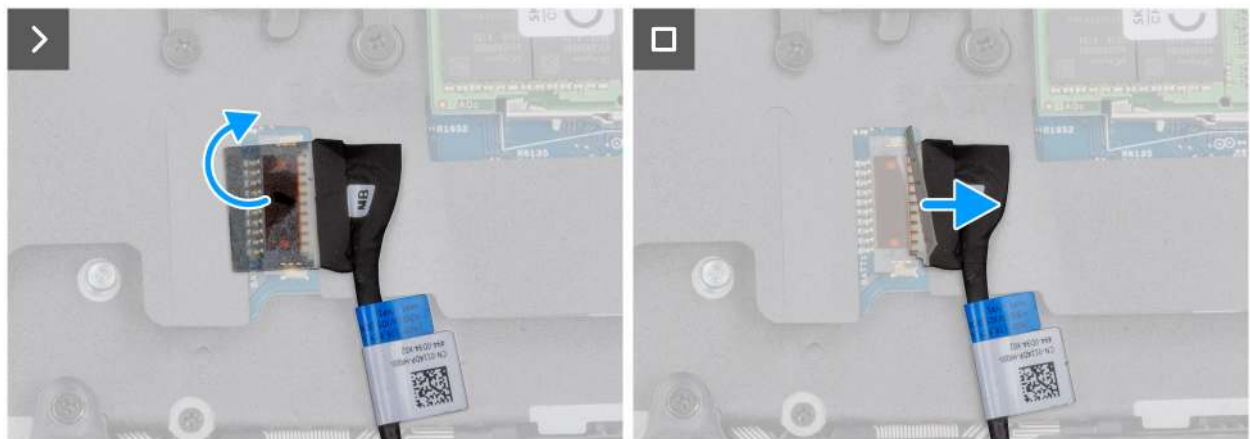
Abbildung 13. Trennen des Akkukabels
