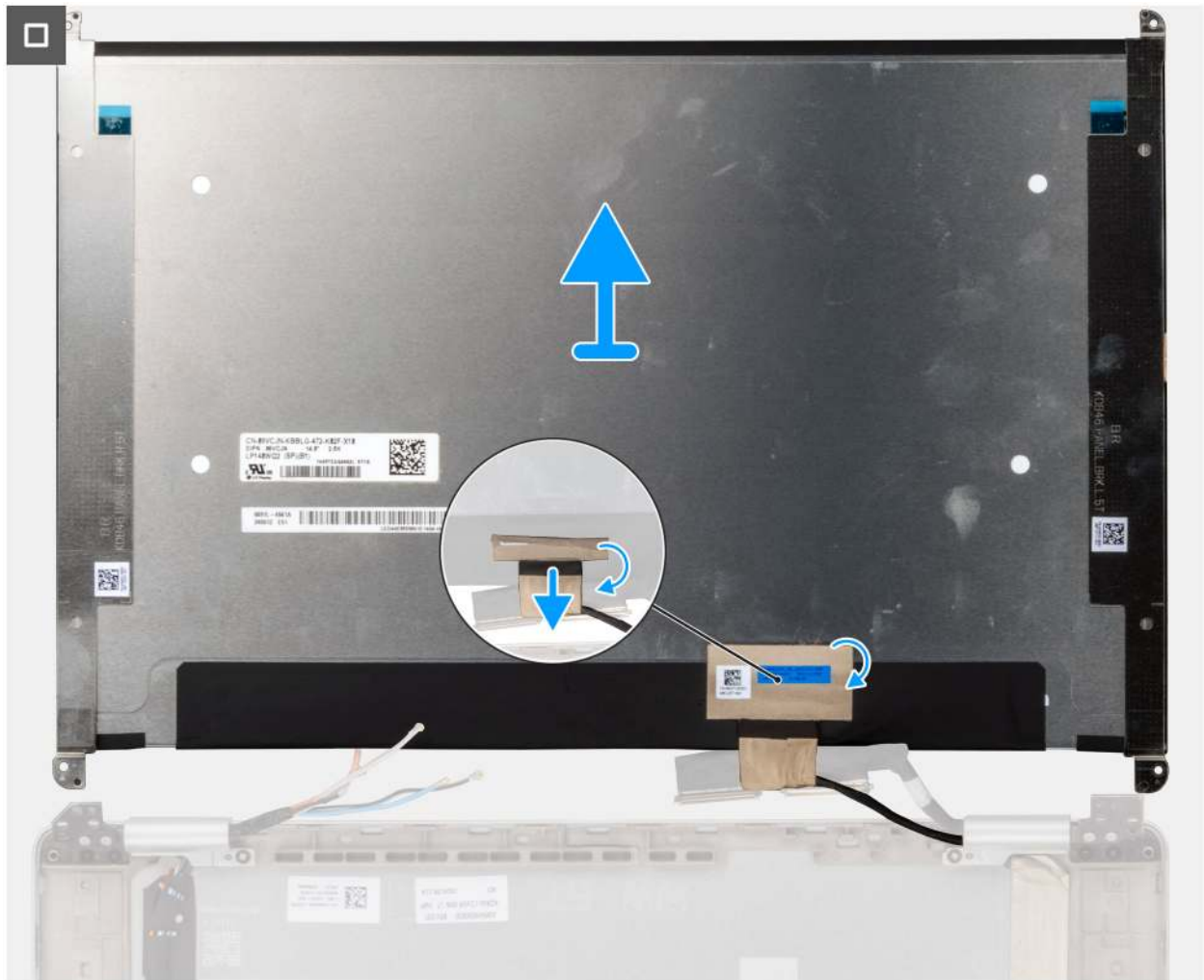
Abbildung 69. Entfernen des Bildschirms
