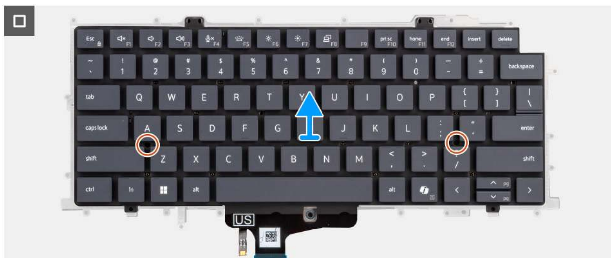
Abbildung 82. Entfernen der Tastatur
