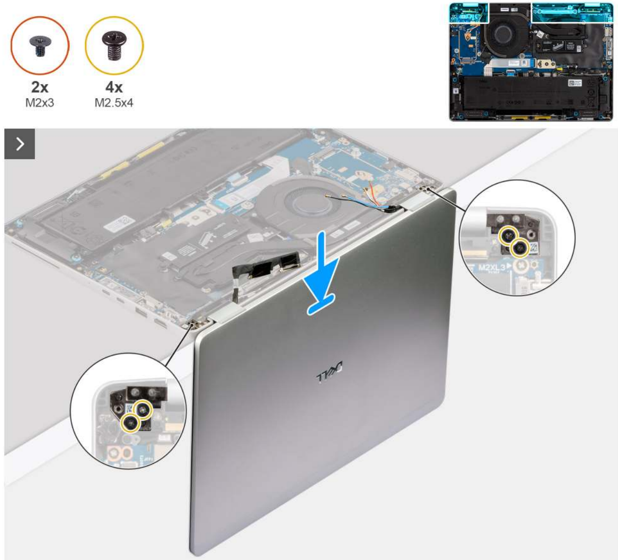
Abbildung 59. Einbauen der Displaybaugruppe
