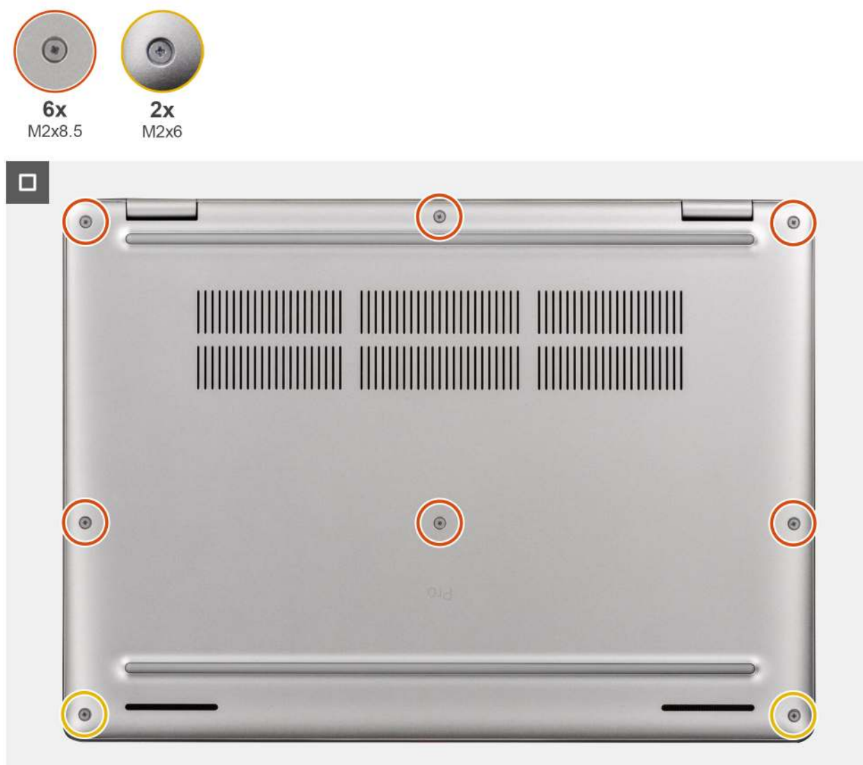
Abbildung 26. Anbringen der Bodenabdeckung
