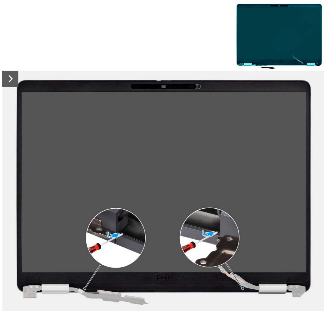
Abbildung 61. Entfernen der Bildschirmblende
