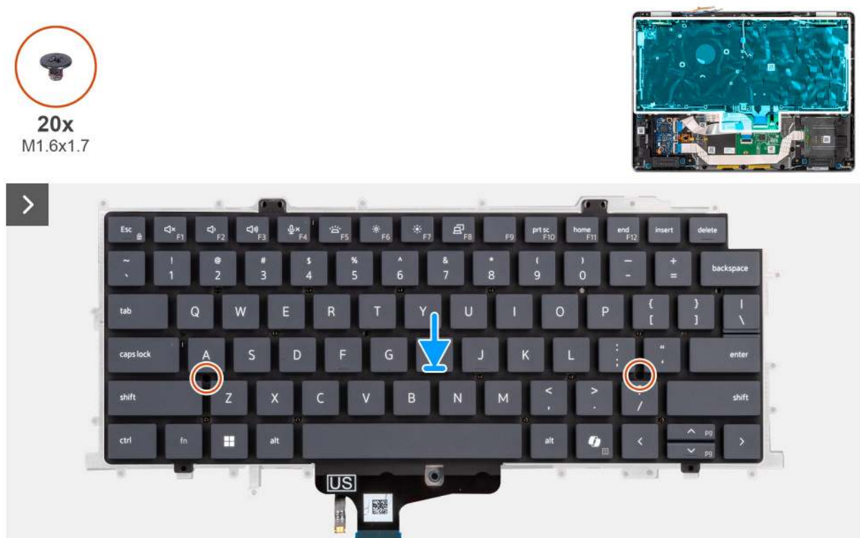
Abbildung 83. Einbauen der Tastatur
