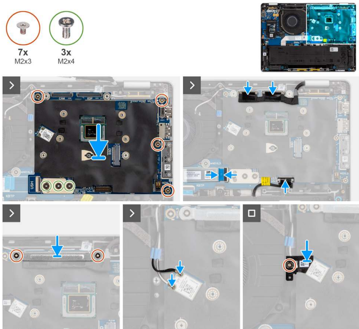
Abbildung 50. Einbauen der Systemplatine
