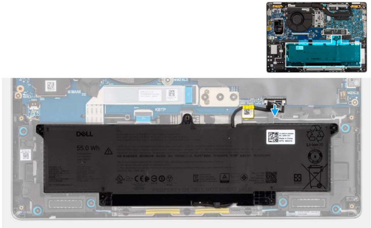
Abbildung 24. Trennen des Akkukabels
