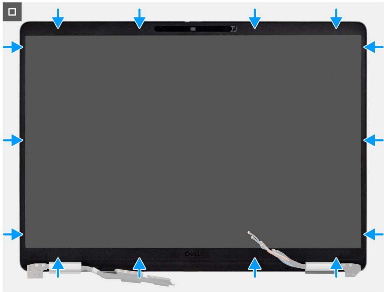
Abbildung 67. Einbauen der Bildschirmblende
