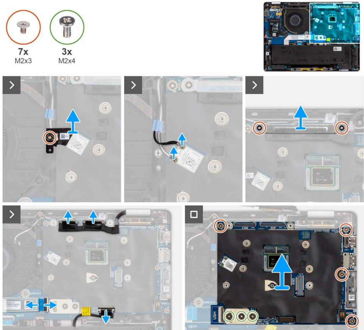
Abbildung 48. Entfernen der Systemplatine
