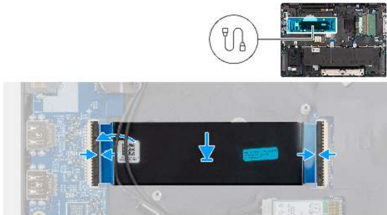
Abbildung 54. Einbauen der FPC der I/O-Platine
