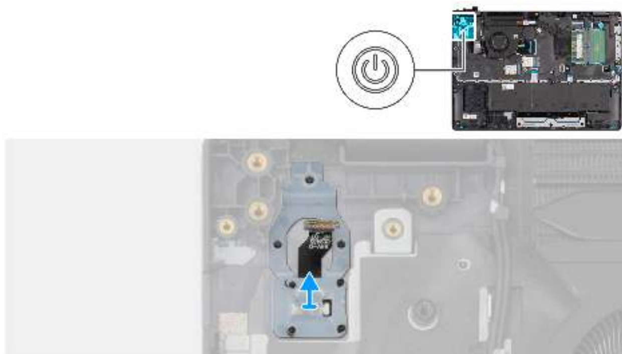
Abbildung 55. Entfernen des Netzschalters mit Fingerabdruck-Lesegerät
