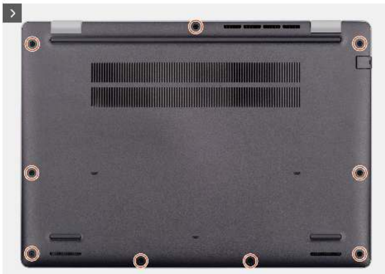
Abbildung 11. Entfernen der Bodenabdeckung
