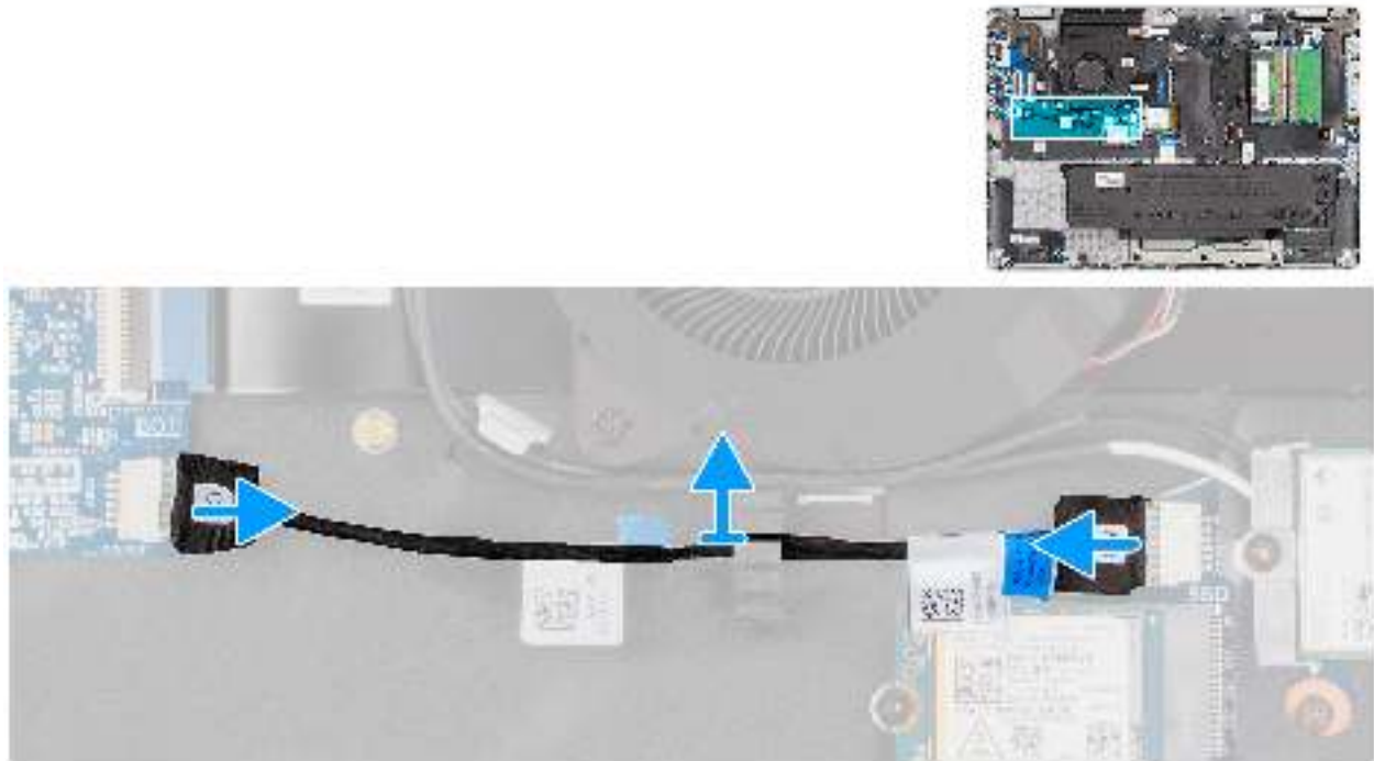
Abbildung 45. Entfernen des vPro-Kabels
