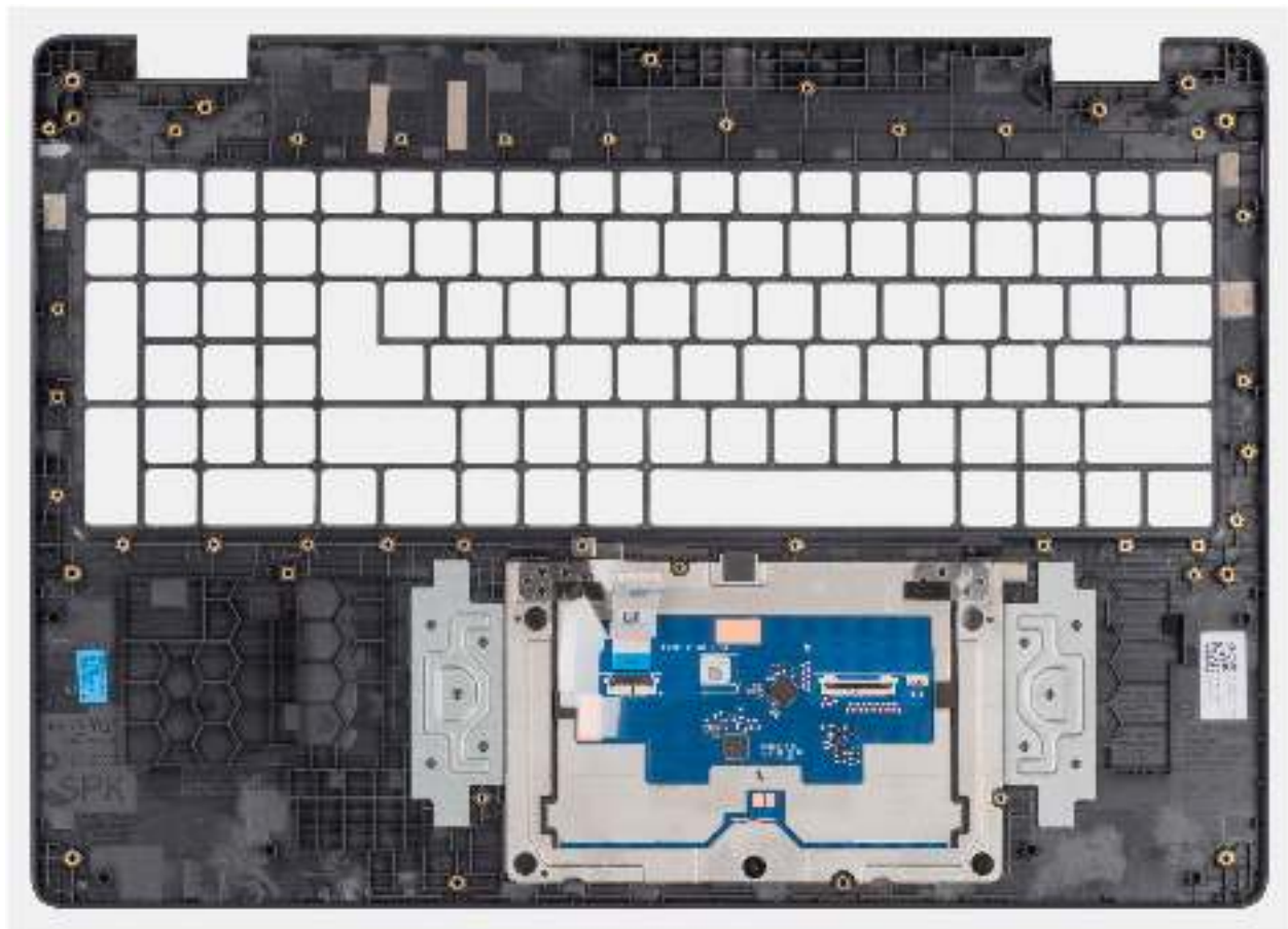
Abbildung 89. Entfernen der Handauflagenbaugruppe
