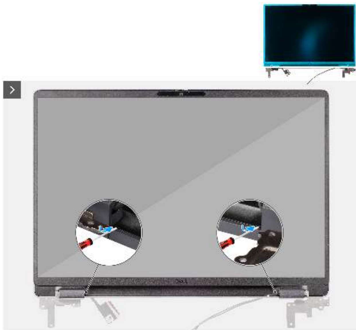
Abbildung 98. Entfernen der Bildschirmblende
