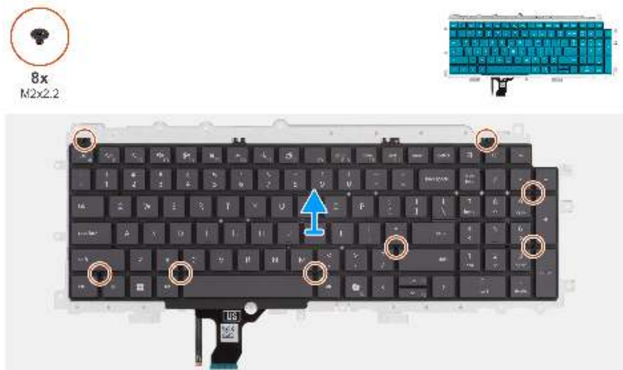
Abbildung 85. Entfernen der Tastaturauflage
