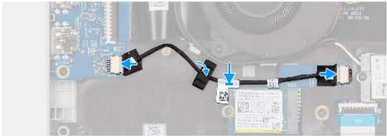
Abbildung 48. Einbauen des vPro-Kabels
