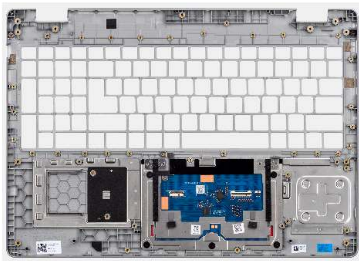
Abbildung 91. Entfernen der Handauflagenbaugruppe
