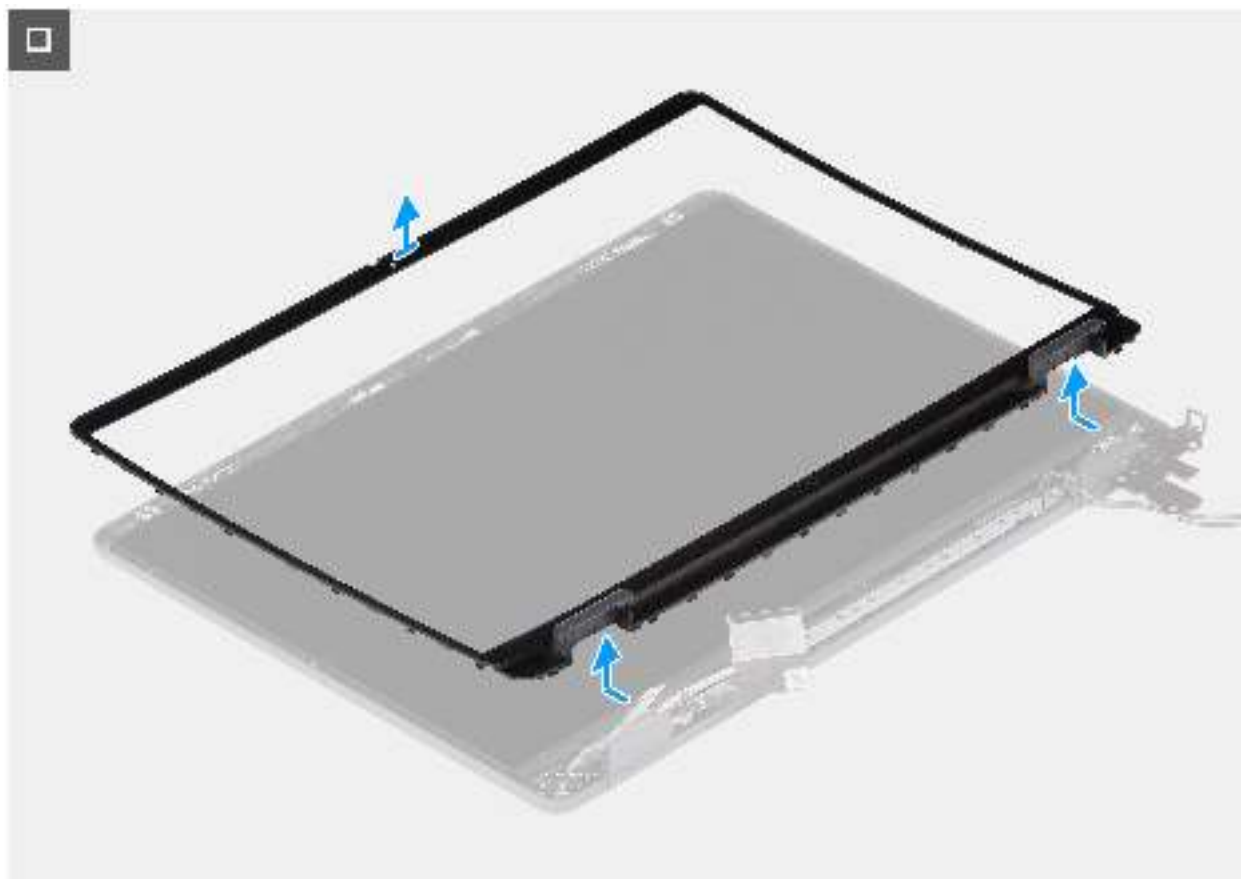
Abbildung 102. Entfernen der Bildschirmblende
