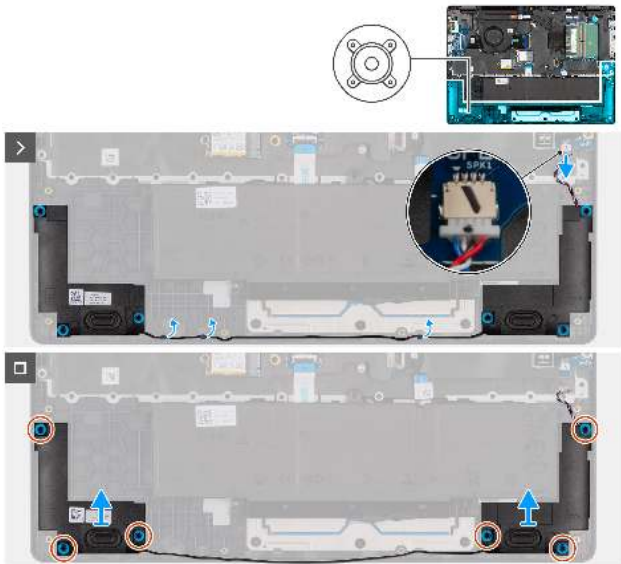
Abbildung 27. Entfernen der Lautsprecher
