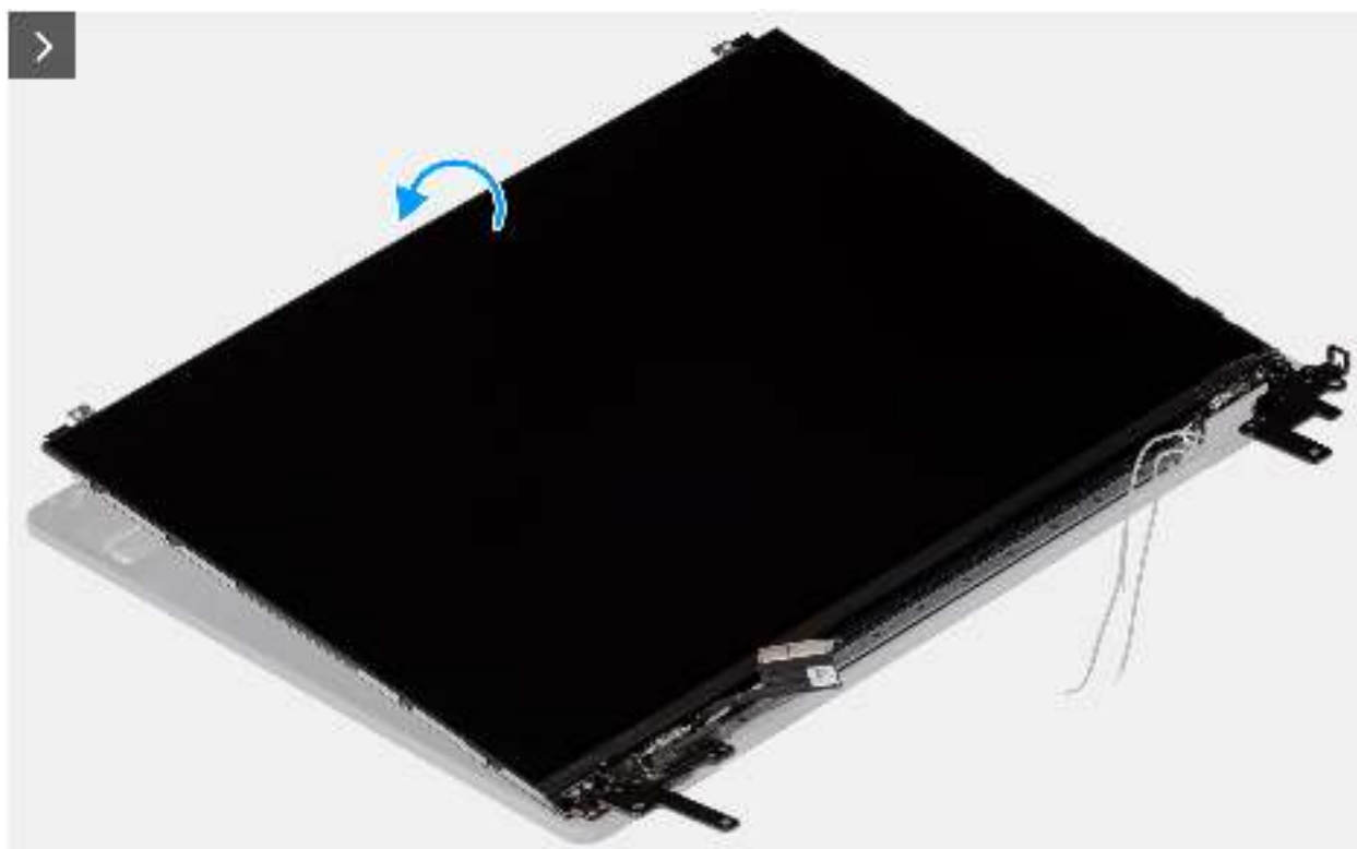
Abbildung 111. Installieren der Bildschirmbaugruppe
