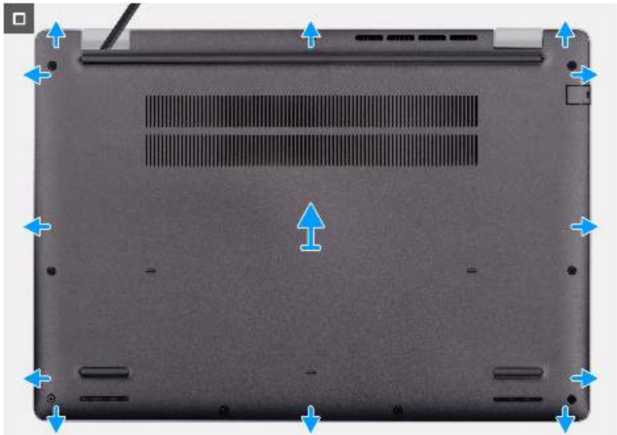
Abbildung 12. Entfernen der Bodenabdeckung
