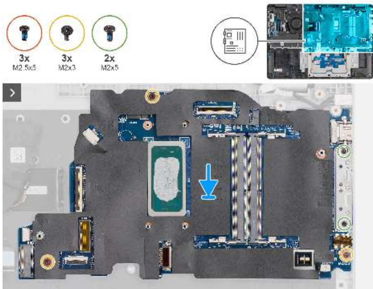
Abbildung 67. Einbauen der Systemplatine
