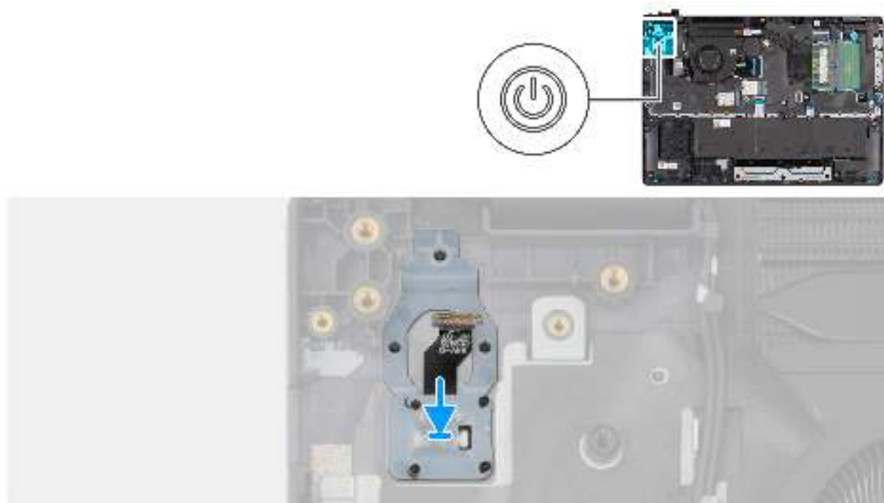
Abbildung 56. Einbauen des Netzschalters mit Fingerabdruck-Lesegerät
