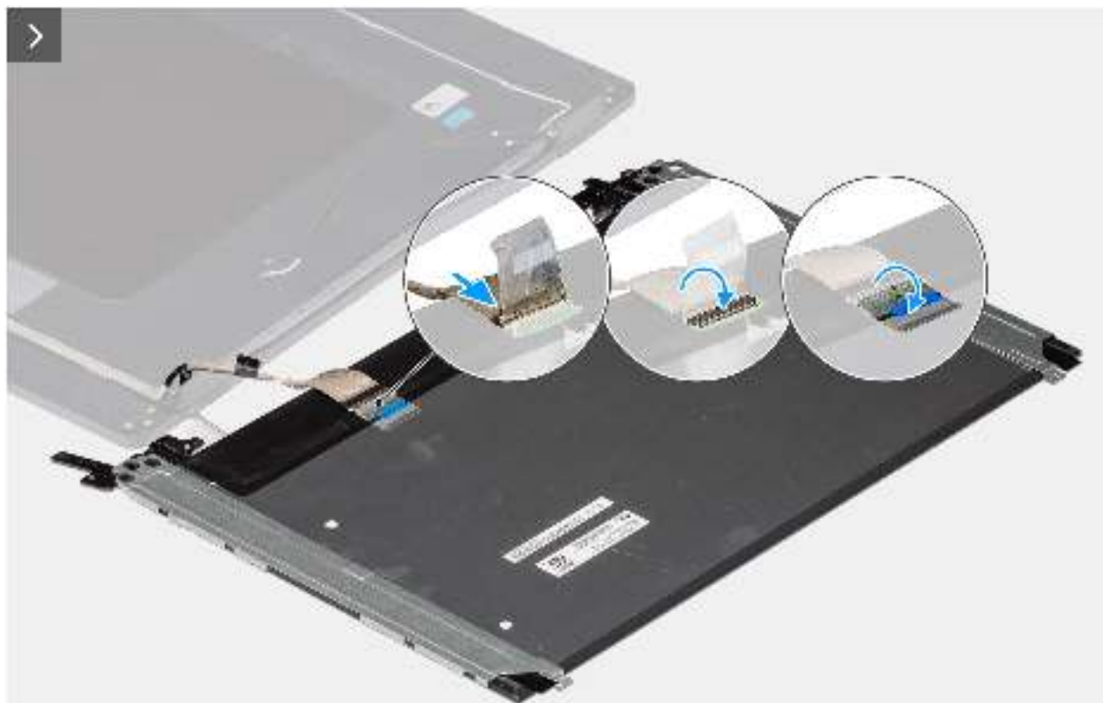
Abbildung 110. Installieren der Bildschirmbaugruppe
