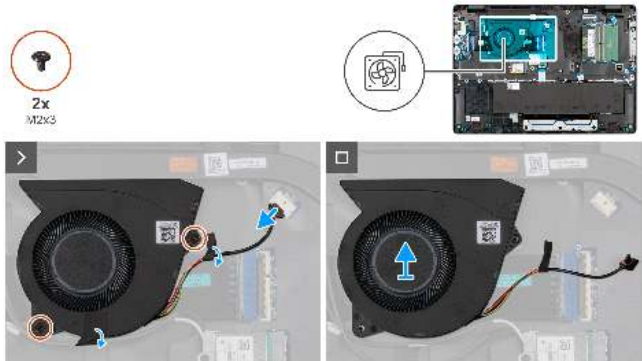
Abbildung 33. Entfernen des Lüfters
