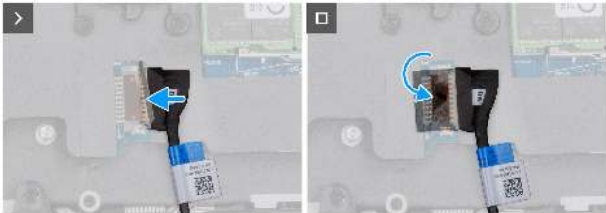
Abbildung 14. Verbinden des Akkukabels
