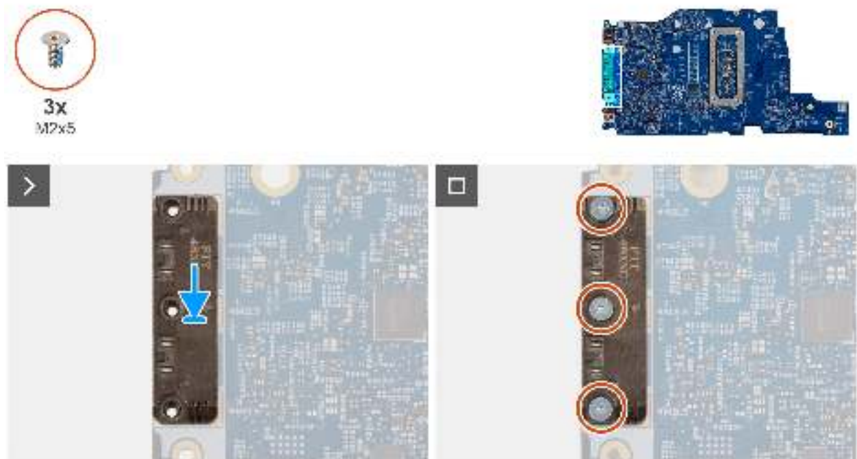
Abbildung 78. Installieren des USB-Typ-C-Moduls
