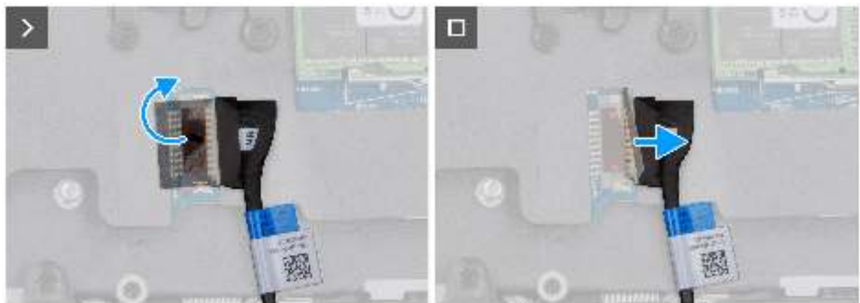
Abbildung 13. Trennen des Akkukabels
