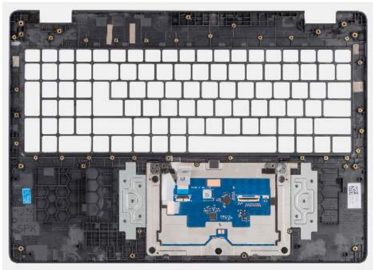
Abbildung 90. Installieren der Handauflagenbaugruppe
