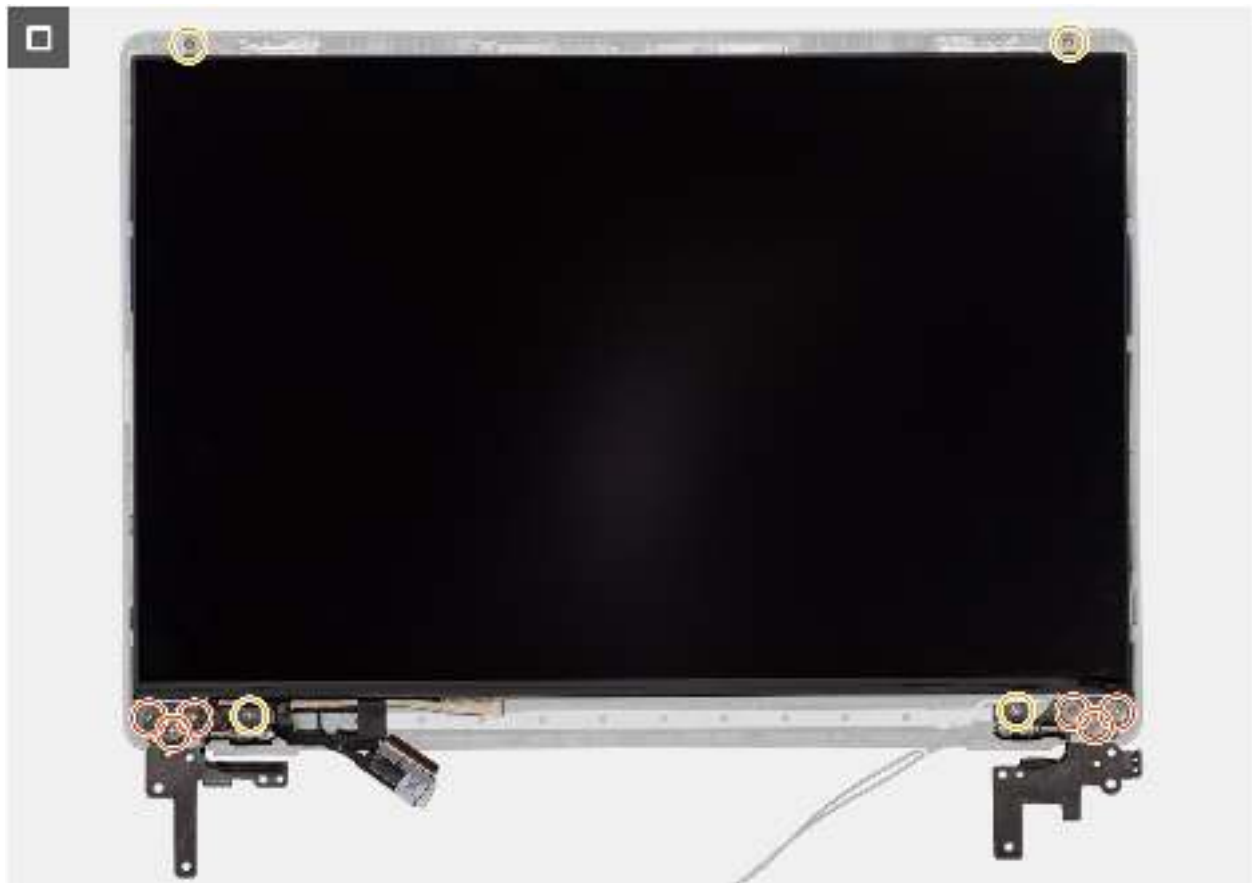
Abbildung 112. Installieren der Bildschirmbaugruppe
