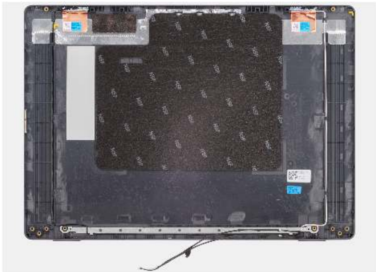
Abbildung 118. Einbauen der Baugruppe der hinteren Bildschirmabdeckung
