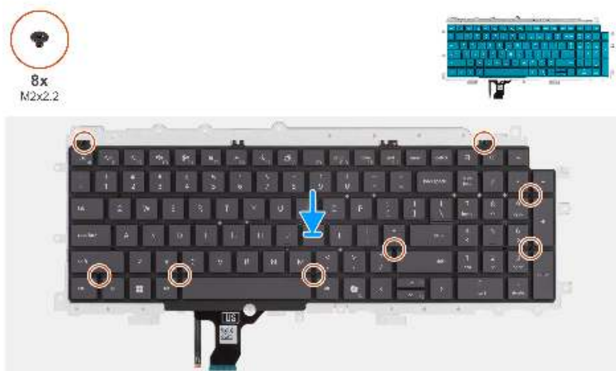
Abbildung 88. Einbauen der Tastaturauflage
