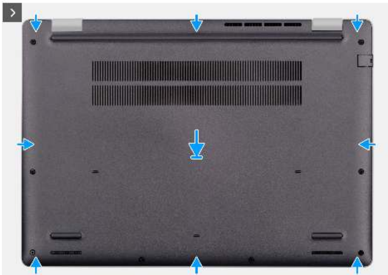
Abbildung 15. Anbringen der Bodenabdeckung
