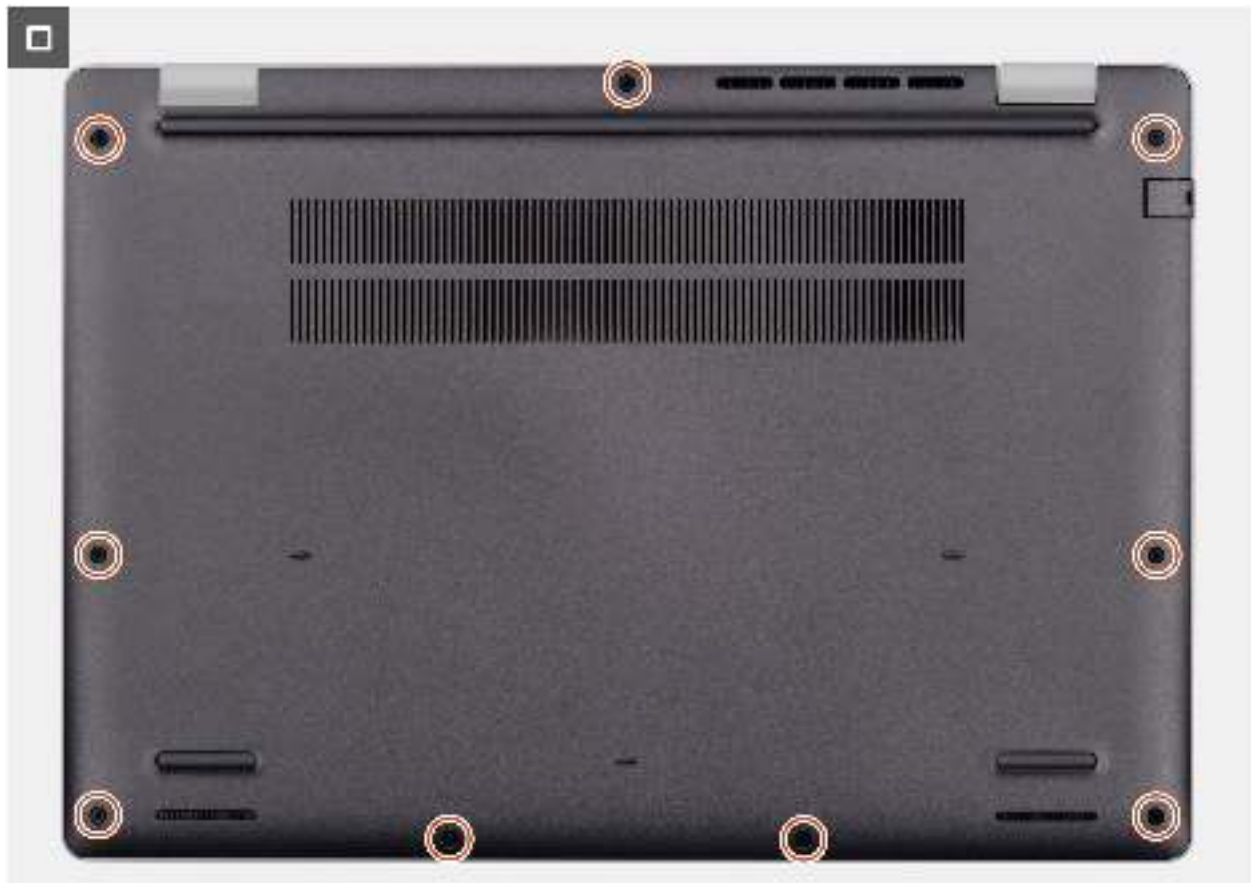
Abbildung 16. Anbringen der Bodenabdeckung
