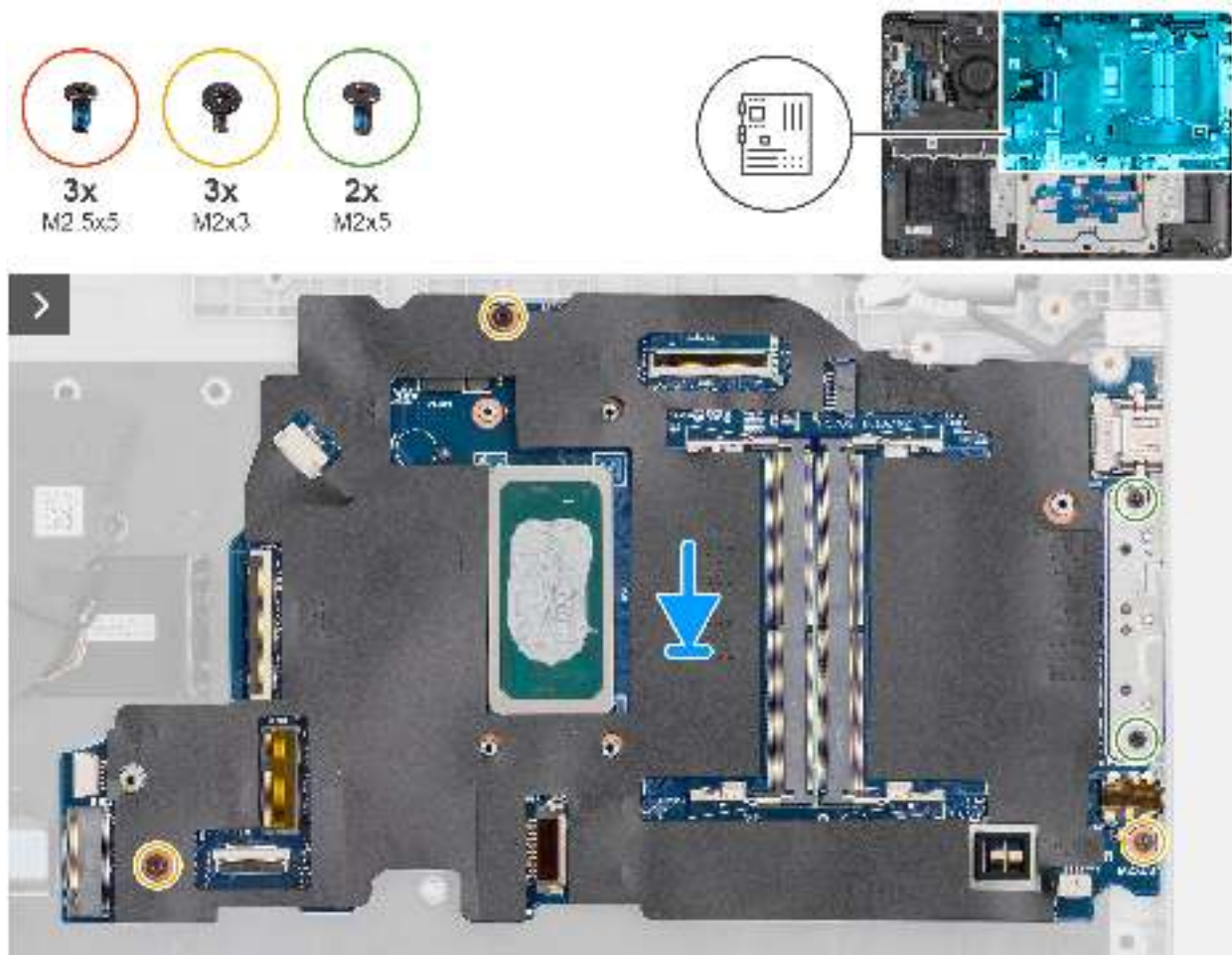
Abbildung 67. Einbauen der Systemplatine
