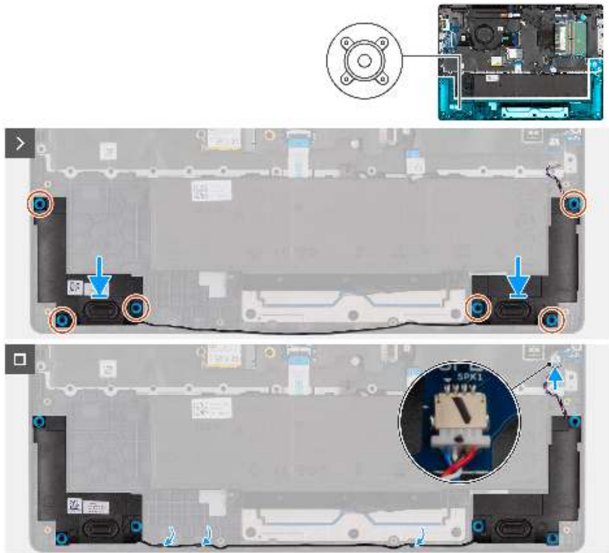
Abbildung 28. Installieren der Lautsprecher
