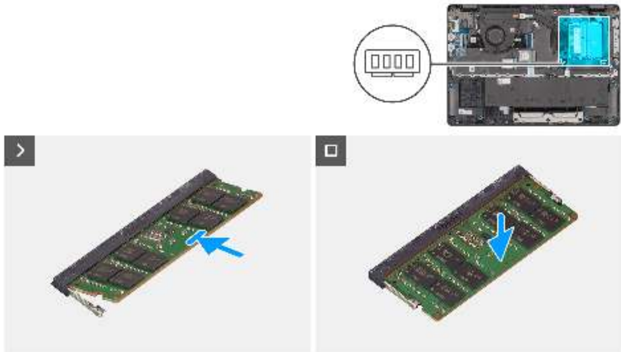
Abbildung 22. Einsetzen des Speichermoduls
