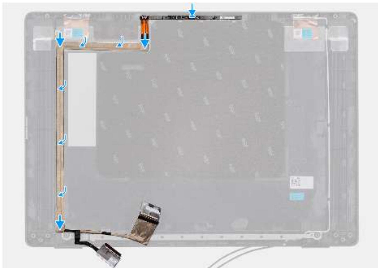
Abbildung 116. Einbauen des eDP-Kabels
