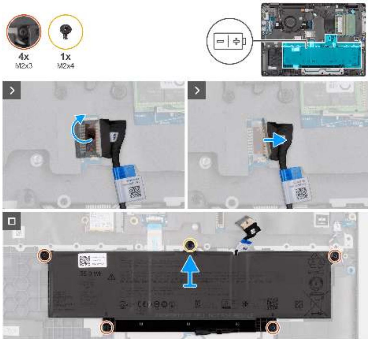
Abbildung 17. Entfernen des Akkus
