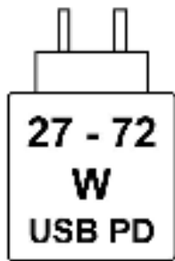
Abbildung 9. Piktogramm für die Anforderungen an die Stromversorgung
