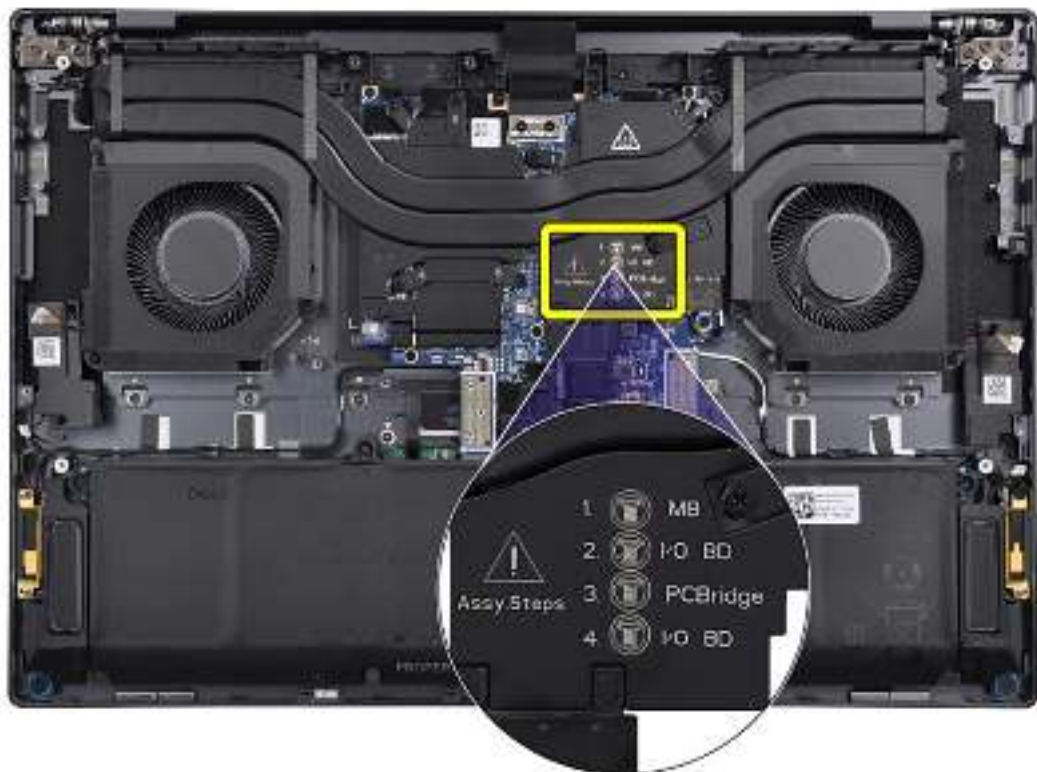
Abbildung 66. Auf dem Kühlkörper aufgedruckte Montageschritte
