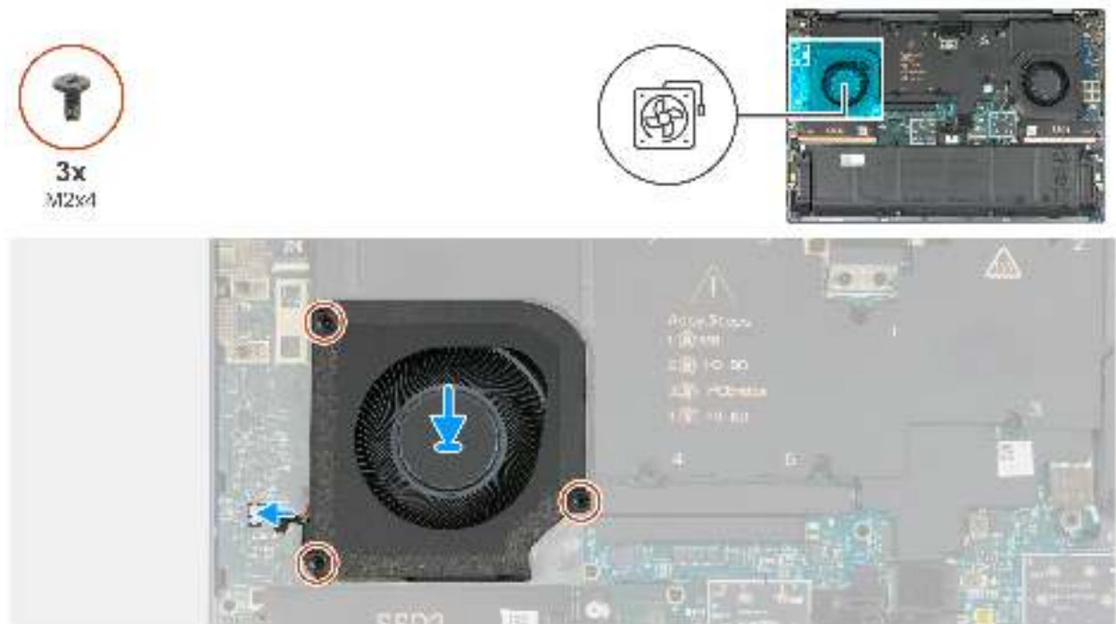
Abbildung 33. Installieren des rechten Lüfters
