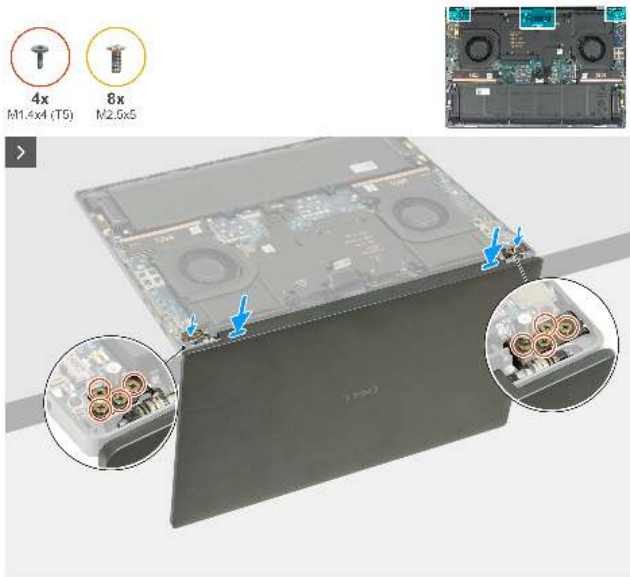
Abbildung 42. Einbauen der Bildschirmbaugruppe
