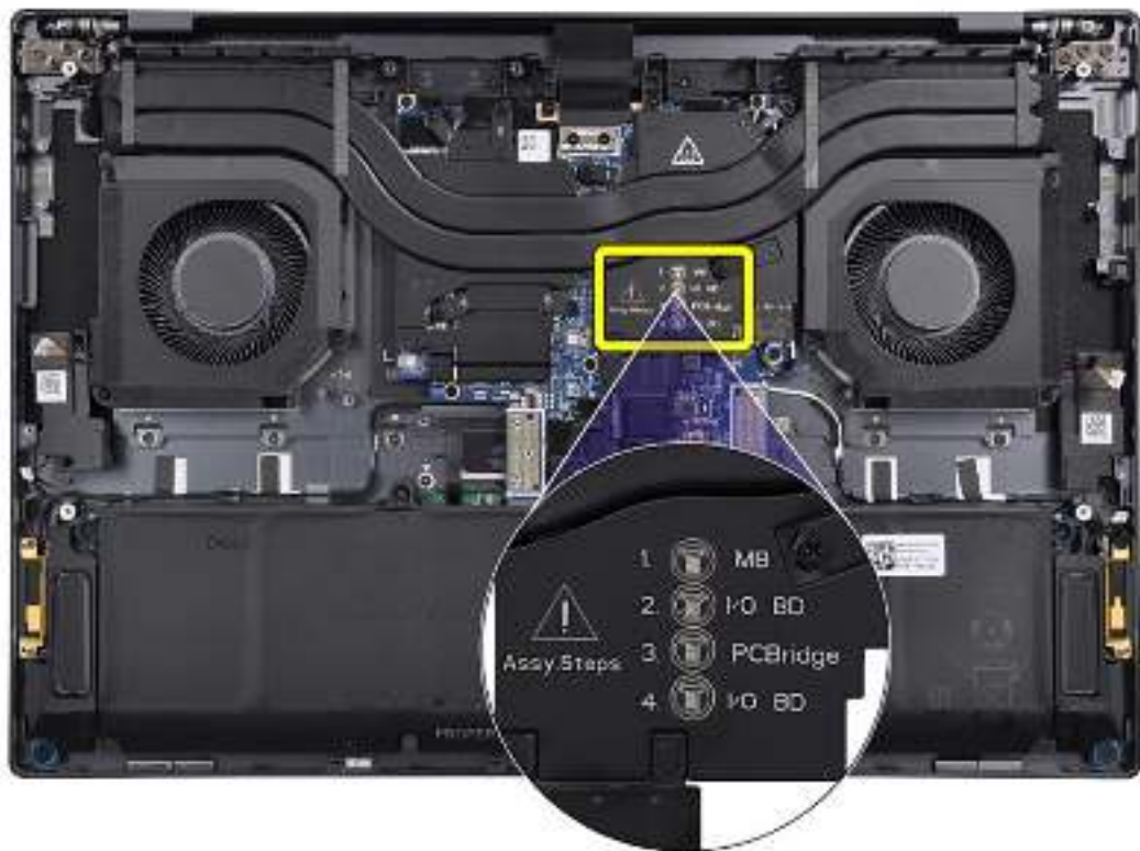
Abbildung 71. Auf dem Kühlkörper aufgedruckte Montageschritte
