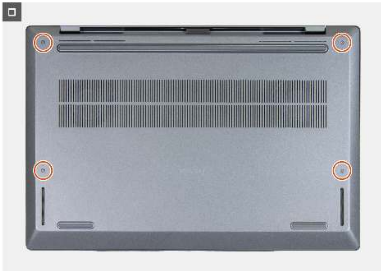
Abbildung 16. Anbringen der Bodenabdeckung
