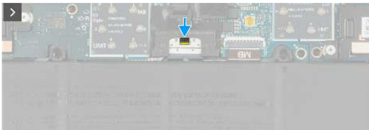
Abbildung 17. Wiederherstellung der Stromversorgung über den Akku
