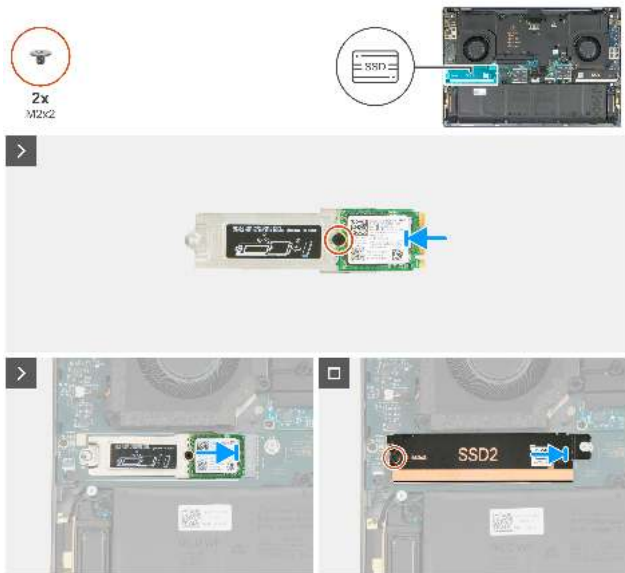
Abbildung 29. Einbauen des M.2 2230-Solid-State-Laufwerks (SSD2)
