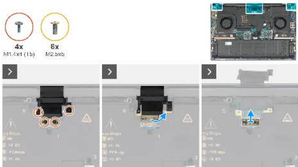
Abbildung 34. Entfernen der Bildschirmbaugruppe
