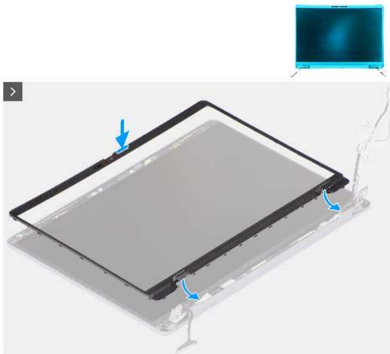
Abbildung 66. Einbauen der Bildschirmblende
