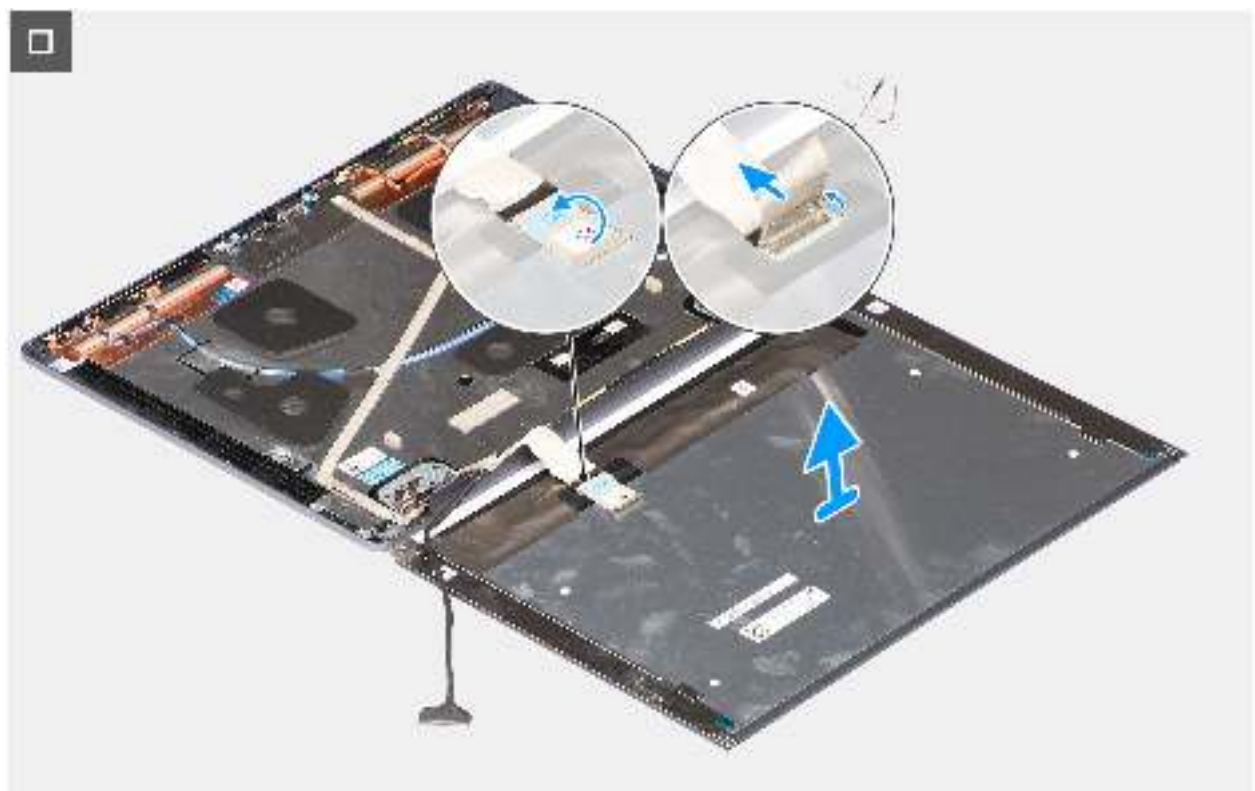
Abbildung 70. Entfernen des Bildschirms
