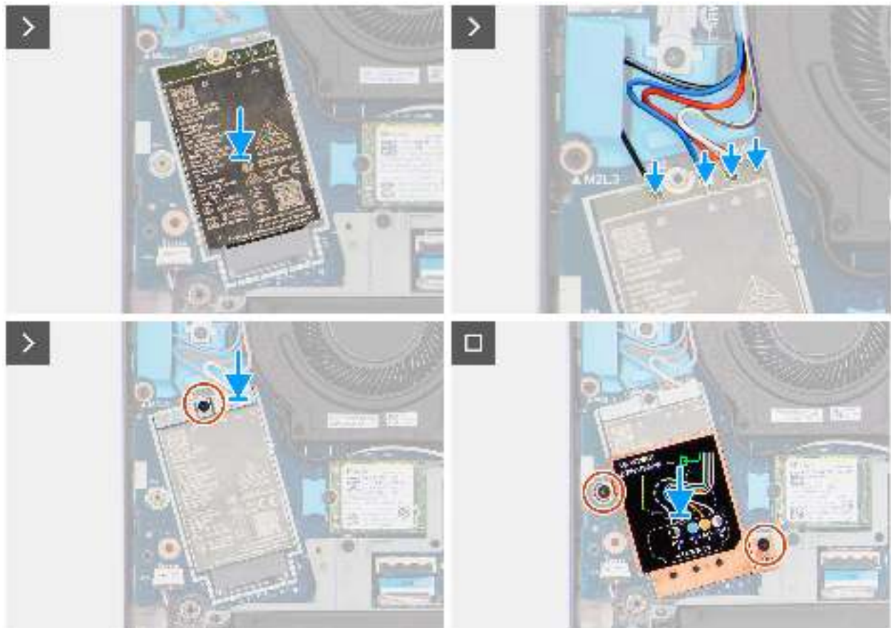
Abbildung 32. Installieren des WWAN-Moduls
