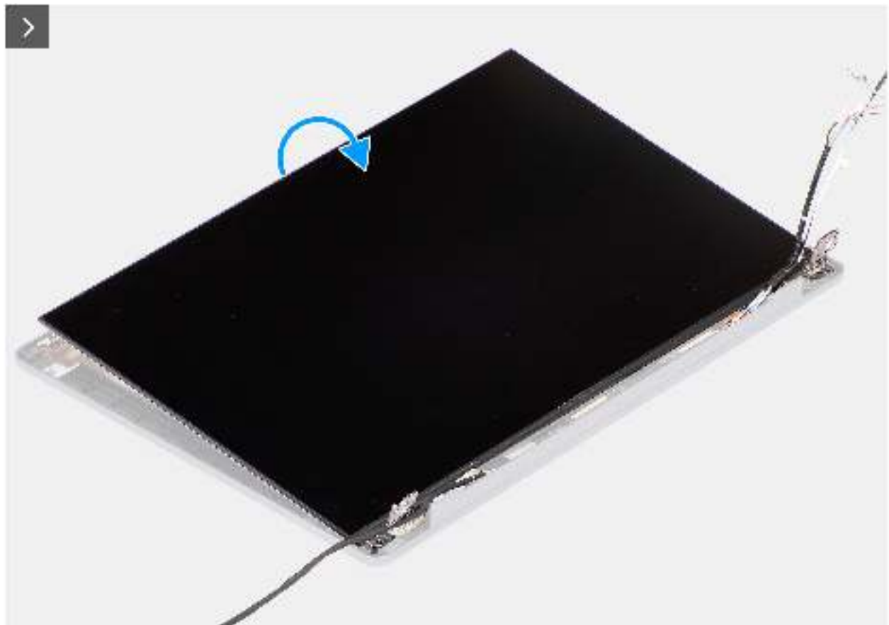
Abbildung 69. Entfernen des Bildschirms
