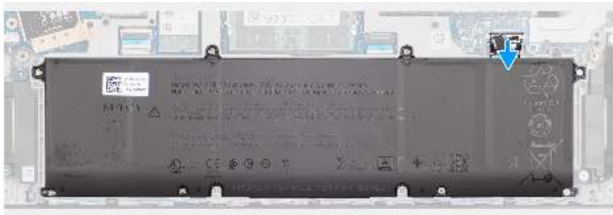
Abbildung 14. Entfernen des Akkukabels
