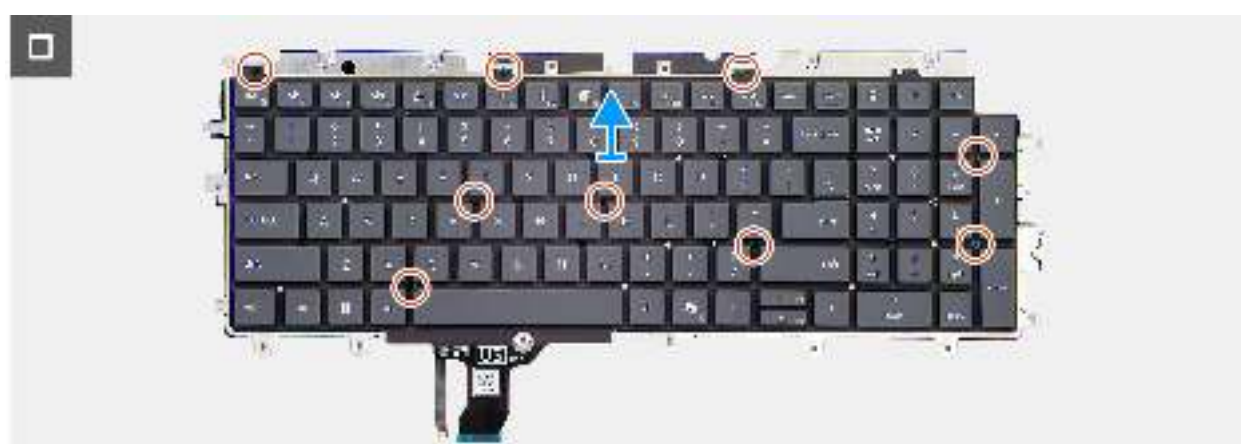
Abbildung 99. Entfernen der Tastatur
