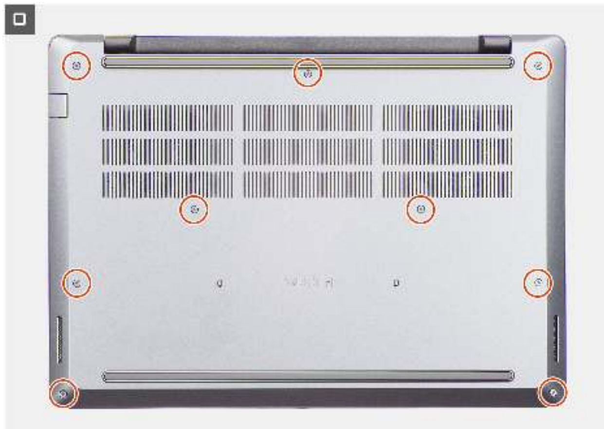
Abbildung 16. Anbringen der Bodenabdeckung
