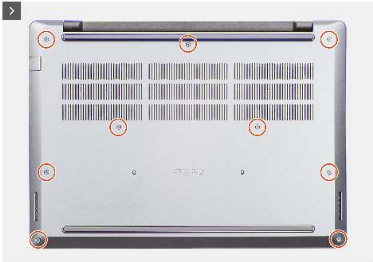
Abbildung 12. Entfernen der Bodenabdeckung
