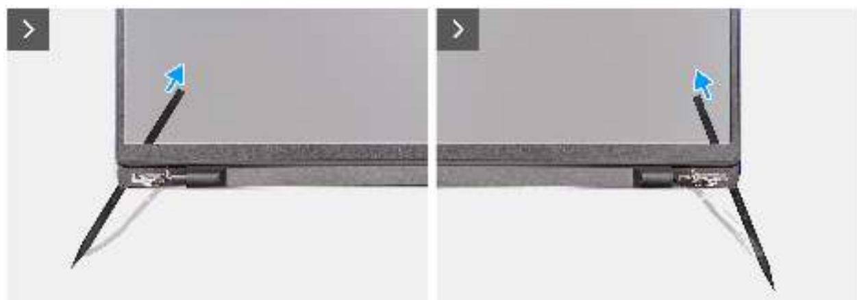
Abbildung 61. Entfernen der Bildschirmblende
