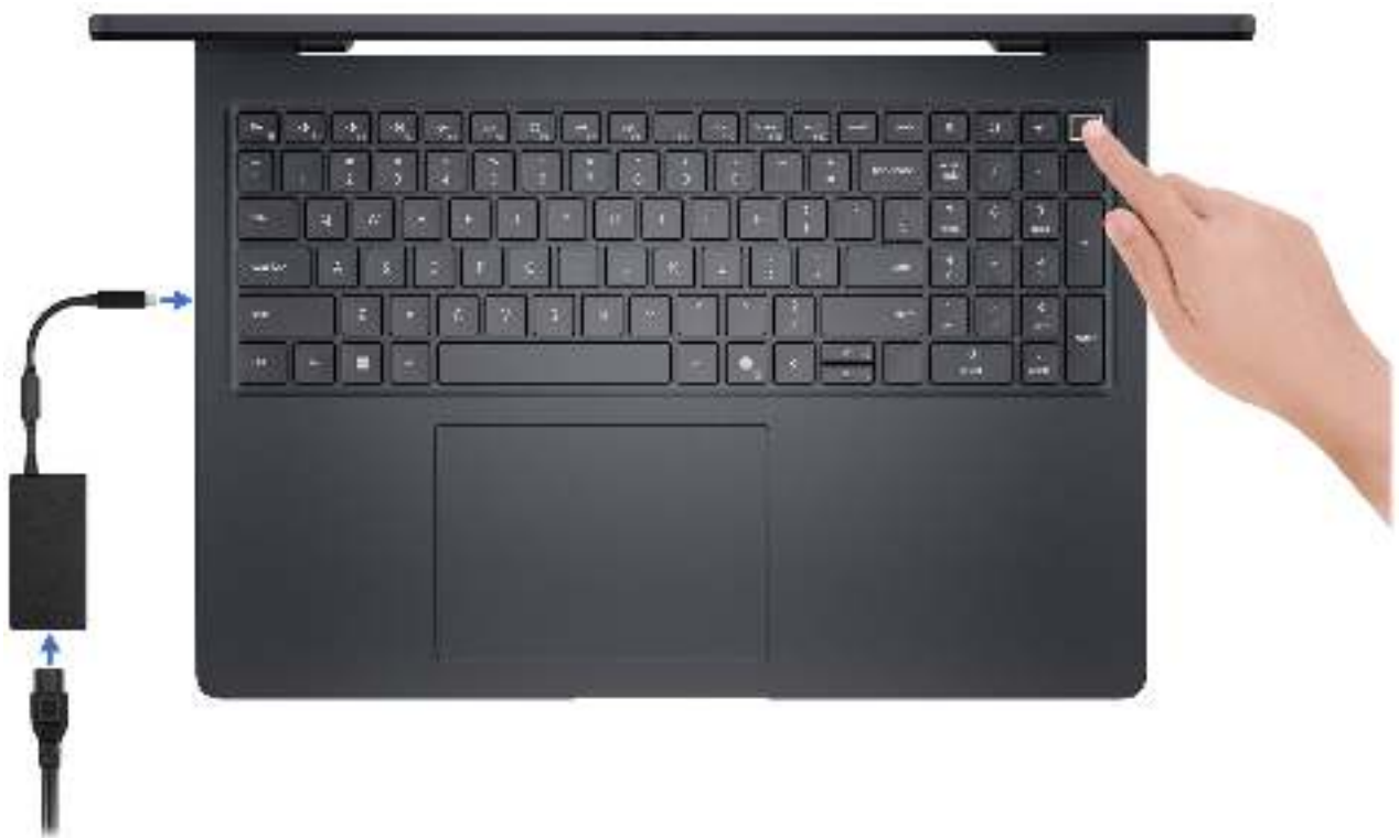
Abbildung 8. Anschließen des Netzteils und Drücken des Netzschalters
