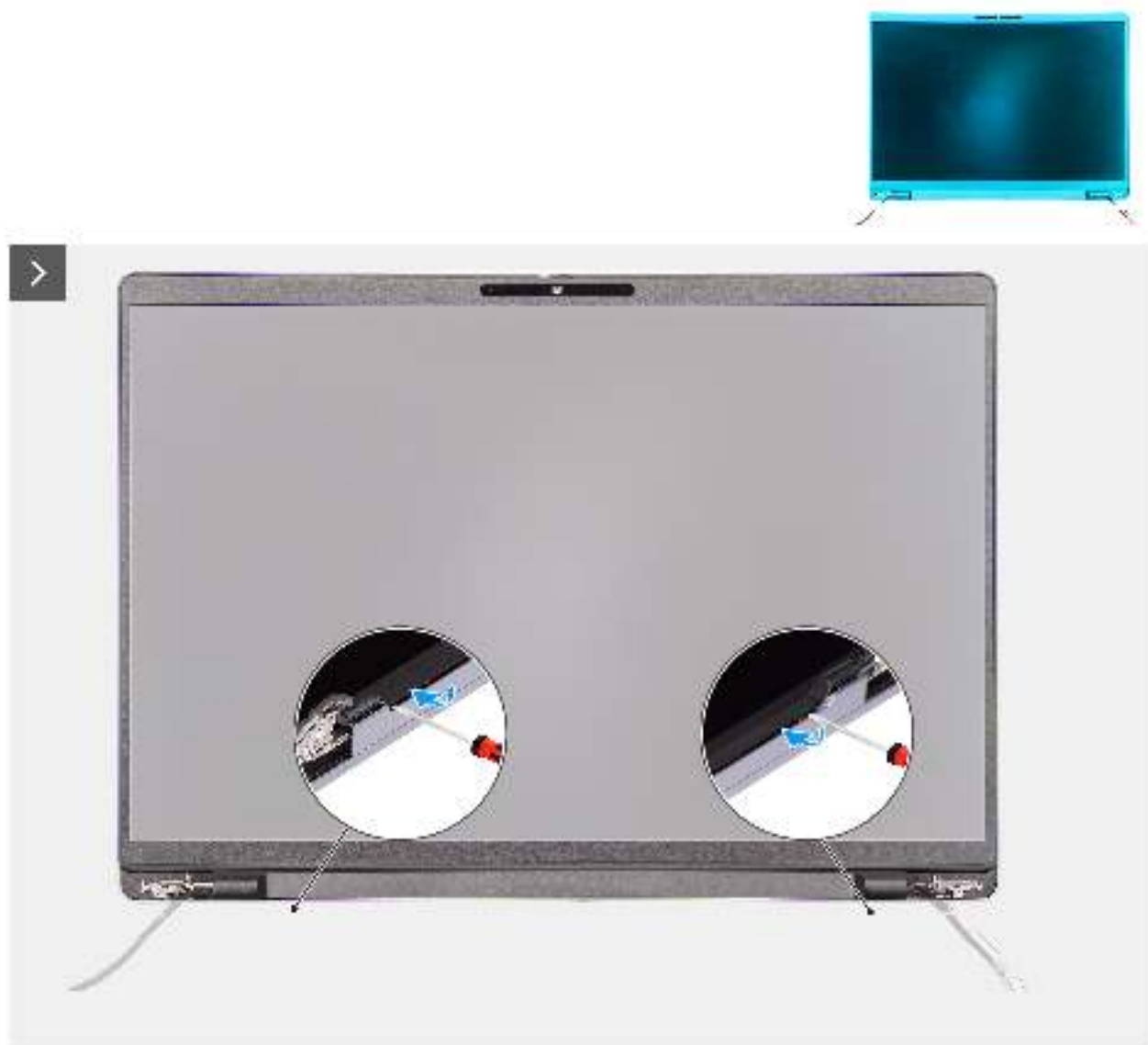
Abbildung 60. Entfernen der Bildschirmblende
