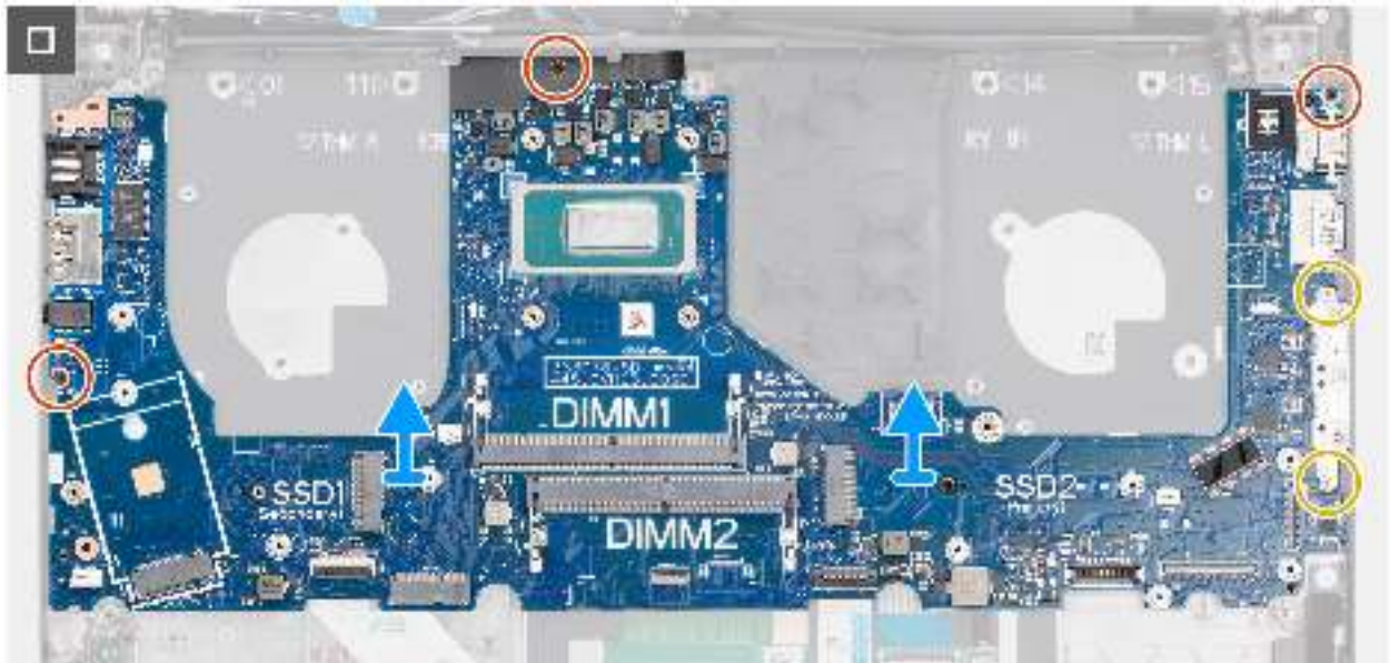
Abbildung 84. Entfernen der Systemplatine
