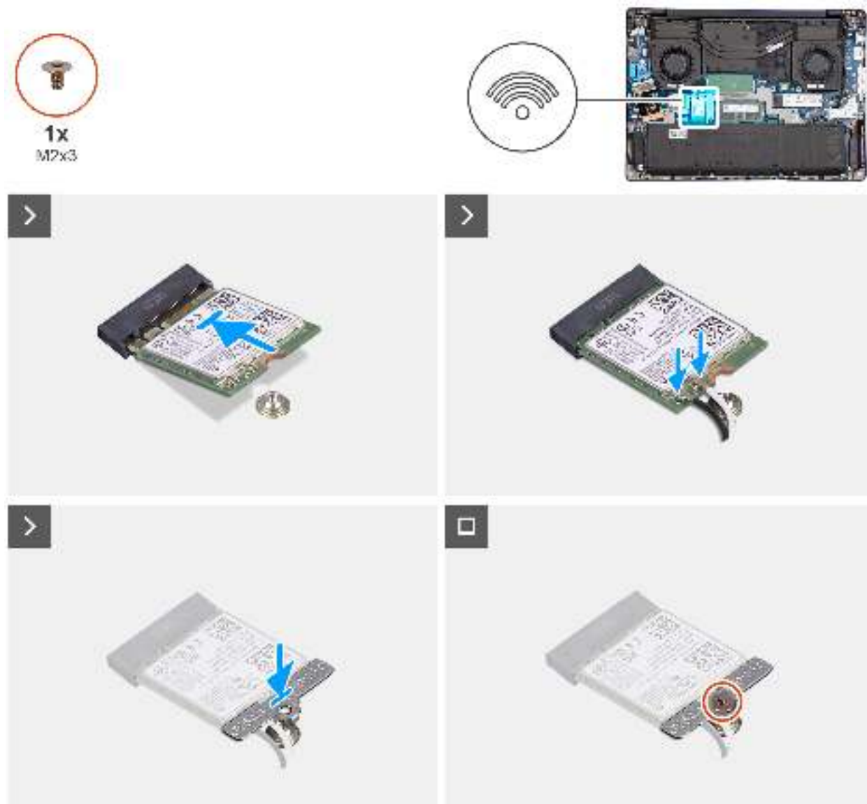
Abbildung 28. Installieren der Wireless-Karte
