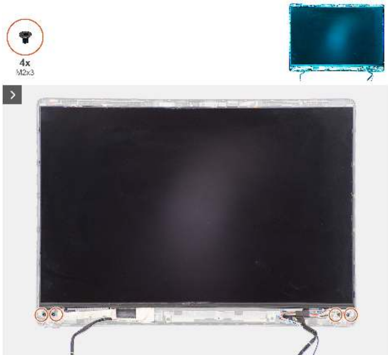
Abbildung 68. Entfernen des Bildschirms
