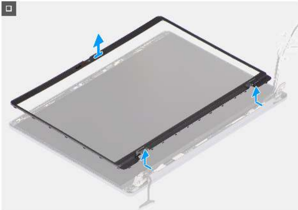
Abbildung 65. Entfernen der Bildschirmblende
