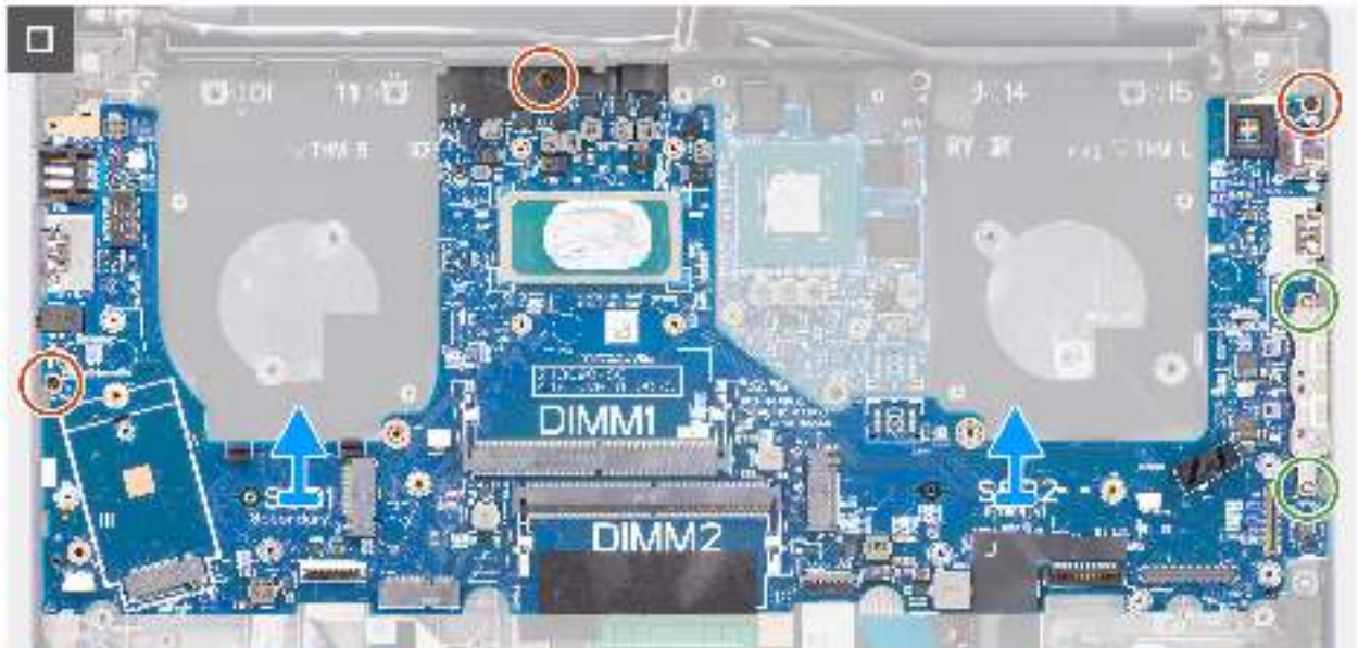
Abbildung 90. Entfernen der Systemplatine
