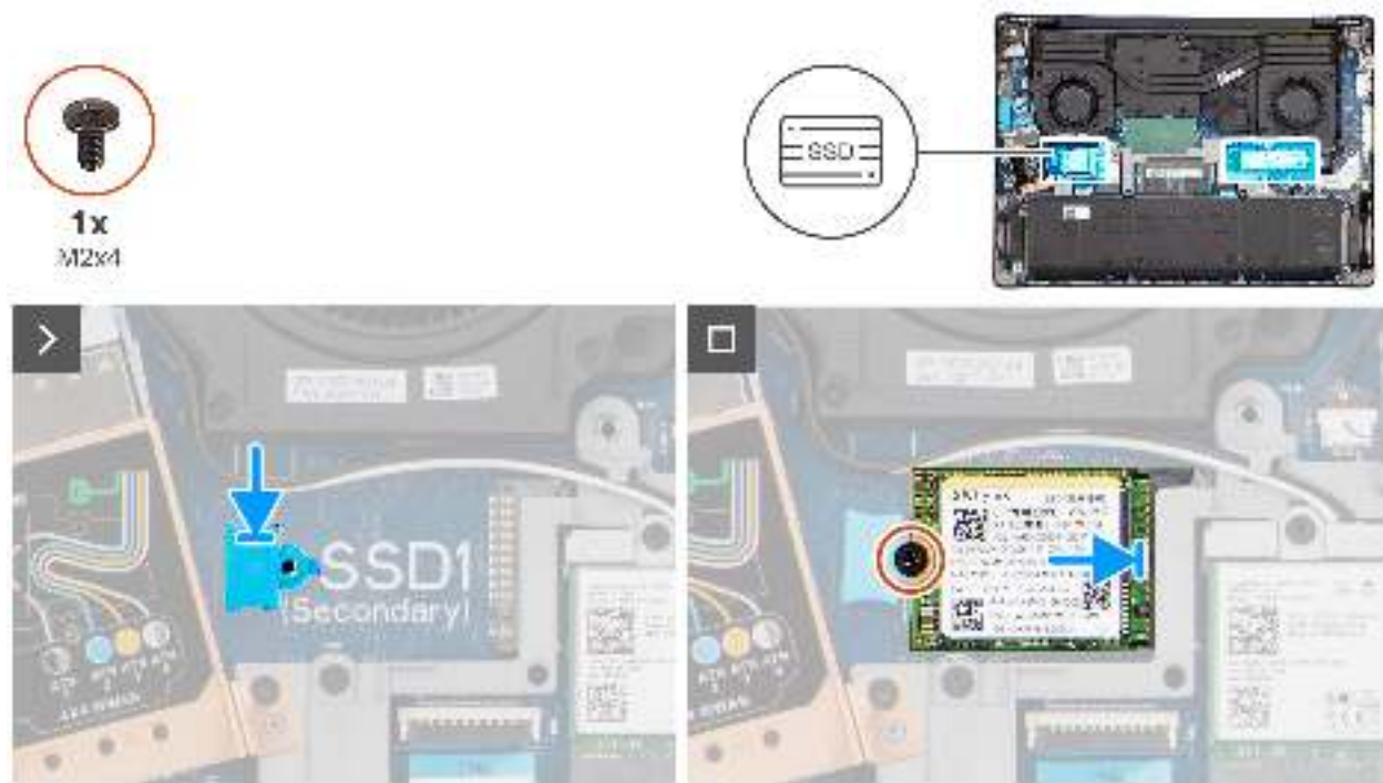
Abbildung 24. Installieren des M.2 2230-Solid-State-Laufwerks
