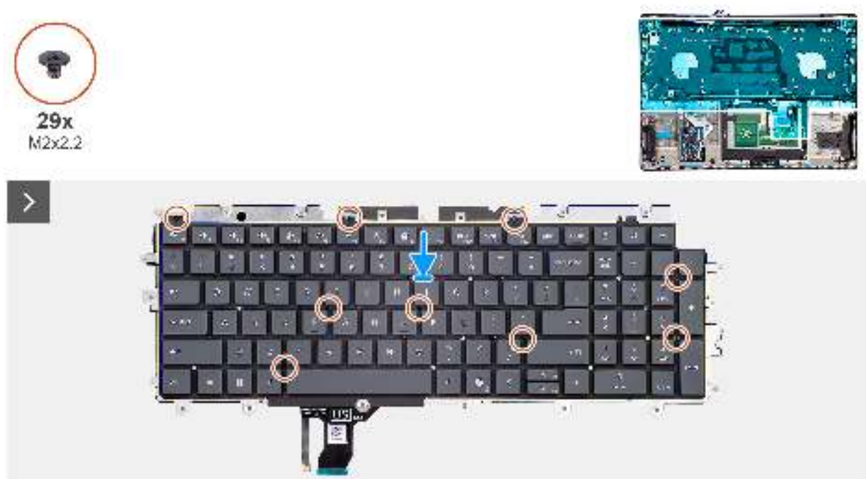
Abbildung 100. Einbauen der Tastatur
