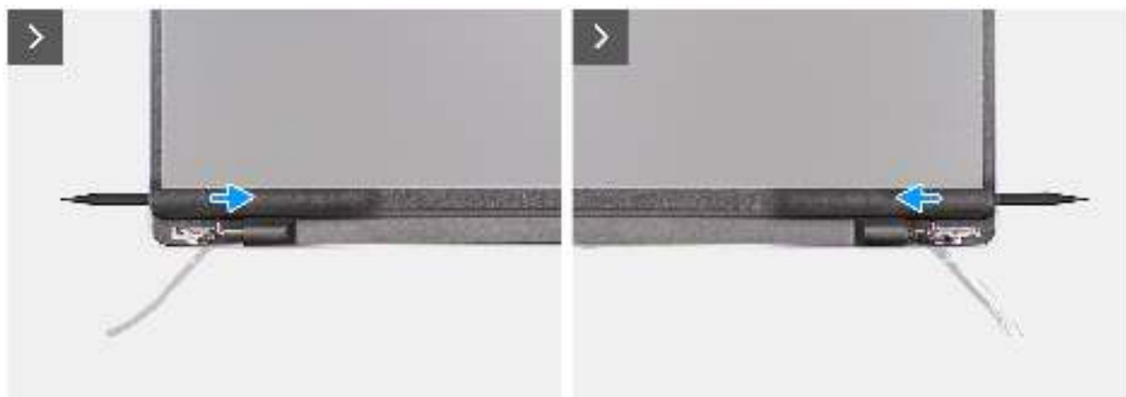
Abbildung 64. Entfernen der Bildschirmblende
