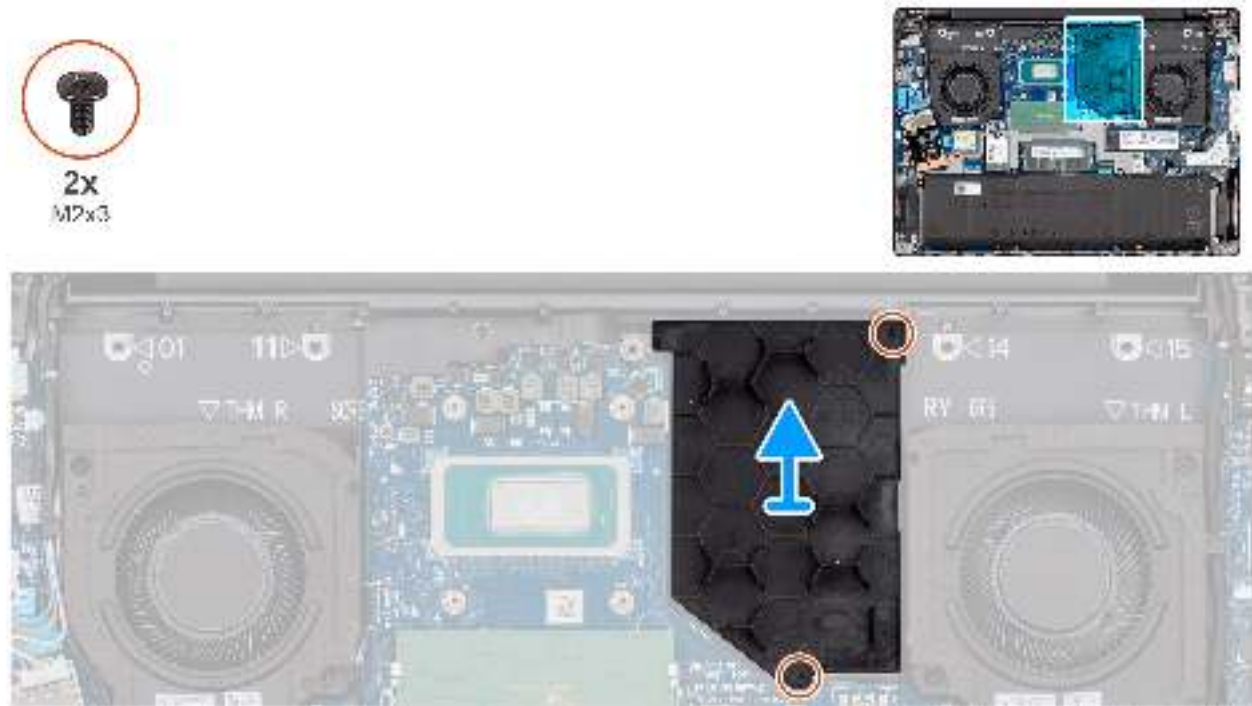
Abbildung 44. Entfernen des GPU-Platzhalters
