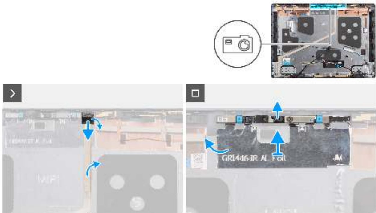
Abbildung 78. Entfernen der Kamera
