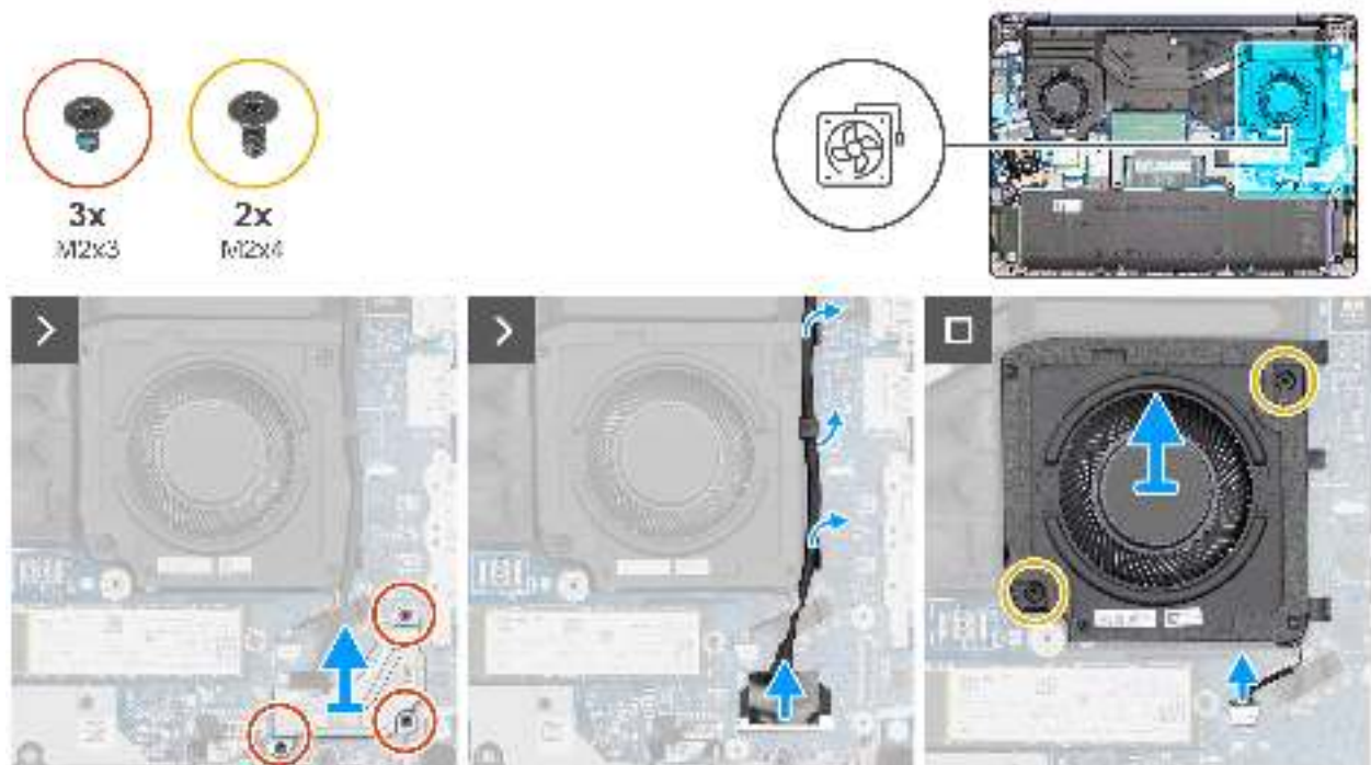
Abbildung 38. Entfernen des linken/Videolüfters
