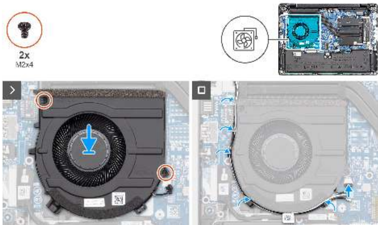
Abbildung 32. Installing the fan
