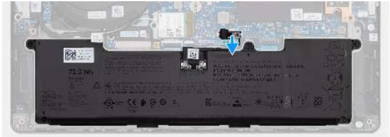
Abbildung 13. Entfernen des Akkukabels
