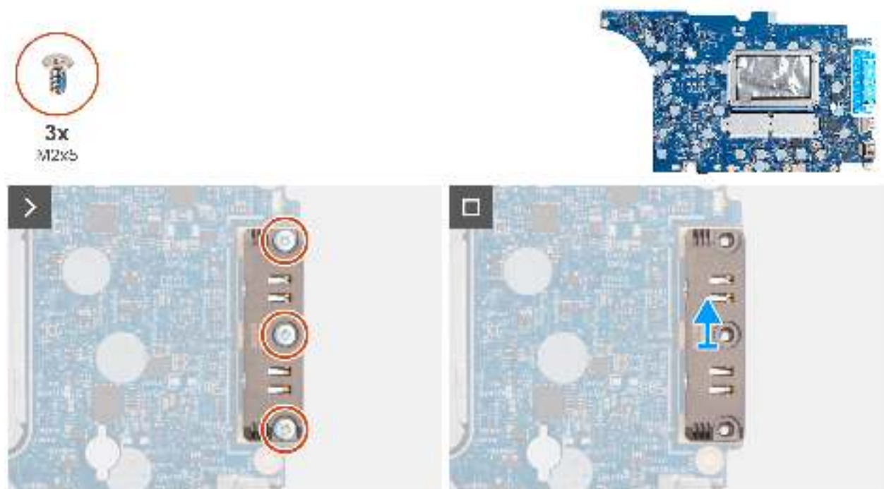
Abbildung 92. Removing the USB Type-C module
