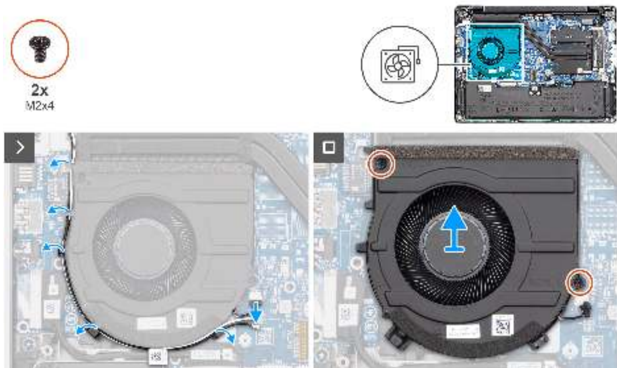
Abbildung 31. Entfernen des Lüfters
