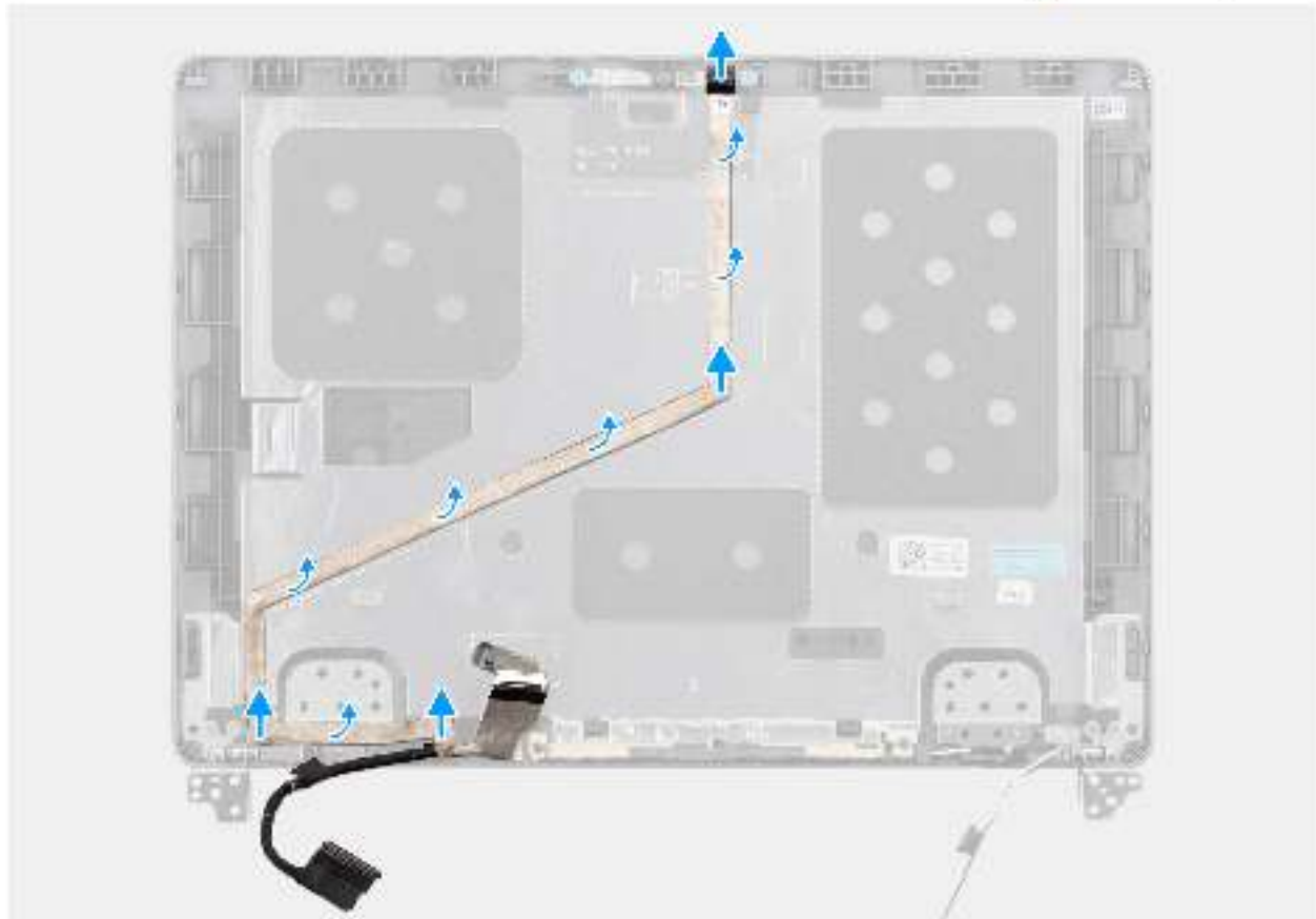
Abbildung 68. Entfernen des Bildschirmkabels
