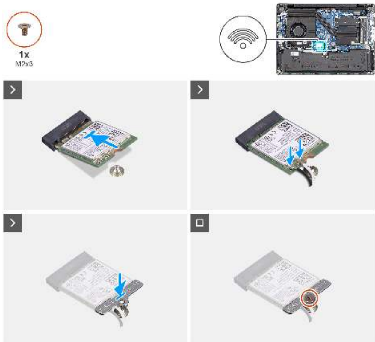
Abbildung 27. Installieren der Wireless-Karte
