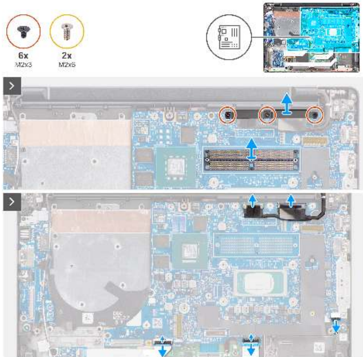
Abbildung 87. Entfernen der Systemplatine
