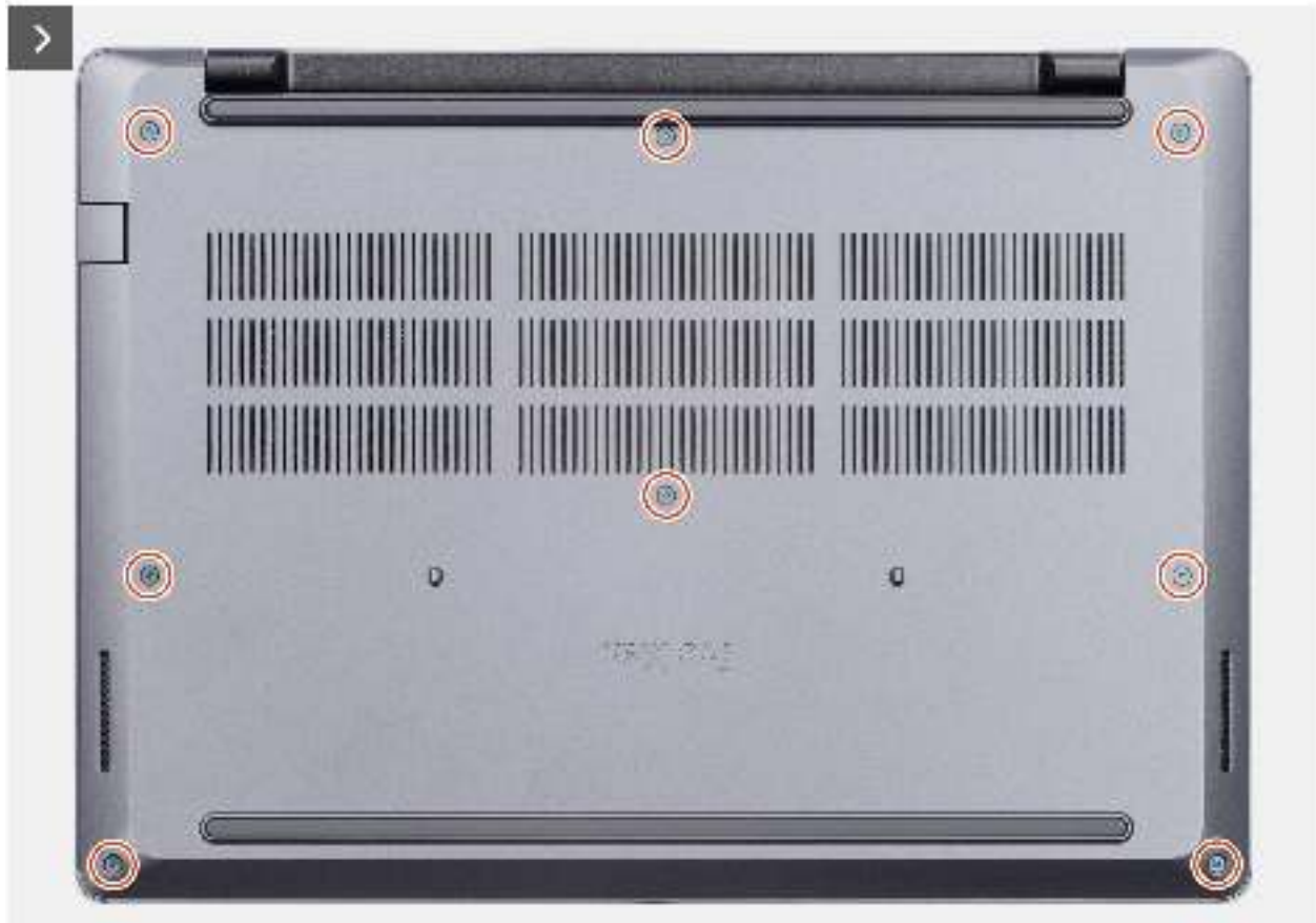
Abbildung 11. Entfernen der Bodenabdeckung
