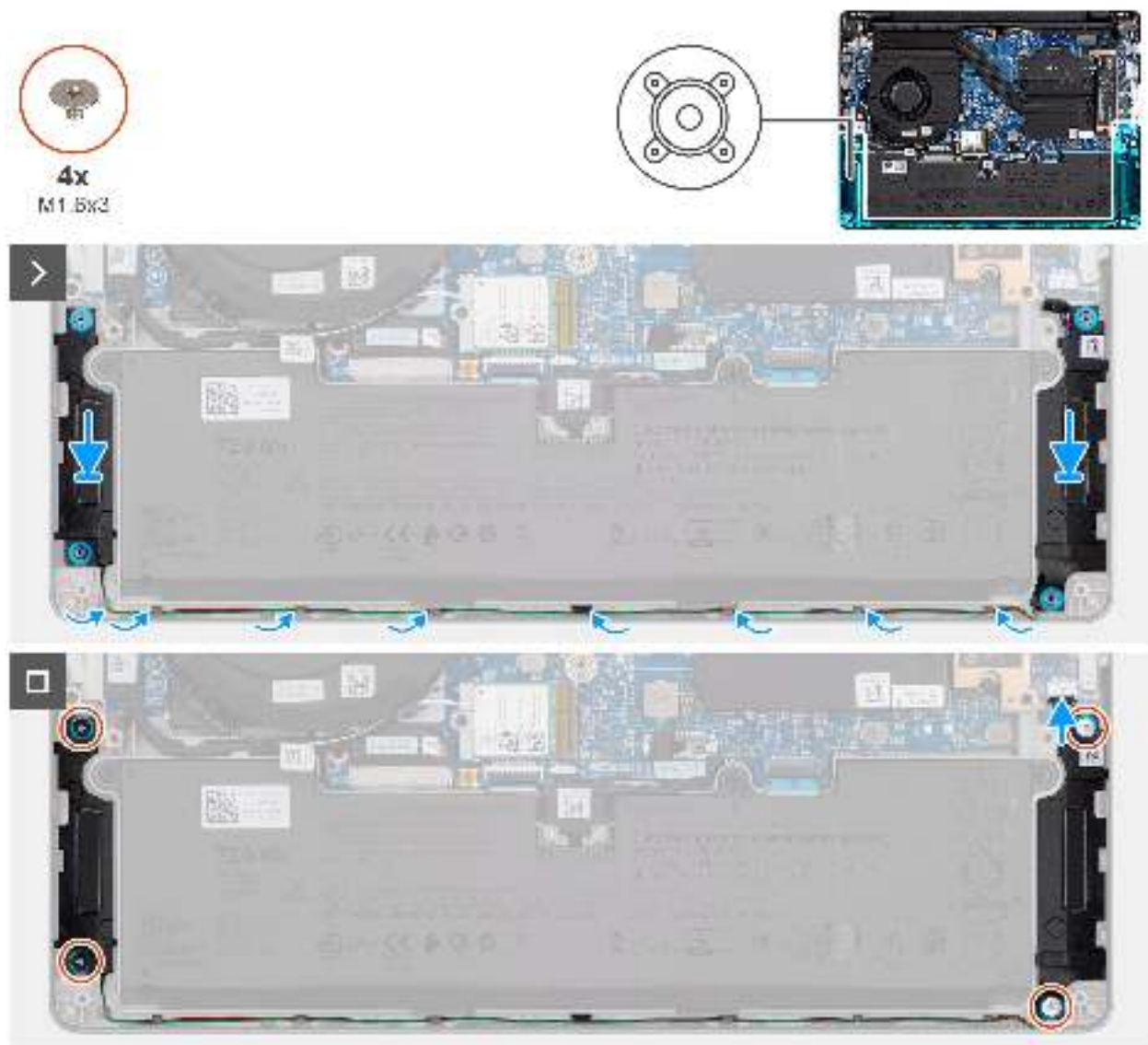
Abbildung 29. Installing the speakers
