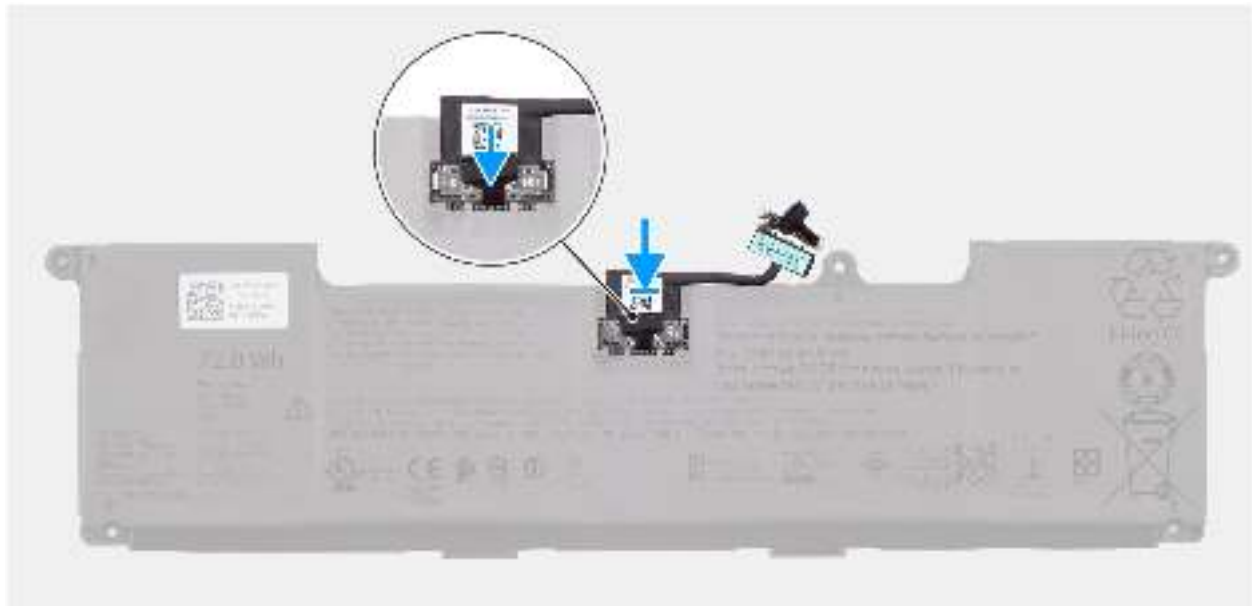
Abbildung 19. Verbinden des Akkukabels
