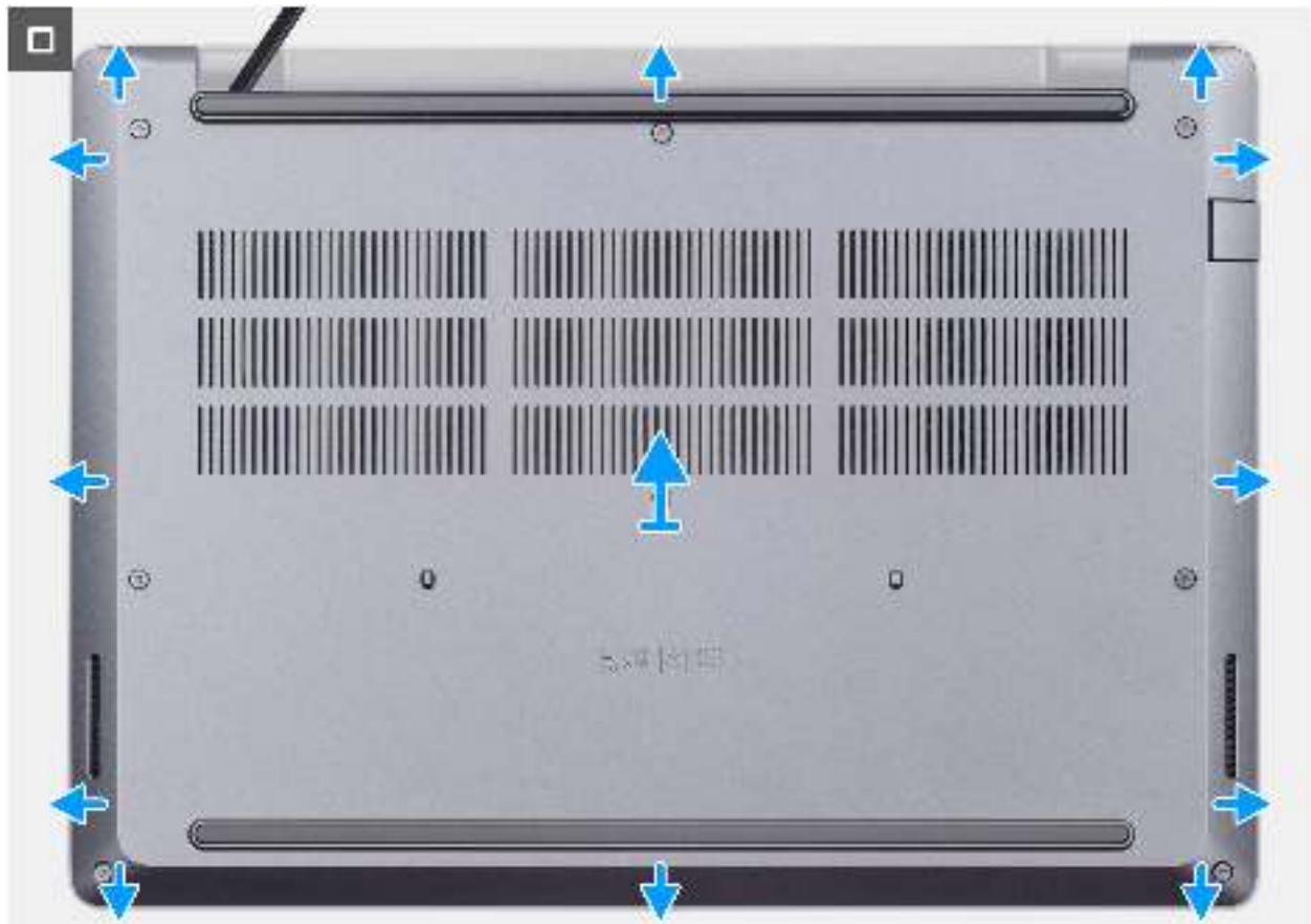
Abbildung 12. Entfernen der Bodenabdeckung
