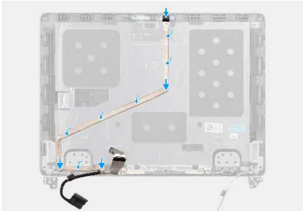
Abbildung 69. Installing the display cable
