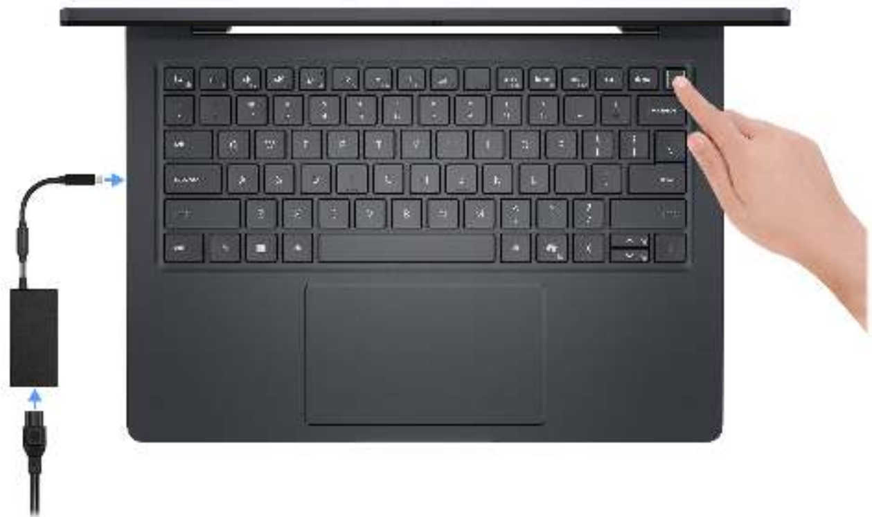
Abbildung 8. Anschließen des Netzteils und Drücken des Netzschalters
