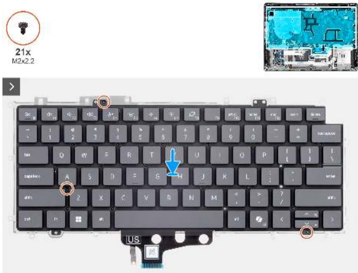
Abbildung 97. Installing the keyboard
