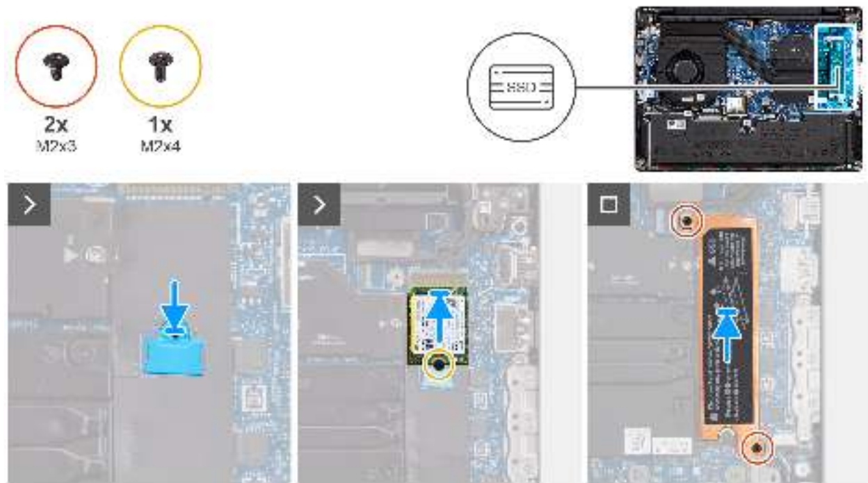
Abbildung 23. Installieren des M.2 2230-Solid-State-Laufwerks
