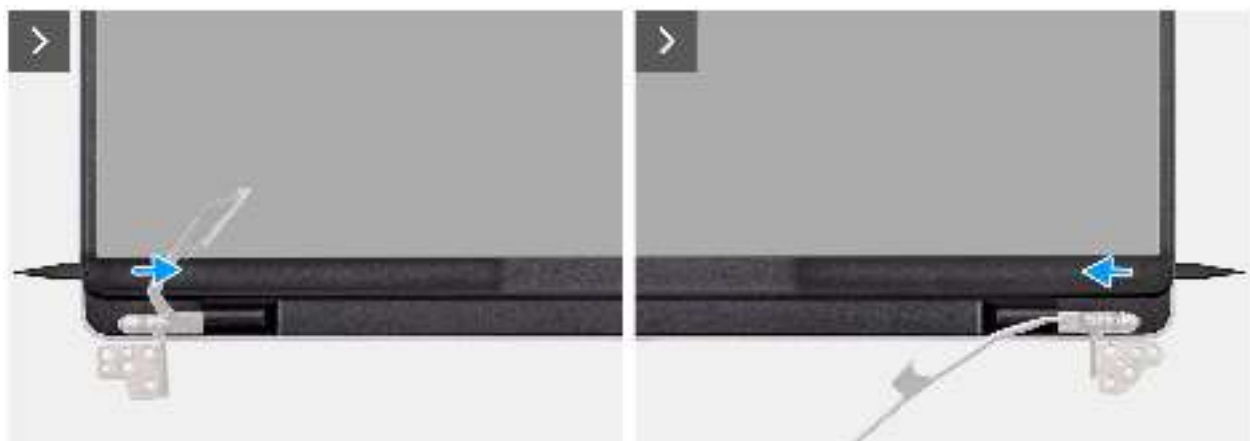
Abbildung 56. Removing the display bezel
