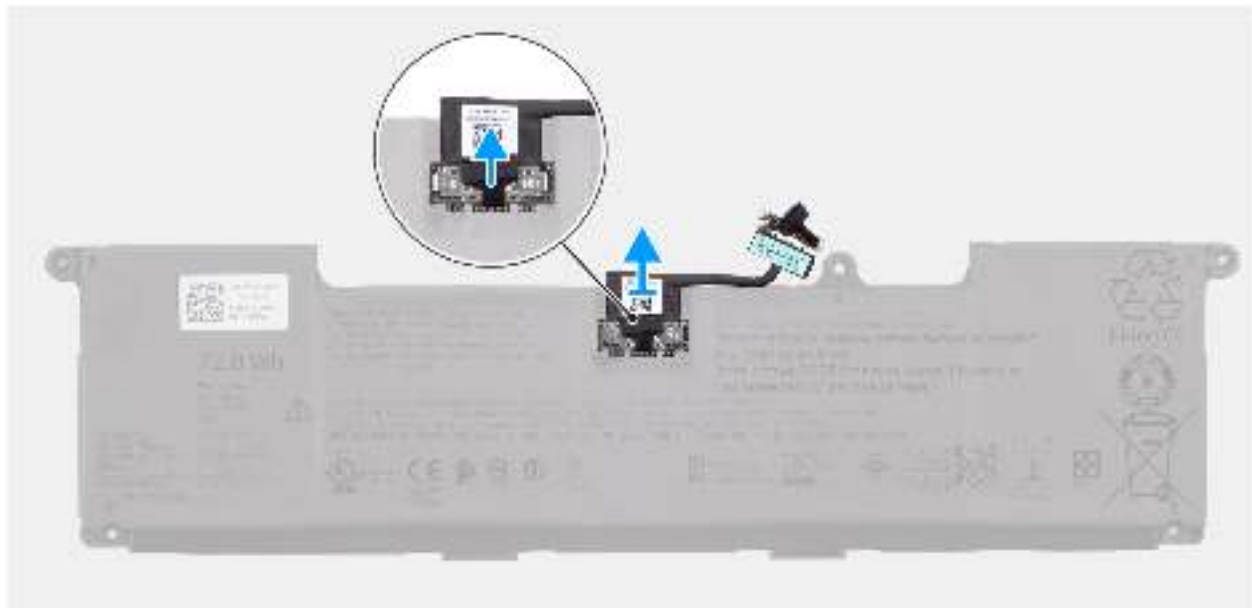
Abbildung 18. Trennen des Batteriekabels.
