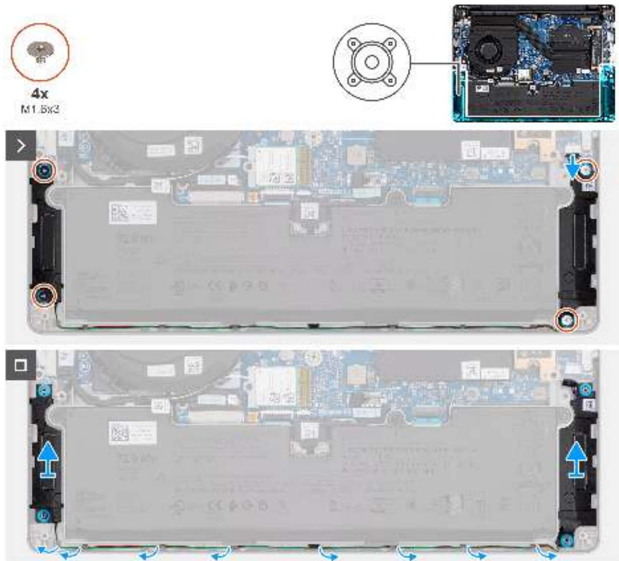
Abbildung 28. Removing the speakers
