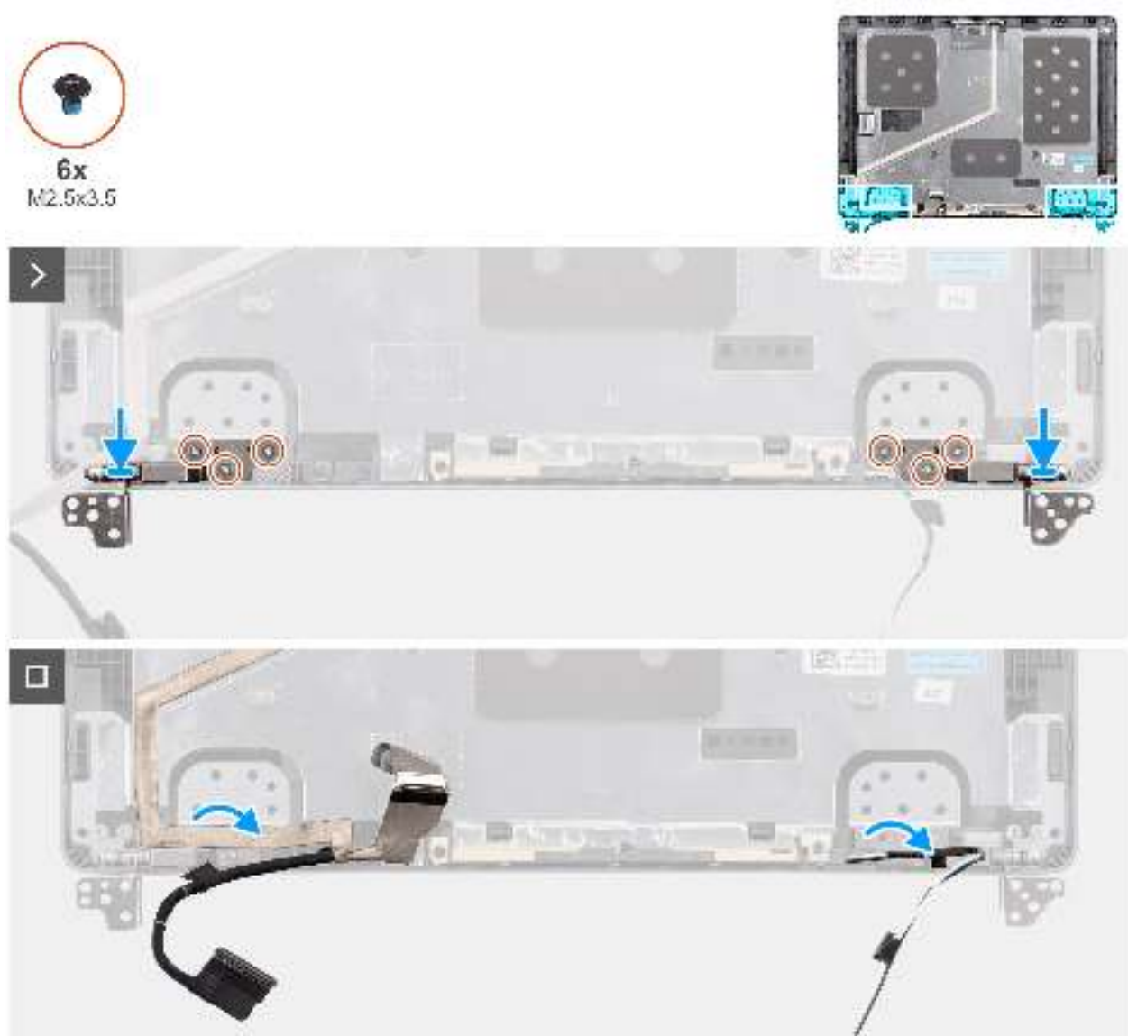
Abbildung 67. Installing the display hinges
