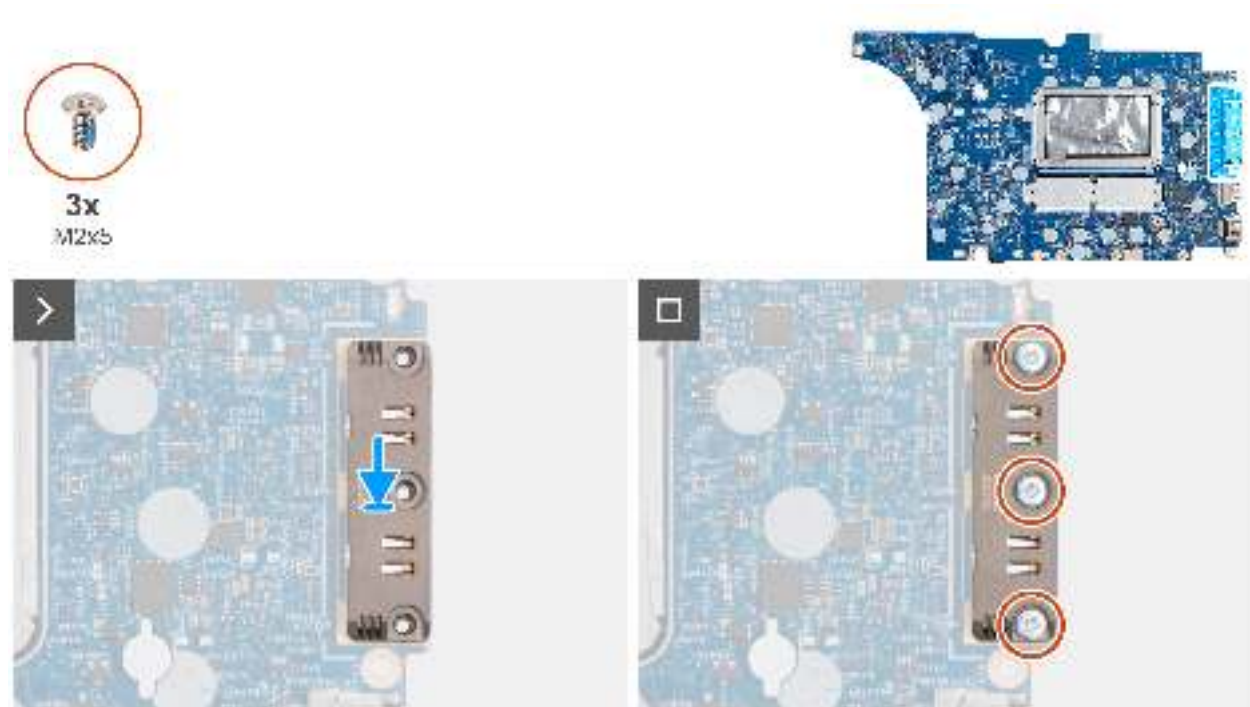
Abbildung 93. Installing the USB Type-C module
