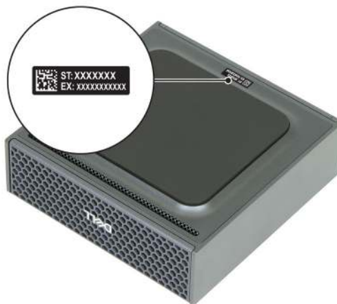
Abbildung 3. Position der Service-Tag-Nummer des Dell Pro Max mit GB10-FCM1253
