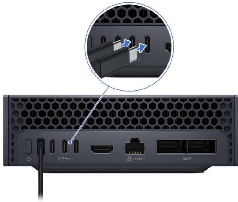
Abbildung 11. Anschließen der Maus und Tastatur
