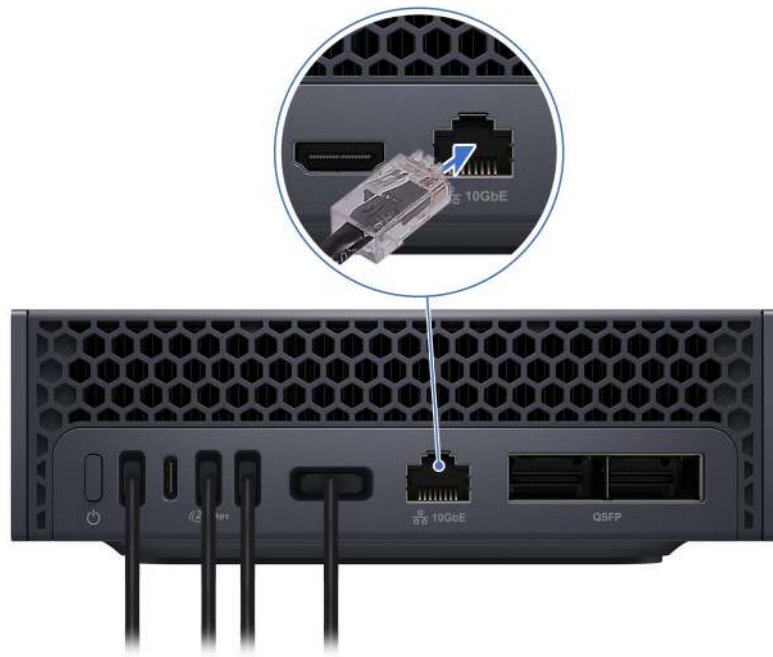
Abbildung 13. Verbinden des Computers mit dem Internet
