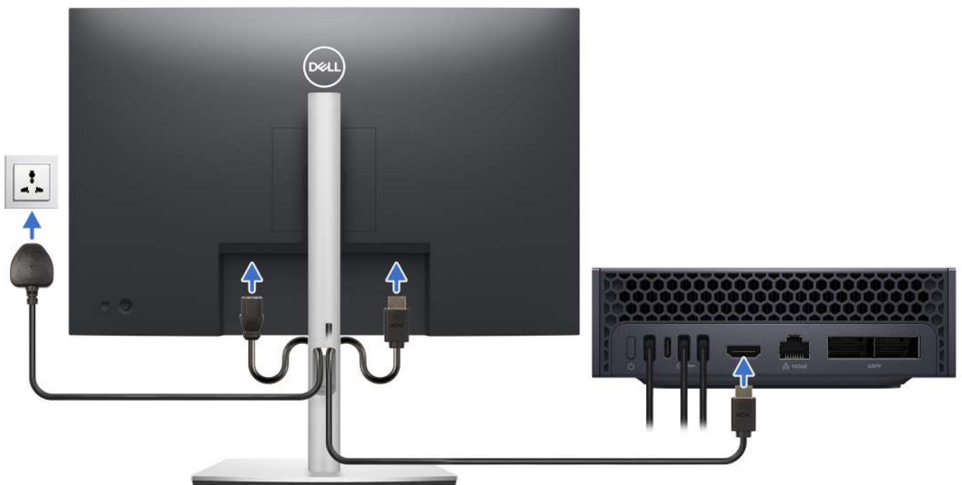
Abbildung 12. Anschließen des Displays
