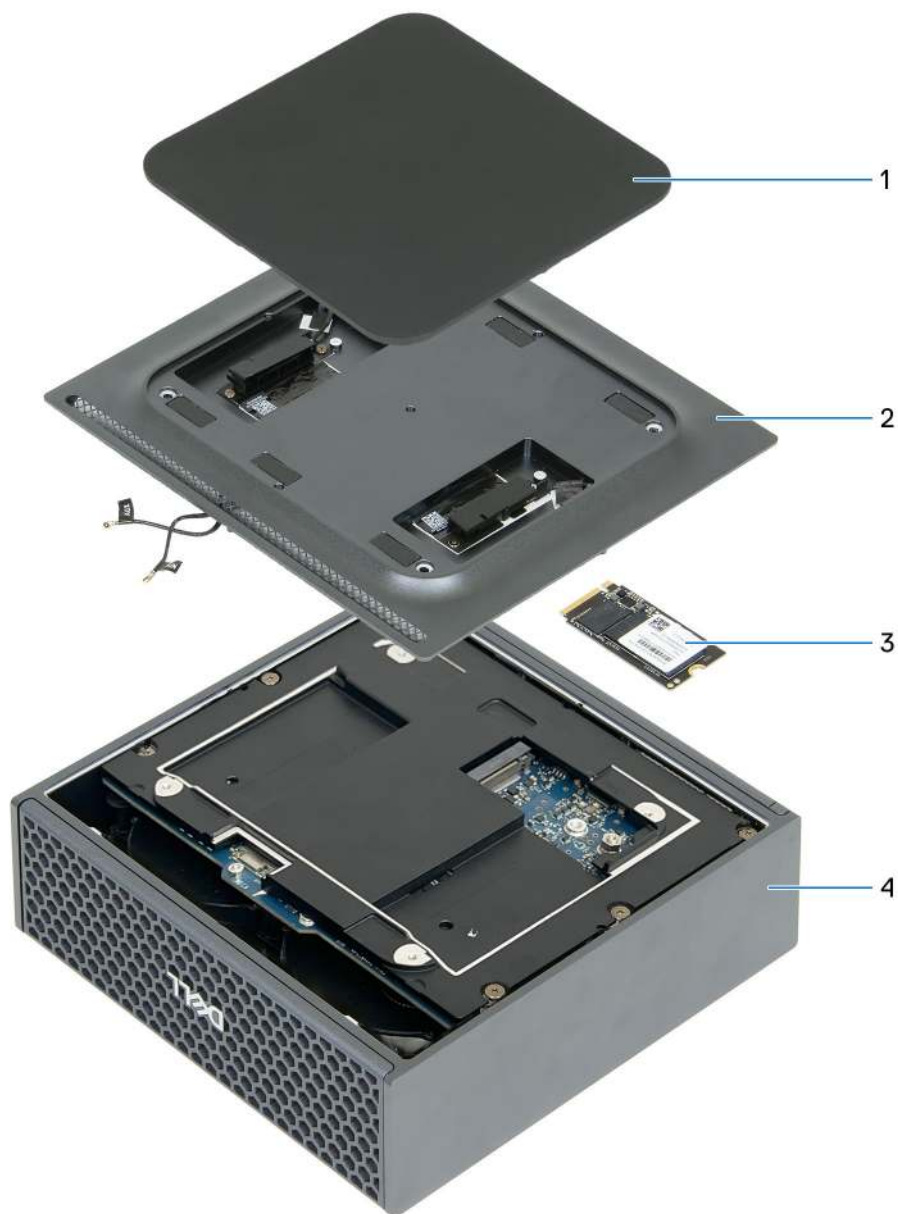
Abbildung 15. Hauptkomponenten von Dell Pro Max mit GB10
