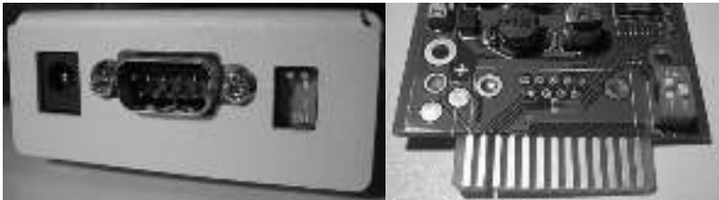
Abbildung 3: DIP- (Kipp-) Schalter: CS121L (links) im Konfigurationsmodus (IP 10.10.10.10) und CS121SC (rechts) im normalen Betriebsmodus
