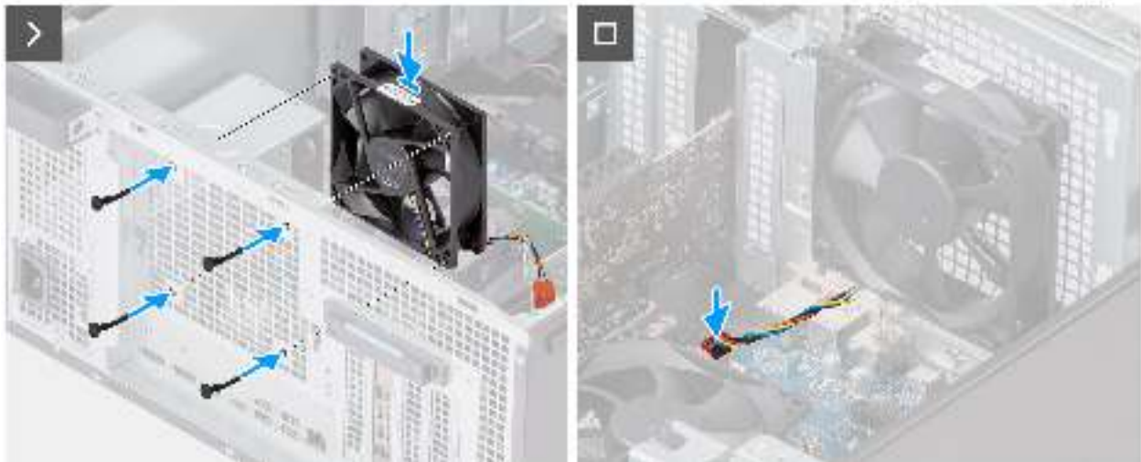
Abbildung 50. Installieren des hinteren Lüfters bei Computern mit 360-W-Netzteilen
