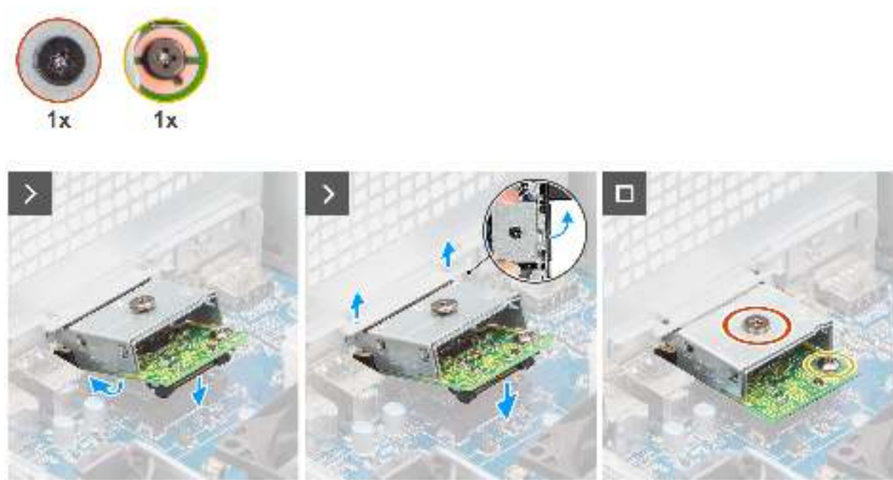
Abbildung 69. Installieren des optionalen DisplayPort-Moduls
