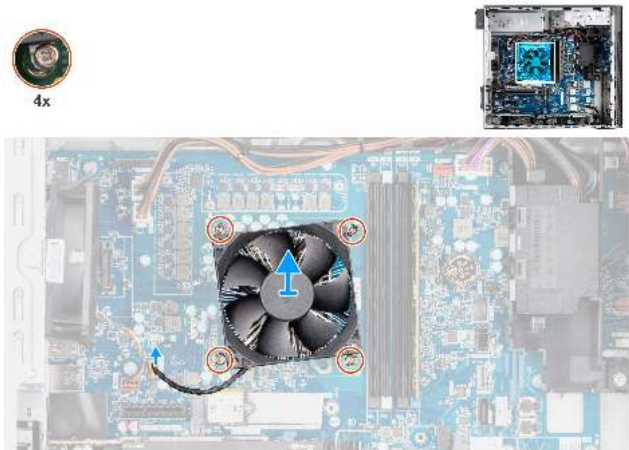
Abbildung 61. Entfernen des Prozessorlüfters und der 65-W-Kühlkörperbaugruppe
