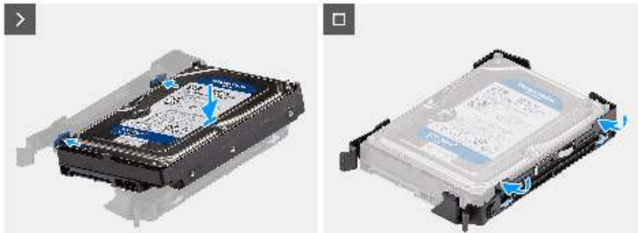
Abbildung 28. Einbauen der 3,5-Zoll-Festplattenhalterung
