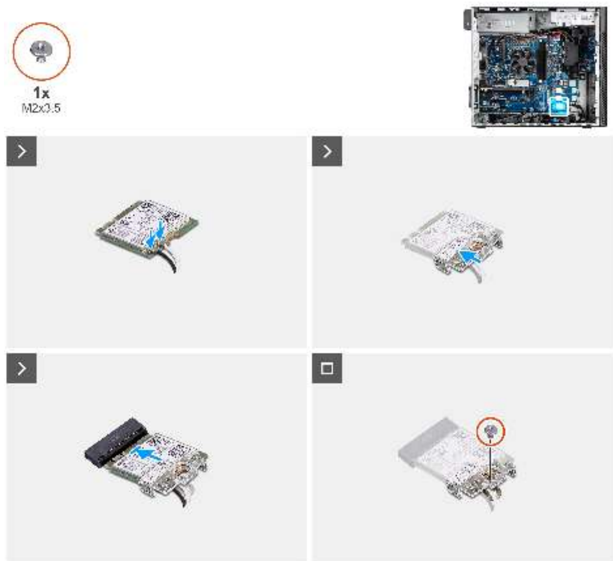
Abbildung 42. Installieren der Wireless-Karte
