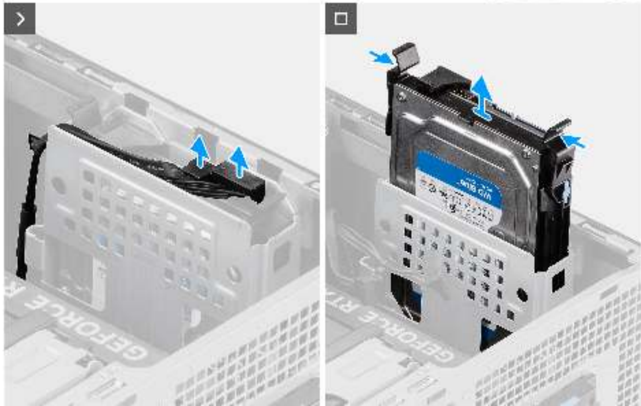
Abbildung 26. Entfernen der 3,5-Zoll-Festplattenbaugruppe (Schacht 2)
