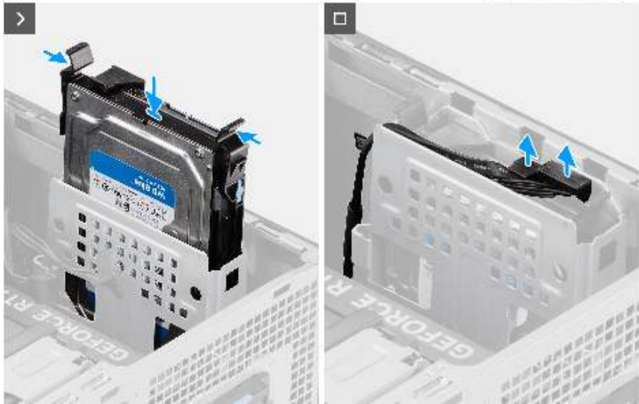
Abbildung 29. Installieren der 3,5-Zoll-Festplattenbaugruppe (Schacht 2)
