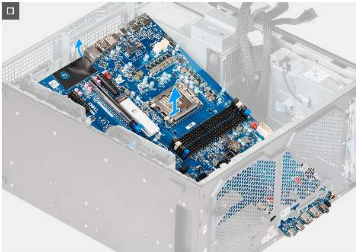
Abbildung 92. Entfernen der Systemplatine
