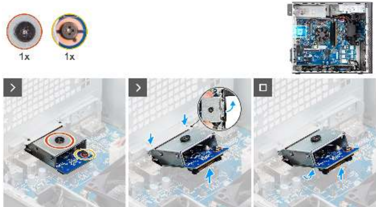
Abbildung 85. Entfernen des optionalen VGA-Moduls
