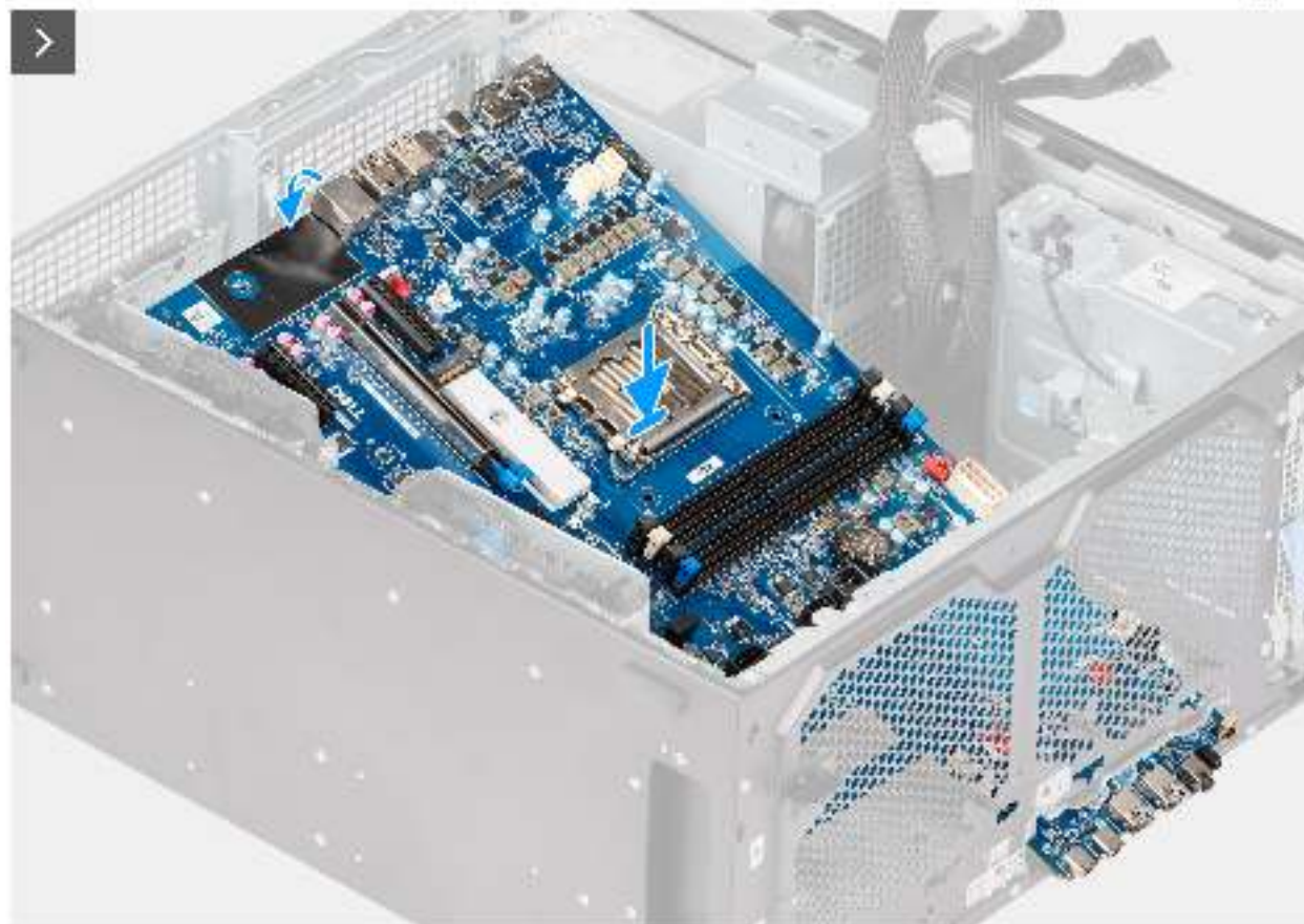
Abbildung 94. Einbauen der Systemplatine
