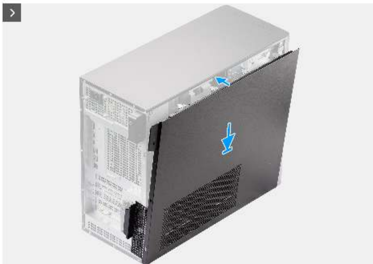
Abbildung 11. Anbringen der Seitenabdeckung
