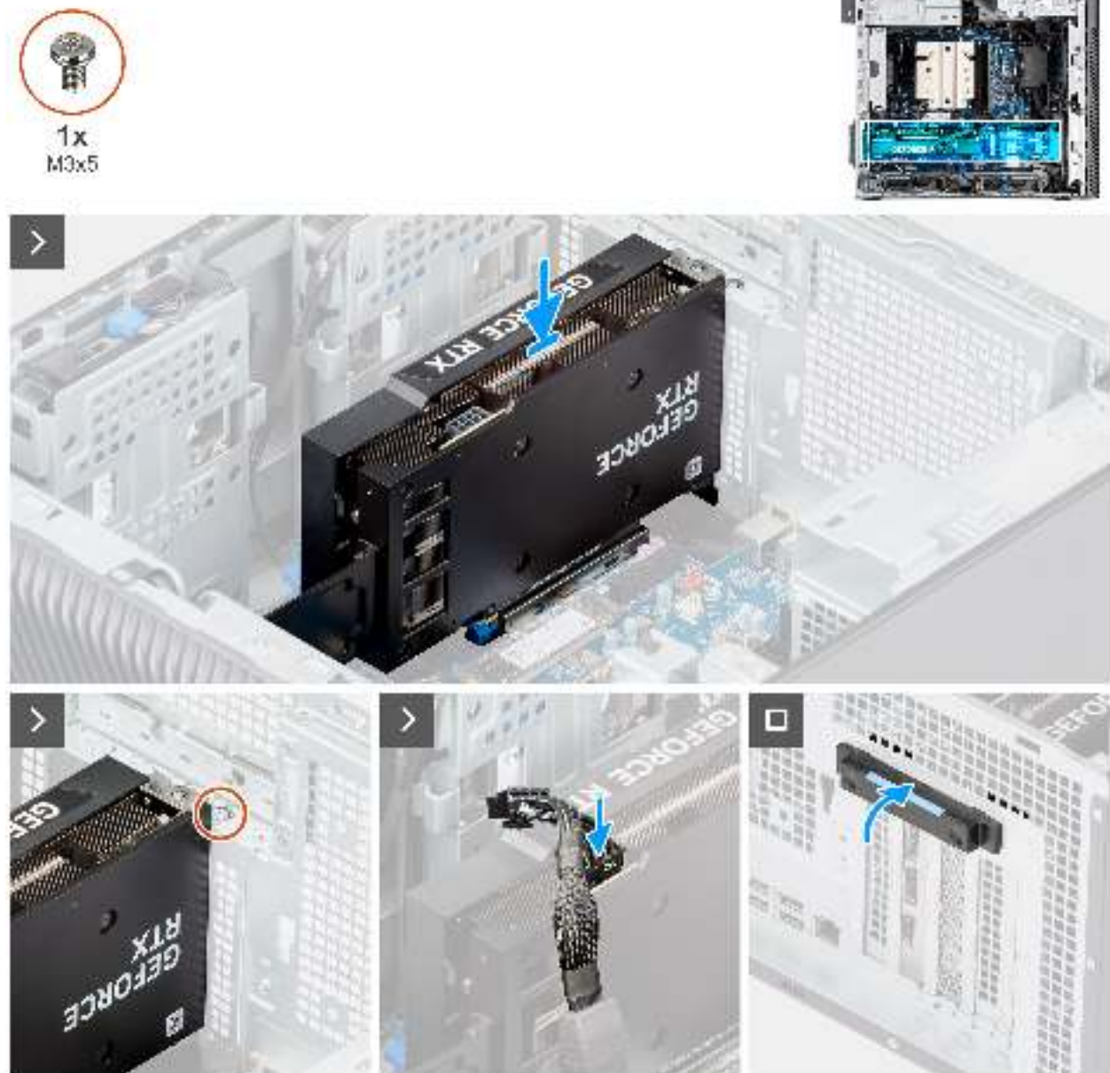
Abbildung 40. Einbauen der Grafikkarte mit Stromversorgung
