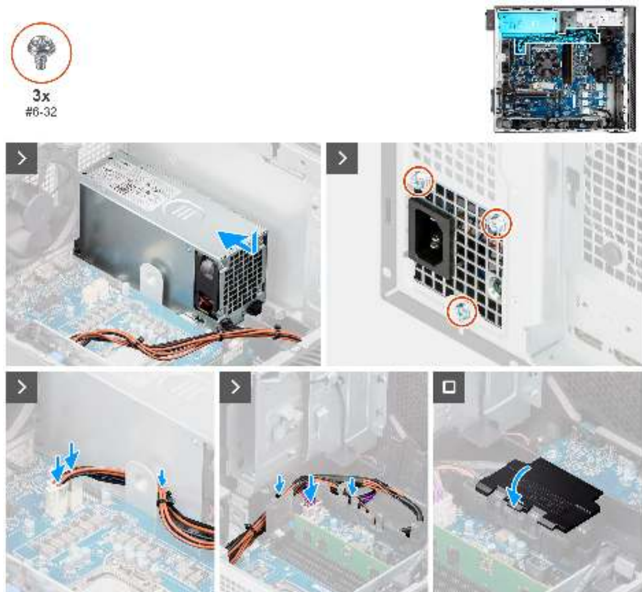
Abbildung 58. Installieren der 360-W-Stromversorgungseinheit
