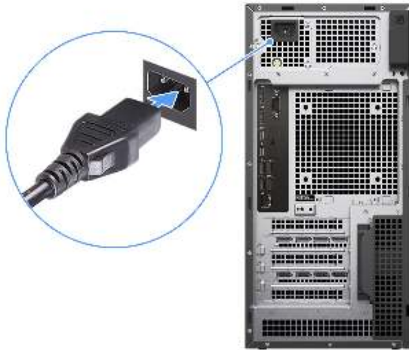
Abbildung 6. Anschließen des Stromkabels
