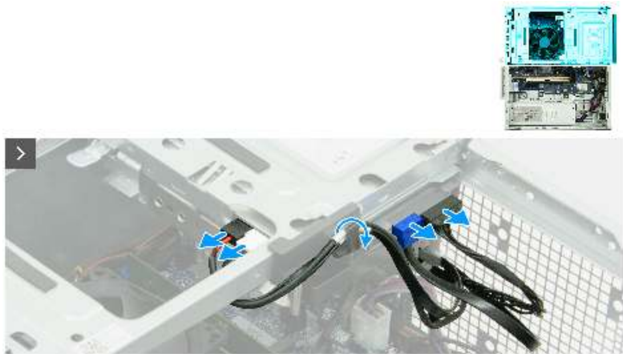
Abbildung 58. Entfernen des Laufwerksschachts
