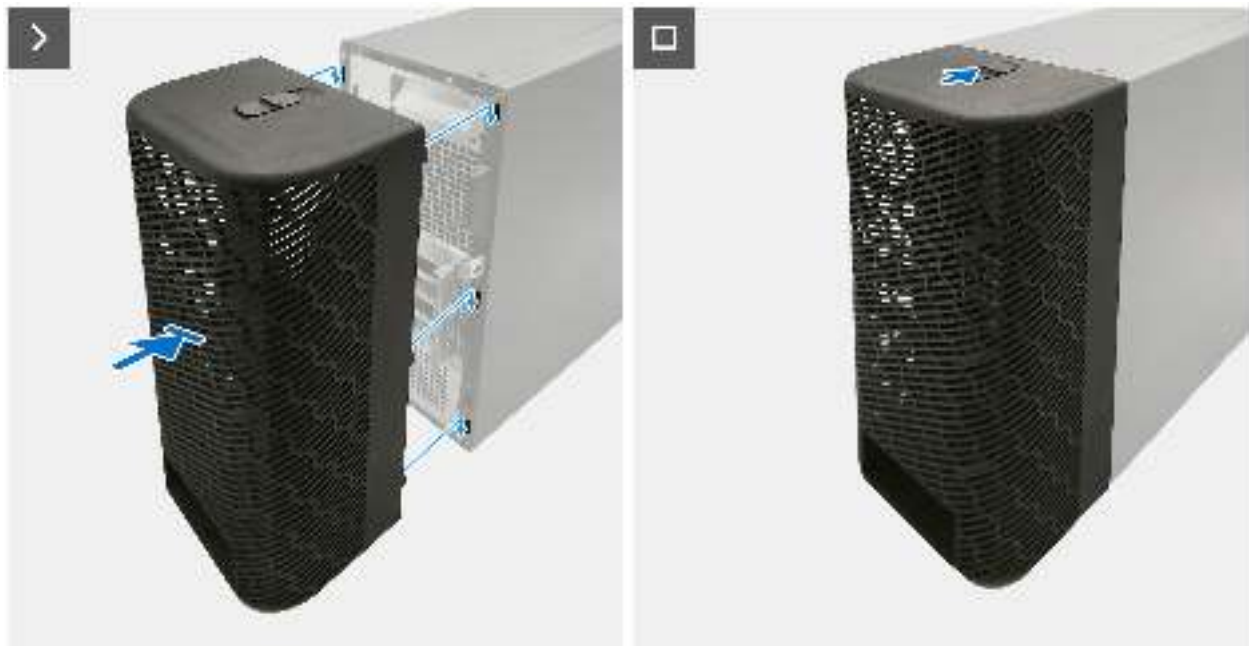
Abbildung 12. Anbringen der Kabelabdeckung
