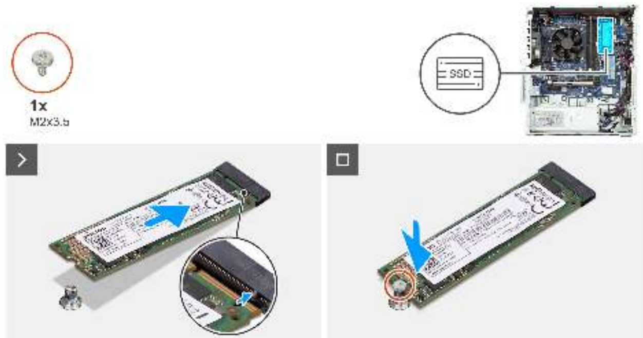
Abbildung 39. Installieren des M.2 2280-Solid-State-Laufwerks in Steckplatz 2
