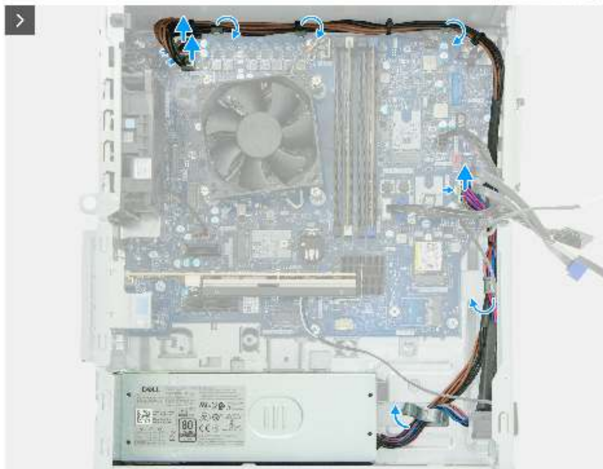
Abbildung 88. Entfernen der Stromversorgungseinheit
