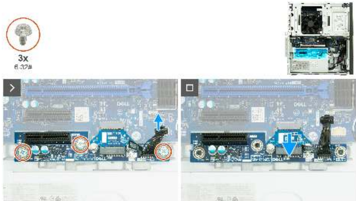
Abbildung 44. Entfernen der PCIe-Erweiterungsplatine
