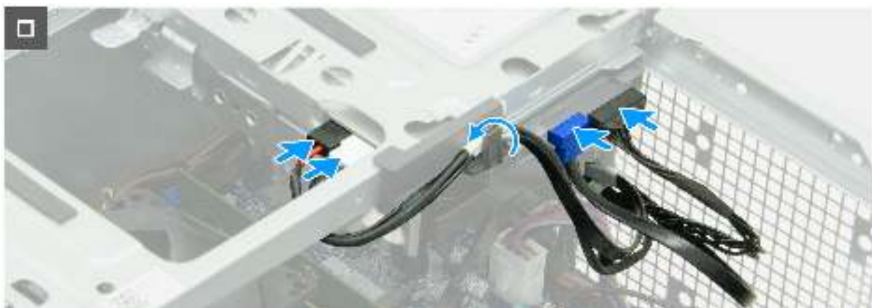
Abbildung 62. Einbauen des Laufwerkschachts
