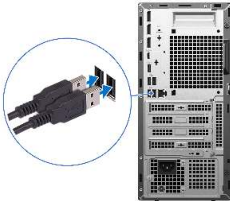
Abbildung 5. Anschließen der Tastatur und Maus
