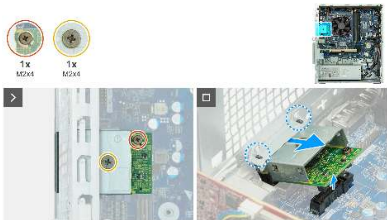
Abbildung 75. Entfernen des Moduls mit optionalem Anschluss
