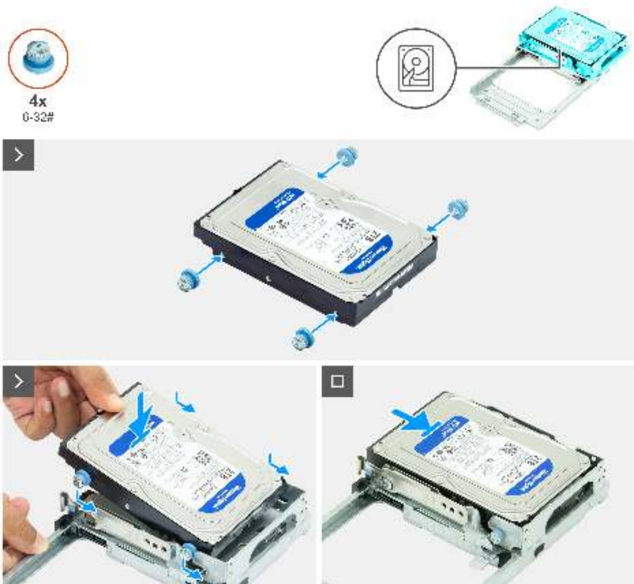
Abbildung 64. Einsetzen des Festplattenlaufwerks
