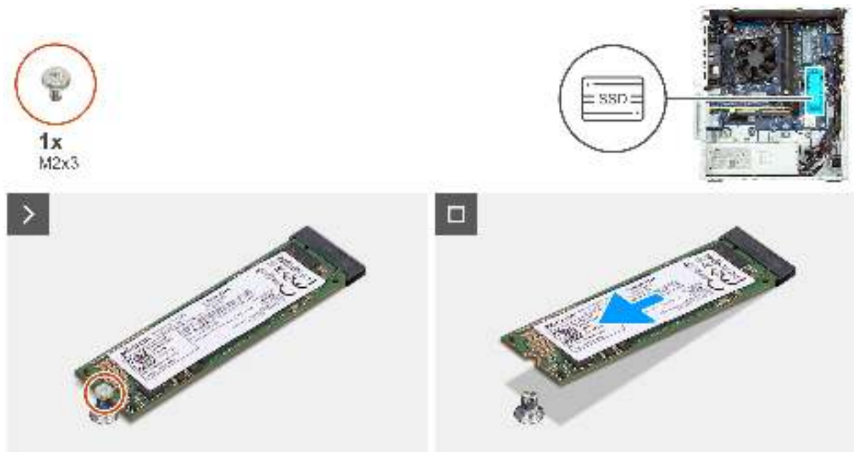
Abbildung 31. Entfernen des M.2 2280-Solid-State-Laufwerks aus Steckplatz 0
