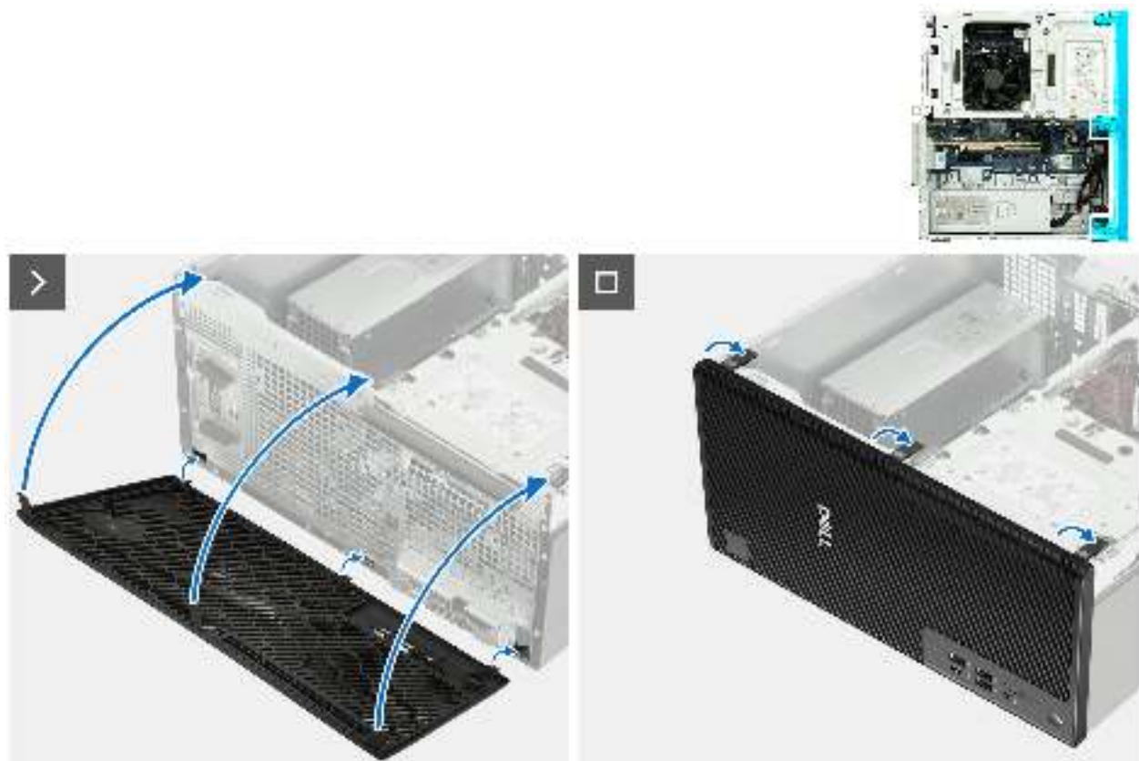
Abbildung 24. Installieren der vorderen Abdeckung
