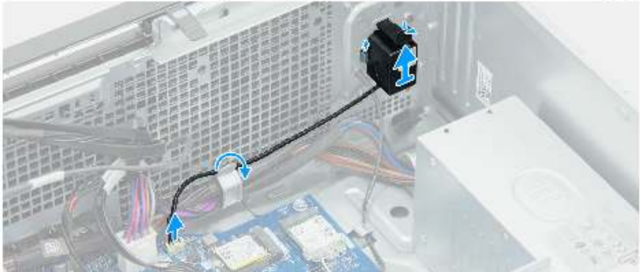
Abbildung 25. Entfernen des internen Lautsprechers
