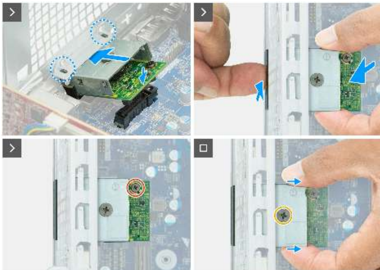
Abbildung 77. Installieren des optionalen Portmoduls
