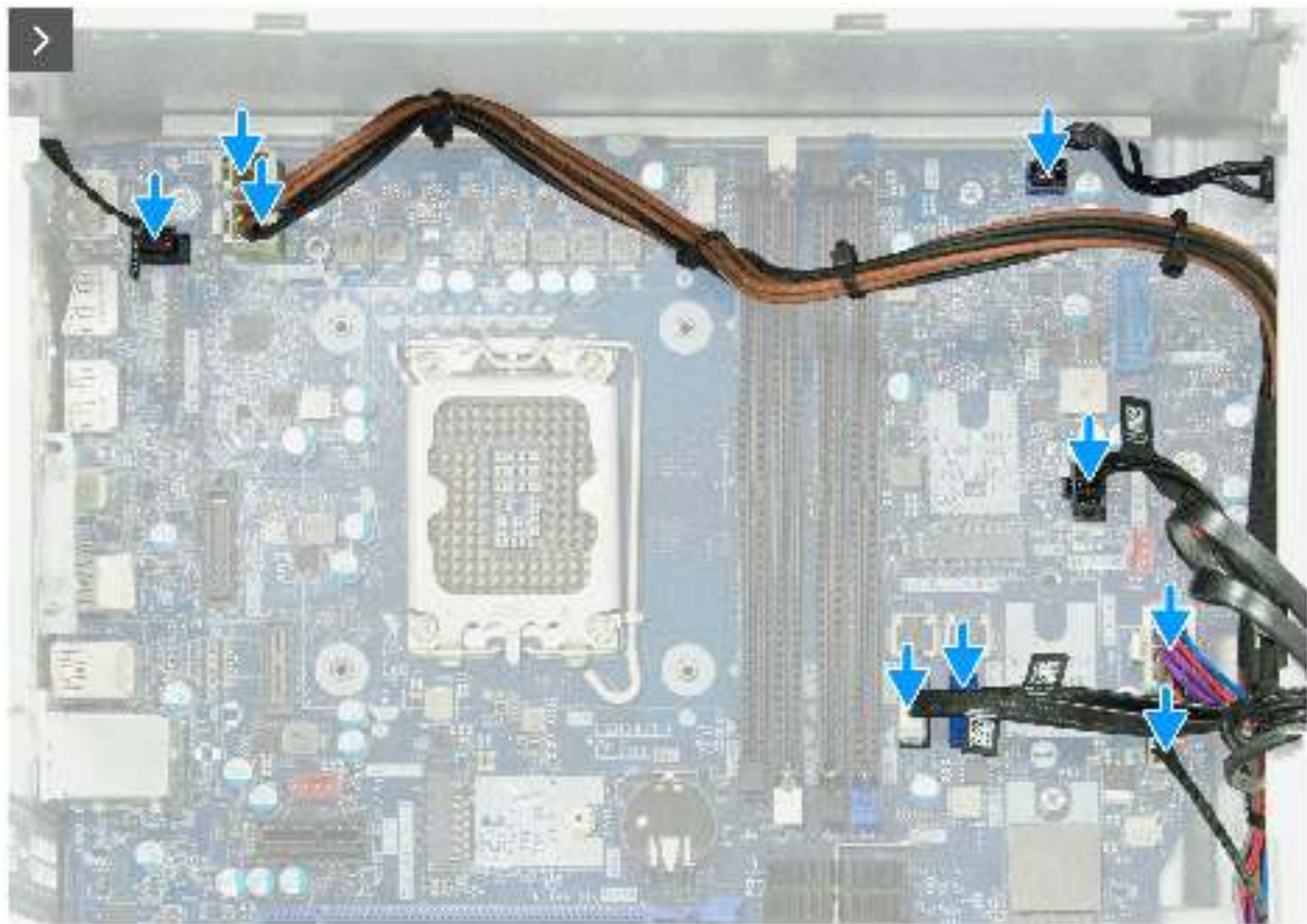
Abbildung 104. Einbauen der Systemplatine
