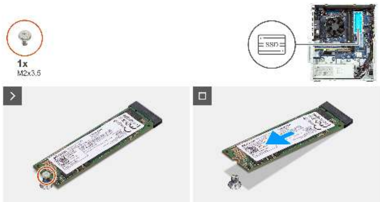
Abbildung 38. Entfernen des M.2 2280-SSD-Laufwerks aus Steckplatz 2
