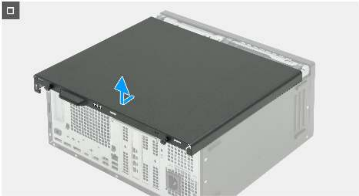
Abbildung 14. Entfernen der linken Abdeckung
