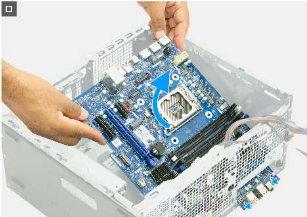
Abbildung 100. Entfernen der Systemplatine
