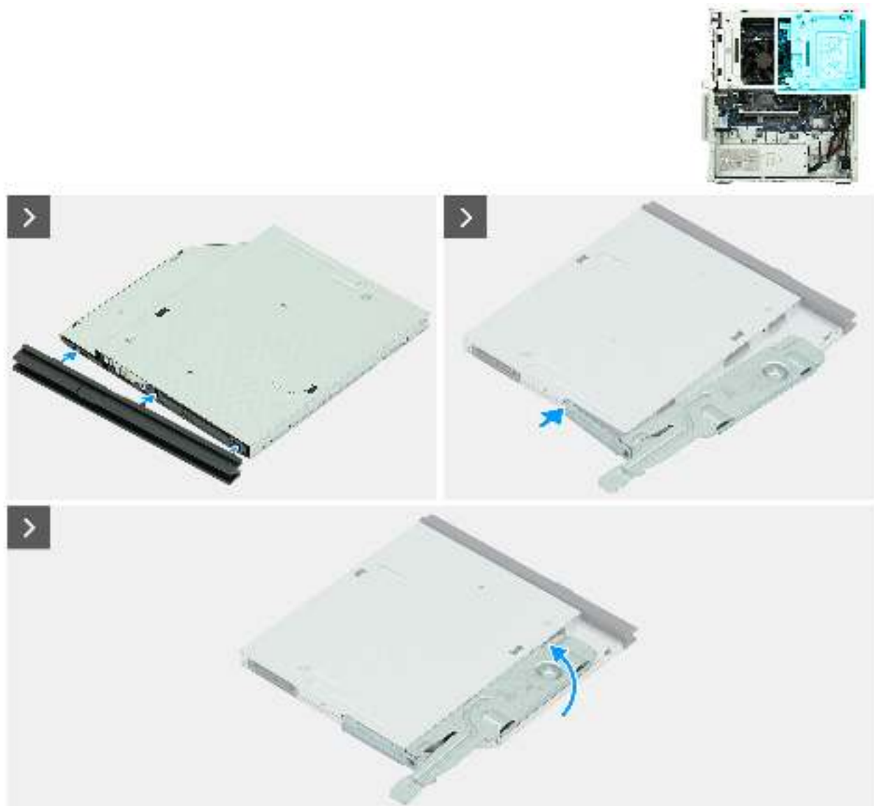
Abbildung 56. Installieren des optischen Laufwerks
