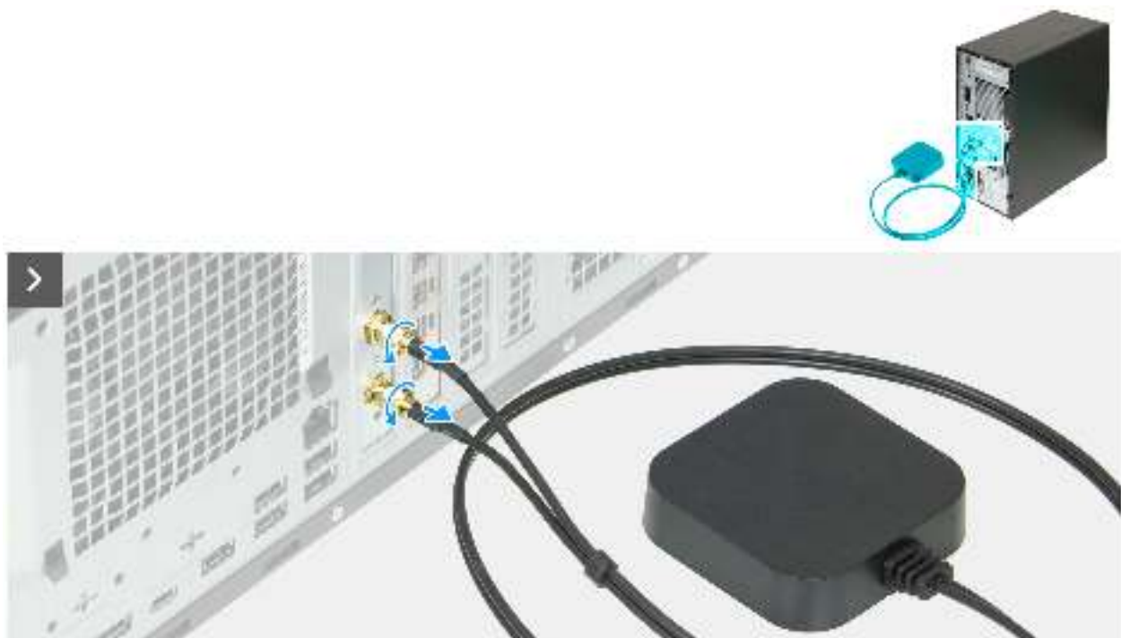
Abbildung 50. Entfernen der Puck-Antennen-Erweiterungskarte
