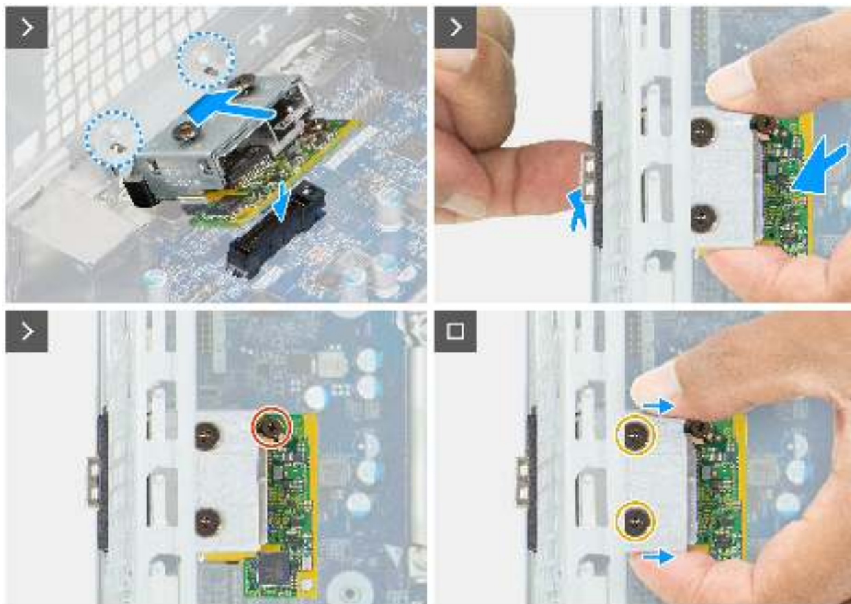
Abbildung 80. Installieren des Fiberoptik-Port-Moduls
