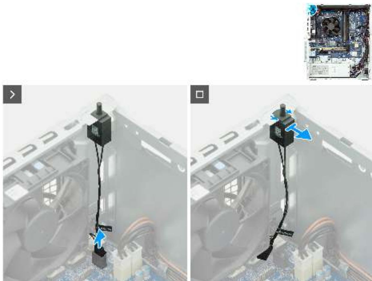
Abbildung 65. Entfernen des Eingriffsschalters
