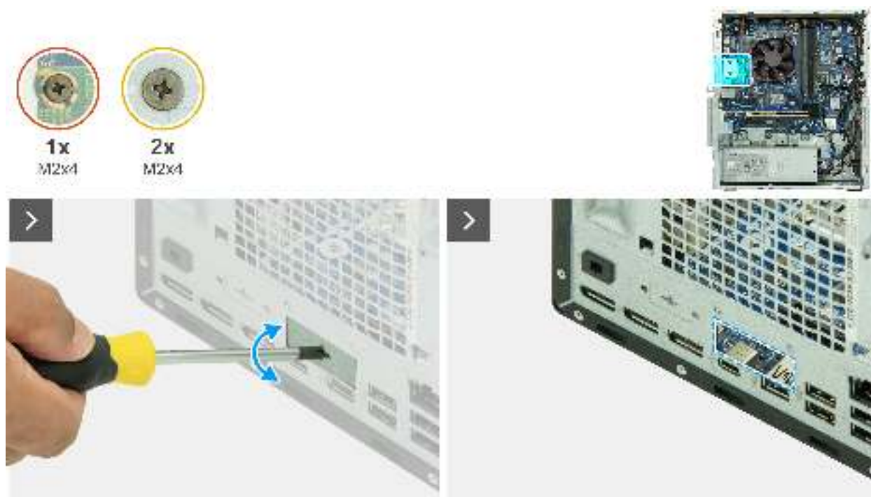
Abbildung 79. Installieren des Fiberoptik-Port-Moduls
