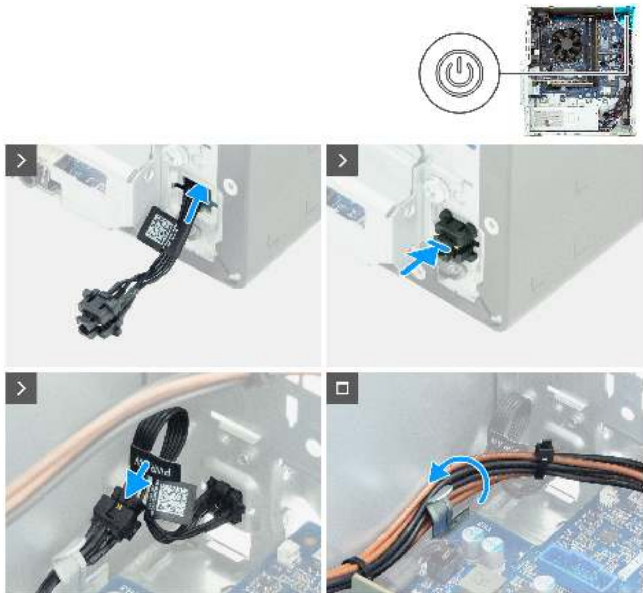
Abbildung 74. Installieren des Netzschalters
