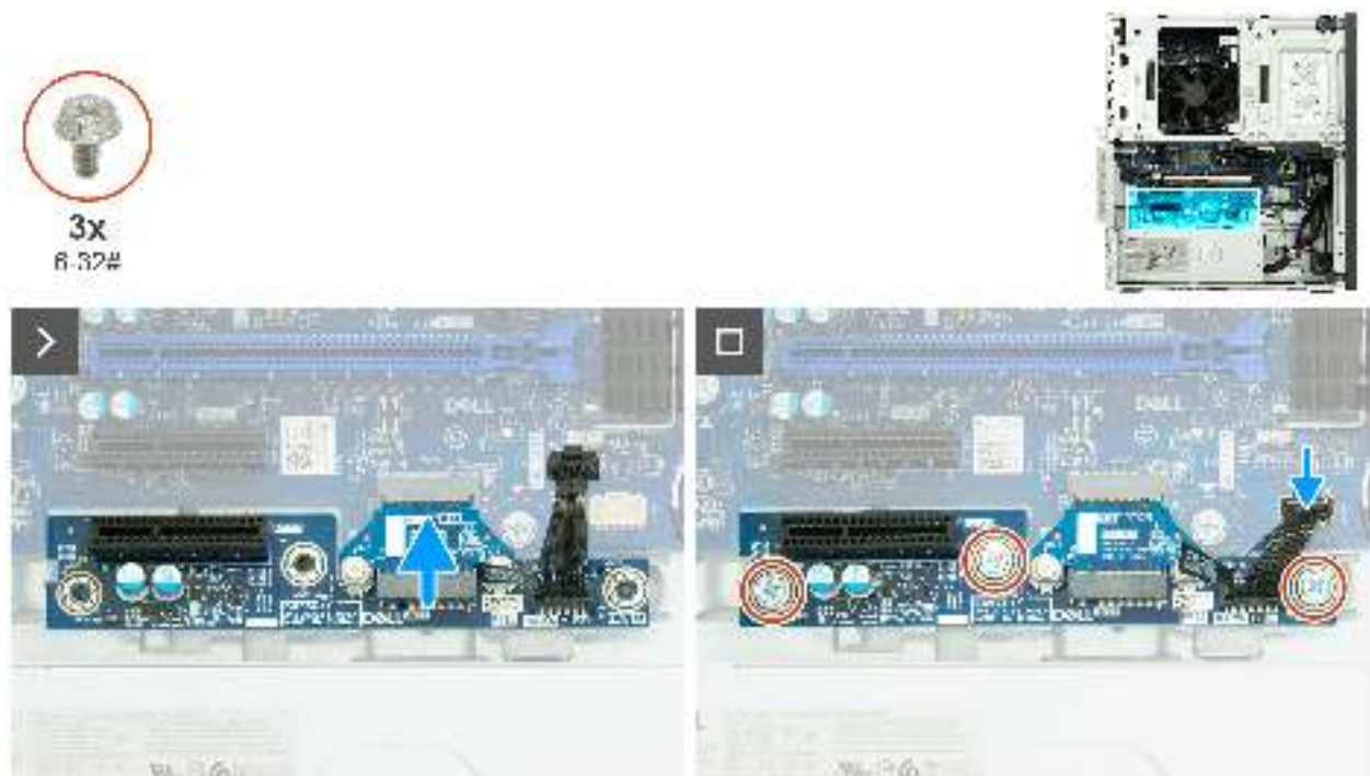
Abbildung 45. Einbauen der PCIe-Erweiterungsplatine
