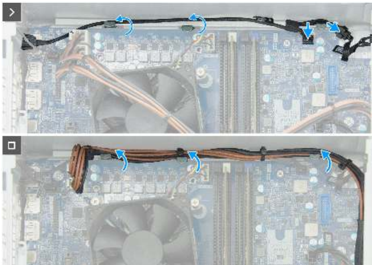
Abbildung 72. Installieren des Kabels des Remote-Netzschalters
