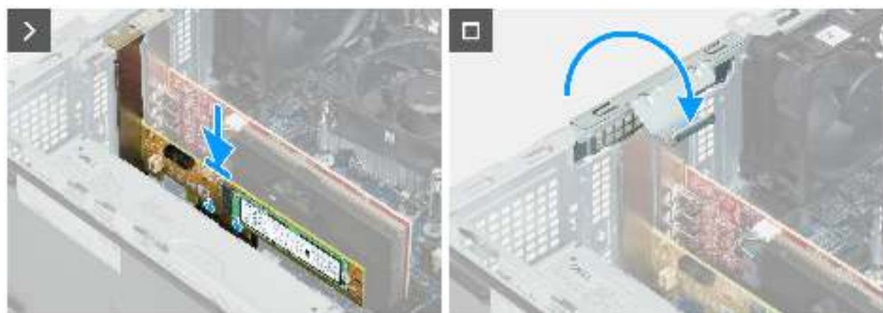
Abbildung 49. Installieren der Halterung der Solid-State-Laufwerk-Erweiterungskarte
