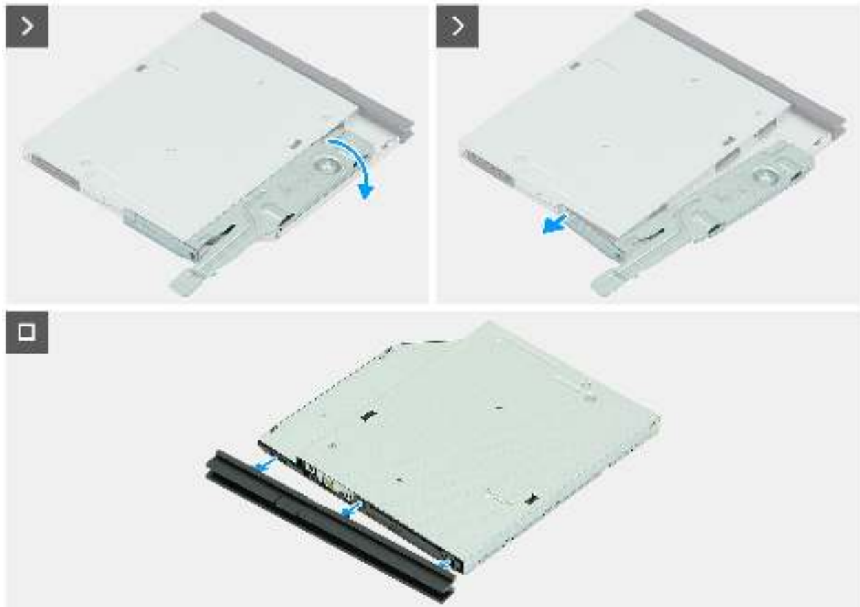
Abbildung 55. Entfernen des optischen Laufwerks
