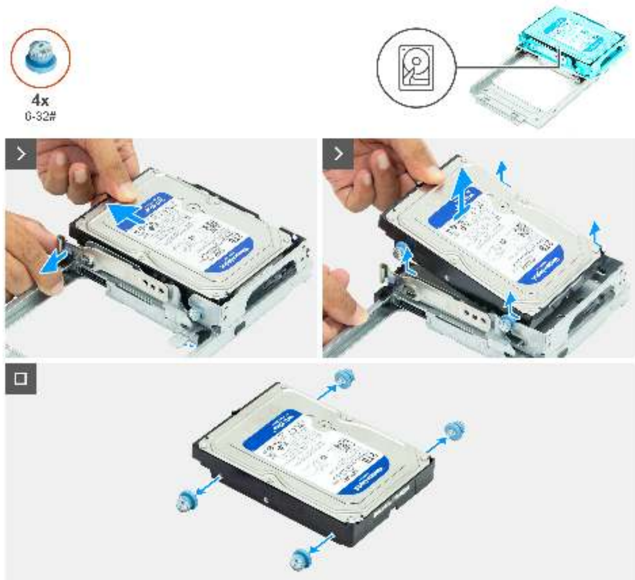
Abbildung 63. Entfernen der Festplatte
