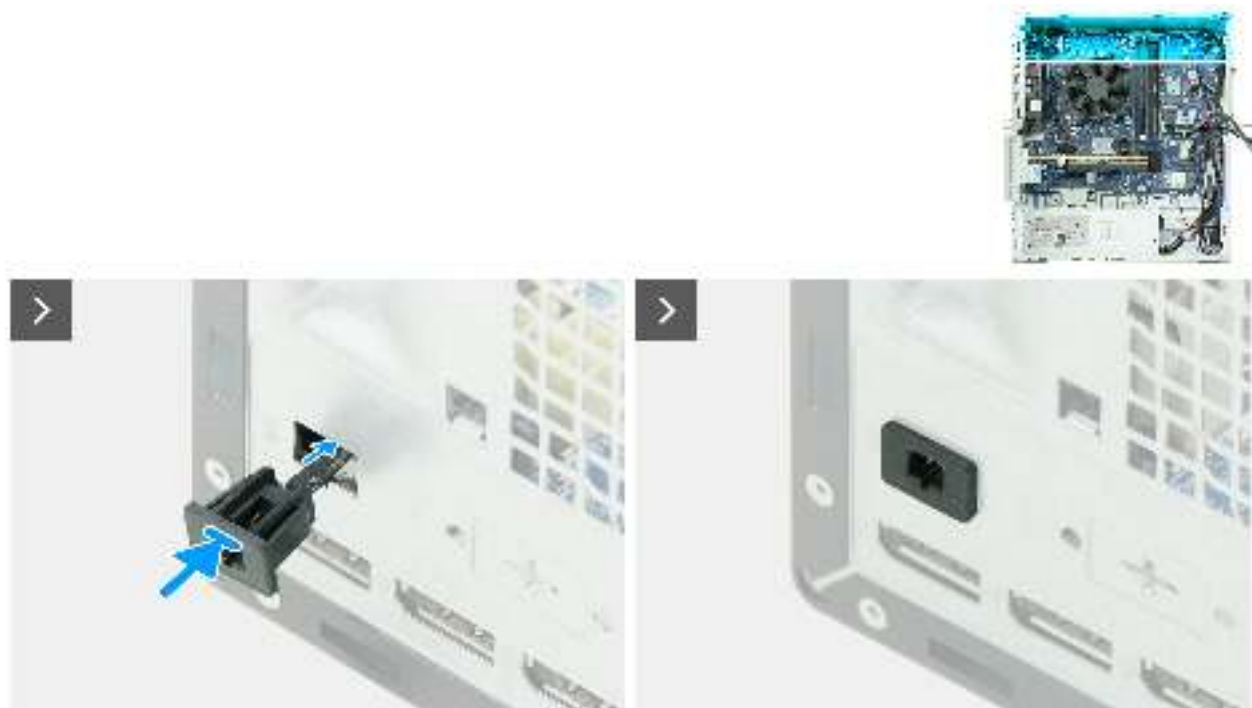
Abbildung 71. Installieren des Kabels des Remote-Netzschalters
