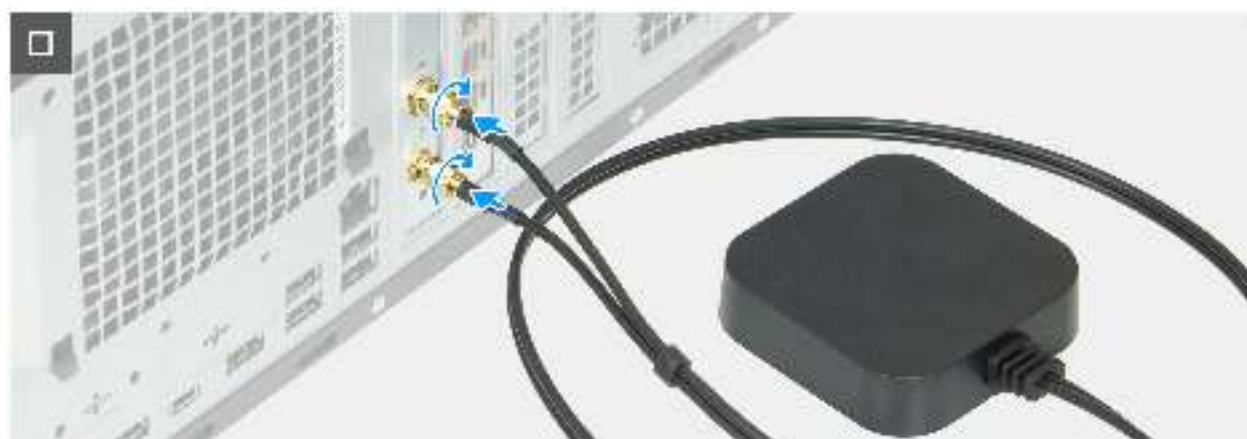
Abbildung 53. Installieren der Puck-Antennen-Erweiterungskarte
