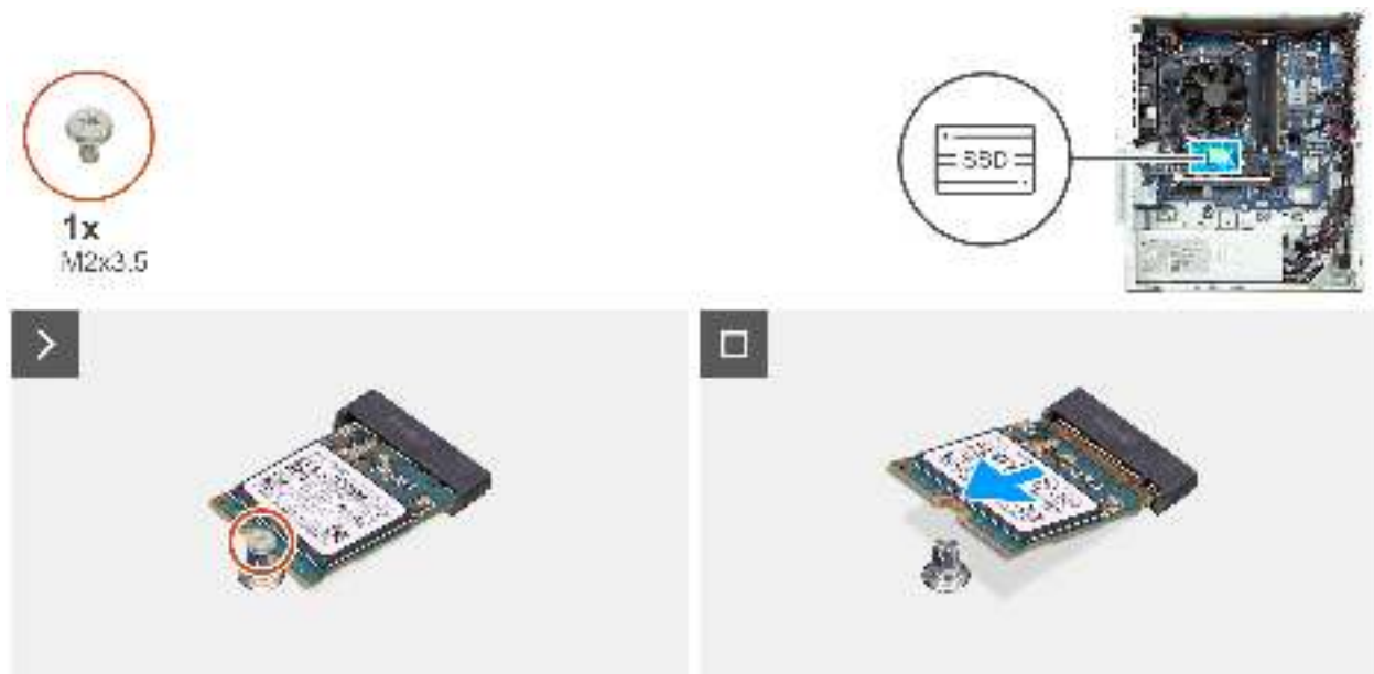
Abbildung 34. Entfernen des M.2 2230-SSD-Laufwerks aus Steckplatz 1
