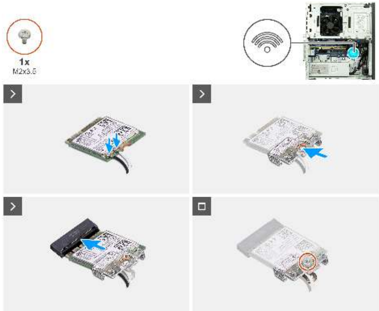
Abbildung 43. Installieren der Wireless-Karte
