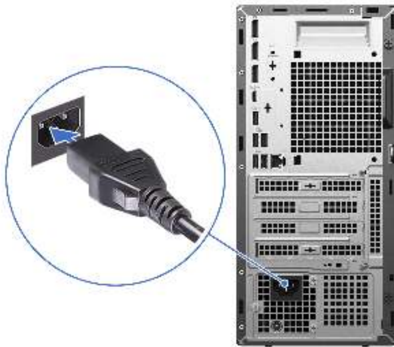
Abbildung 8. Anschließen des Stromkabels
