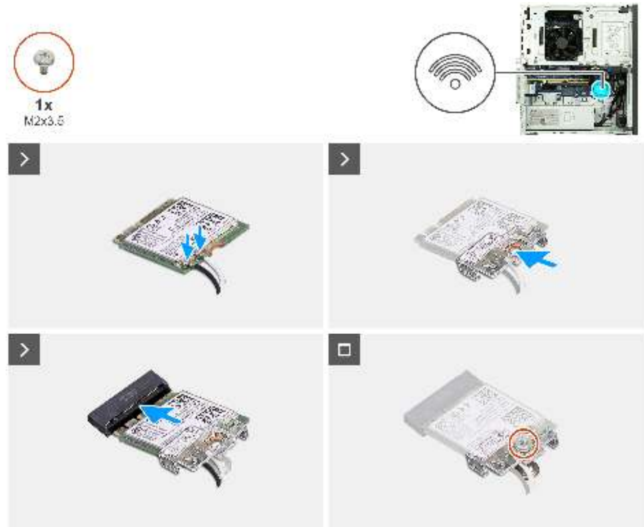
Abbildung 43. Installieren der Wireless-Karte
