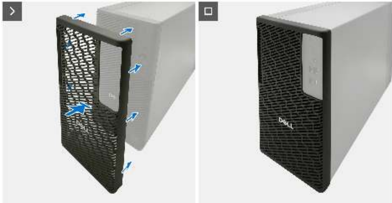
Abbildung 22. Installieren des Staubfilters
