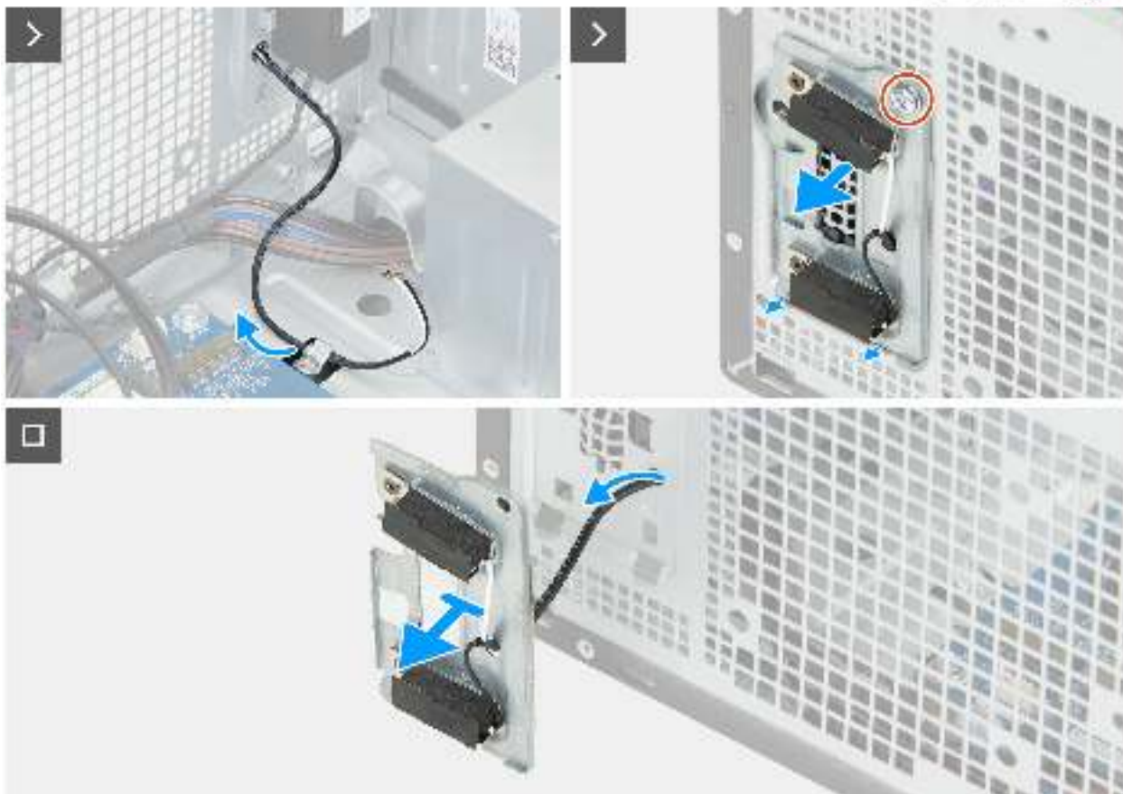
Abbildung 86. Entfernen der Antennenmodule
