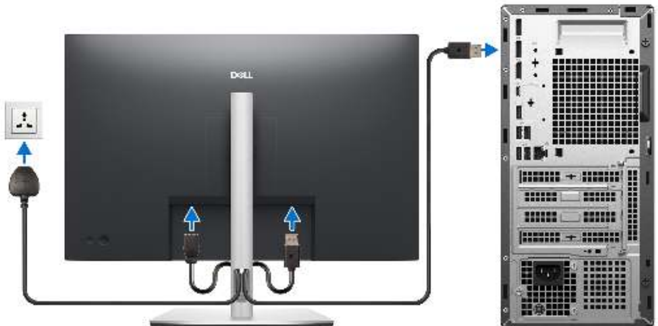
Abbildung 7. Anschließen des Displays
