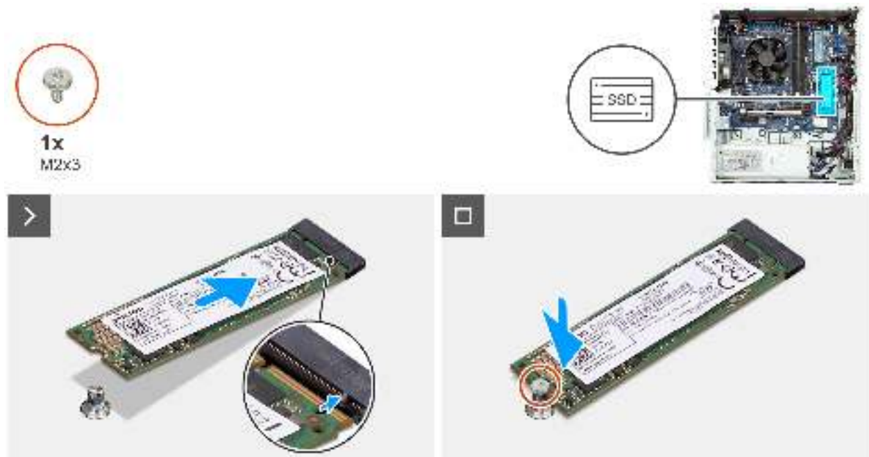
Abbildung 32. Installieren des M.2 2280-Solid-State-Laufwerks in Steckplatz 0
