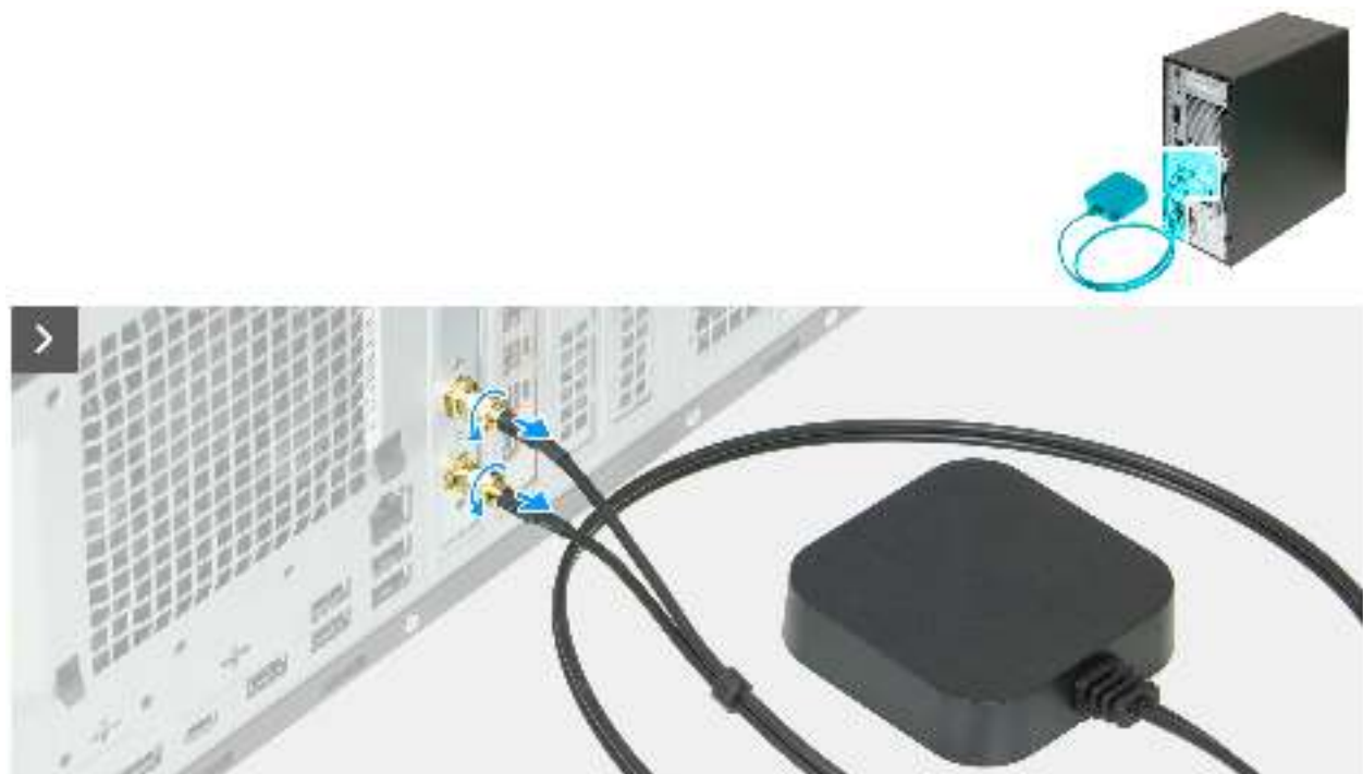
Abbildung 50. Entfernen der Puck-Antennen-Erweiterungskarte
