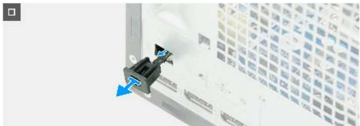
Abbildung 70. Entfernen des Kabels des Remote-Netzschalters
