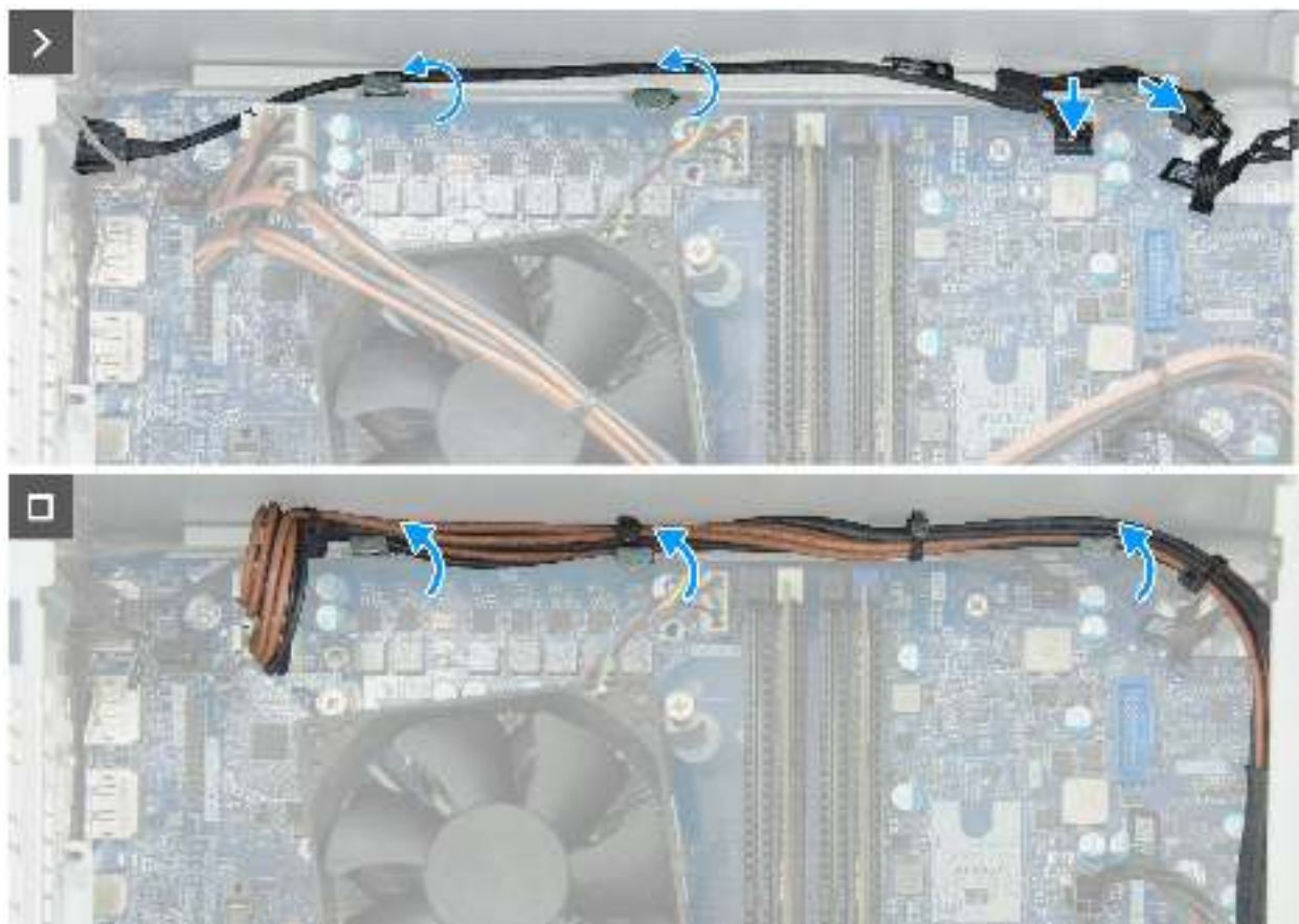
Abbildung 72. Installieren des Kabels des Remote-Netzschalters
