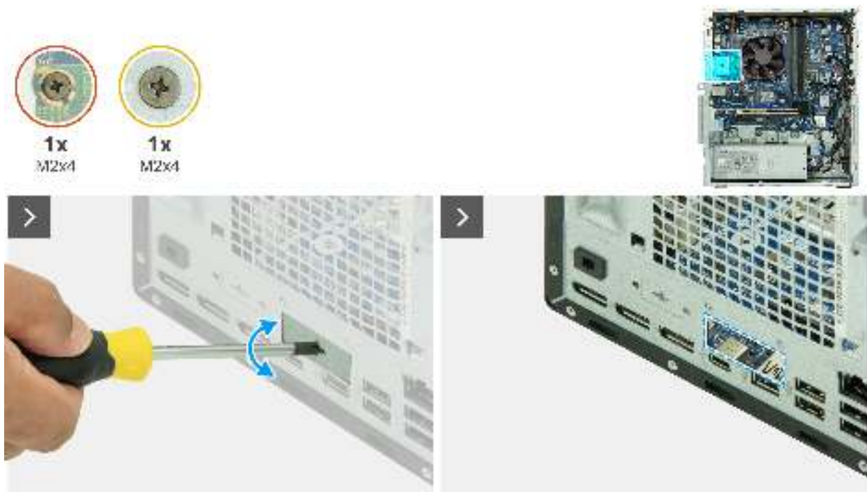
Abbildung 76. Installieren des optionalen Portmoduls
