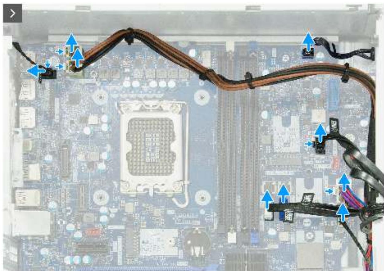
Abbildung 98. Entfernen der Systemplatine
