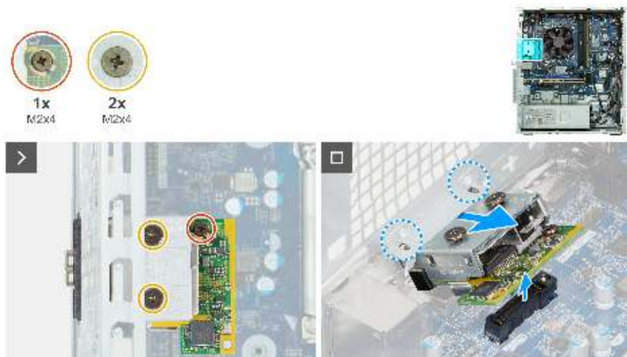
Abbildung 78. Entfernen des Faseroptik-Portmoduls
