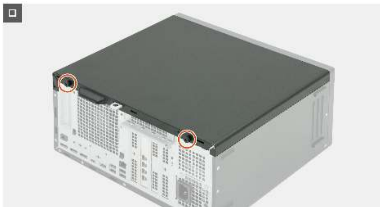
Abbildung 16. Installieren der linken Abdeckung
