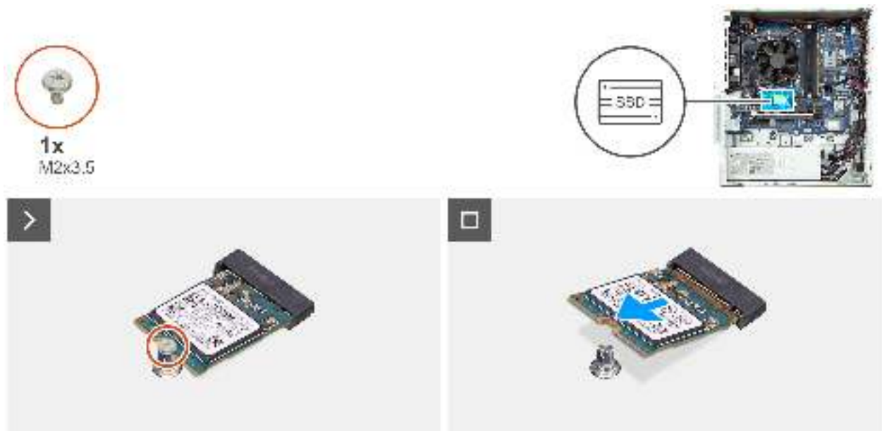
Abbildung 34. Entfernen des M.2 2230-SSD-Laufwerks aus Steckplatz 1
