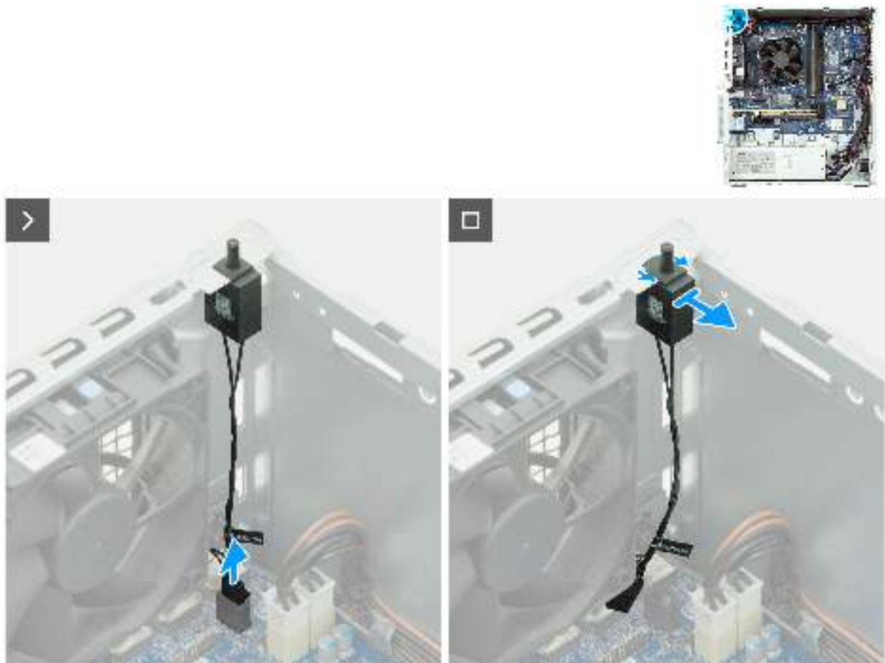
Abbildung 65. Entfernen des Eingriffsschalters
