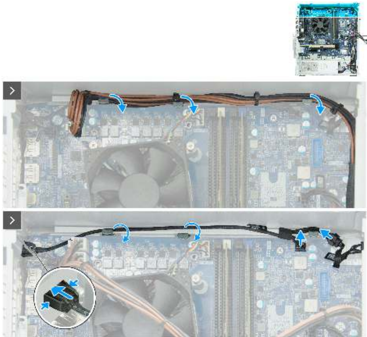
Abbildung 69. Entfernen des Kabels des Remote-Netzschalters
