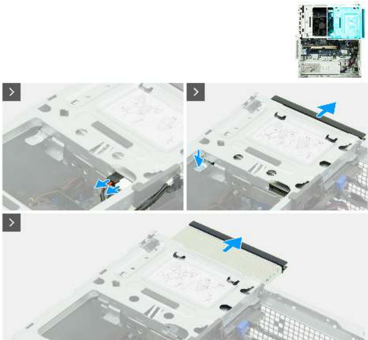
Abbildung 54. Entfernen des optischen Laufwerks
