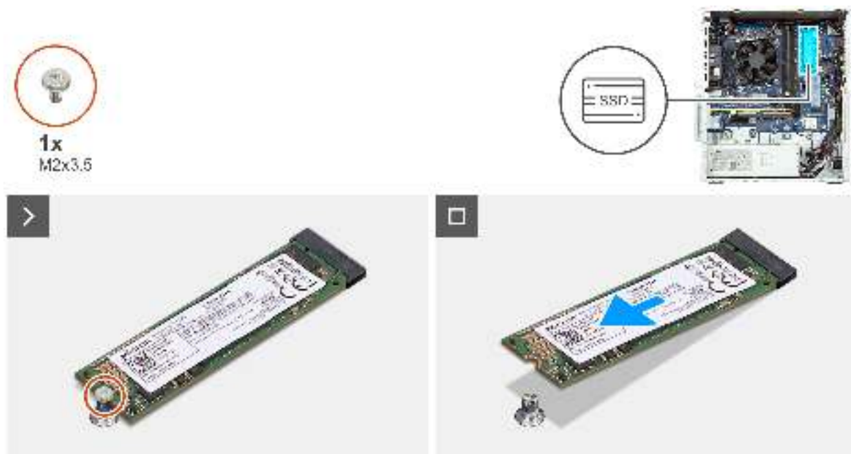
Abbildung 38. Entfernen des M.2 2280-SSD-Laufwerks aus Steckplatz 2
