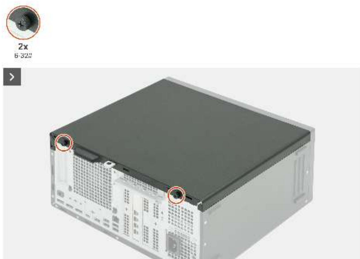
Abbildung 13. Entfernen der linken Abdeckung
