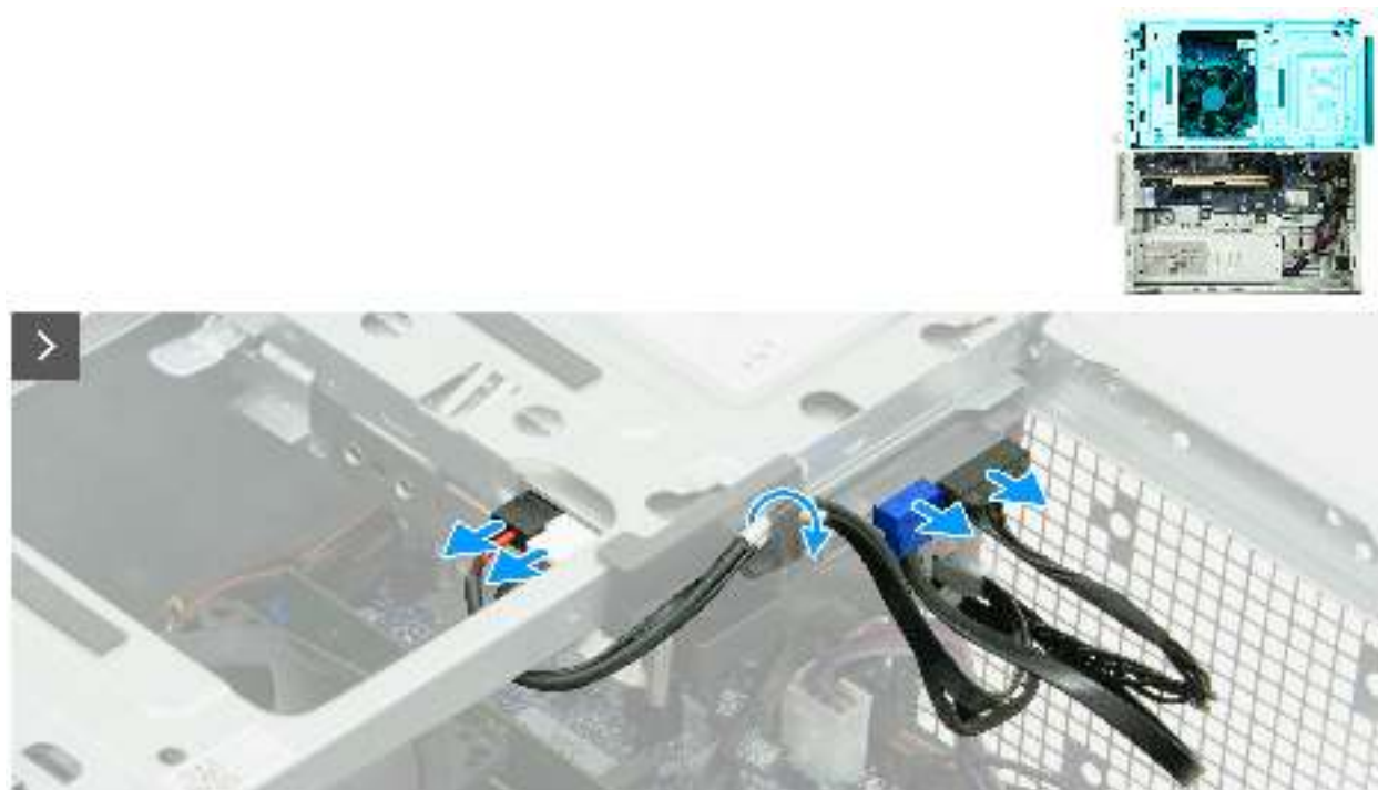
Abbildung 58. Entfernen des Laufwerksschachts
