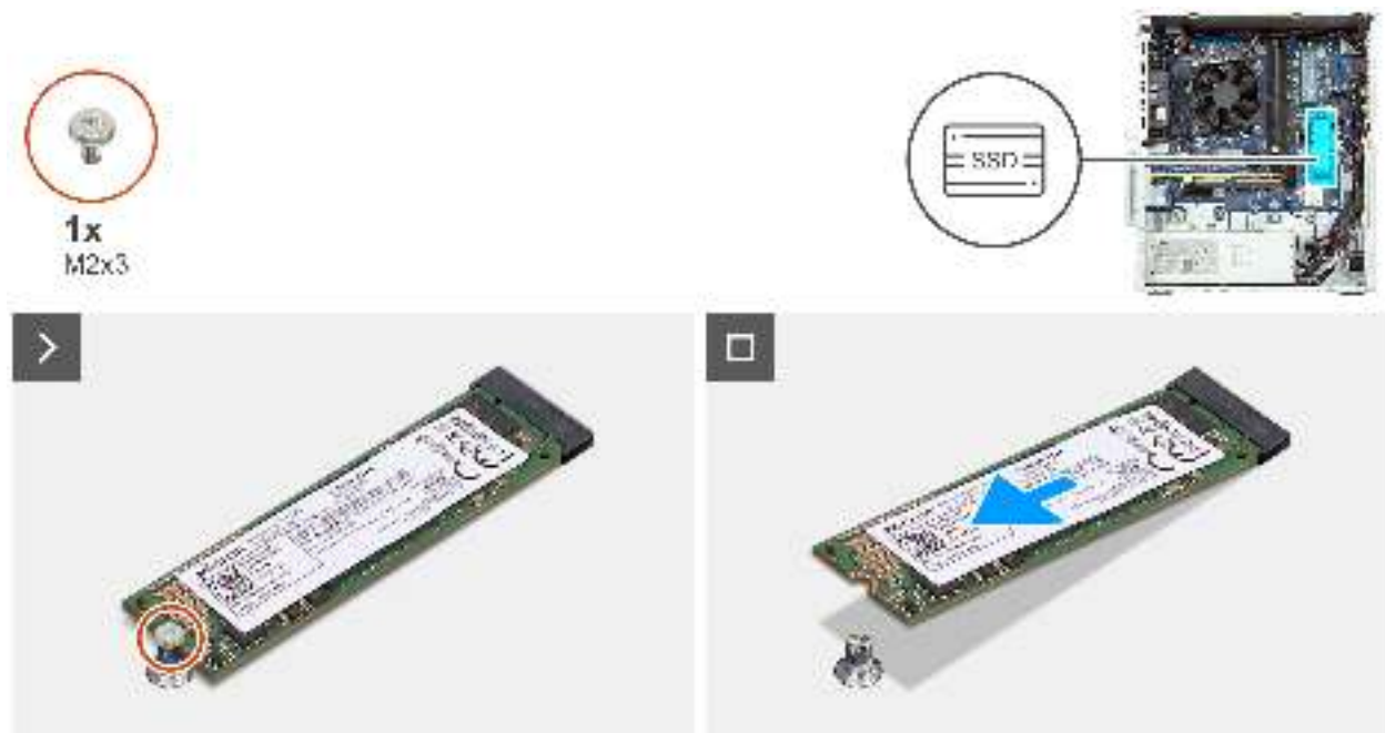
Abbildung 31. Entfernen des M.2 2280-Solid-State-Laufwerks aus Steckplatz 0
