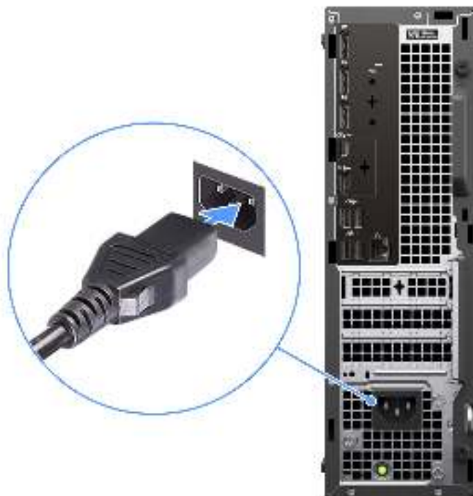
Abbildung 6. Anschließen des Stromkabels
