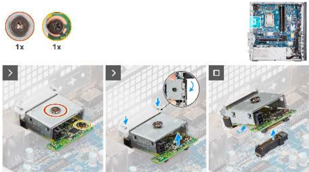
Abbildung 67. Entfernen des optionalen Thunderbolt-Moduls
