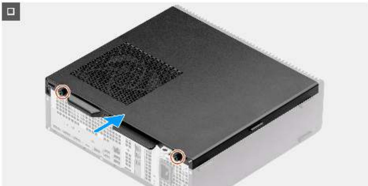
Abbildung 12. Anbringen der Seitenabdeckung
