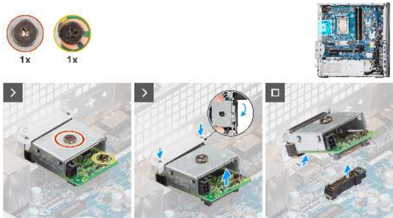
Abbildung 64. Entfernen des optionalen USB-Moduls
