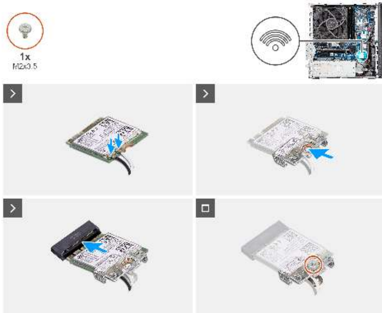
Abbildung 42. Installieren der Wireless-Karte
