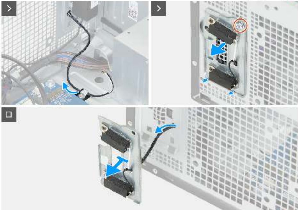
Abbildung 86. Entfernen der Antennenmodule
