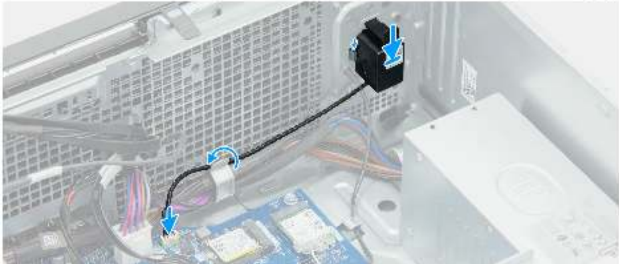
Abbildung 26. Einbauen des internen Lautsprechers
