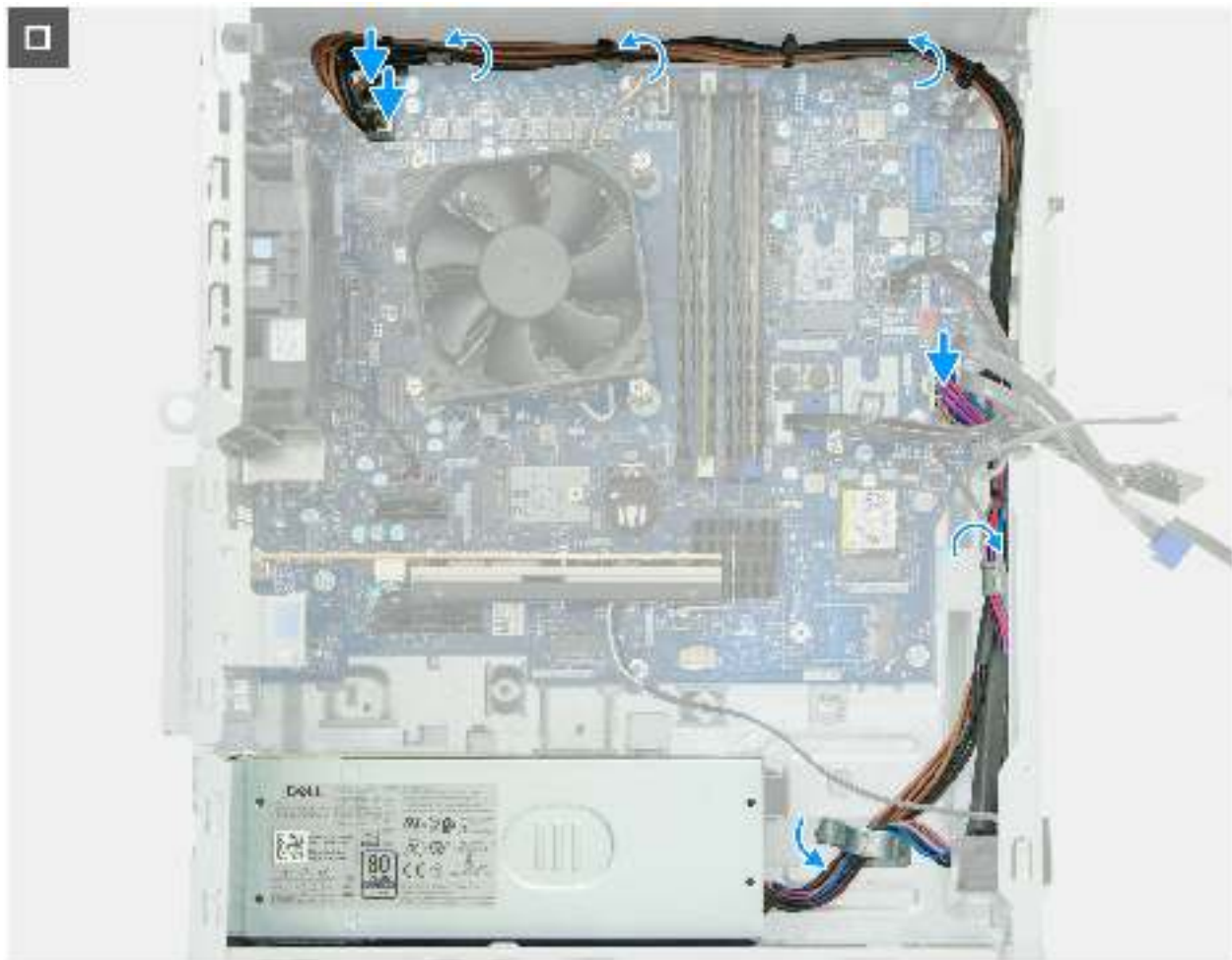
Abbildung 91. Installieren der Stromversorgungseinheit
