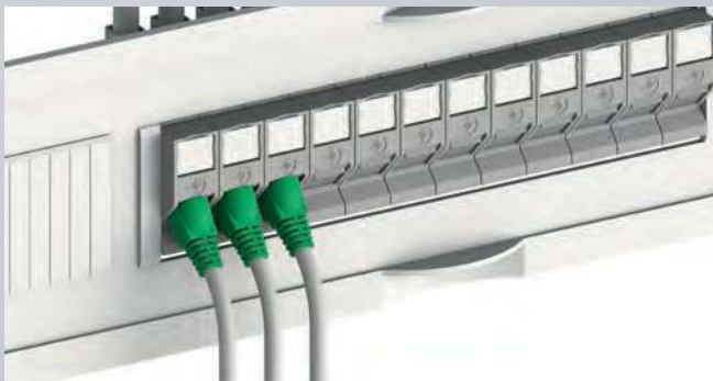
Höhe des TS45 und des Elektroverteilers sind optimal aufeinander abgestimmt: Das AMJ-S Modul ist so eingebaut, dass der Entriegelungshebel des Patchkabels von oben bedienbar ist.
