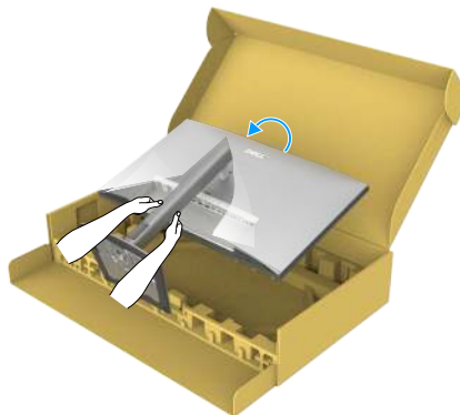
Abbildung 21. Halten Sie den Ständer und heben Sie den Monitor an.
