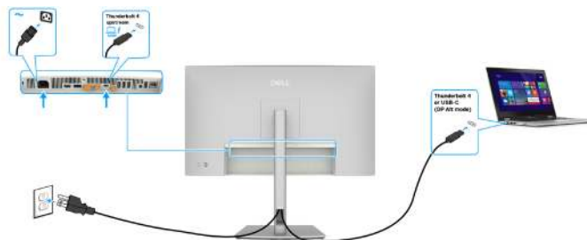
Abbildung 40. Thunderbolt 4-Kabel anschließen
