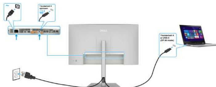
Abbildung 33. Thunderbolt 4-Kabel anschließen
