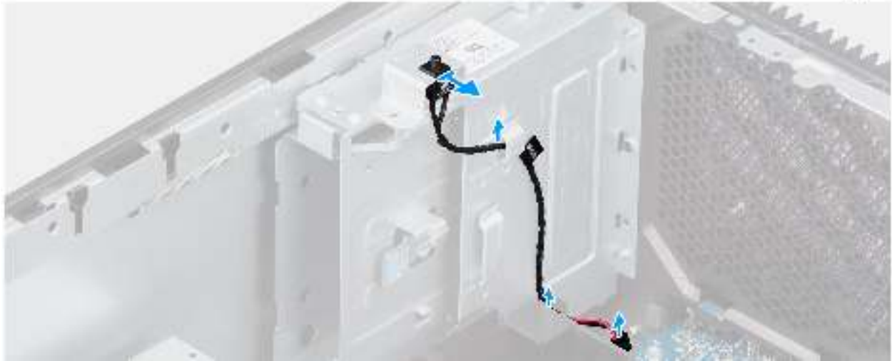
Abbildung 43. Entfernen des Eingriffsschalters
