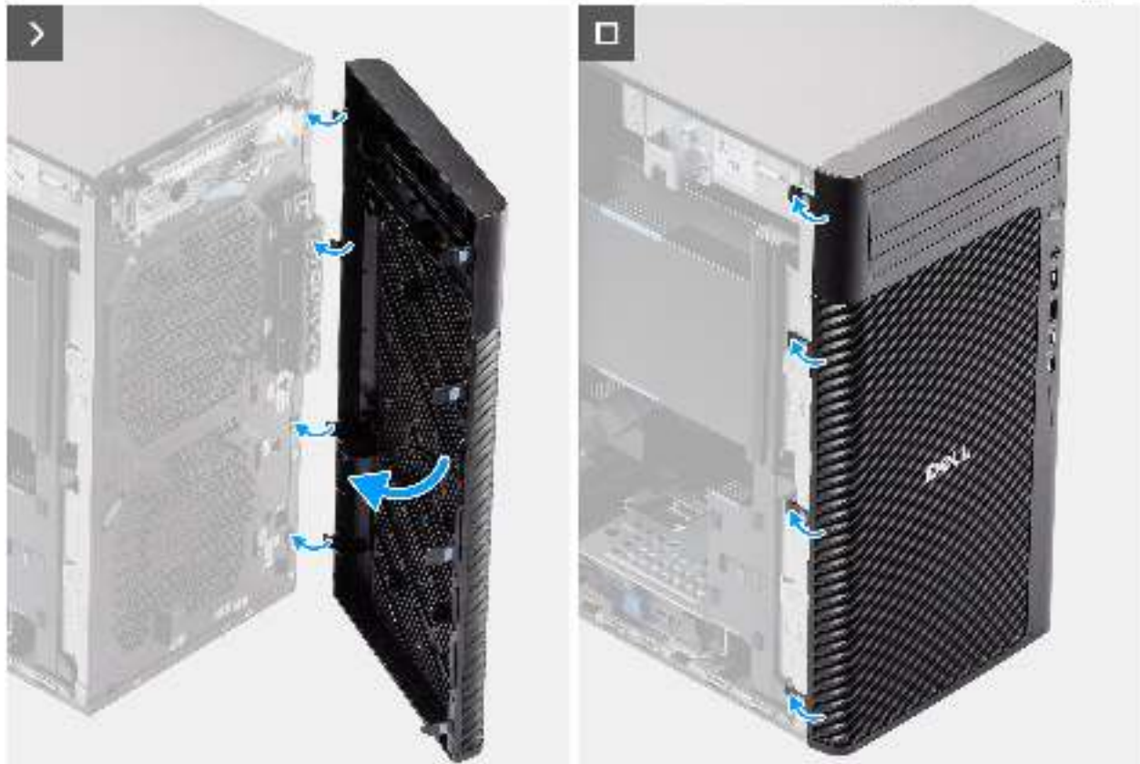
Abbildung 18. Installieren der Frontverkleidung
