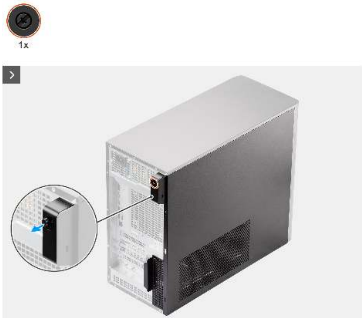
Abbildung 9. Entfernen der Seitenabdeckung
