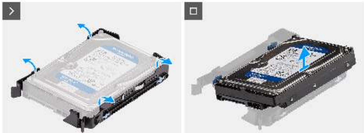
Abbildung 27. Entfernen der 3,5-Zoll-Festplattenlaufwerkhalterung
