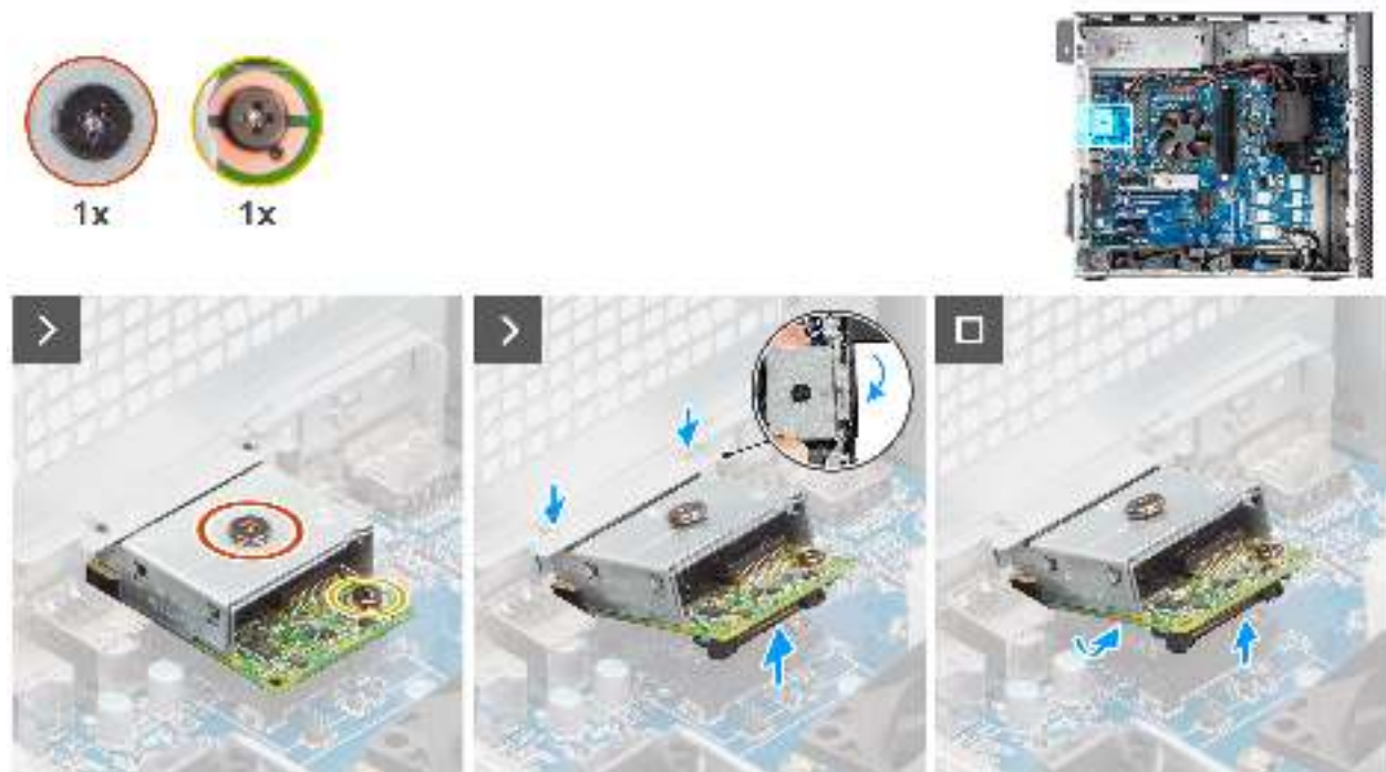
Abbildung 76. Entfernen des optionalen LAN-Moduls
