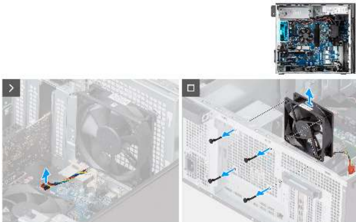
Abbildung 49. Entfernen des hinteren Lüfters bei Systemen mit 360-W-Netzteilen
