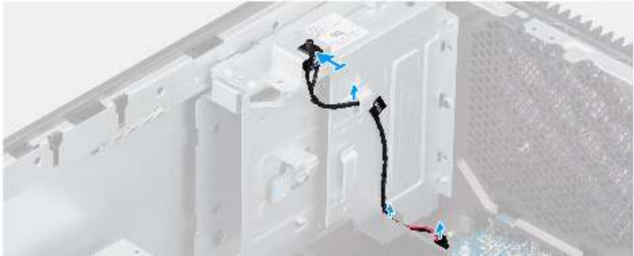
Abbildung 44. Installieren des Eingriffsschalters
