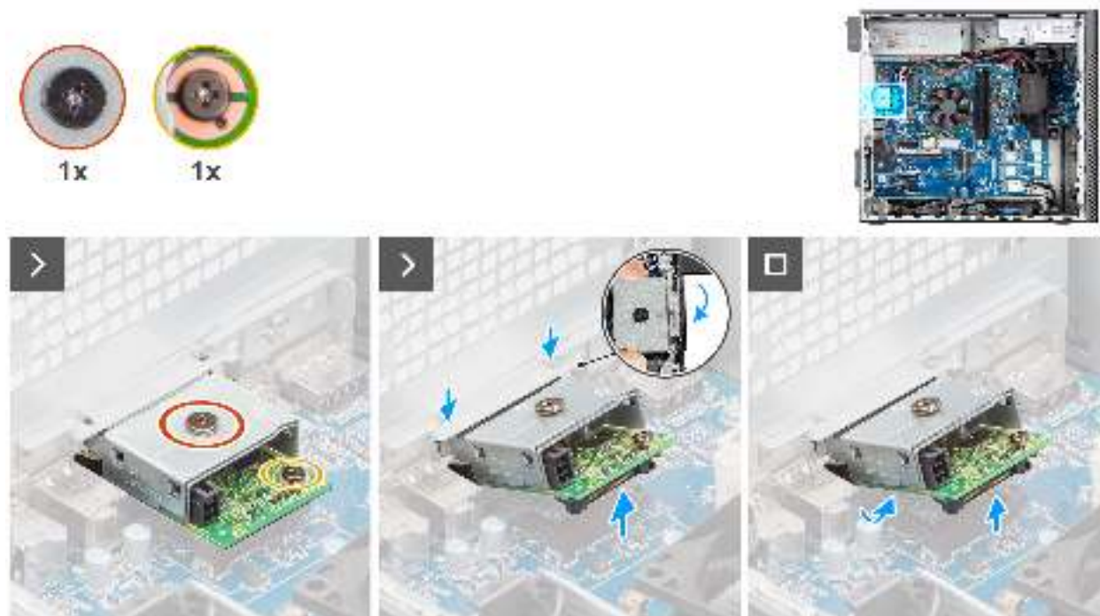
Abbildung 82. Entfernen des optionalen USB-Moduls
