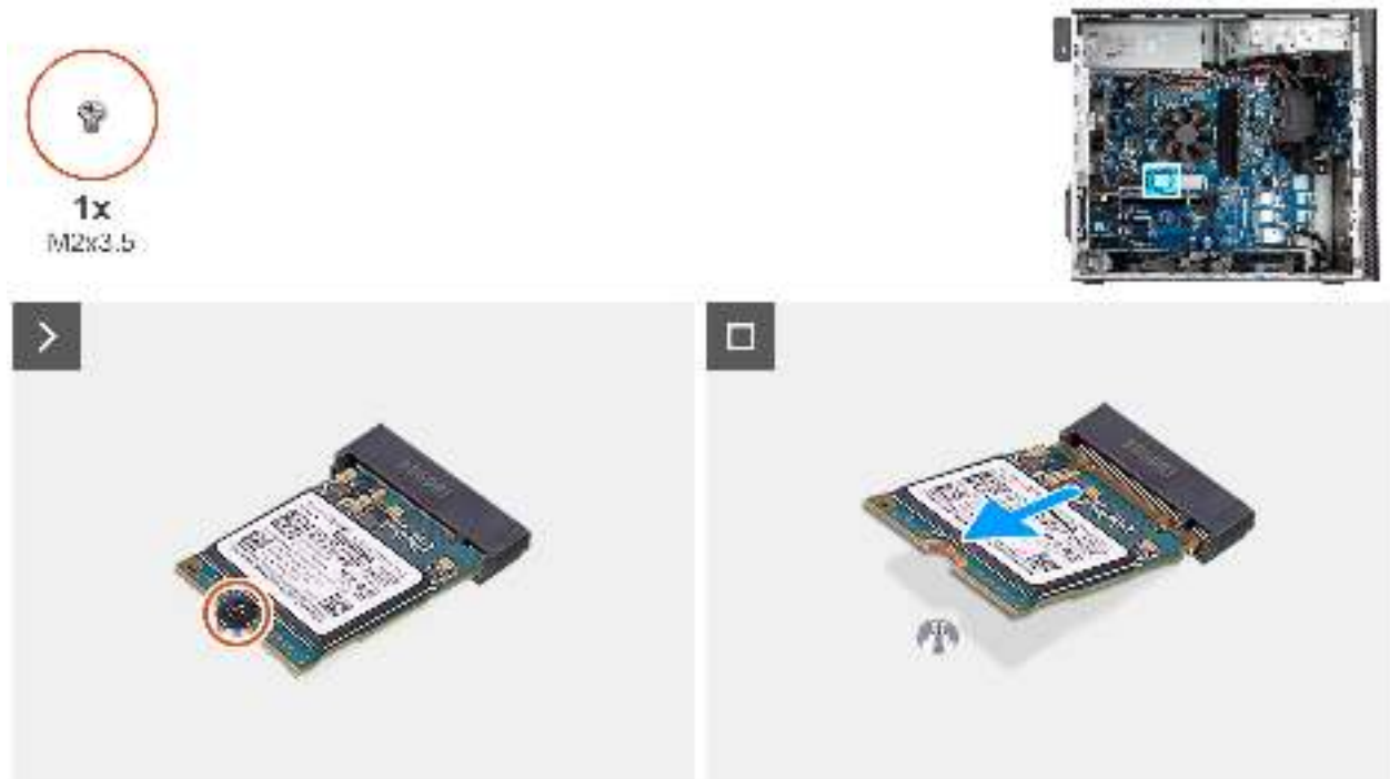
Abbildung 31. Entfernen des M.2 2230-PCIe-SSD-Laufwerks
