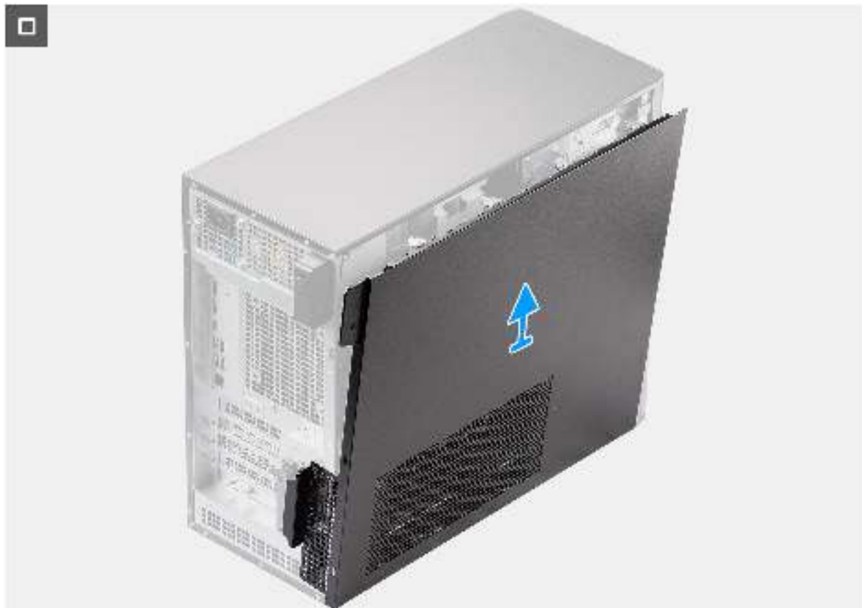
Abbildung 10. Entfernen der Seitenabdeckung
