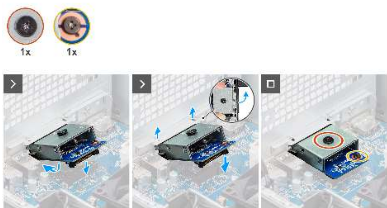
Abbildung 72. Installieren des optionalen HDMI-Moduls
