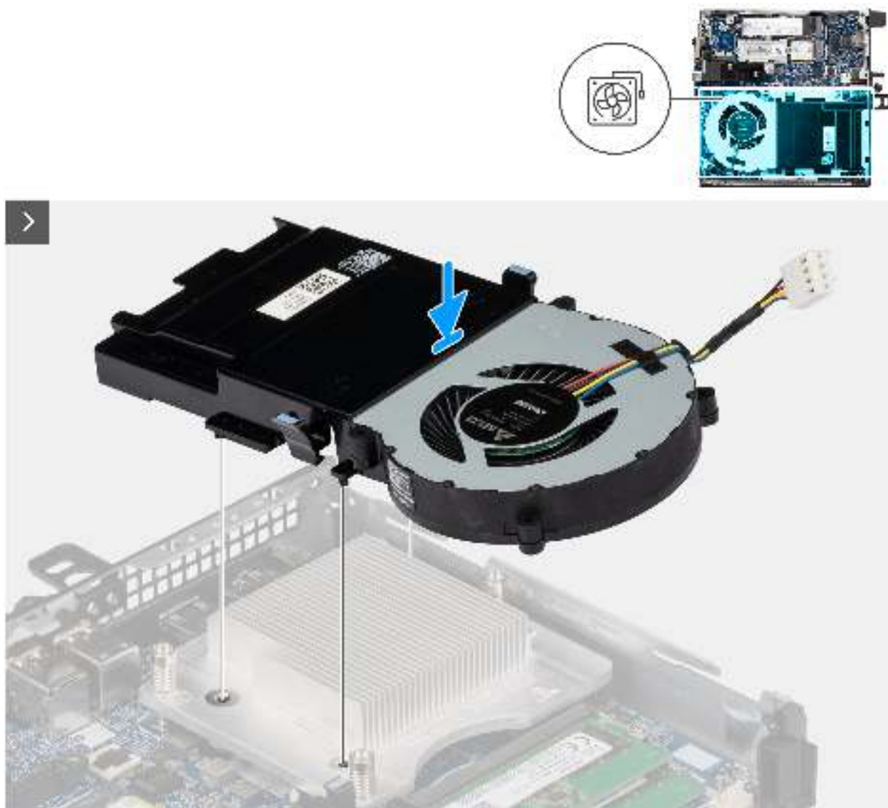
Abbildung 30. Einbauen des Lüfters
