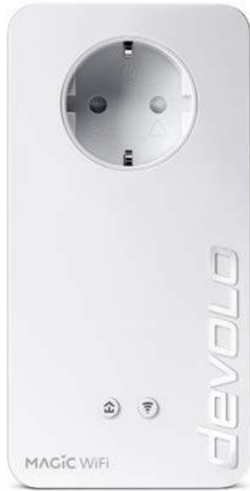
Abb. 2: devolo Magic 2 WiFi 6 next mit landes- spez. Stecker und Steckdose
